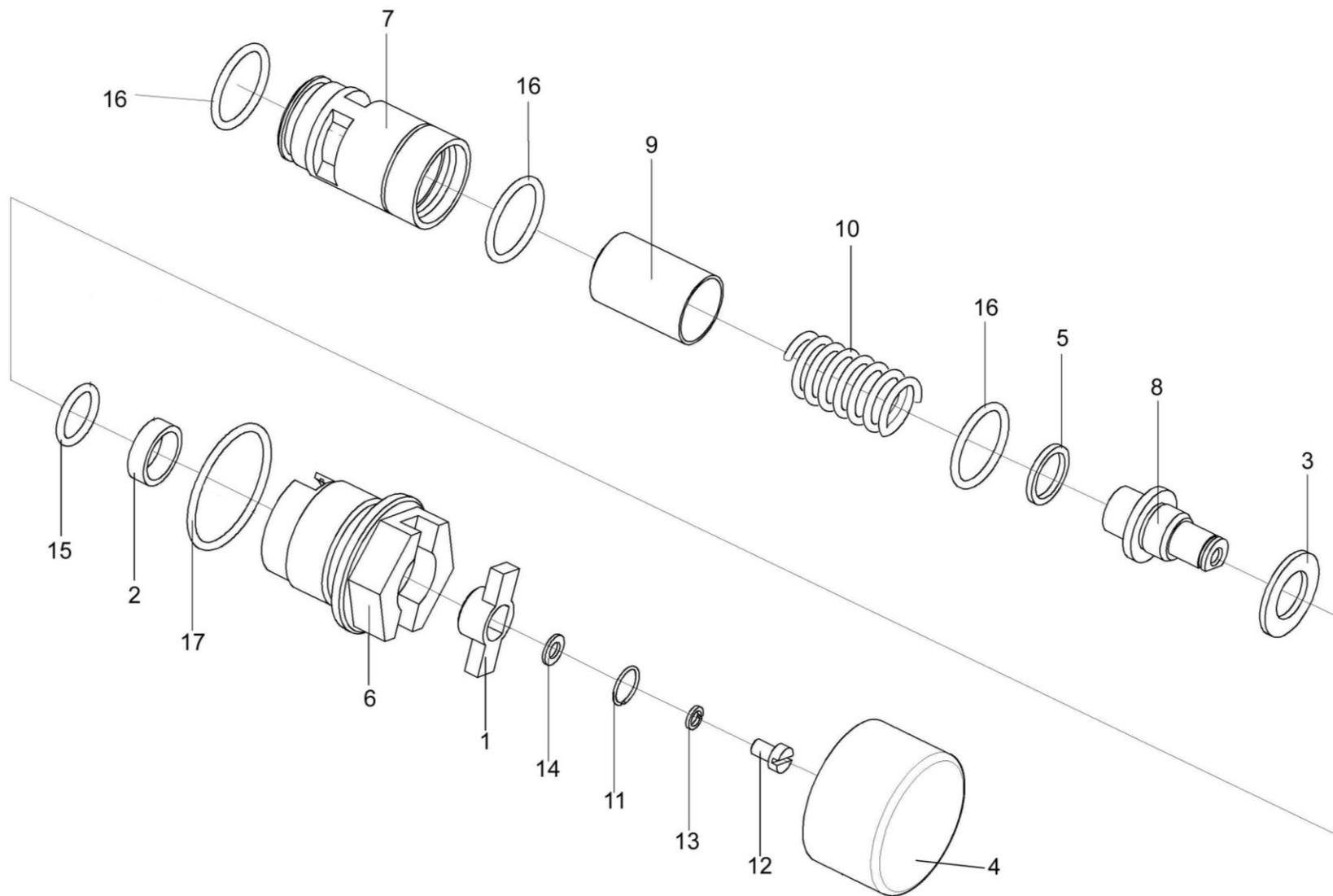
Рисунок 180 – Клапан-сигнализатор УЭС 0603660-01
