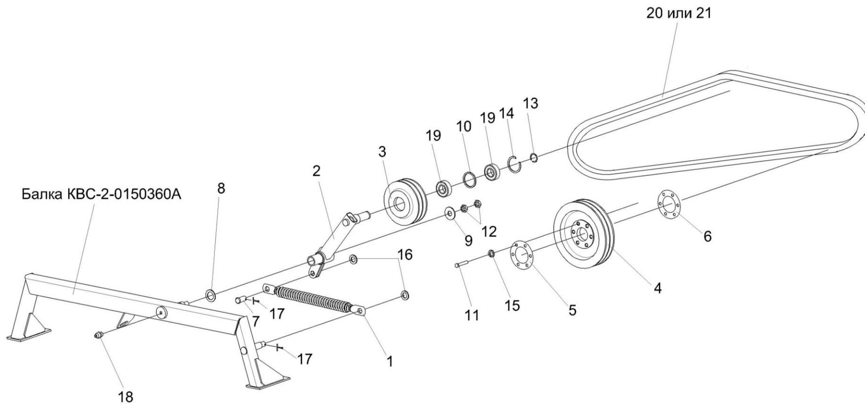
Рисунок 97 – Привод вентилятора КВС-2-0150090А
