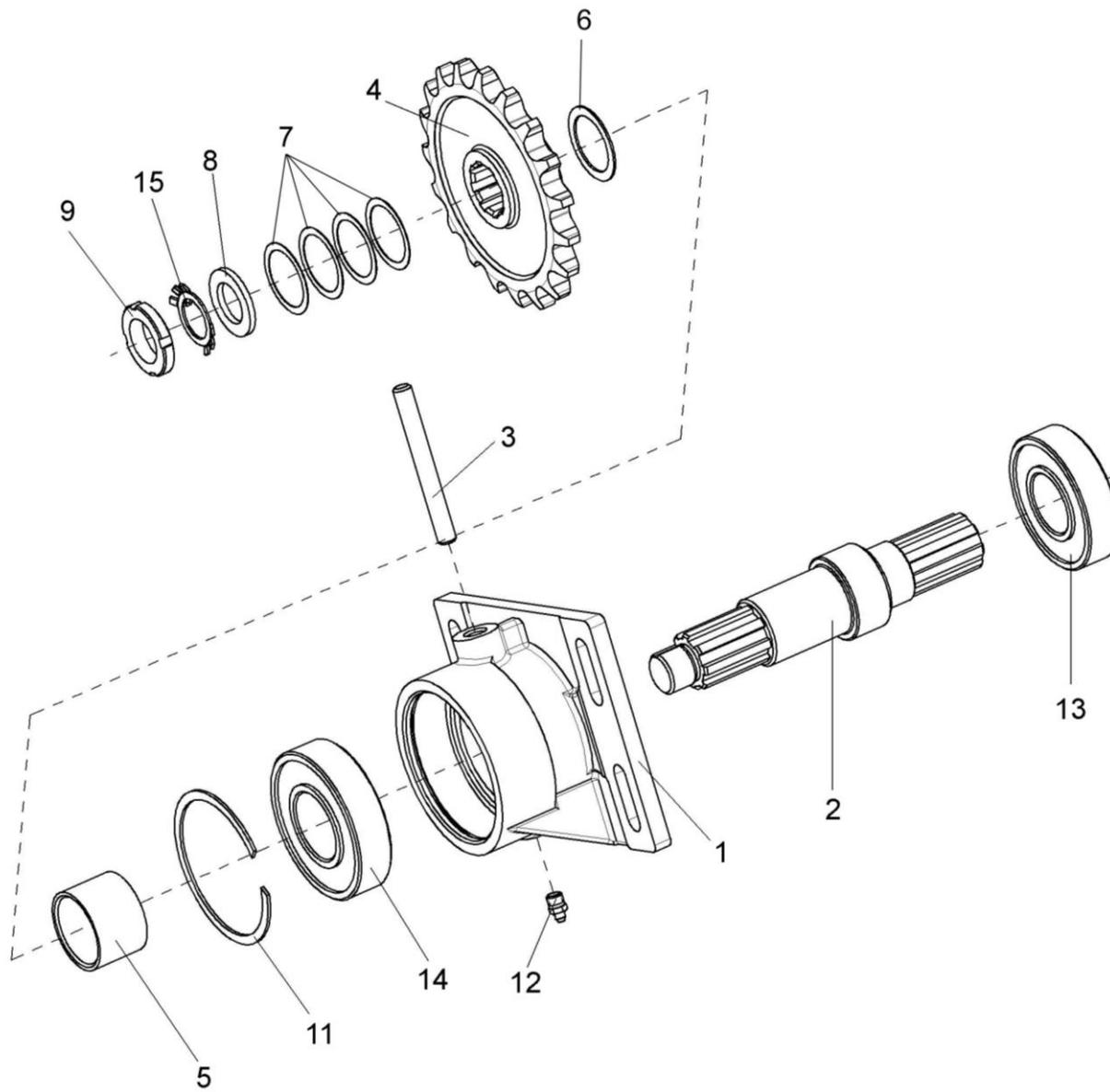
Рисунок 8 – Контрпривод КВС-1-011170
