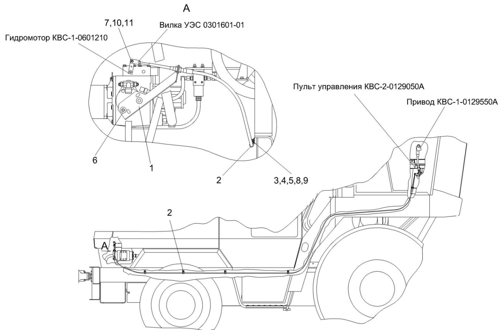
Рисунок 162 – Привод управления КВС-1-0129530
