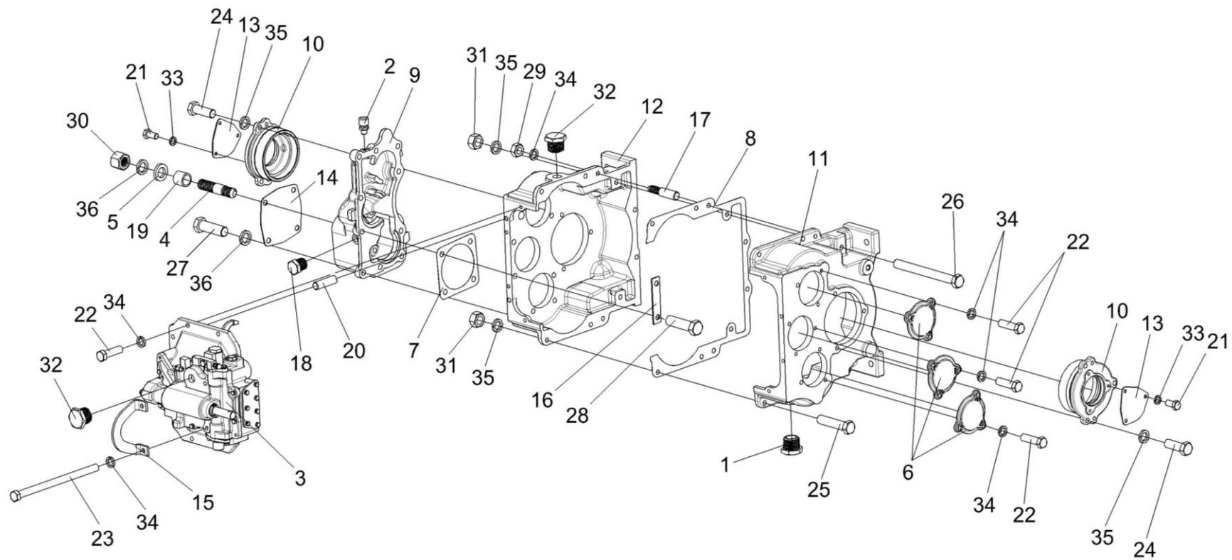
Рисунок 79 – Коробка диапазонов 3518020-46150 (корпус, крышки)
