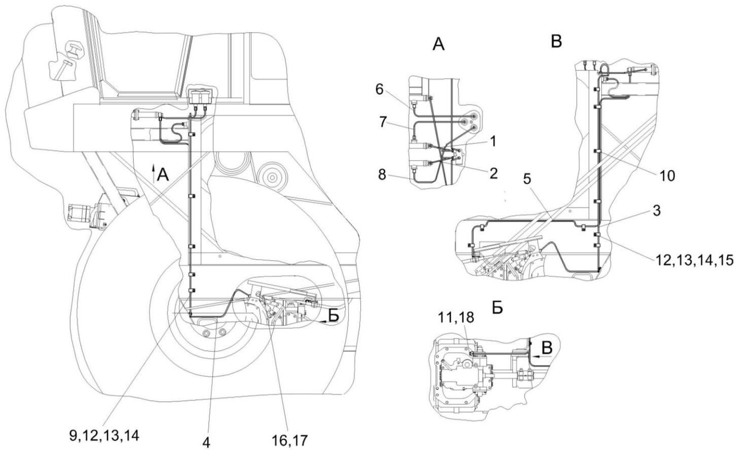
Рисунок 161 – Установка трубопроводов и стояночных тормозов КВС-1-0129100
