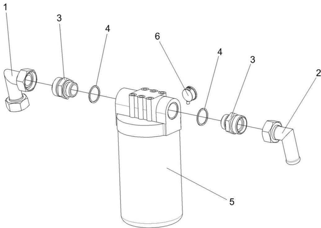
Рисунок 166 – Фильтр всасывающий КВС-2-0601090Б
