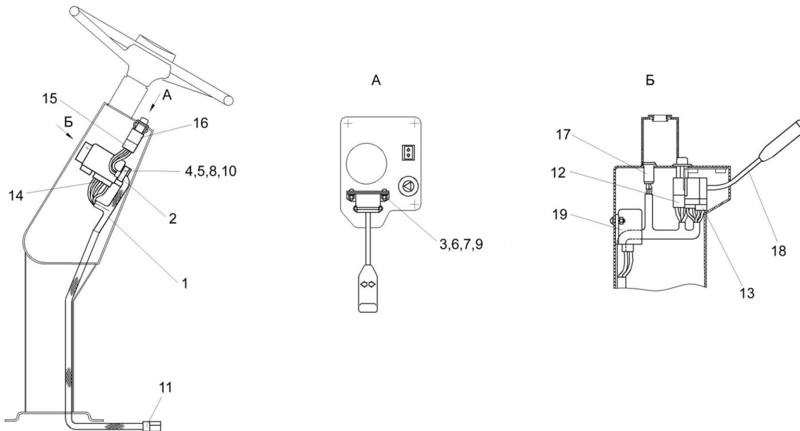
Рисунок 152 – Электрооборудование рулевой колонки КВС-1-0129230
