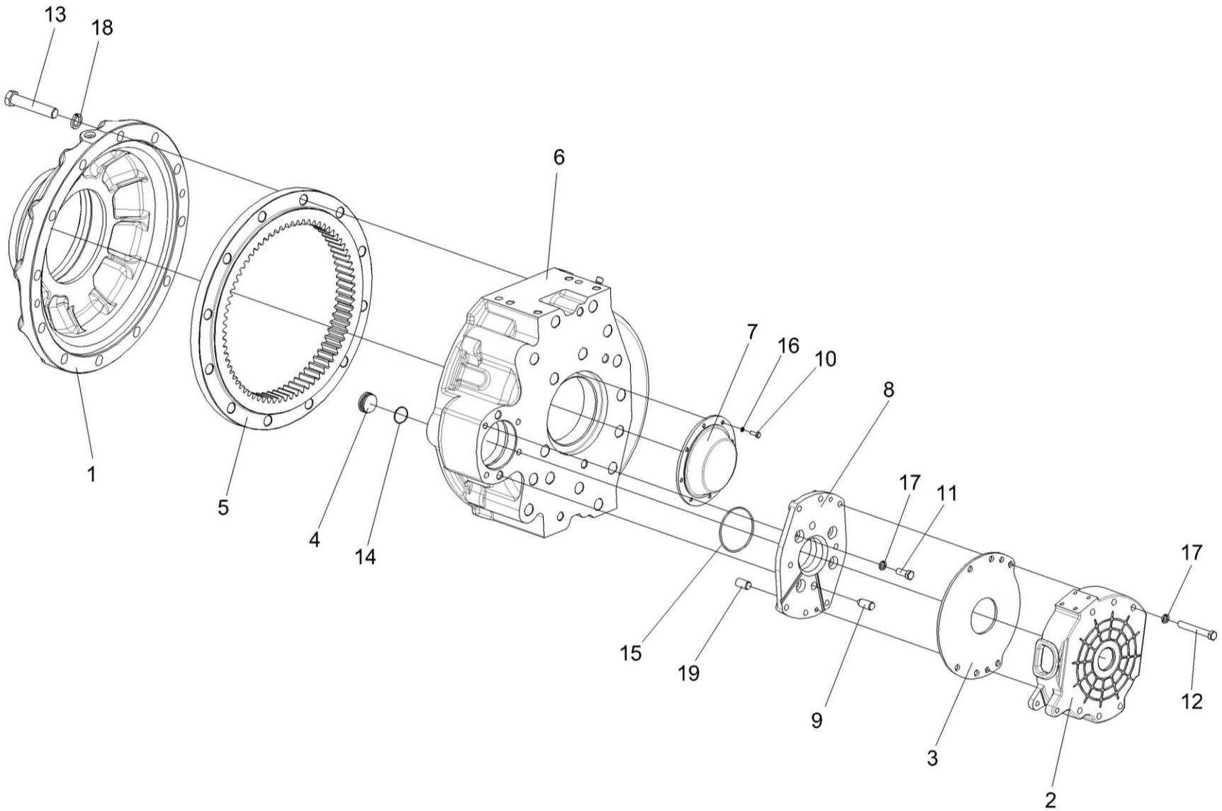
Рисунок 72 – Редуктор бортовой КЗК-10-0107200-02. Корпуса и крышки
