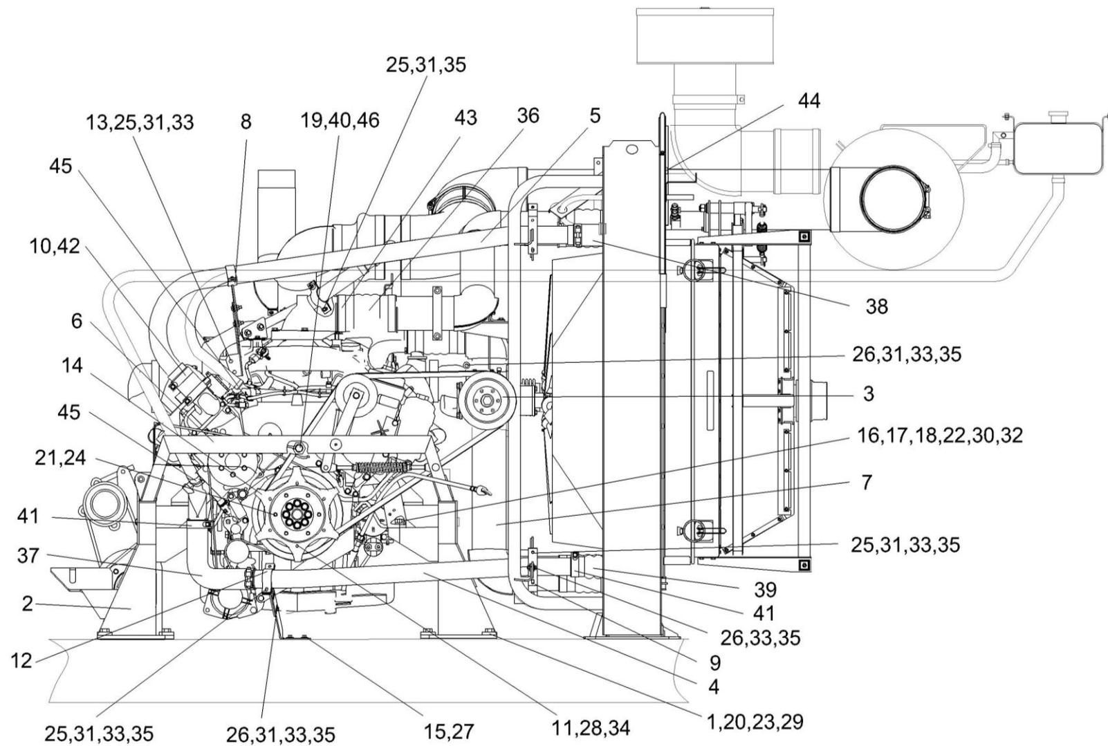
Рисунок 92 – Установка дизеля OM 502LA КВС-2-0150000В (лист 1)
