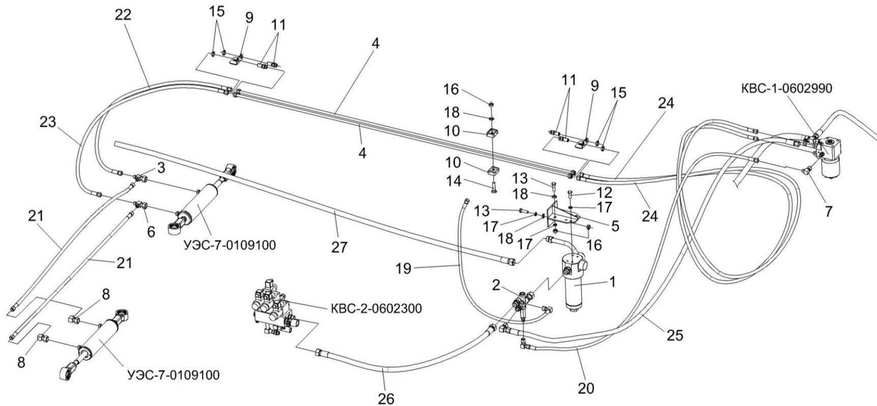
Рисунок 172 – Гидросистема рабочих органов и рулевого управления КВС-2-0602000 (рулевое управление)
