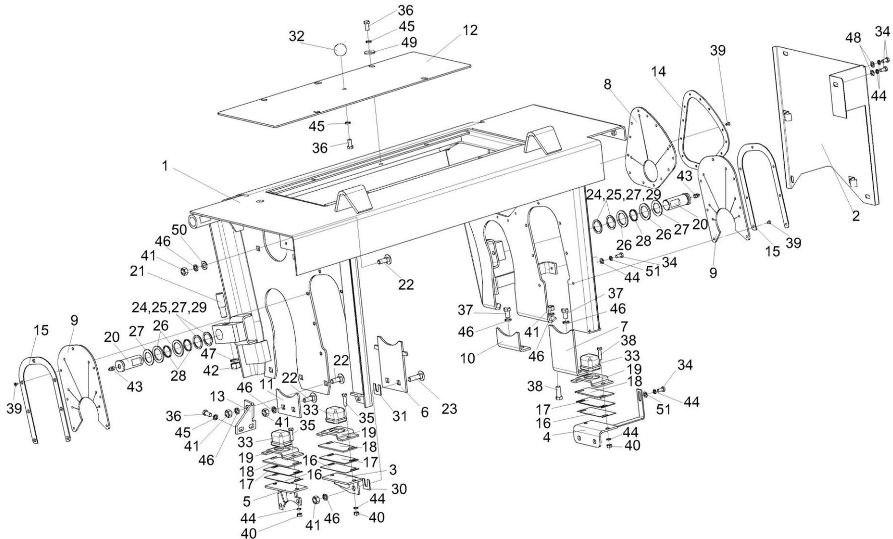
Рисунок 5 – Установка рамы верхней КВС-2-0111300А аппарата питающего
