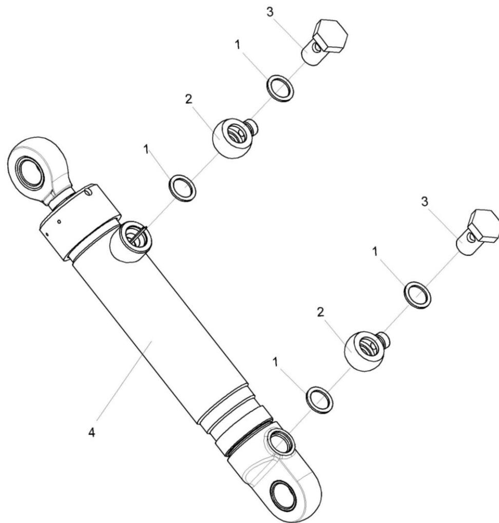
Рисунок 65 – Гидроцилиндр КВС-2-0602500
