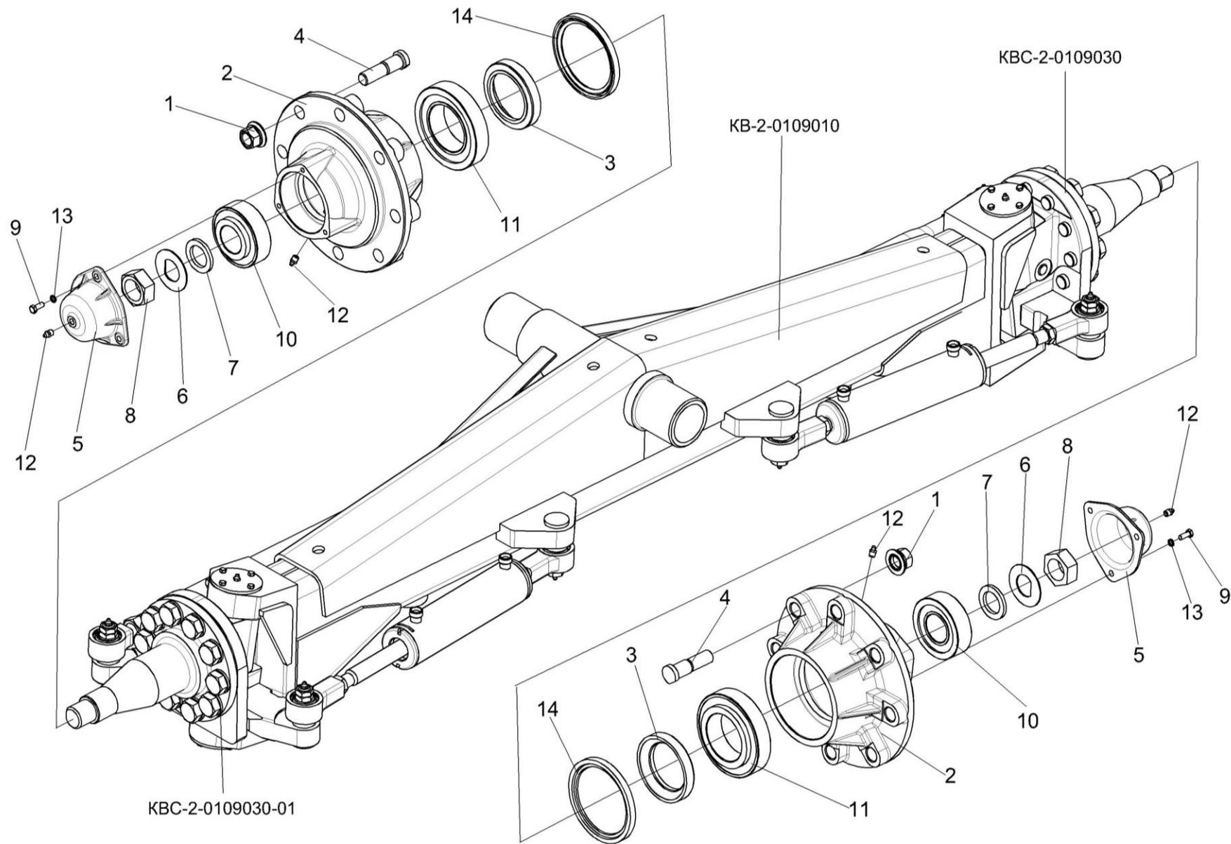
Рисунок 85 – Мост управляемых колес КВС-2-0109000 (установка ступиц)
