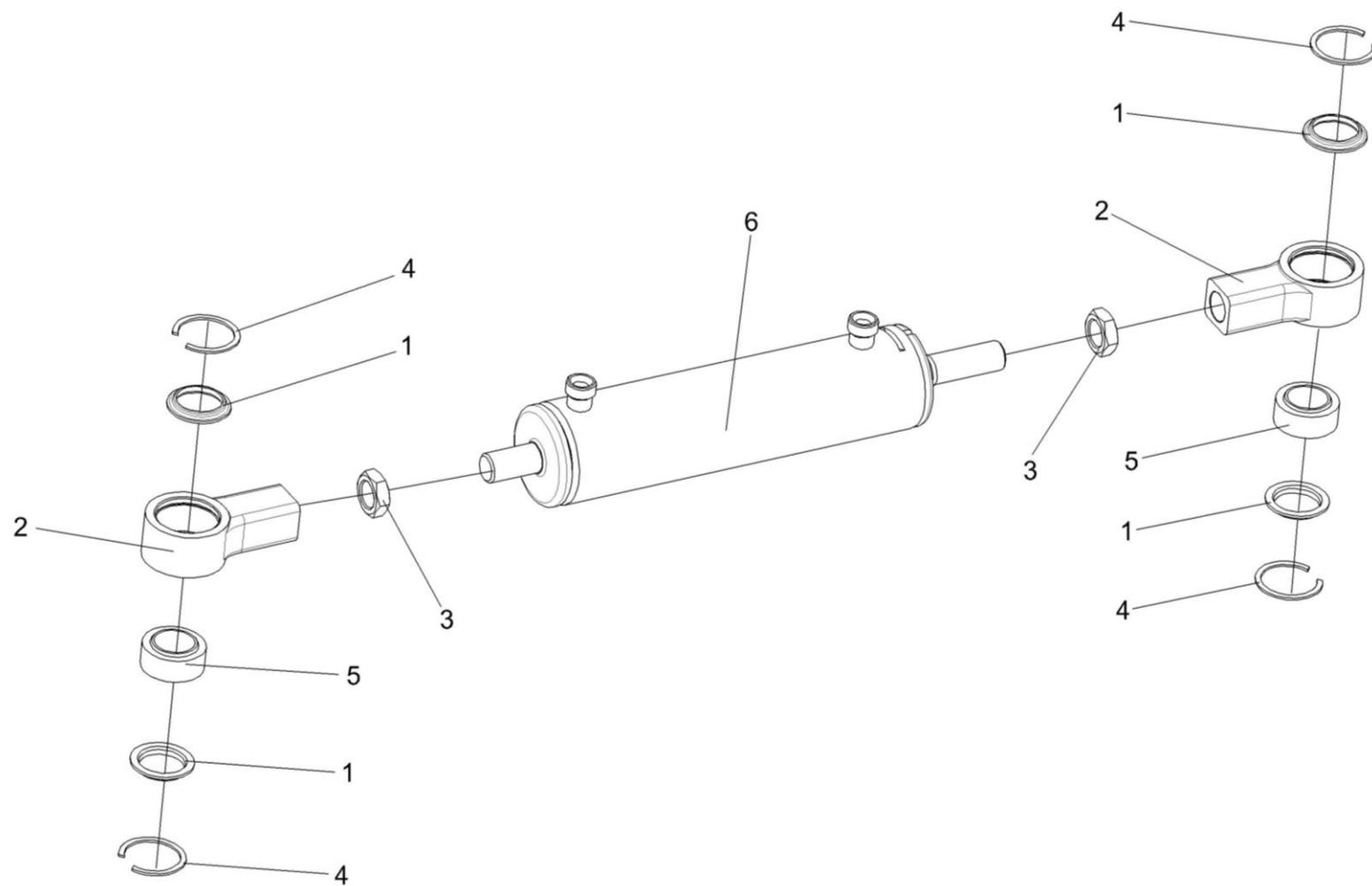
Рисунок 86 – Гидроцилиндр УЭС-7-0109100
