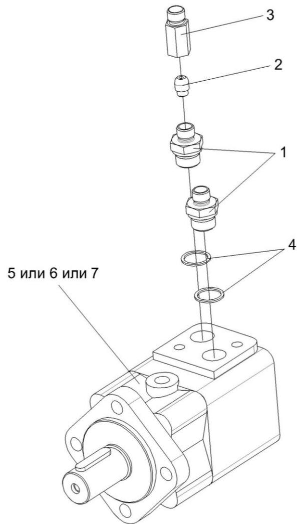
Рисунок 183 – Гидромотор заточного устройства КВС-1-0602650-01
