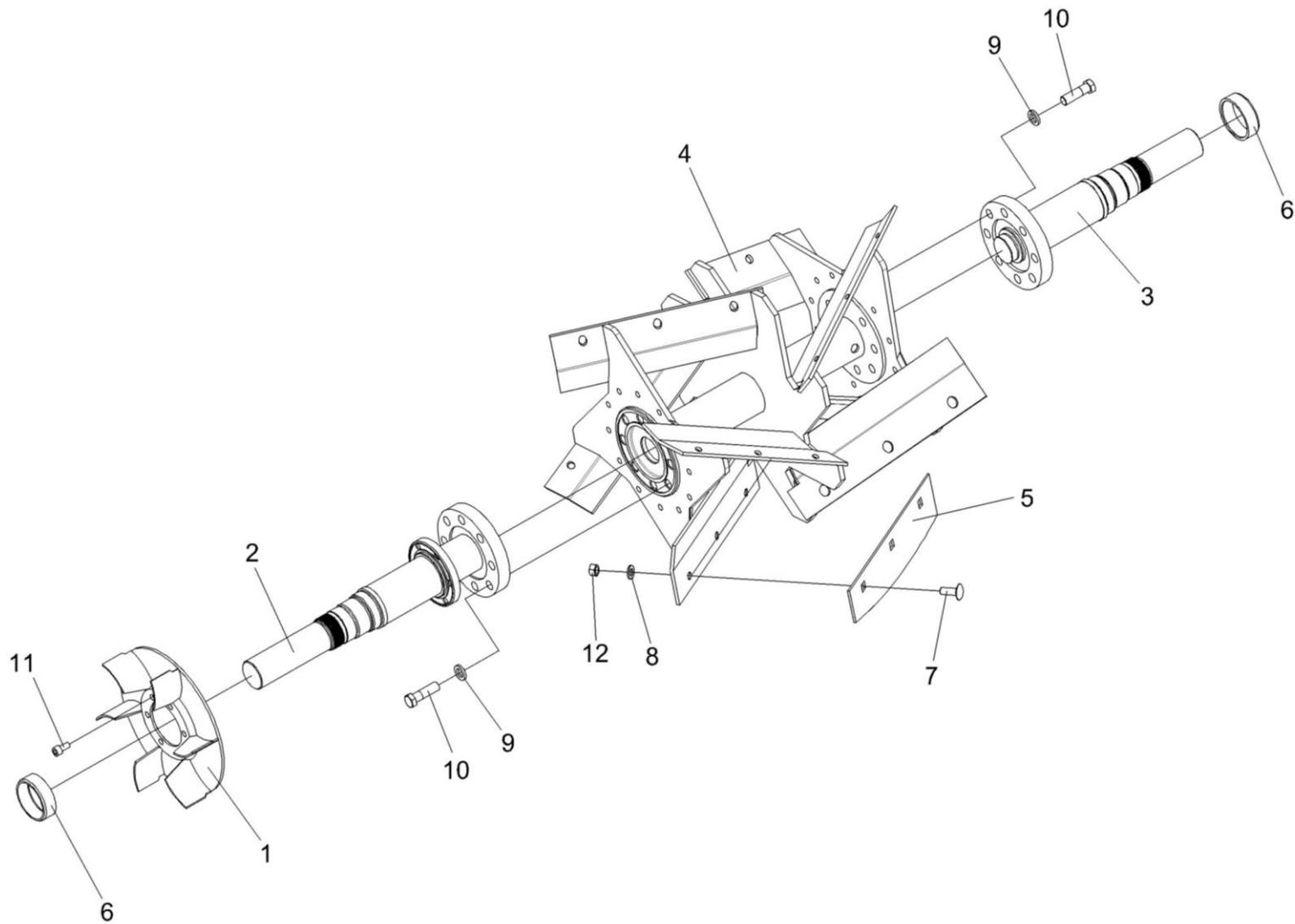
Рисунок 60 – Вал ускорителя выброса КВС-1-0142810
