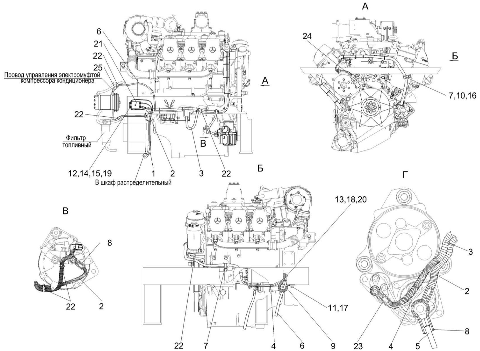
Рисунок 96 – Электрооборудование дизеля OM 502LA KBC-2-0100000
