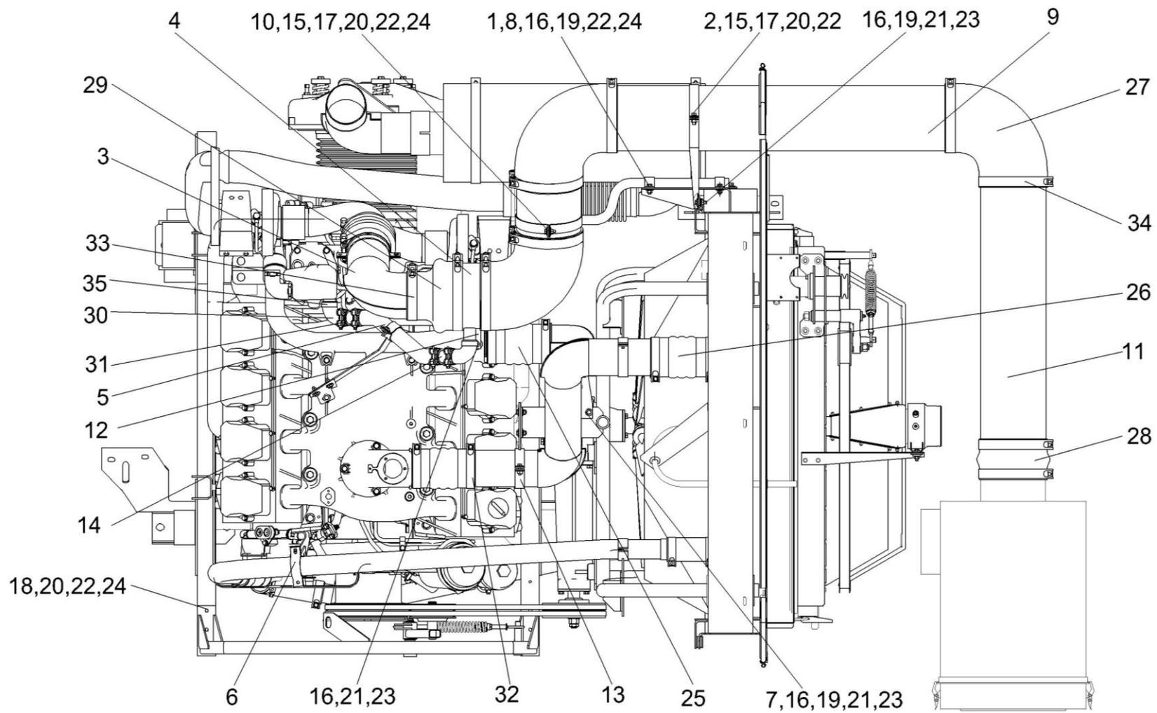
Рисунок 95 – Установка дизеля OM 502LA KBC-2-0150000B (лист 4)
