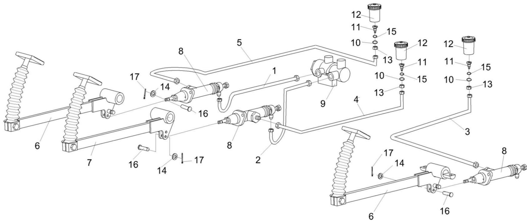
Рисунок 139 – Рычаги и трубопроводы площадки управления
