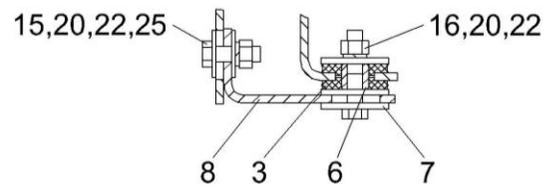
Рисунок 105 – Установка блока радиаторов КВС-2-0152000А (лист 1)
