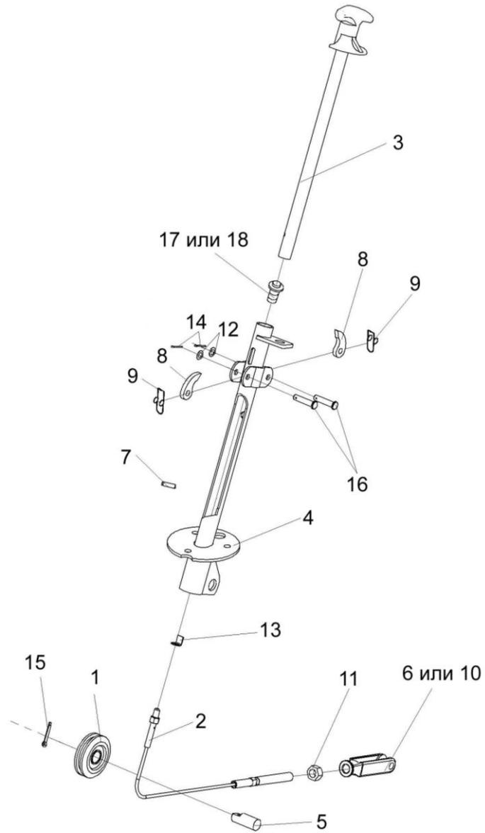
Рисунок 154 – Колонка привода УЭС 0300710
