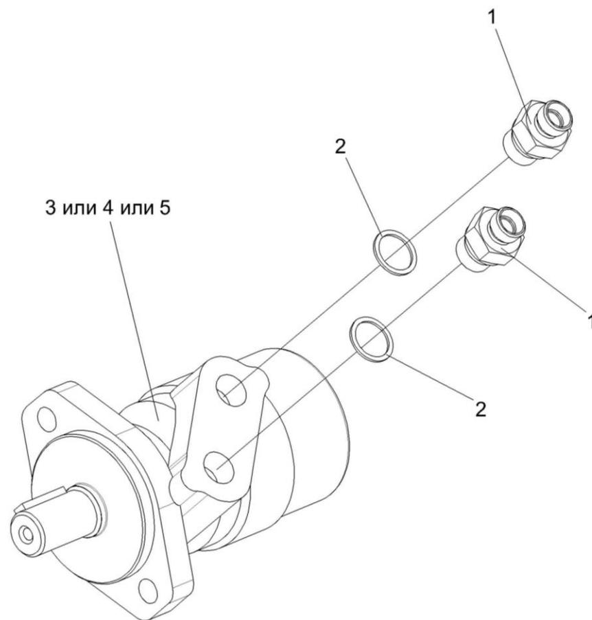
Рисунок 111 – Гидромотор воздухозаборника КВС-5-0602100
