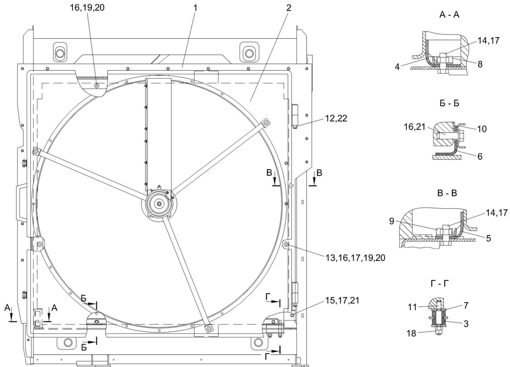
Рисунок 106 – Установка блока радиаторов KBC-2-0152000A (лист 2)
