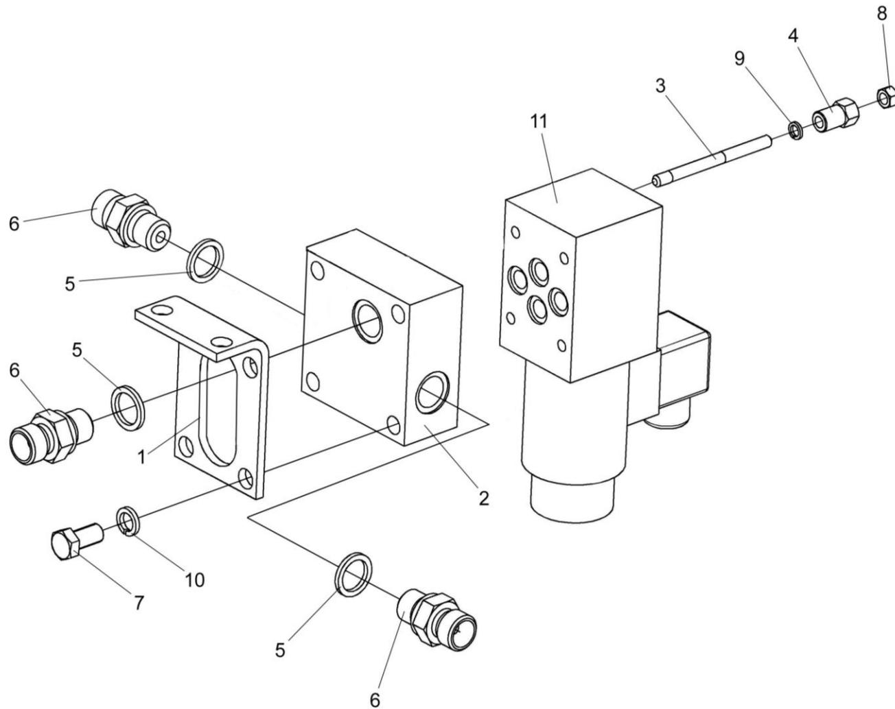
Рисунок 167 – Гидроблок включения главного привода КВС-1-0601220А
