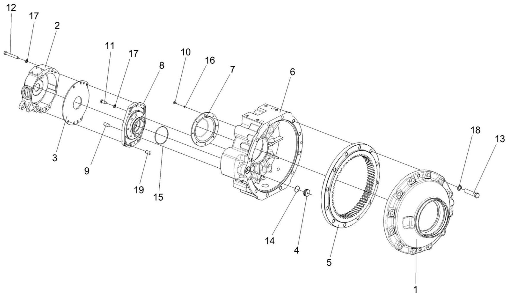
Рисунок 75 – Редуктор бортовой КЗК-10-0107200-03. Корпуса и крышки
