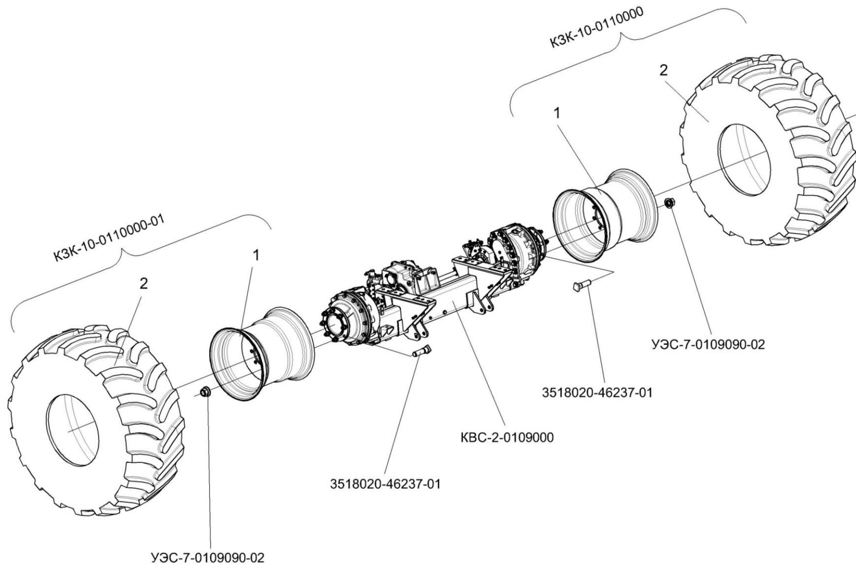
Рисунок 89 – Установка колес КЗК-10-0110000 и КЗК-10-0110000-01
