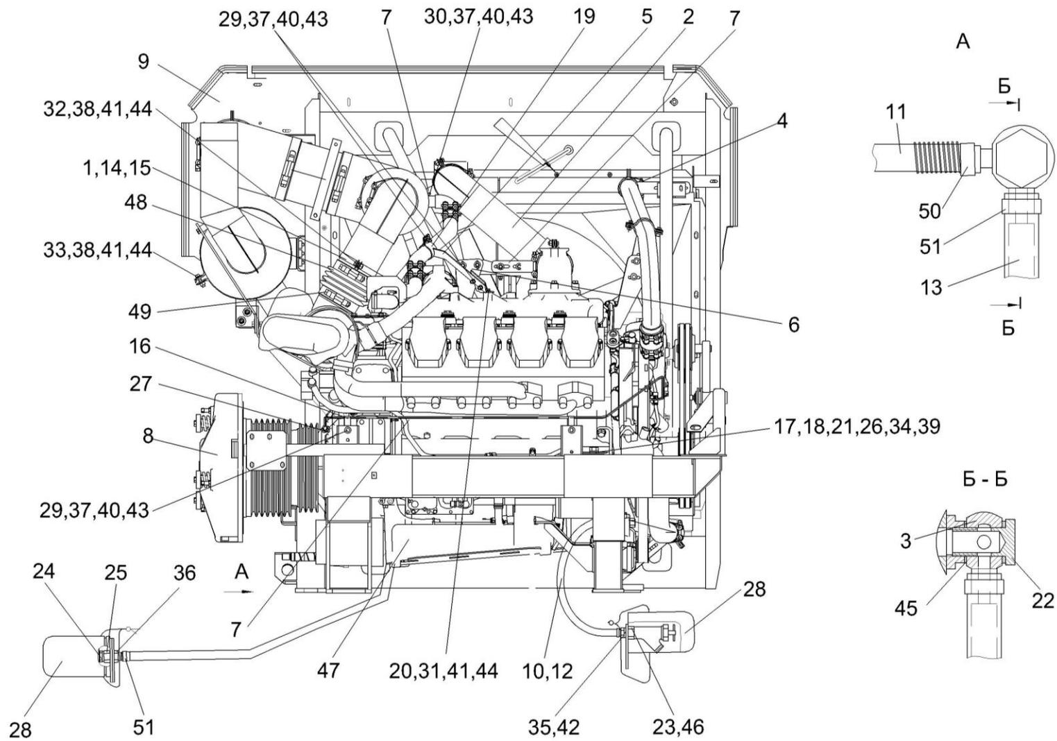
Рисунок 93 – Установка дизеля OM 502LA KBC-2-0150000B (лист 2)
