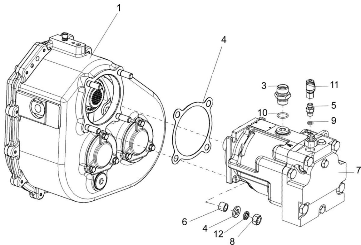
Рисунок 17 – Установка гидромотора привода питающего аппарата КВС-2-0604210
