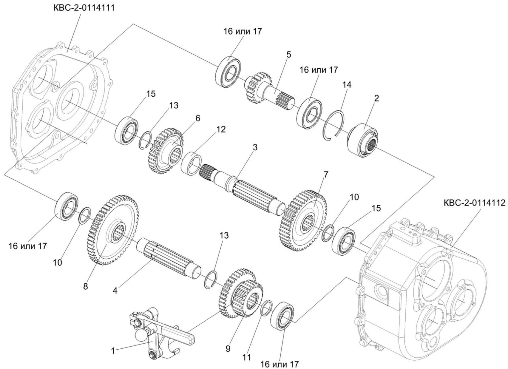
Рисунок 19 – Коробка передач КВС-2-0114100А. Валы и шестерни
