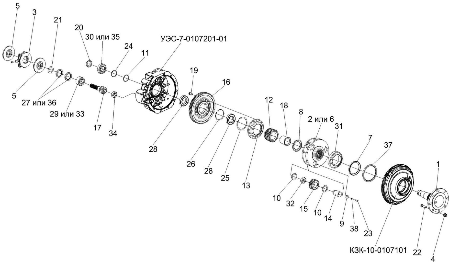
Рисунок 76 – Редуктор бортовой КЗК-10-0107200-03. Валы и шестерни
