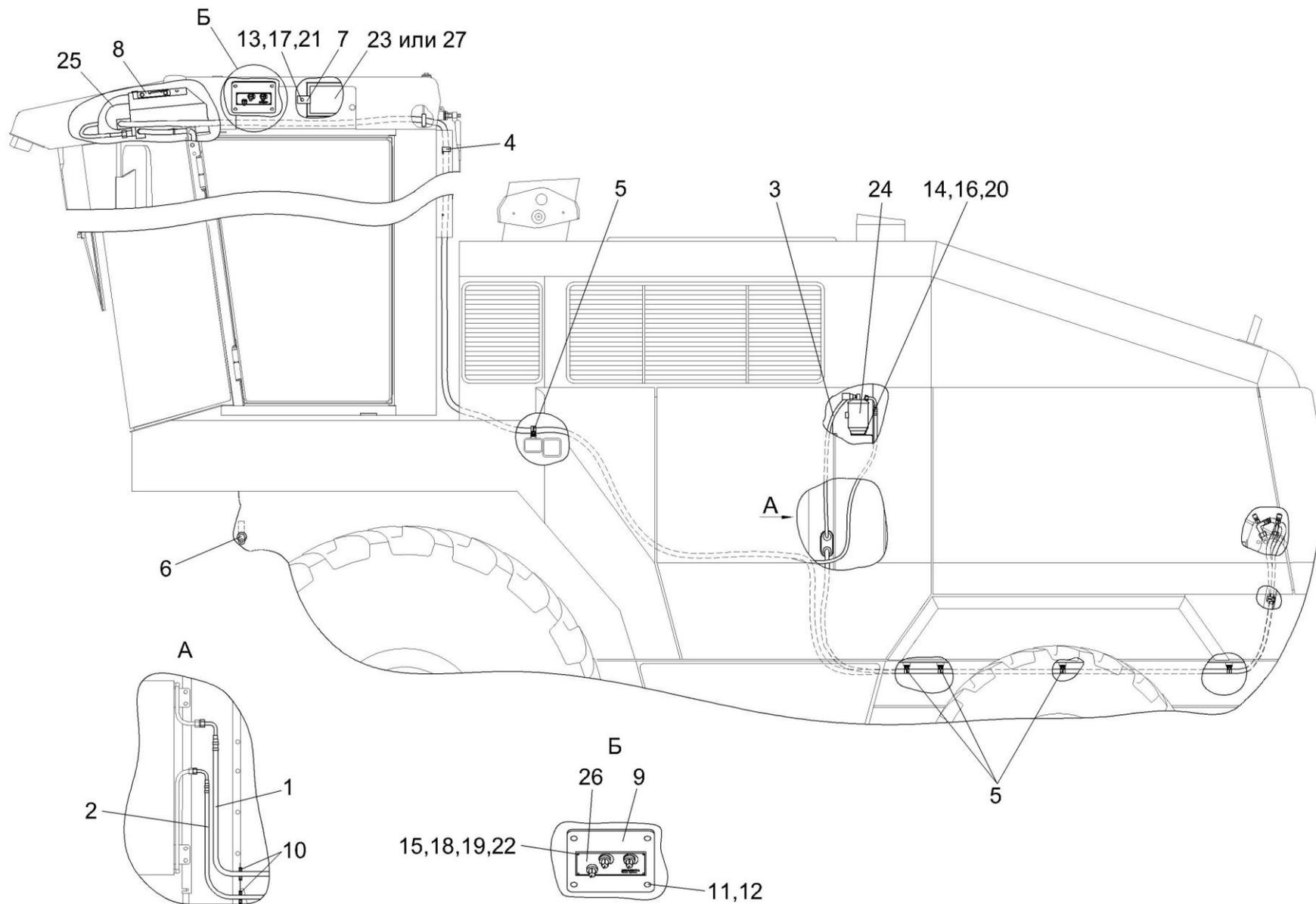
Рисунок 135 – Установка климатическая КВС-2-0121000А (вид слева)
