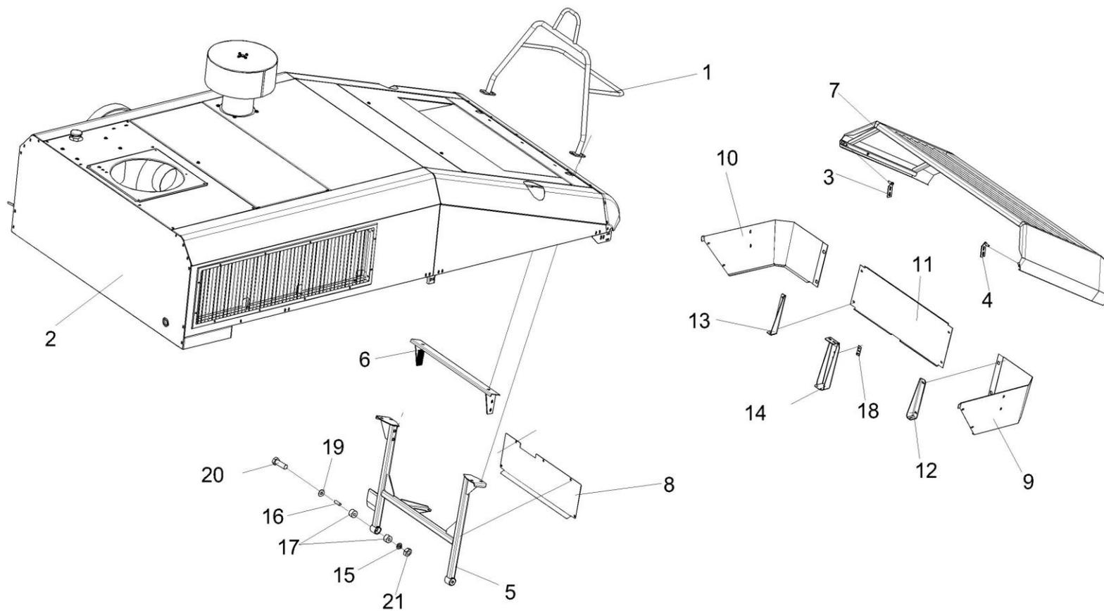
Рисунок 121 – Установка капотов КВС-2-0160000 (лист 3)
