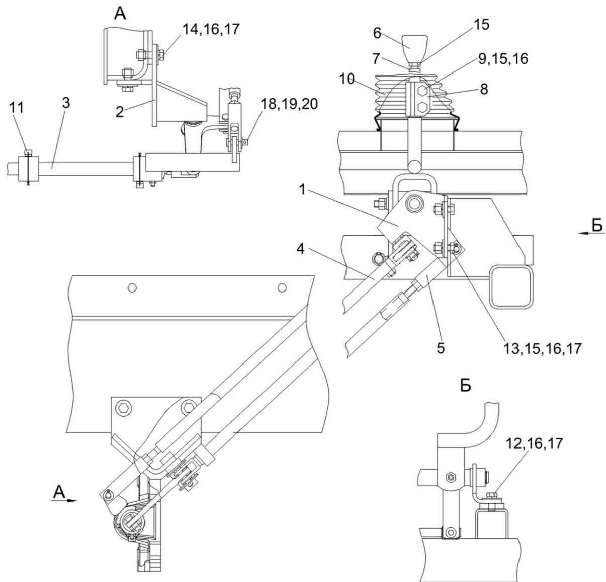
Рисунок 155 – Установка механизма управления коробкой диапазонов КВС-2-0129040
