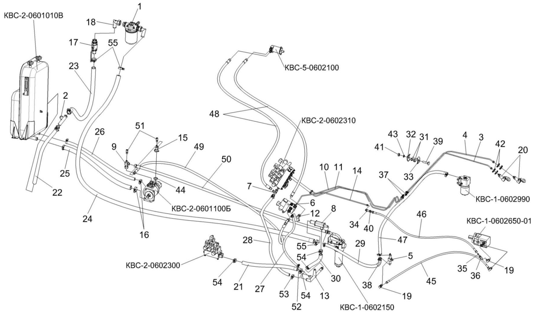
Рисунок 173 – Гидросистема рабочих органов и рулевого управления KBC-2-0602000
