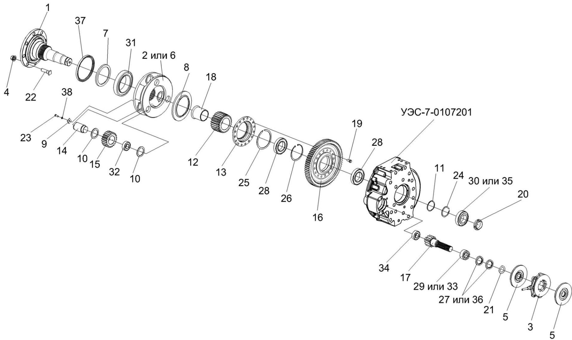
Рисунок 73 – Редуктор бортовой КЗК-10-0107200-02. Валы и шестерни
