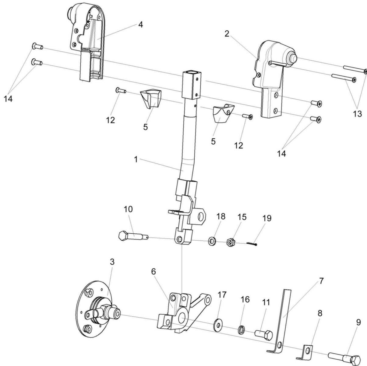
Рисунок 141 – Привод КВС-1-0129550А
