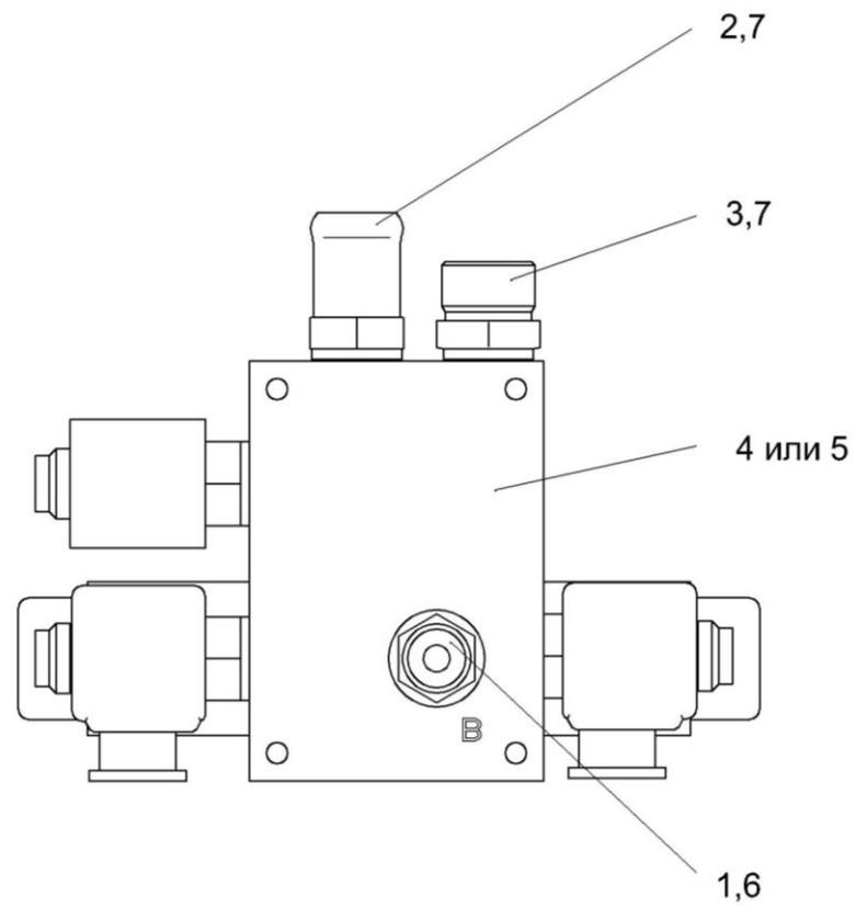
Рисунок 175 – Гидроблок навески КВС-2-602300
