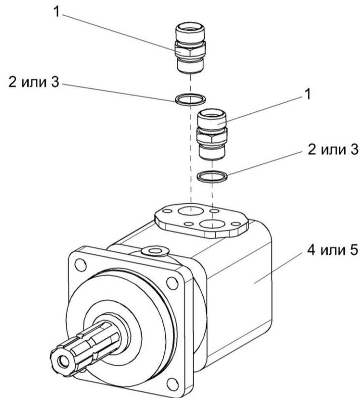
Рисунок 189 – Гидромотор привода адаптеров КГС 0115380
