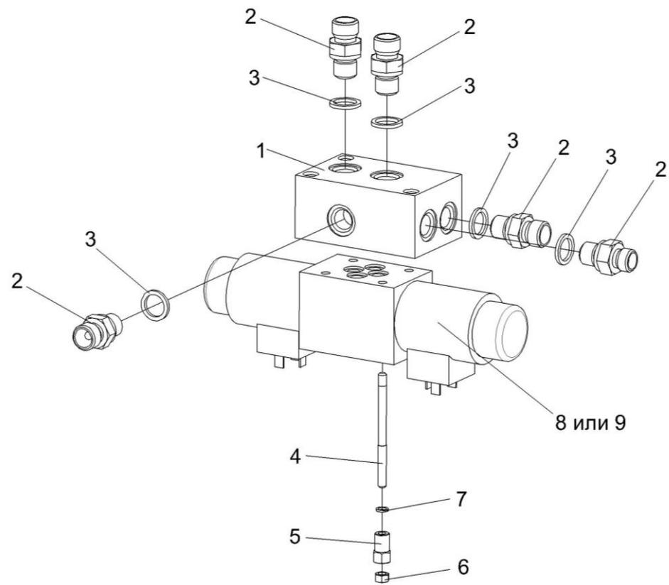
Рисунок 188 – Гидроблок управления КГС 0115120А-01
