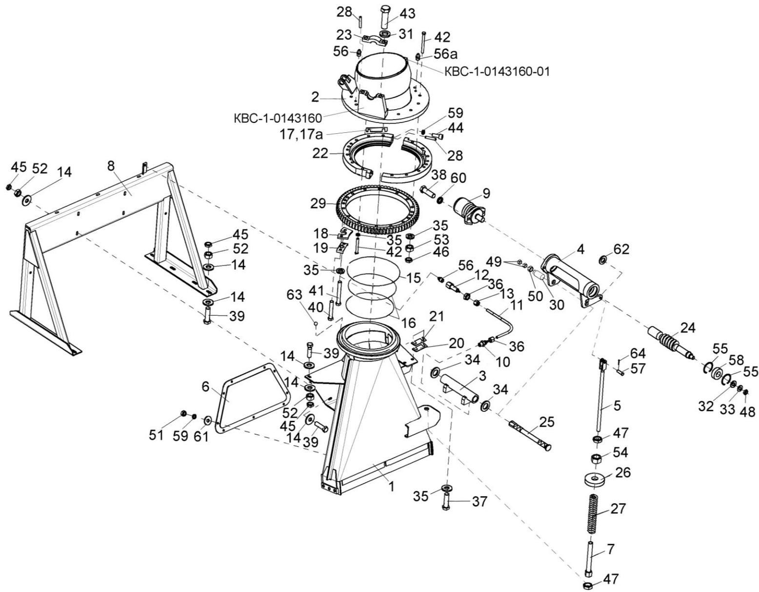
Рисунок 62 – Основание силосопровода и механизм поворота КВС-1-0143000
