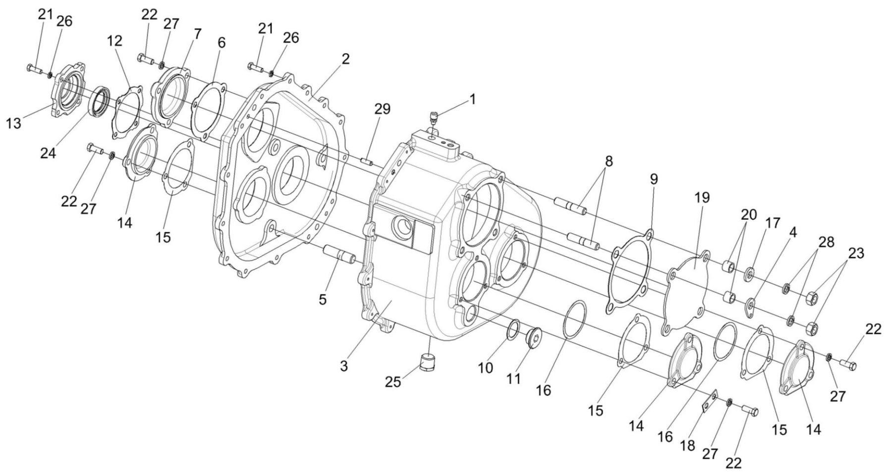
Рисунок 18 – Коробка передач КВС-2-0114100А. Корпуса и крышки
