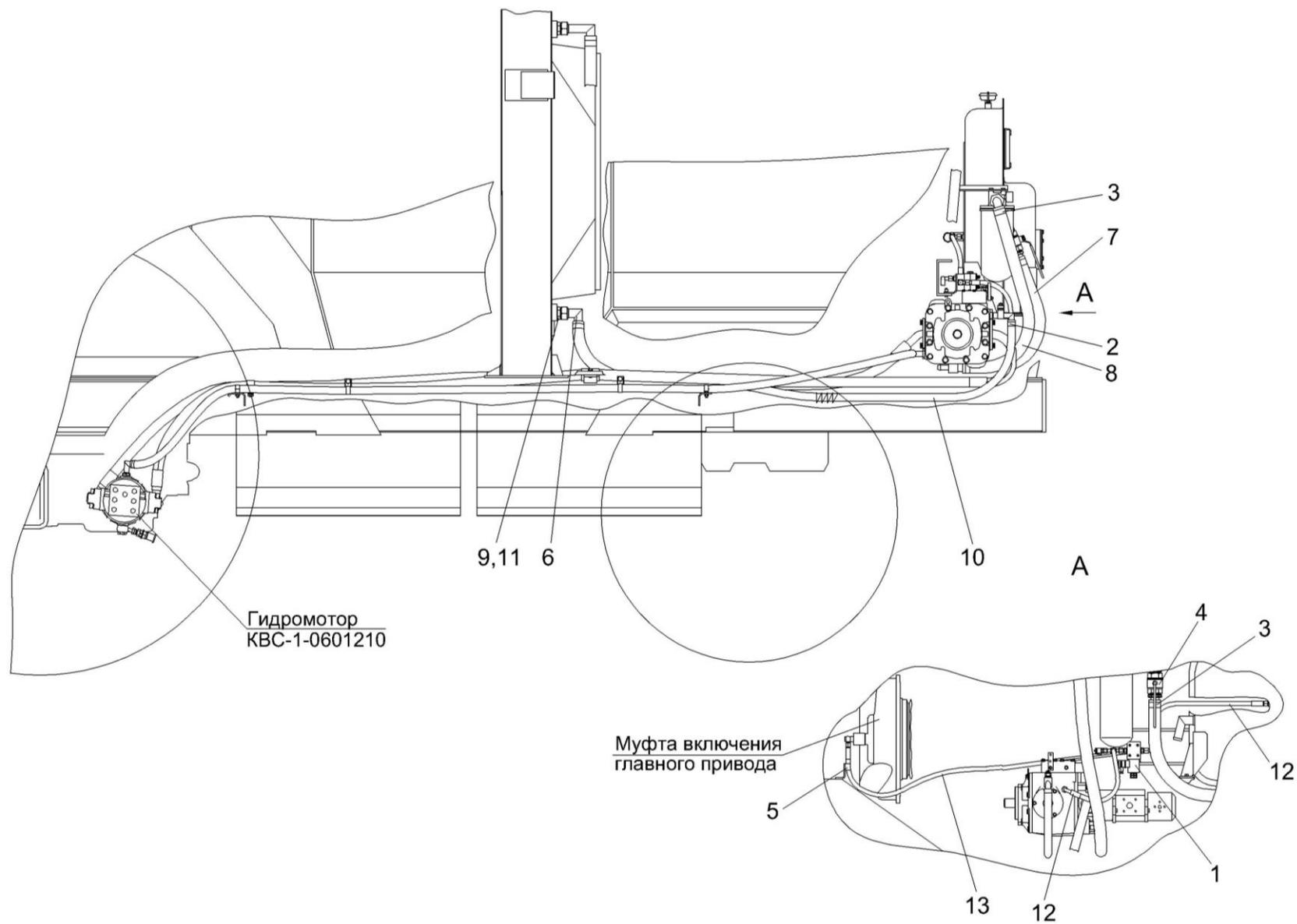
Рисунок 163 – Гидросистема привода ходовой части КВС-2-0601000Б (вид слева)
