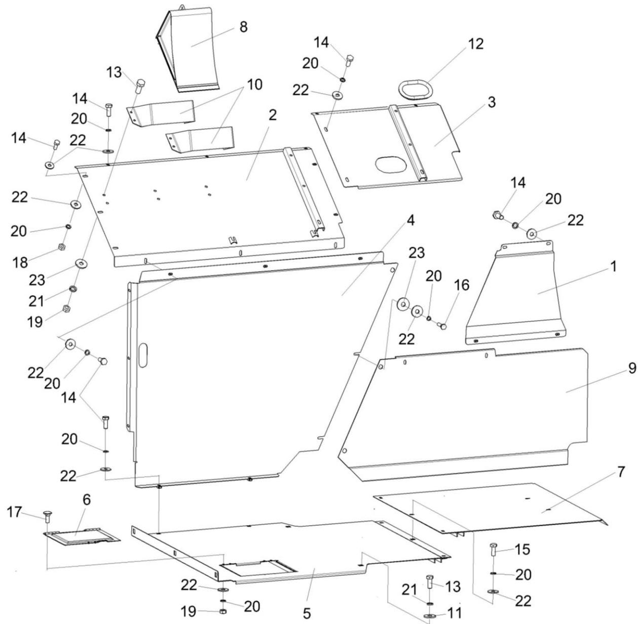
Рисунок 126 – Установка настилов и ограждений КВС-2-0169000
