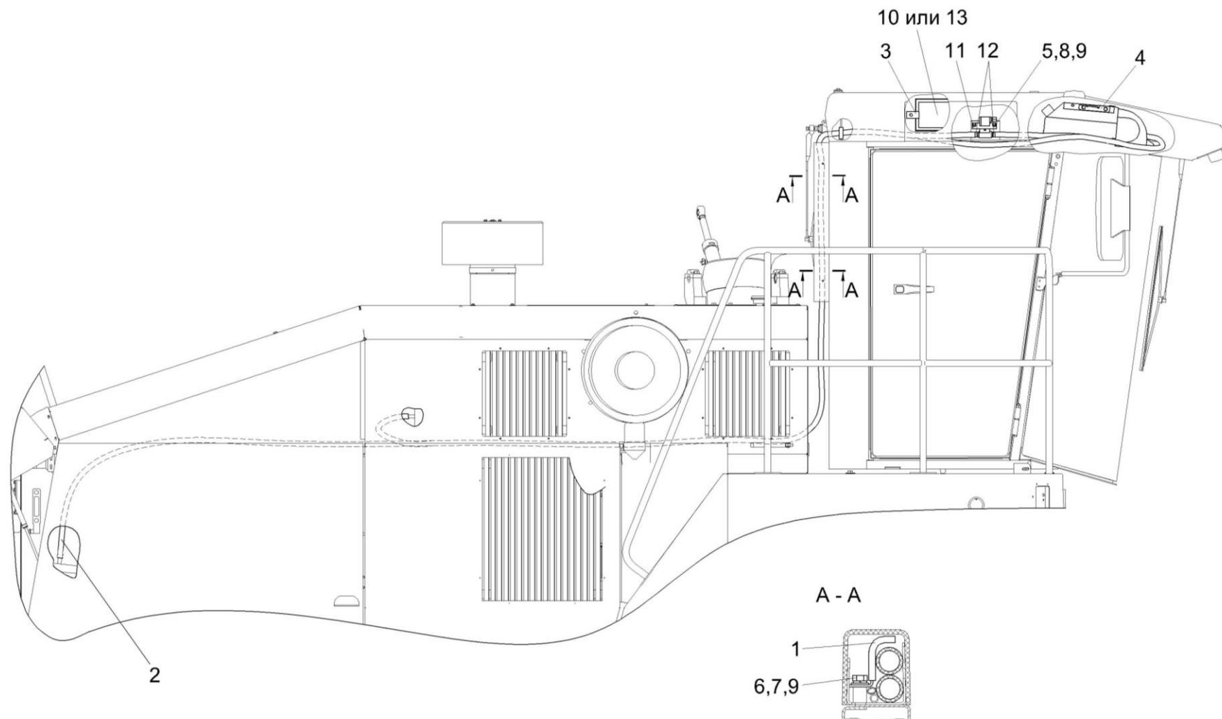
Рисунок 134 – Установка климатическая КВС-2-0121000А (вид справа)
