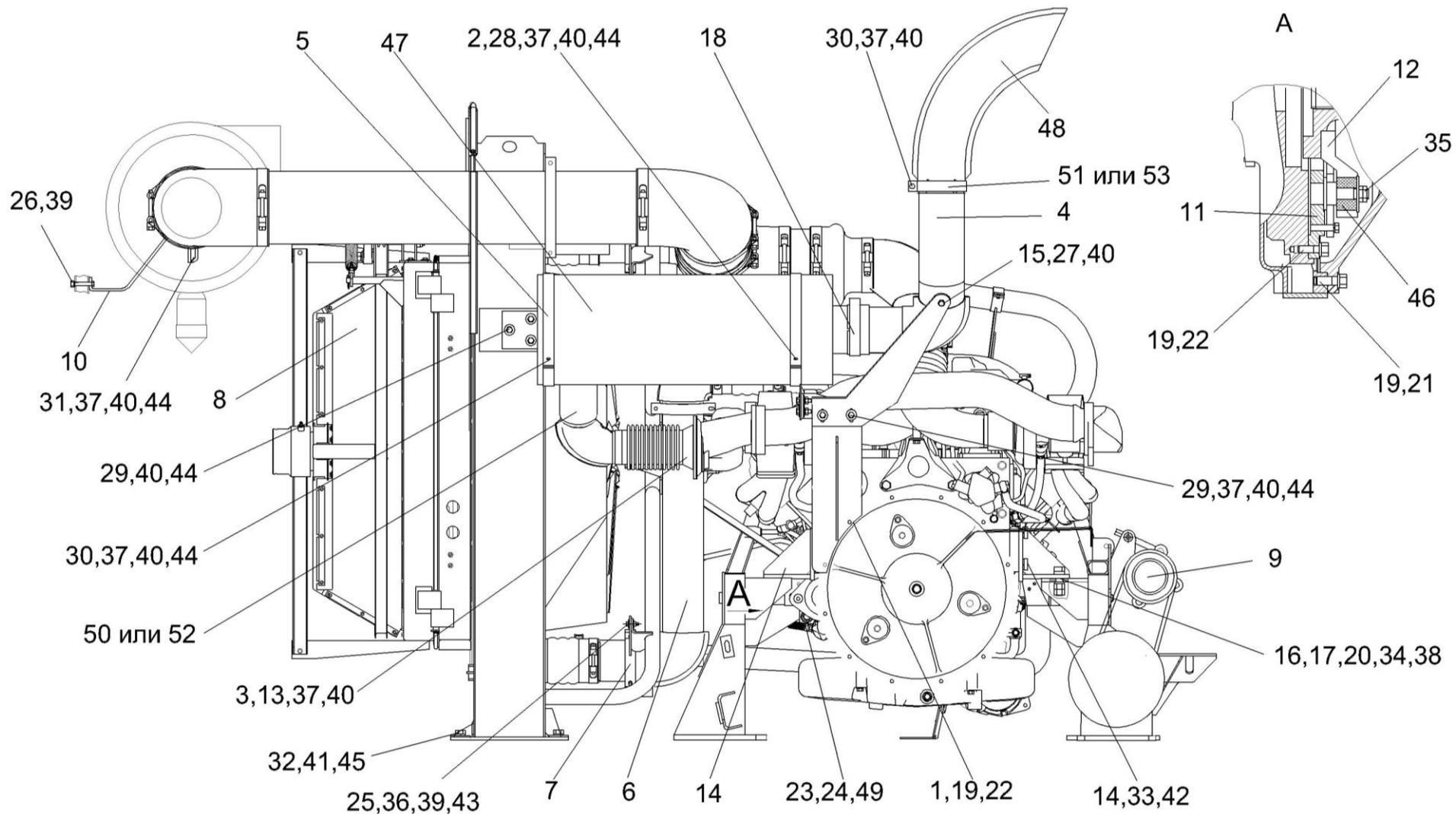
Рисунок 94 – Установка дизеля OM 502LA KBC-2-0150000B (лист 3)
