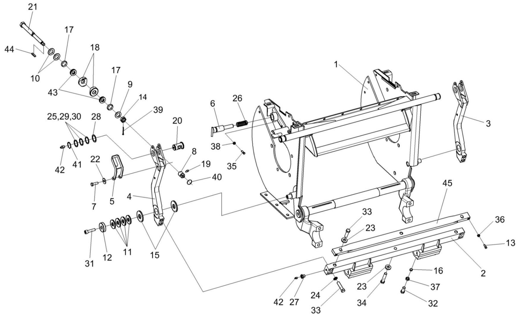
Рисунок 25 – Установка рычагов КВС-2-0117080 и КВС-2-0117080-01
