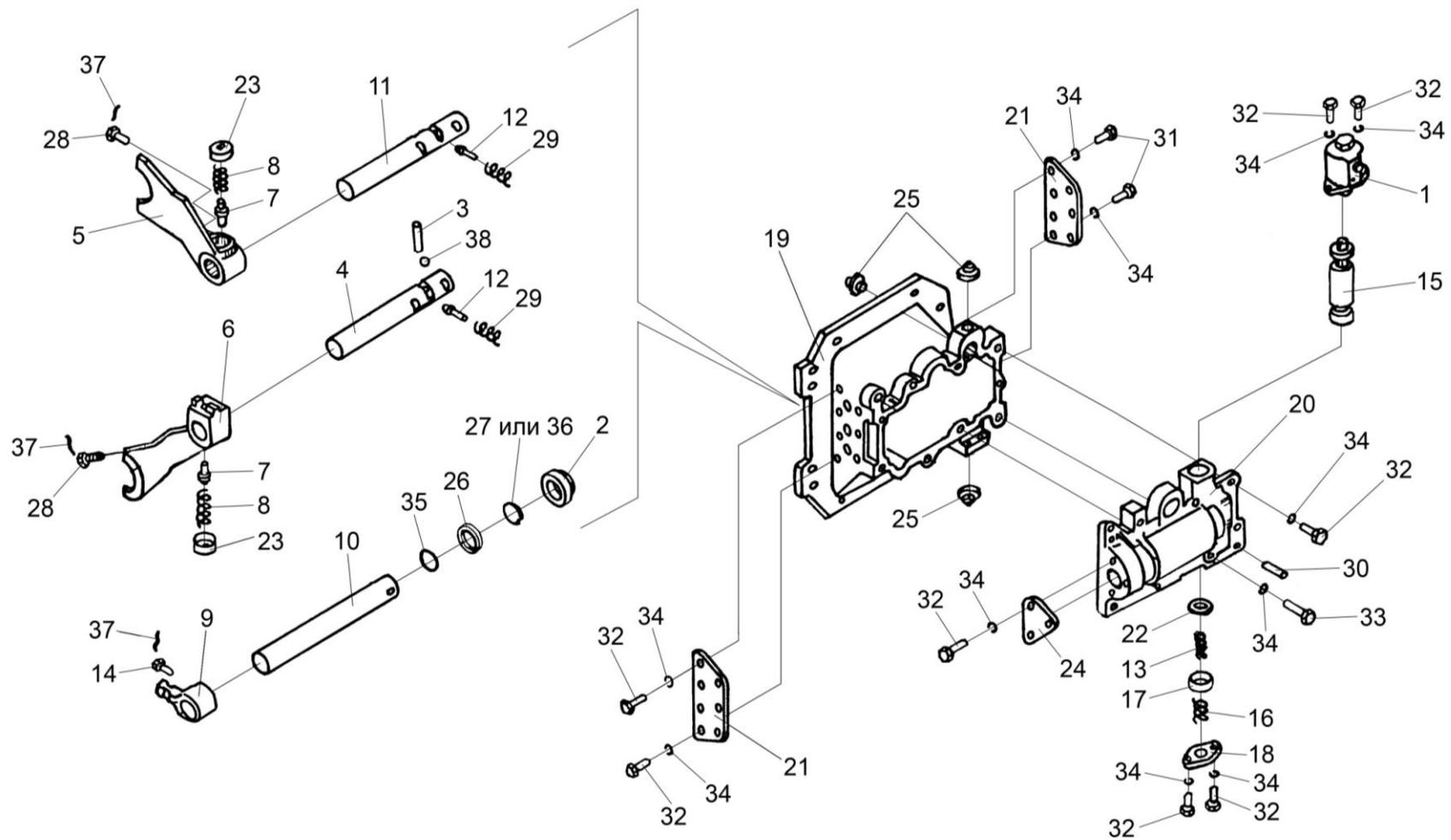
Рисунок 81 – Механизм переключения диапазонов 3518020-46160
