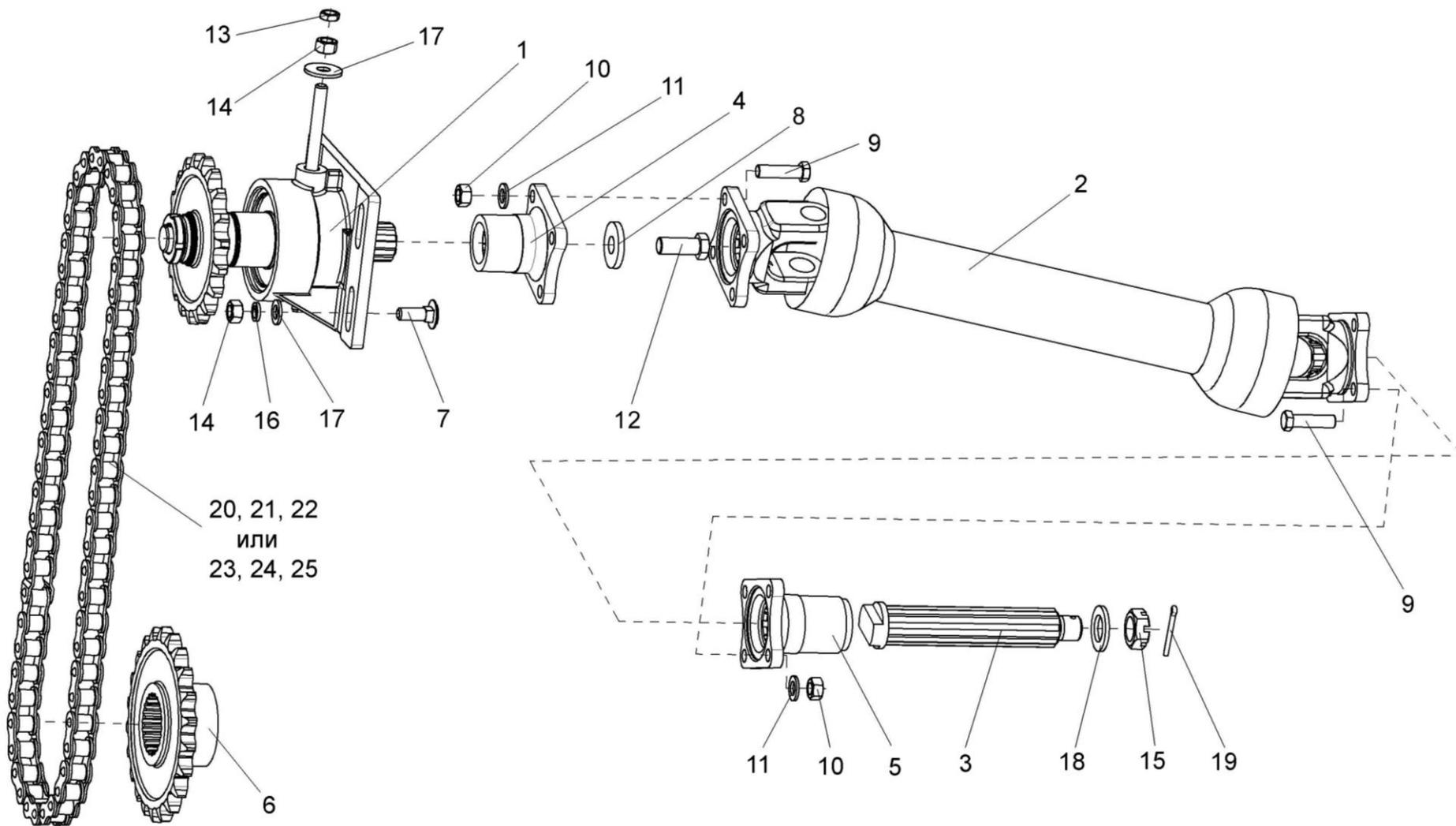
Рисунок 7 – Установка карданного вала КВС-1-0119000
