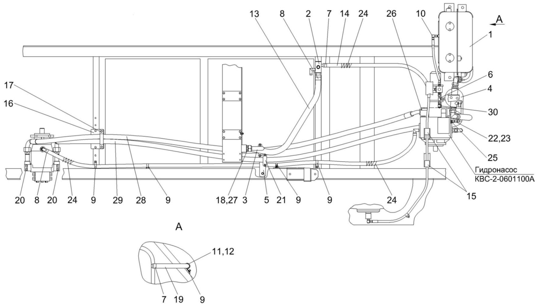
Рисунок 164 – Гидросистема привода ходовой части КВС-2-0601000Б (вид сверху)
