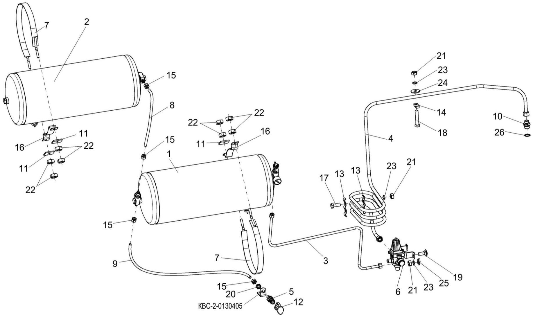
Рисунок 190 – Пневмосистема КВС-2-0800000
