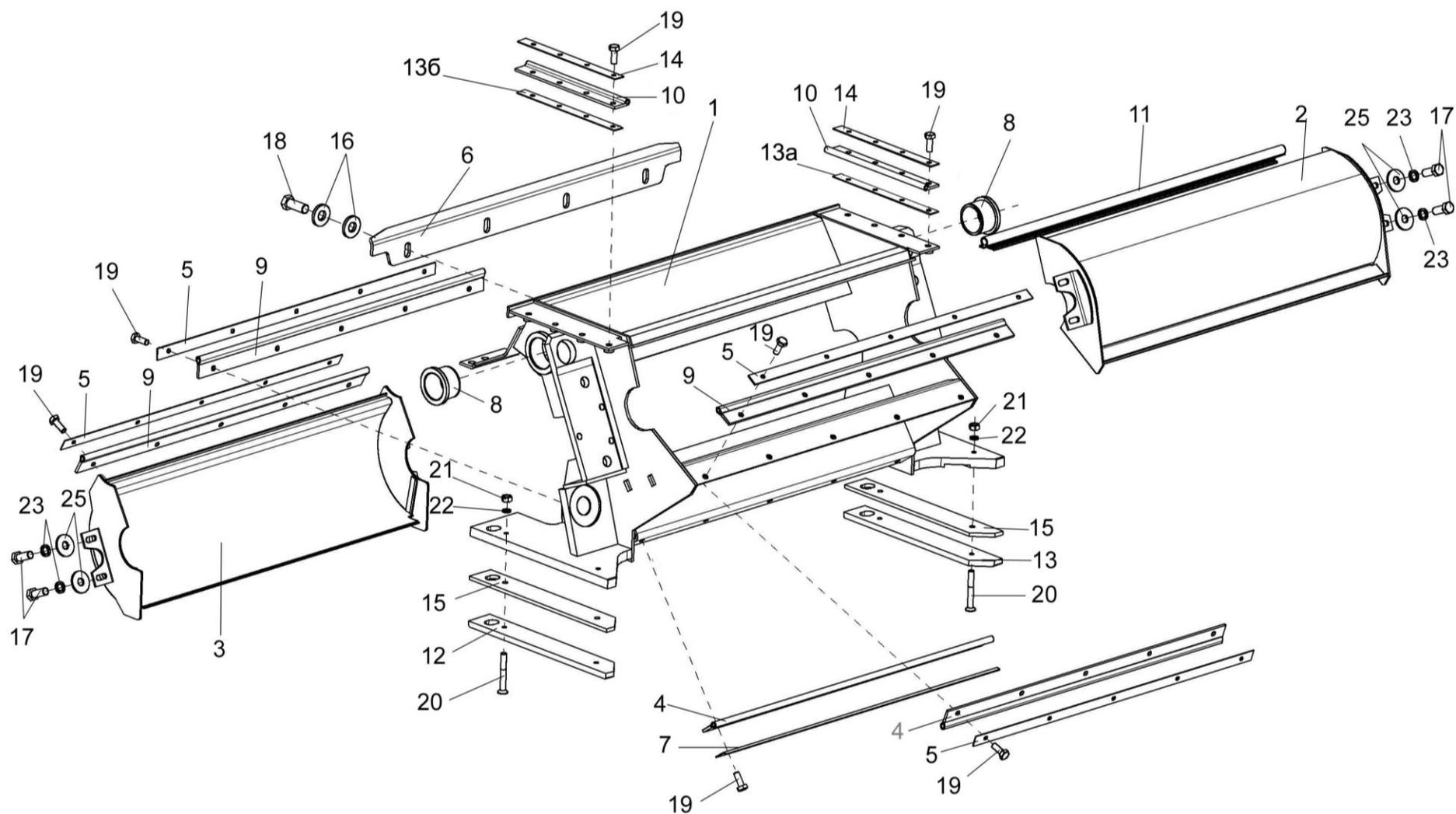
Рисунок 45 – Устройство доизмельчающее КВС-1-0148310 (установка кожухов)
