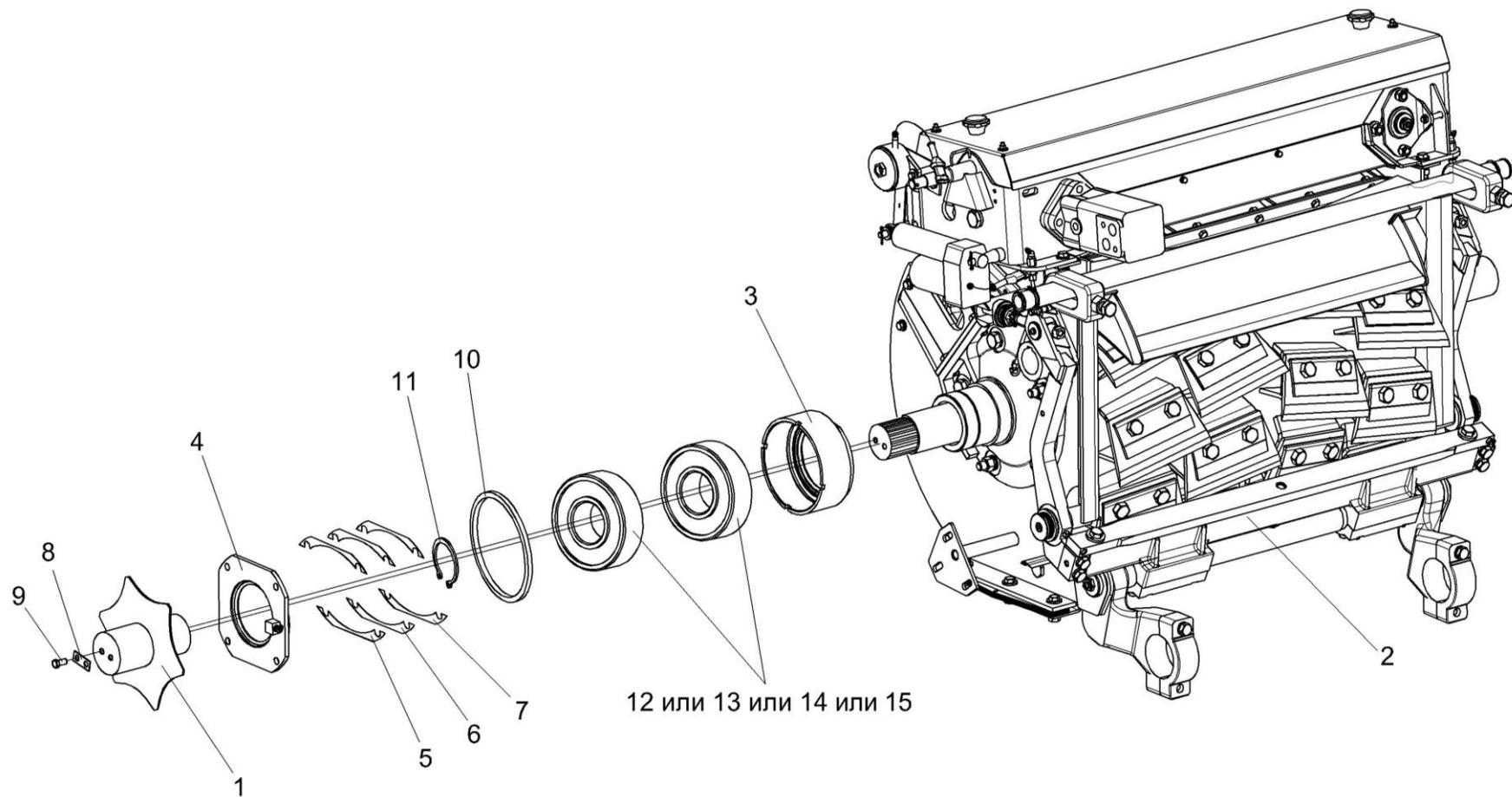
Рисунок 32 – Установка звезды КВС-2-0100460 на барабан измельчающего аппарата
