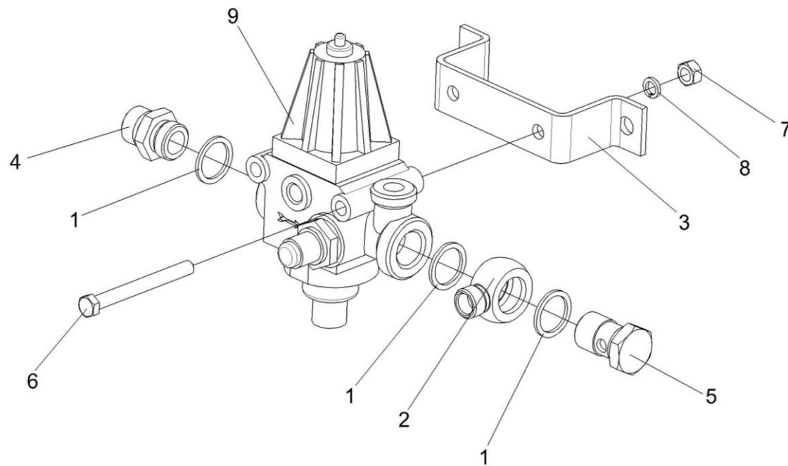
Рисунок 192 – Регулятор давления КГС 0180190
