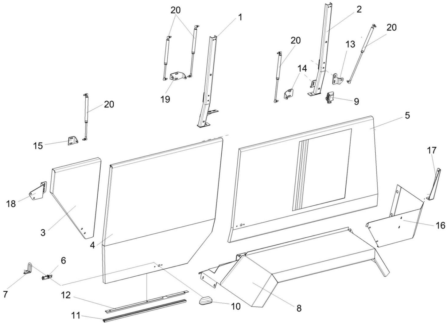
Рисунок 119 – Установка капотов КВС-2-0160000 (лист 1)
