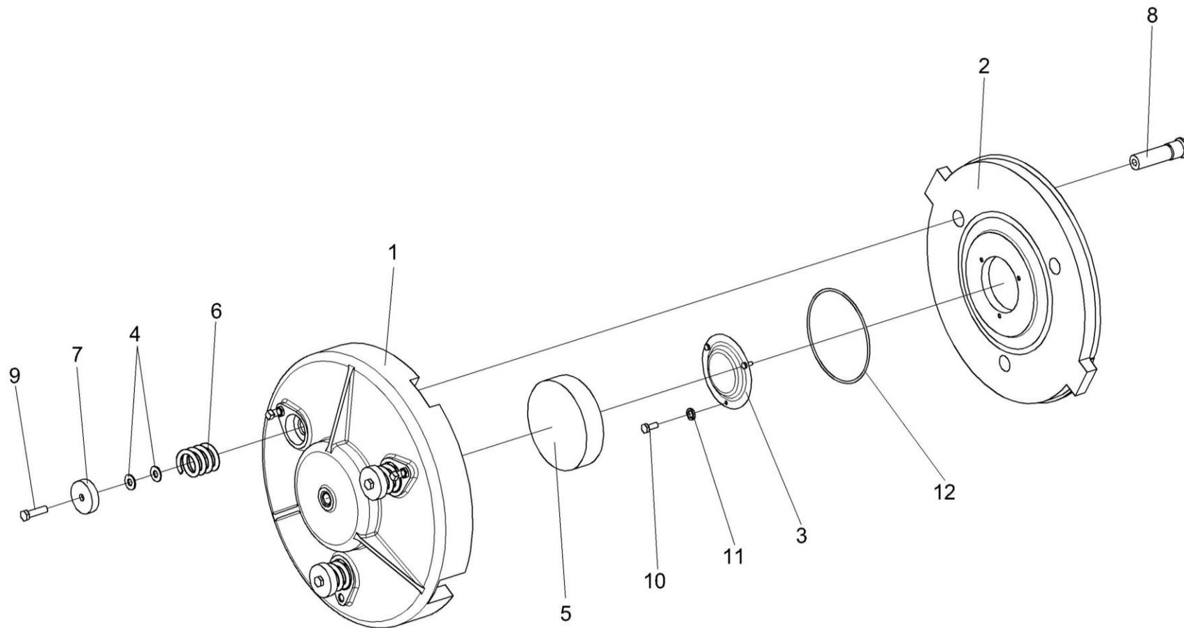
Рисунок 102 – Механизм нажимной КВС-1-0151020
