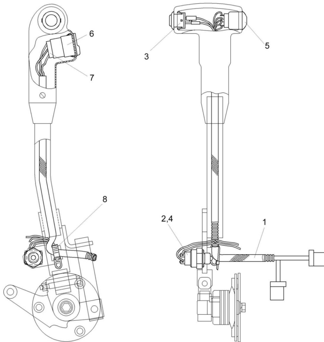
Рисунок 142 – Электрооборудование привода КВС-1-0129550А
