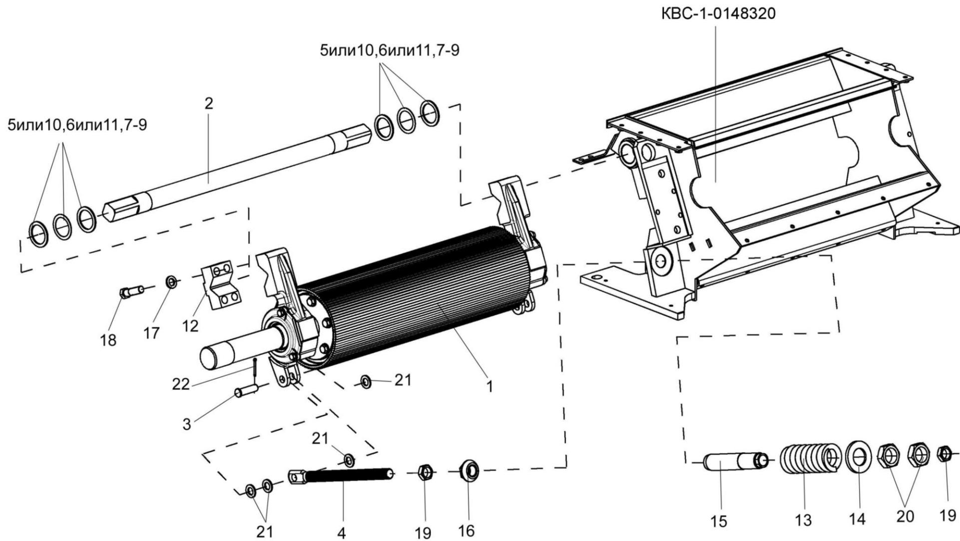
Рисунок 47 – Устройство доизмельчающее KBC-1-0148310 (установка нижнего вальца)
