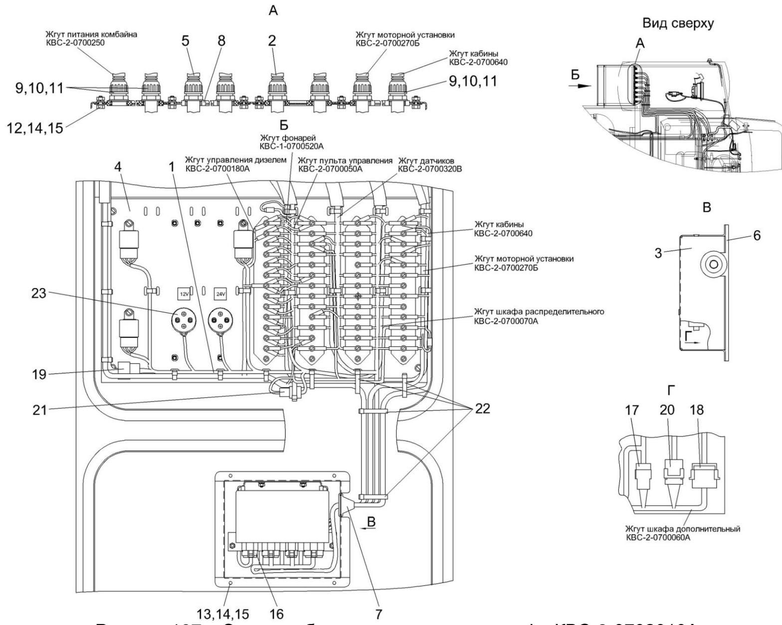
Рисунок 197 – Электрооборудование электрошкафа КВС-2-0702010А
