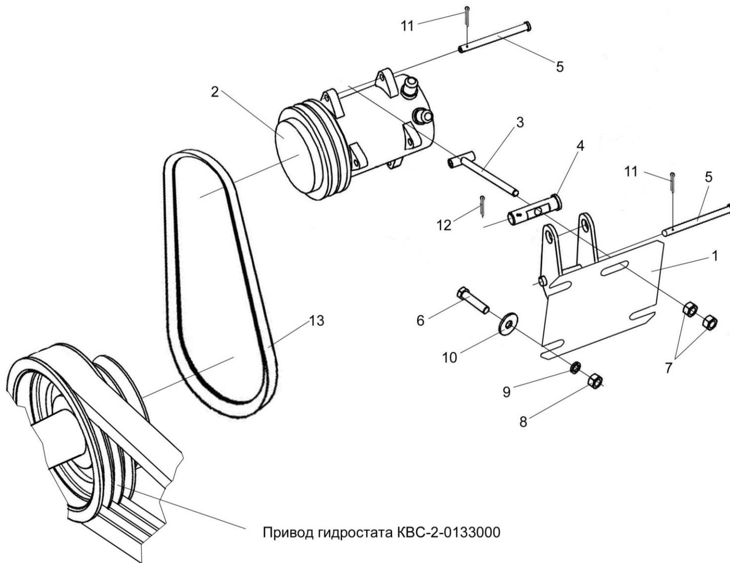
Рисунок 112 – Привод компрессора кондиционера КВС-1-0150100А
