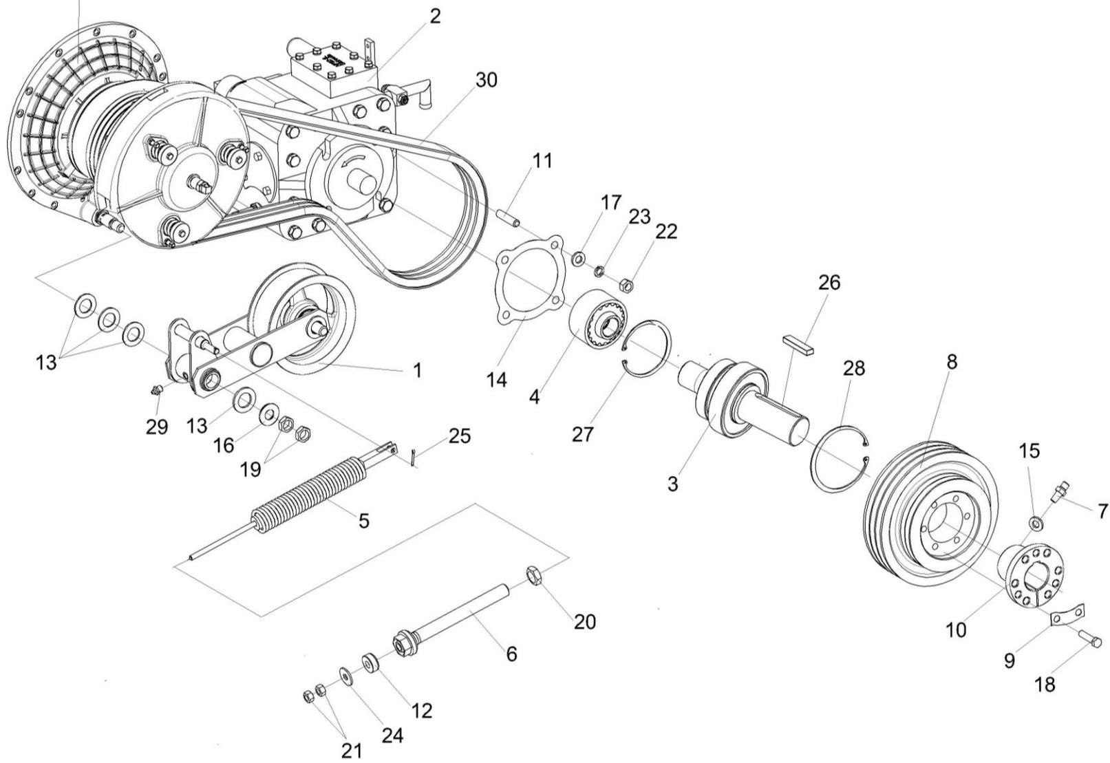
Рисунок 114 – Привод гидростата КВС-2-0133000
