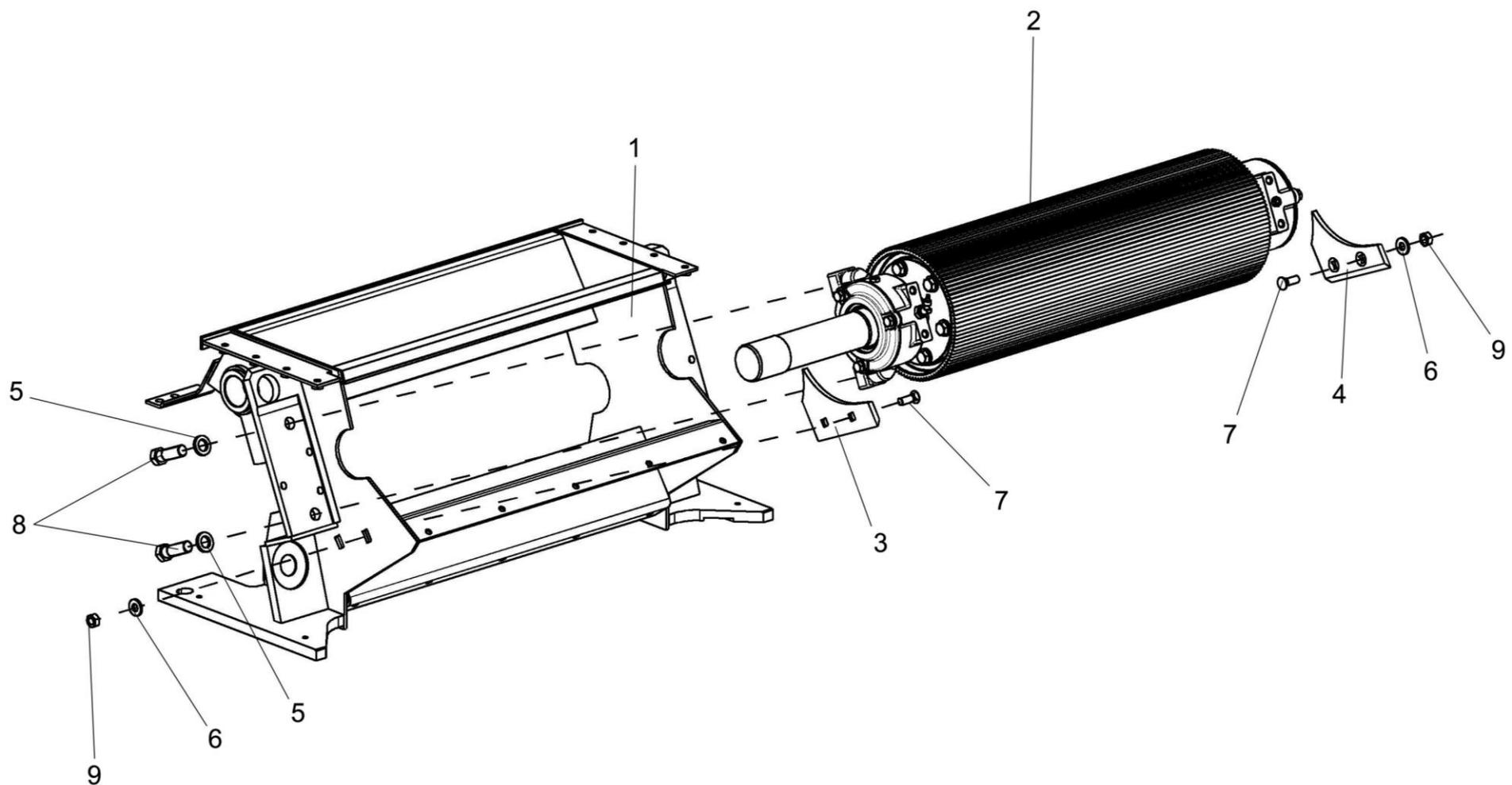
Рисунок 46 – Устройство доизмельчающее КВС-1-0148310 (установка верхнего вальца)
