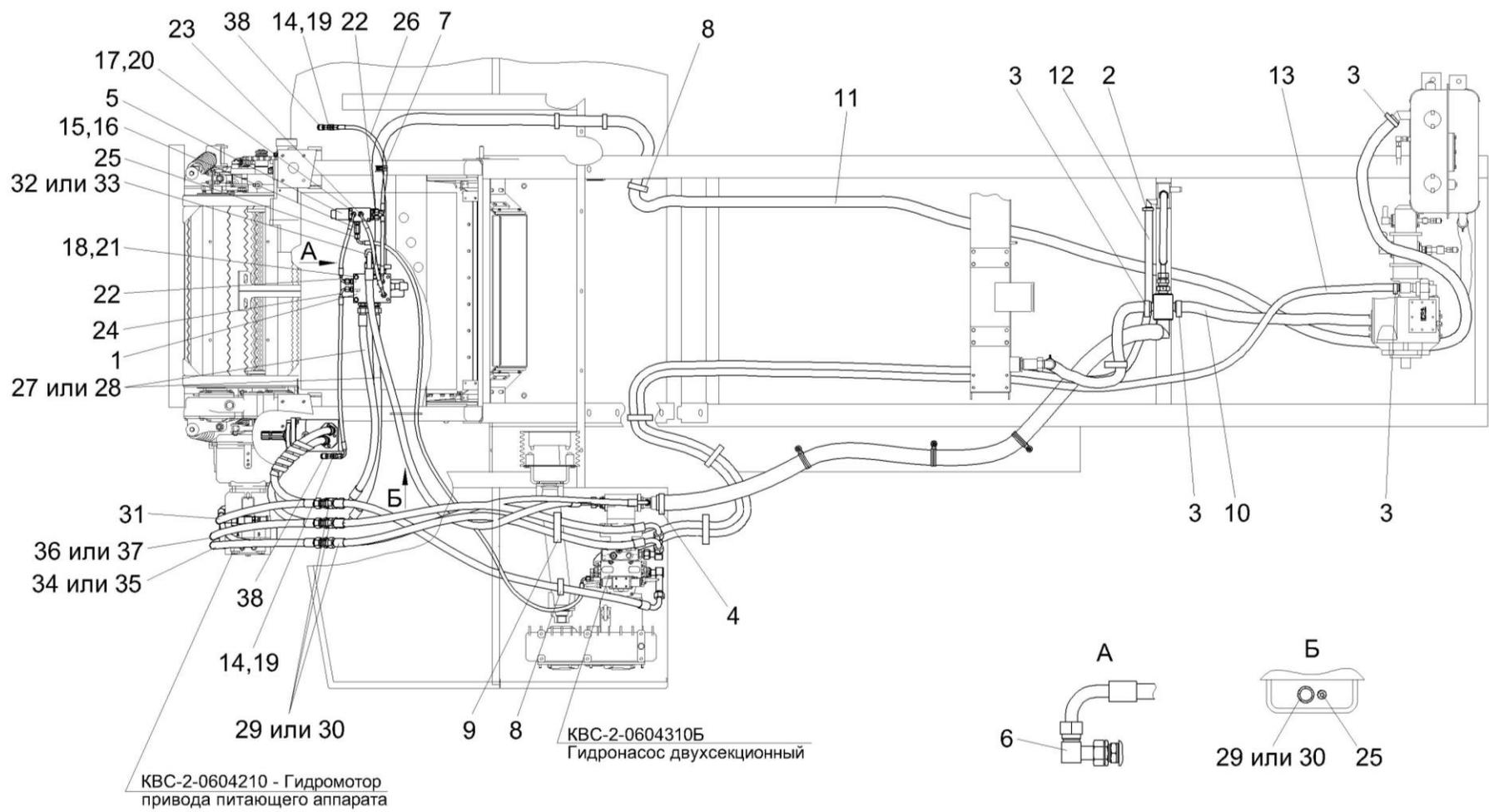
Рисунок 186 – Гидросистема привода питающего аппарата и адаптеров КВС-2-0604000Б (вид сверху)
