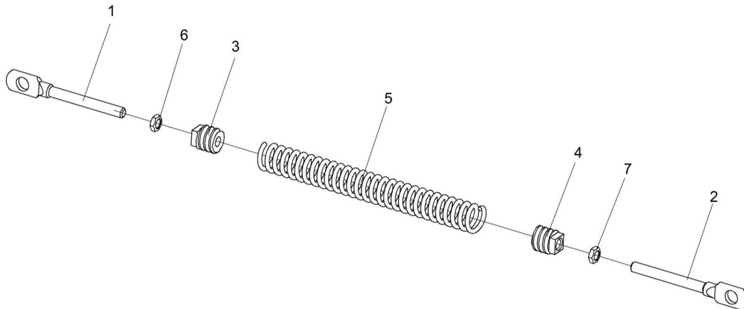
Рисунок 98 – Механизм натяжения КВС-2-0150120
