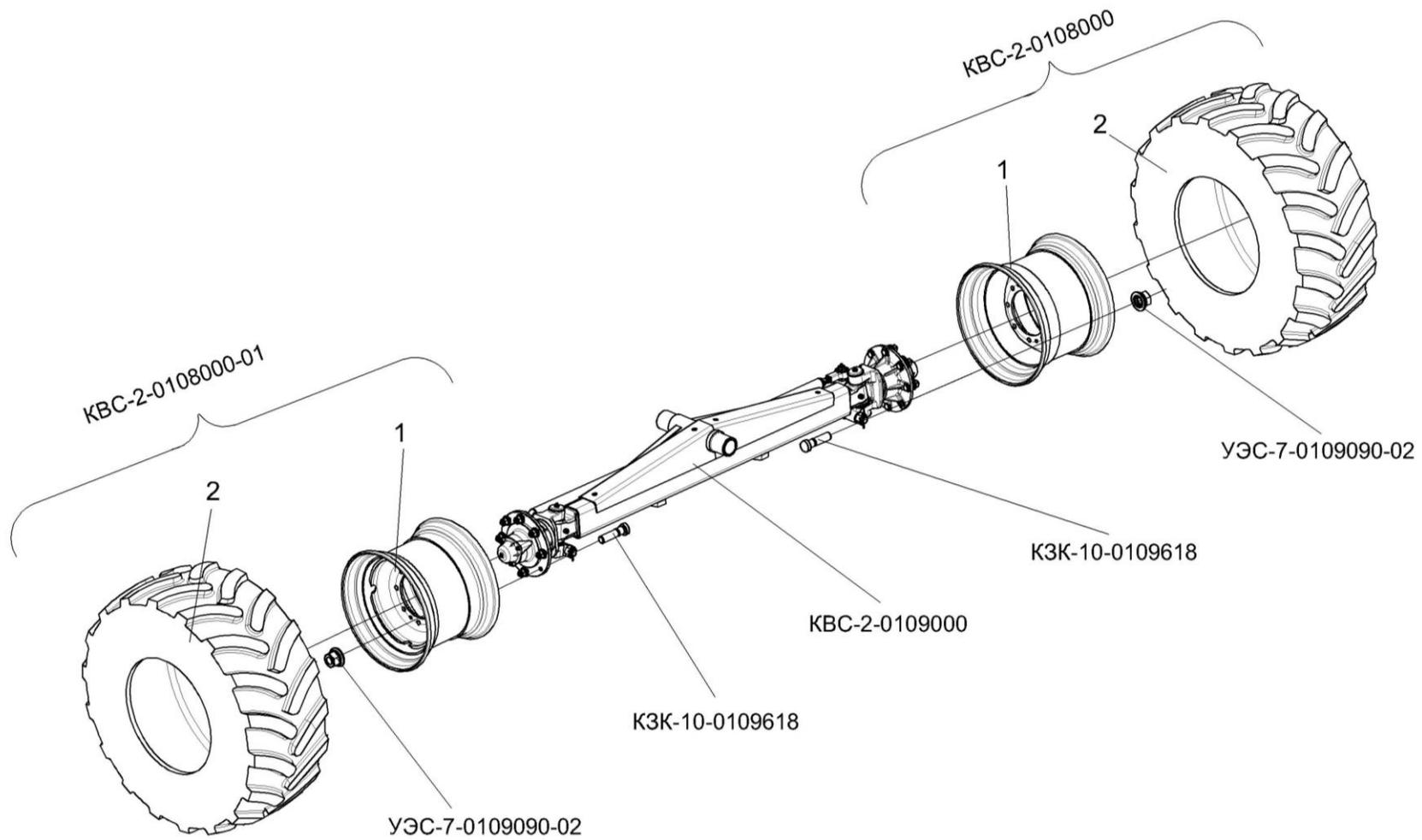
Рисунок 88 – Установка колес KBC-2-0108000 и KBC-2-0108000-01
