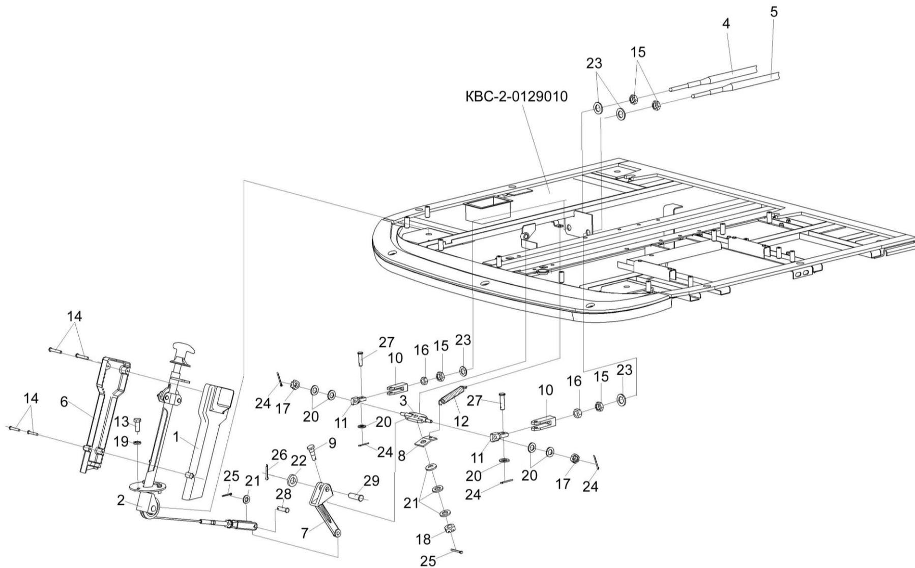
Рисунок 153 – Установка колонки привода УЭС 0300710
