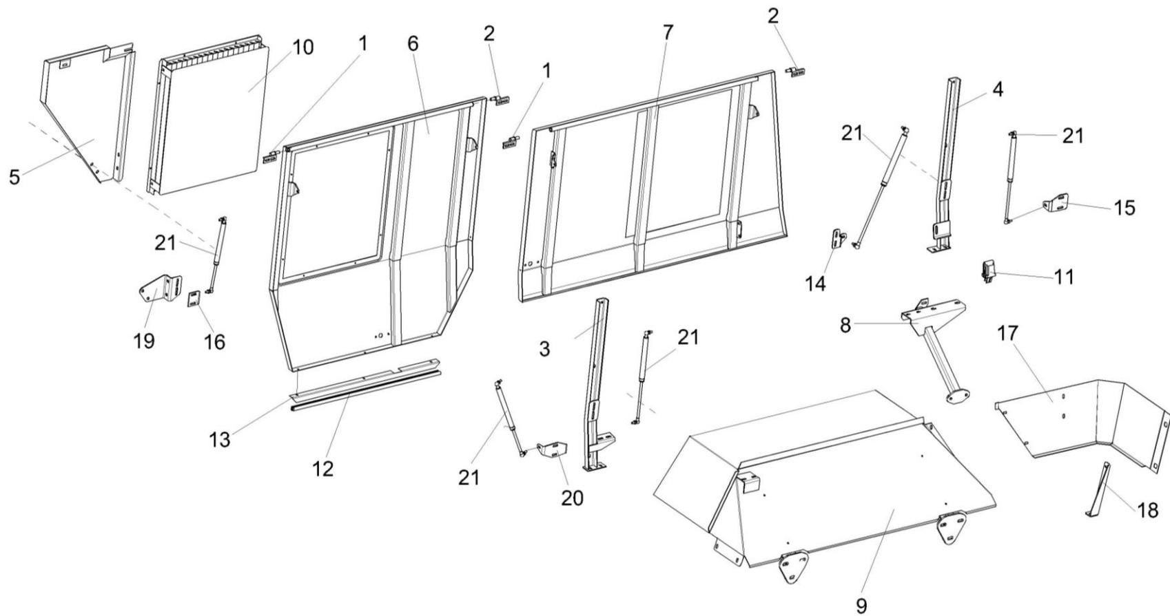
Рисунок 120 – Установка капотов КВС-2-0160000 (лист 2)
