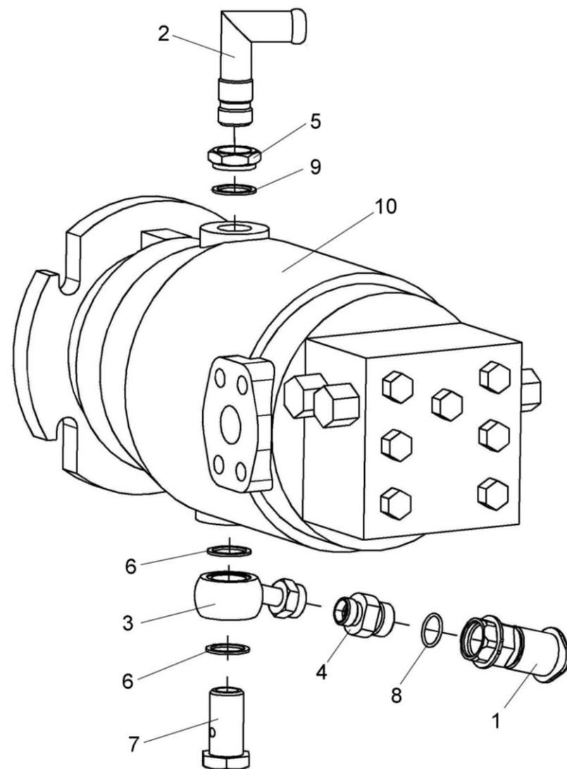
Рисунок 169 – Гидромотор КВС-1-0601210
