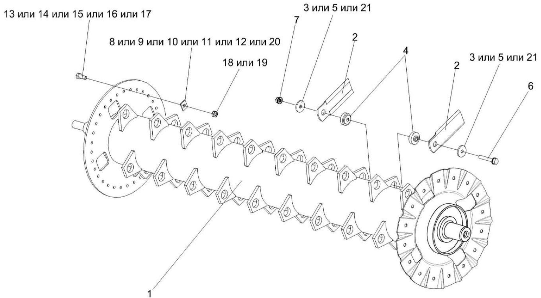
Рисунок 133 – Ротор измельчителя КЗК-10-0290140А
