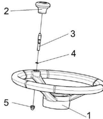
Рисунок 173 – Колесо рулевое КЗК-12-0122300
