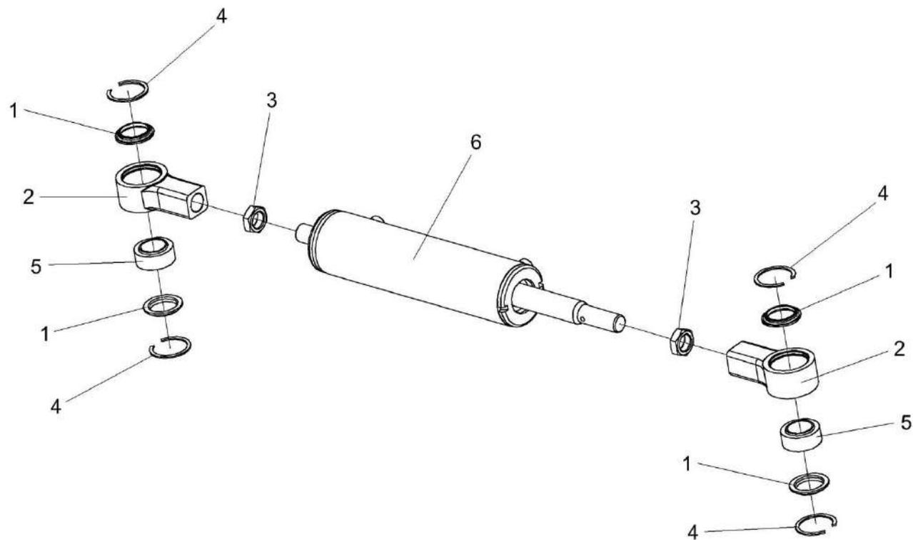
Рисунок 94 – Гидроцилиндр УЭС-7-0109200
