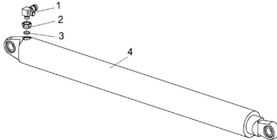
Рисунок 268 – Гидроцилиндр КЗК-12-0602740-01
