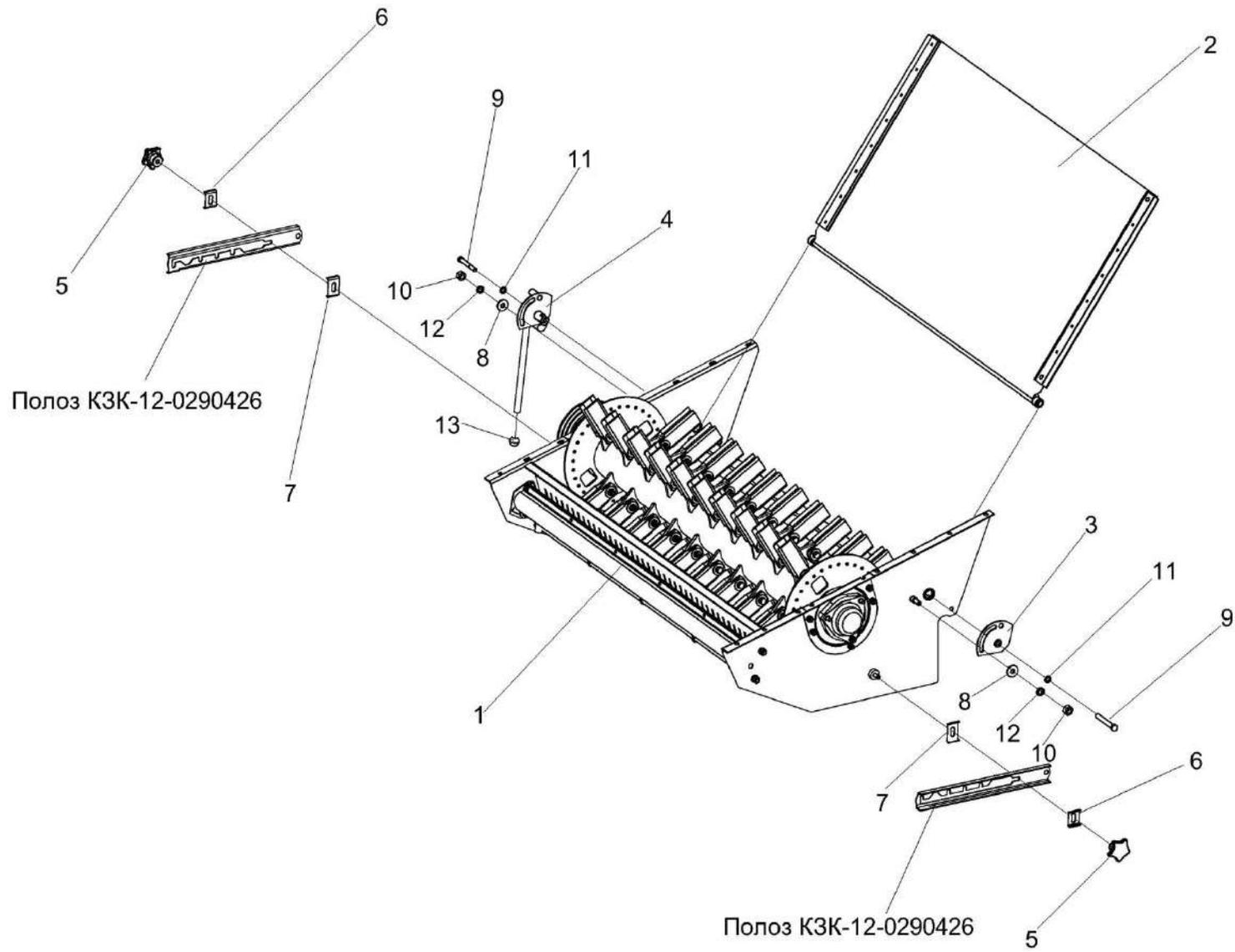
Рисунок 130 – Установка соломоизмельчителя КЗК-10-0290600 (лист 2)
