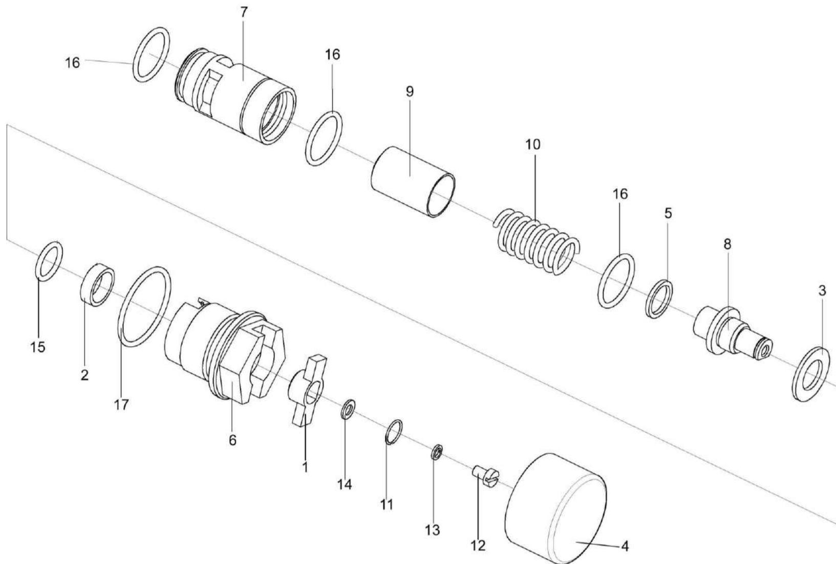
Рисунок 262 – Клапан-сигнализатор УЭС 0603660-01
