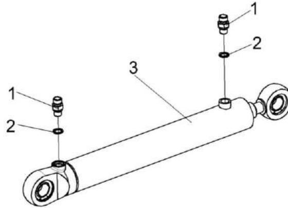
Рисунок 271 – Гидроцилиндр КЗК-10-0602500
