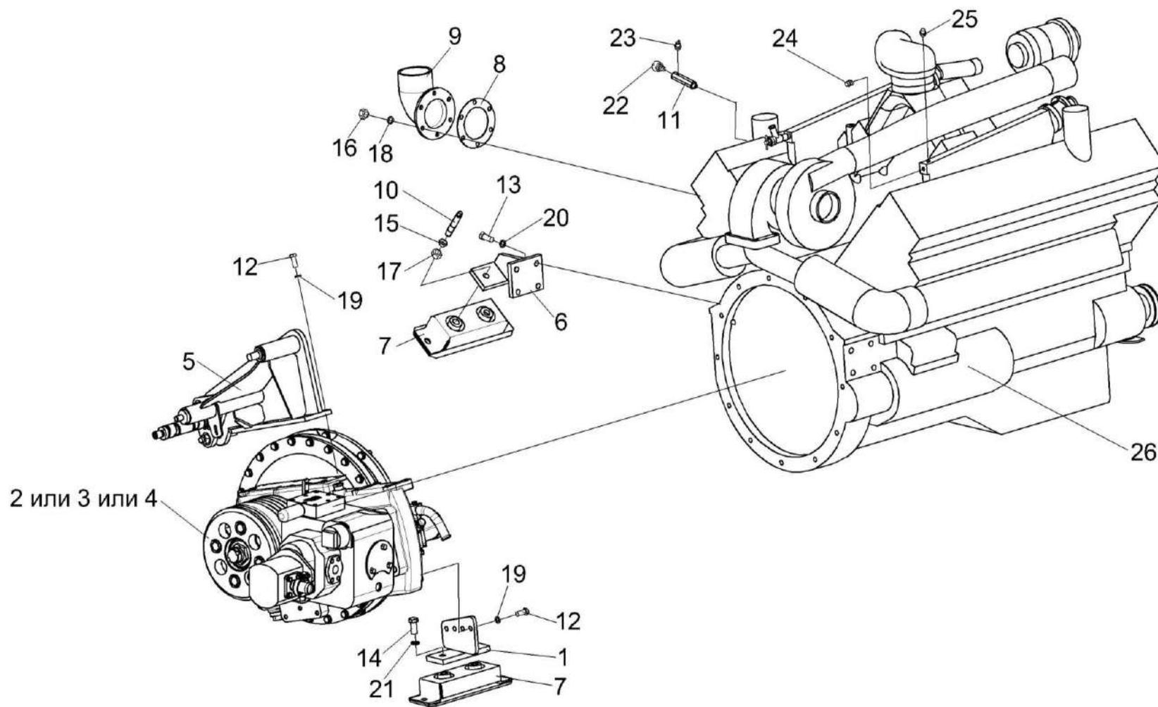
Рисунок 201 – Двигатель КЗК-12-3-0106010А-01 (лист 2)
