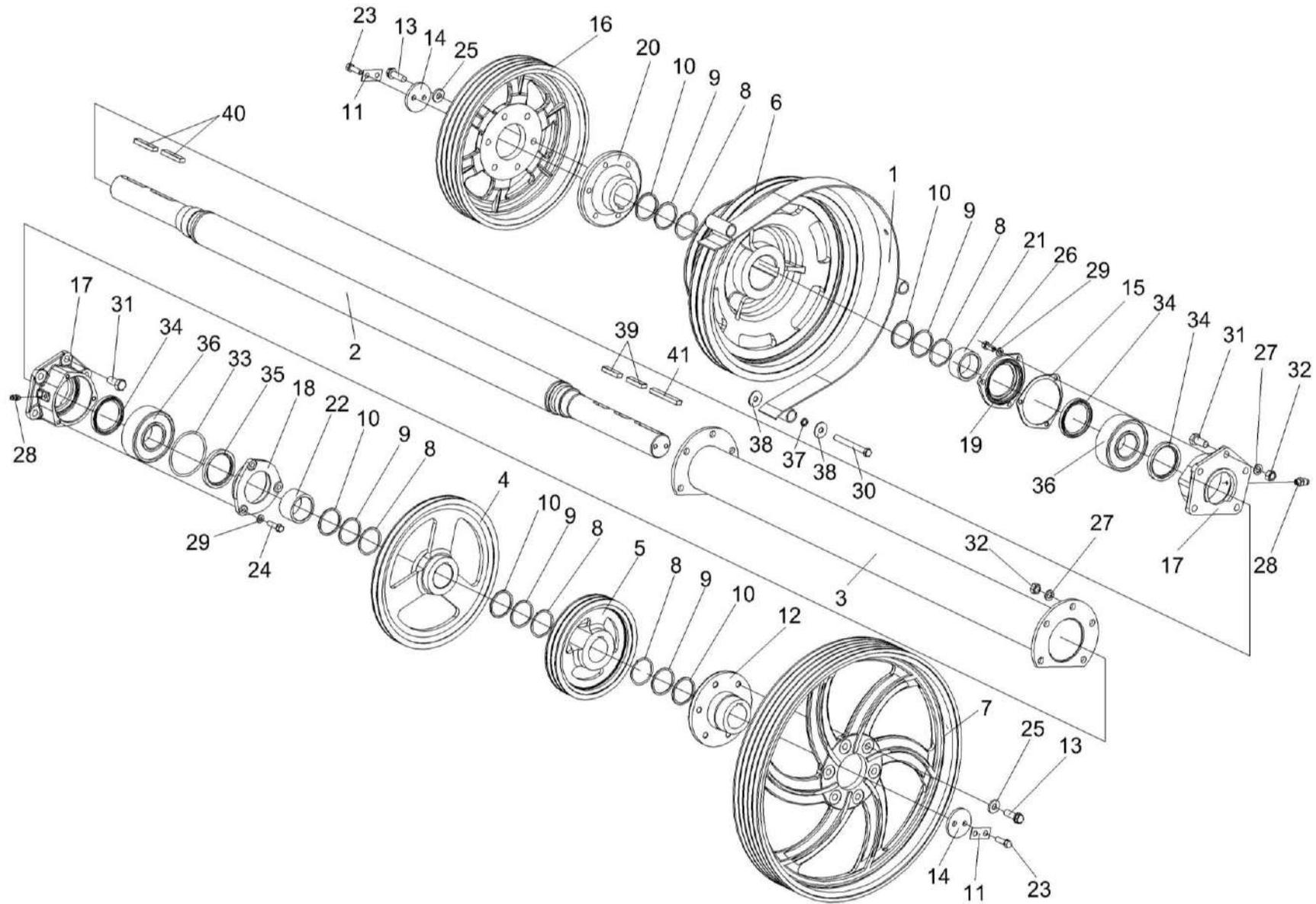
Рисунок 34 – Установка шкивов КЗК-12-0202860А-01 и КЗК-10-0202010-01
