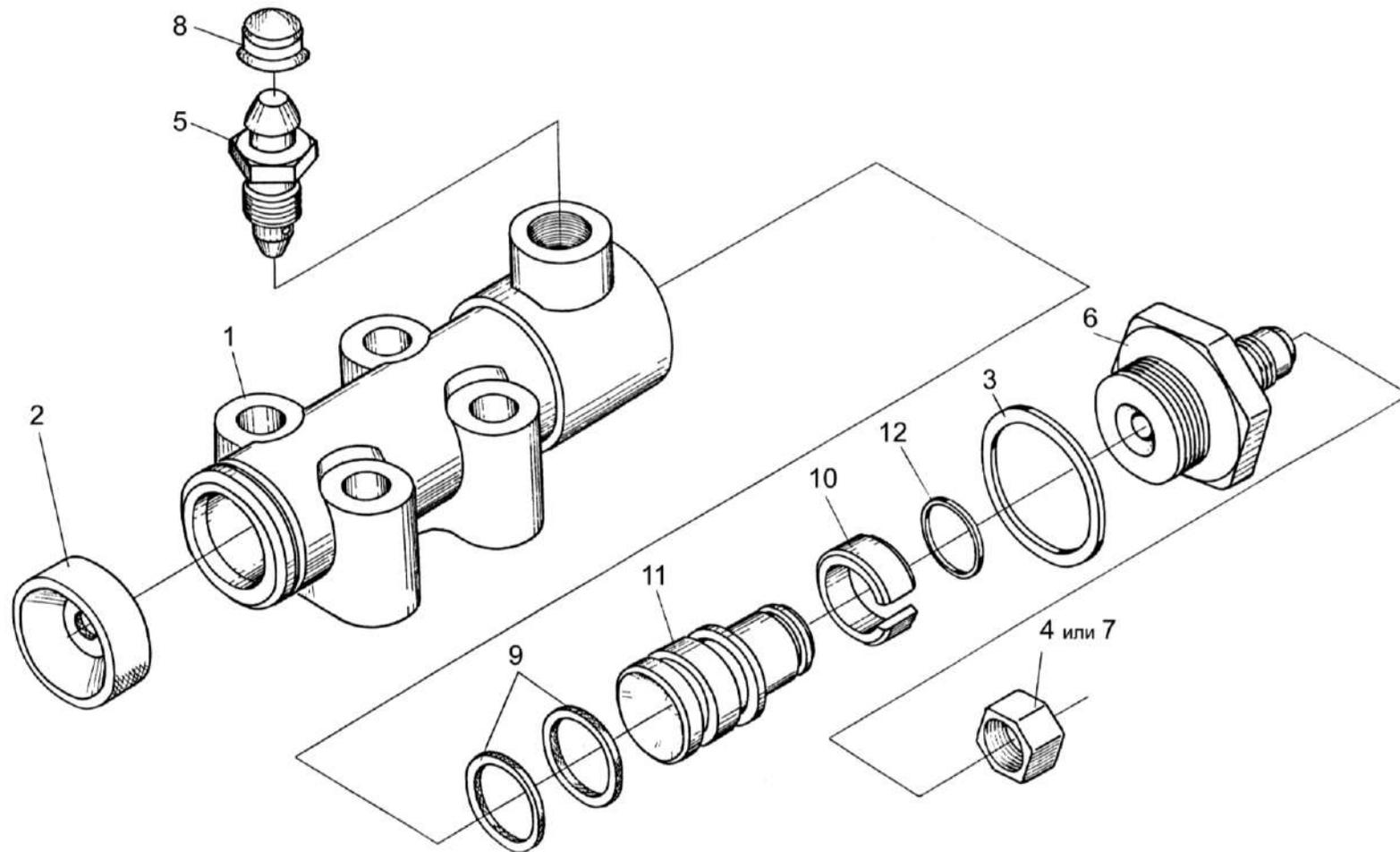
Рисунок 84 – Гидроцилиндр тормоза МК-23М.03.220А
