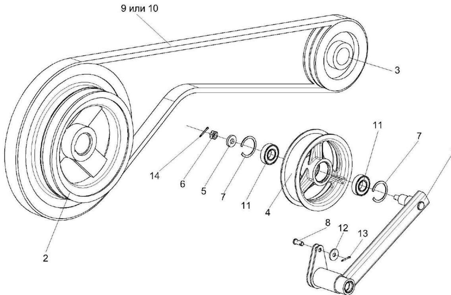
Рисунок 51 – Установка рычага КЗК 0202430В
