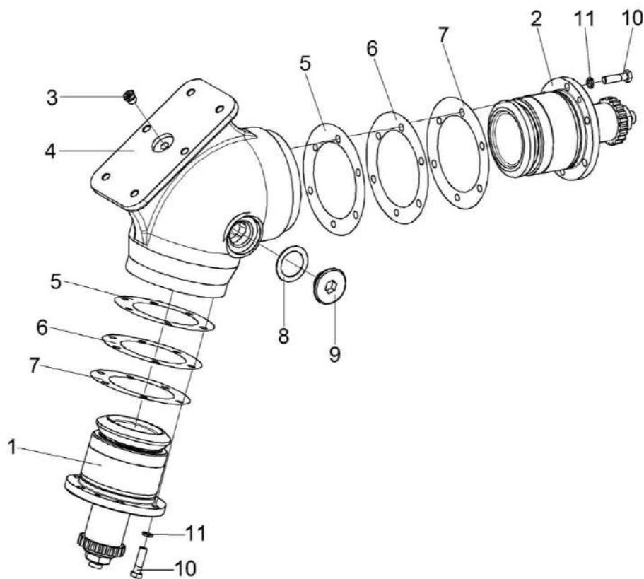
Рисунок 115 – Редуктор КЗК-12-0210000А
