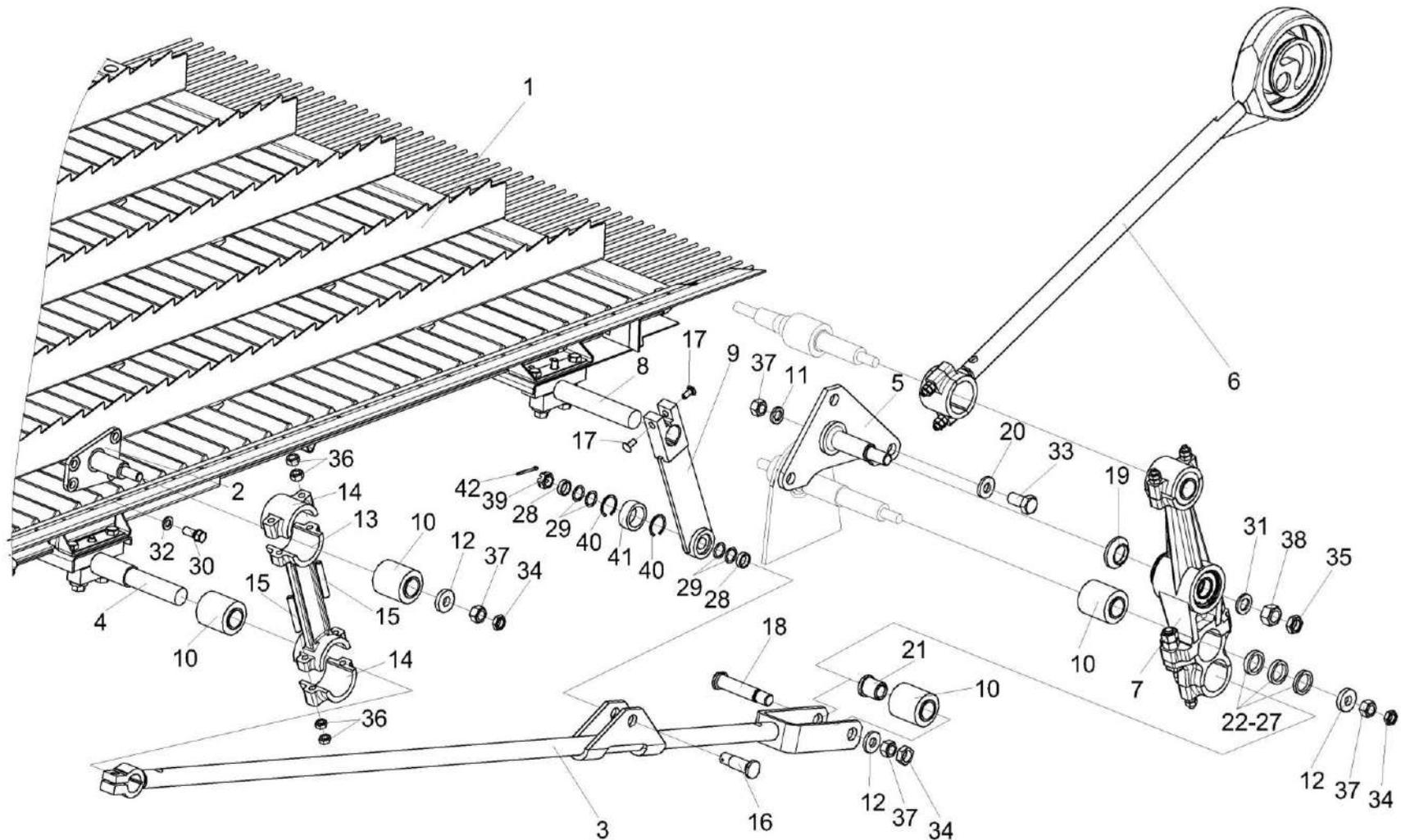
Рисунок 41 – Установка привода доски стрясной КЗК-12-0280200 (вид слева)
