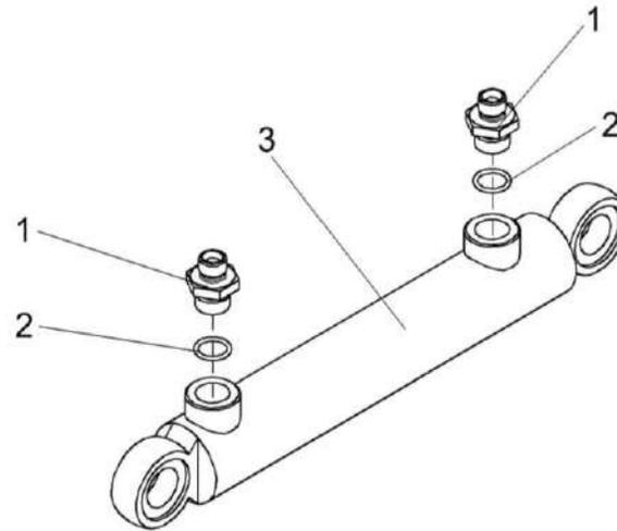
Рисунок 258 – Гидроцилиндр КЗК-12-0602310
