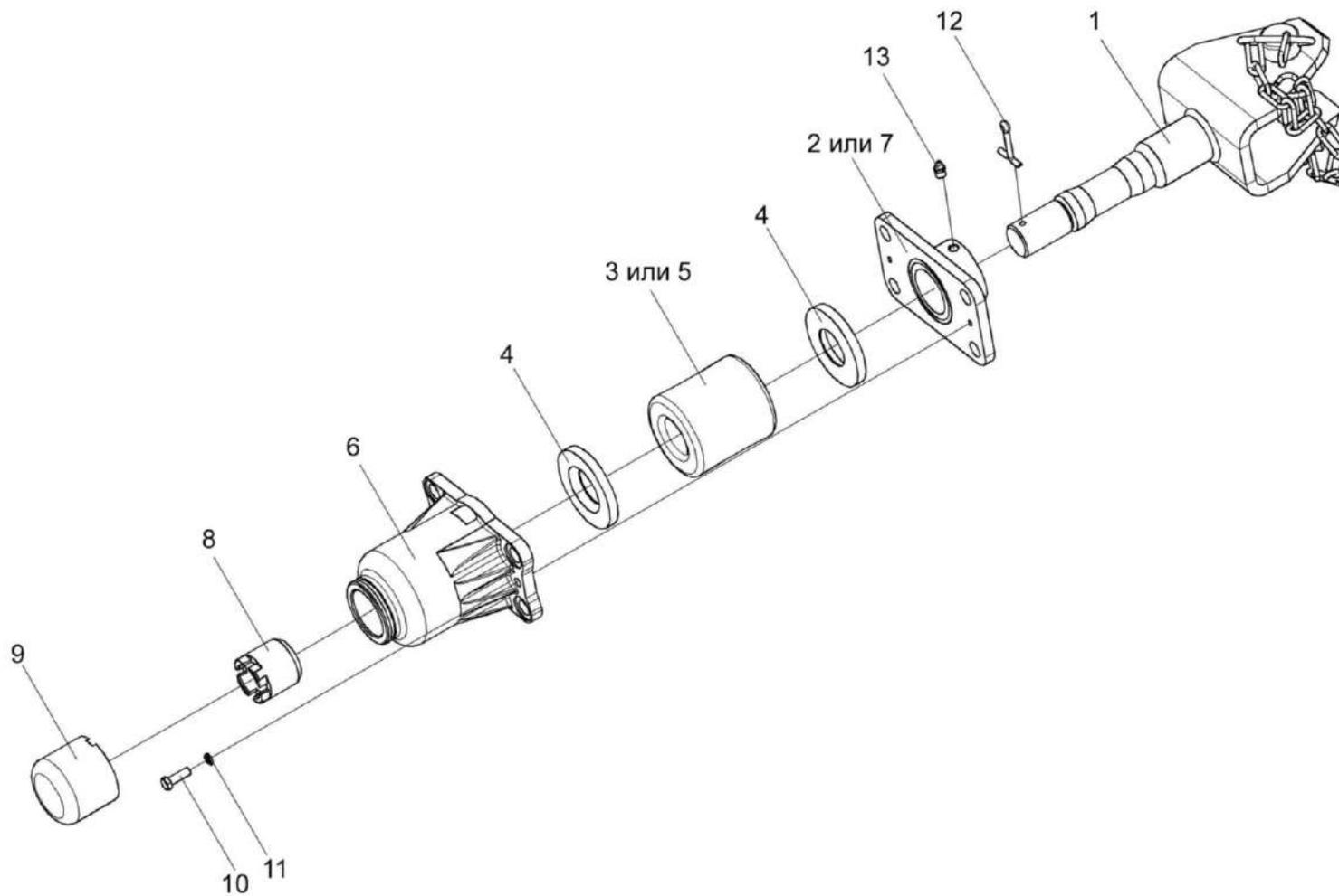
Рисунок 101 – Устройство прицепное КИС 0122000А
