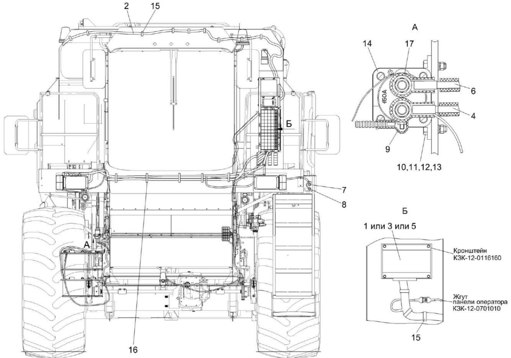
Рисунок 9 – Электрооборудование молотилки самоходной КЗК-12-0100000Б-12 (лист 4)
