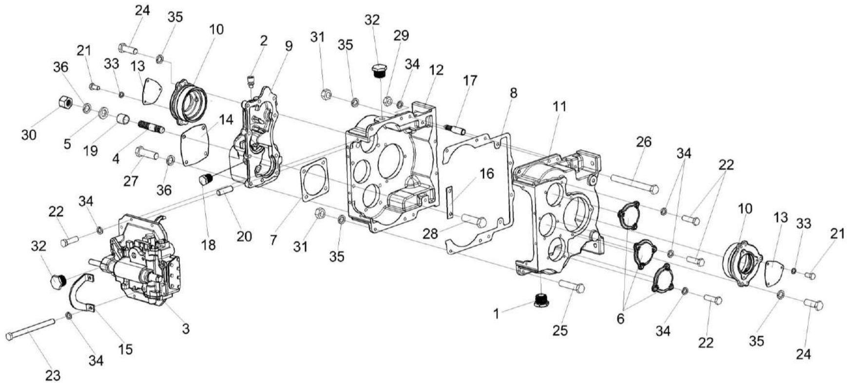
Рисунок 85 – Коробка передач КЗК-12-0107530 (корпус, крышки)
