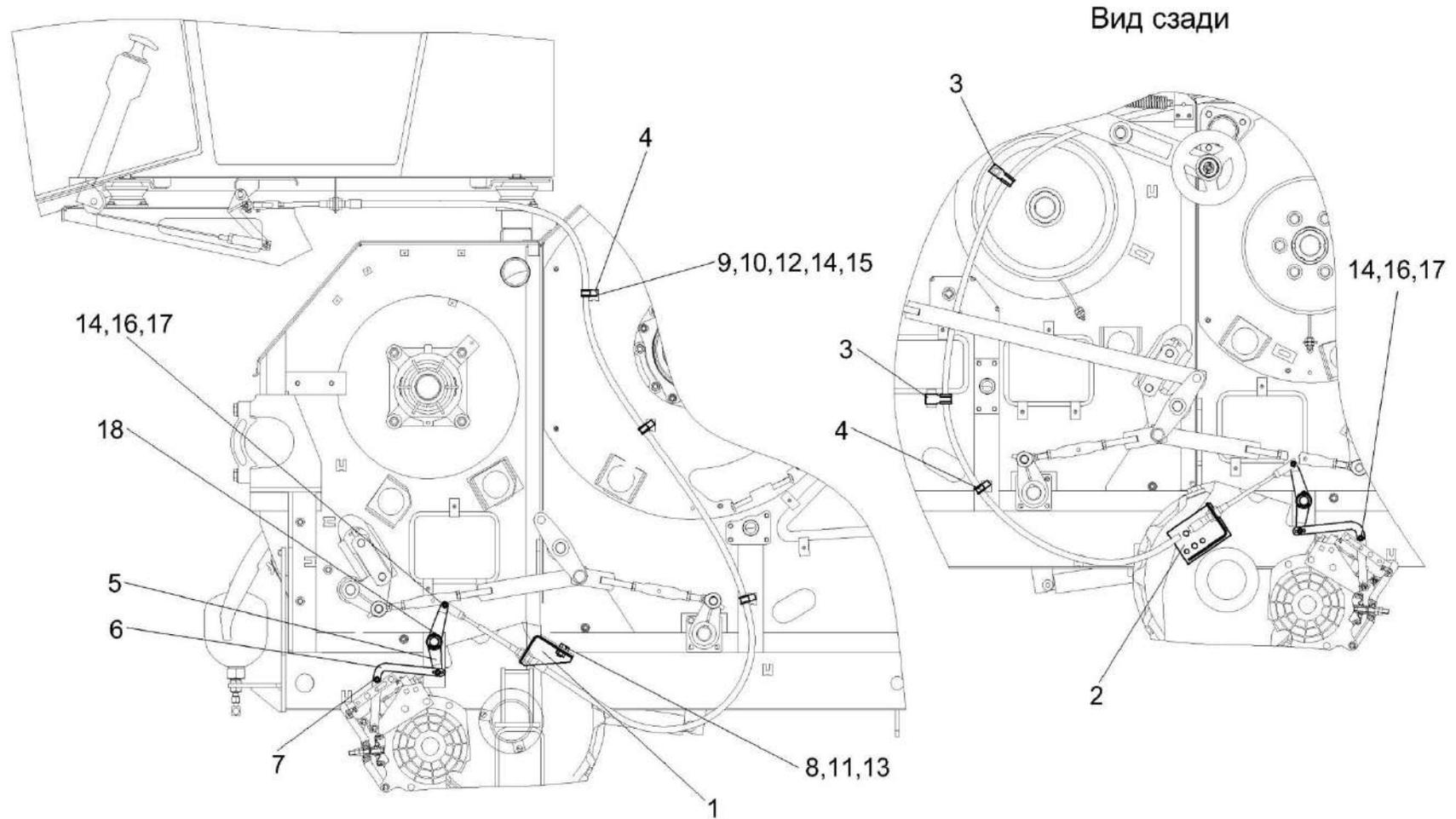
Рисунок 180 – Установка тросов управления стояночным тормозом КЗК-12-0119610
