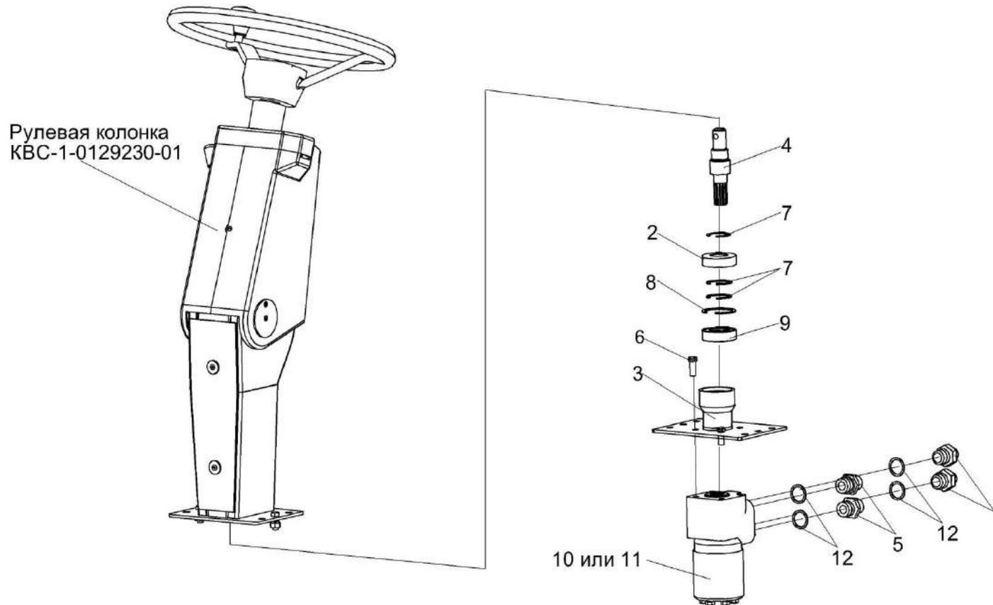
Рисунок 169 – Установка насоса-дозатора КЗК-10-0602090
