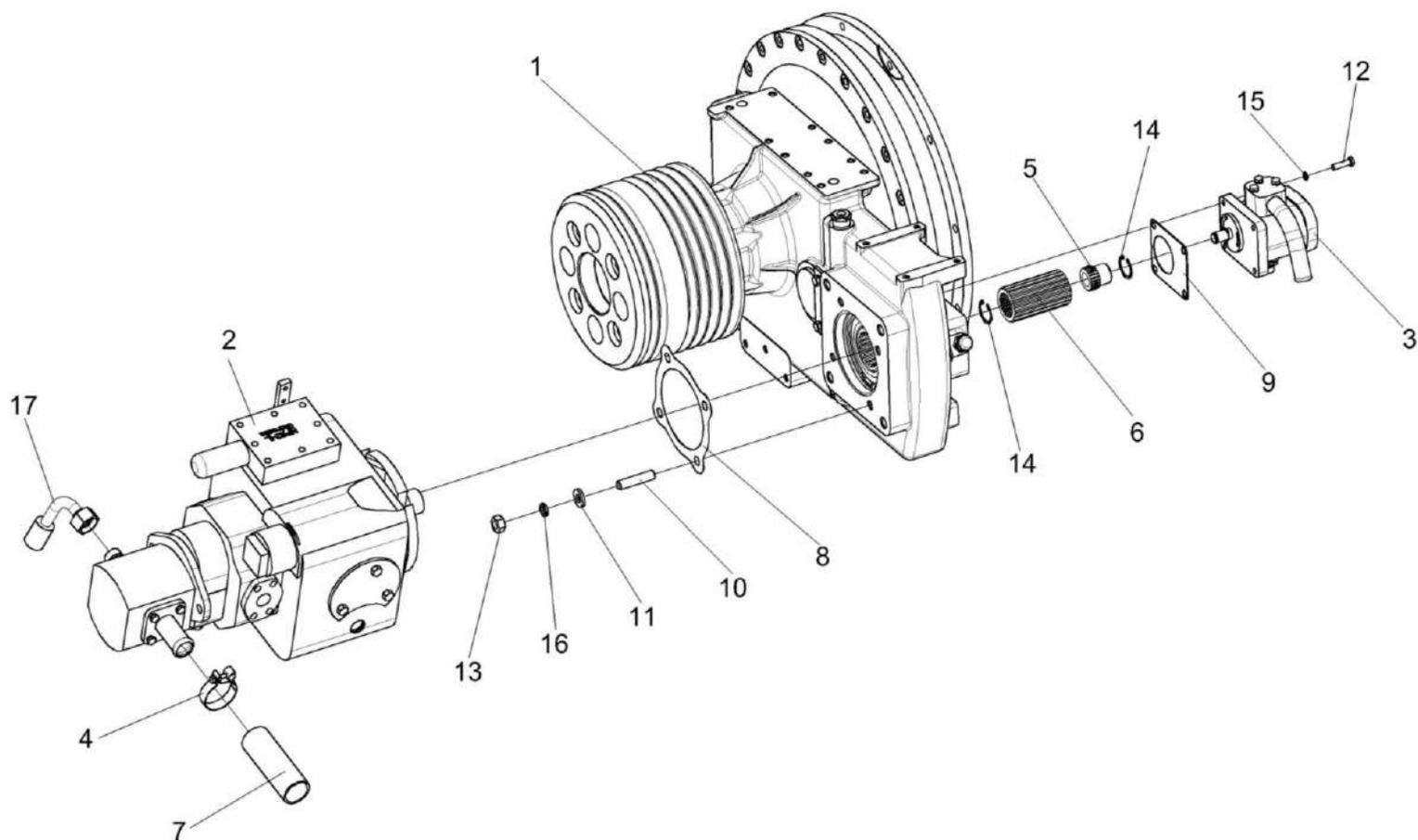
Рисунок 206 – Установка гидронасосов КЗК-12-3-0106750
