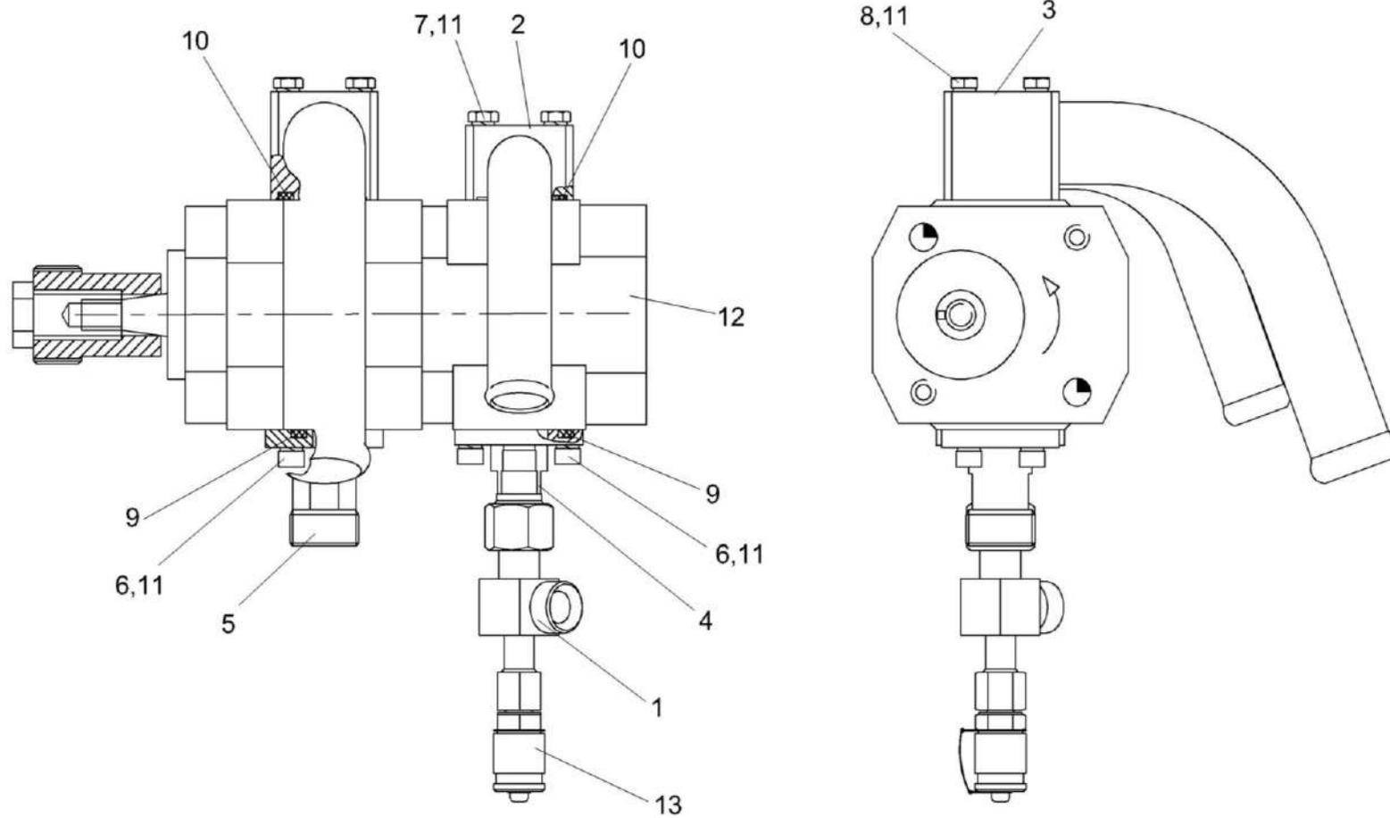
Рисунок 203 – Гидронасос двухсекционный КЗК-12-0602910А
