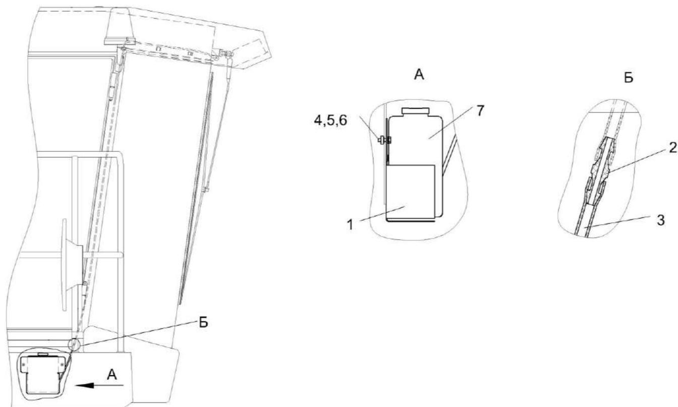
Рисунок 197 – Установка стеклоомывателя КЗК-12-0120460
