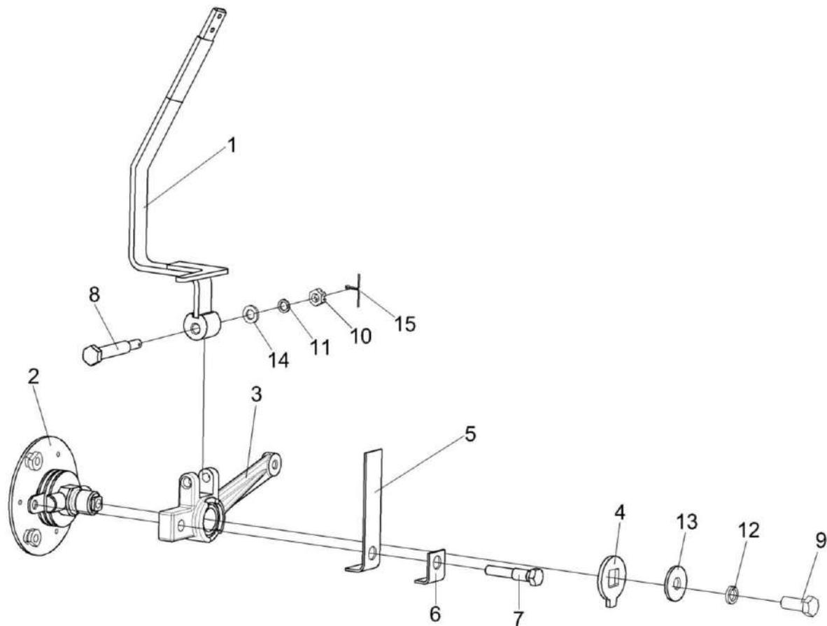
Рисунок 164 – Рычаг КЗК-12-0119440Б
