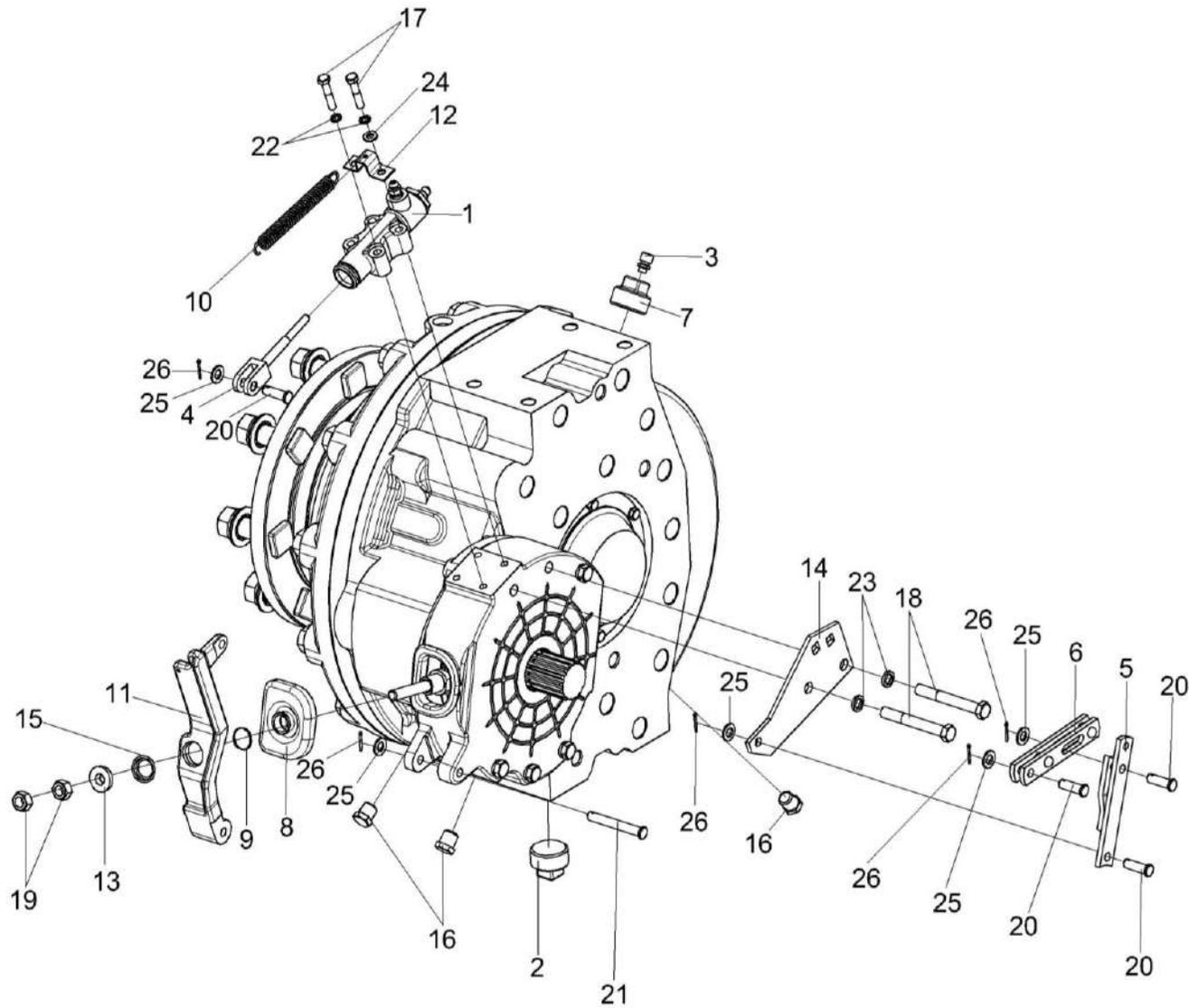
Рисунок 77 – Редуктор бортовой КЗК-10-0107200 (лист 1)
