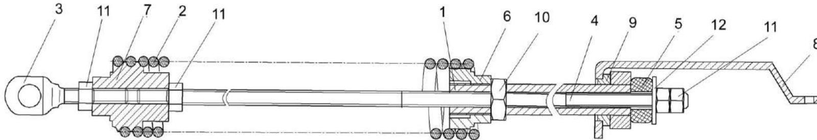
Рисунок 243 – Пружина КЗК-10-0100580
