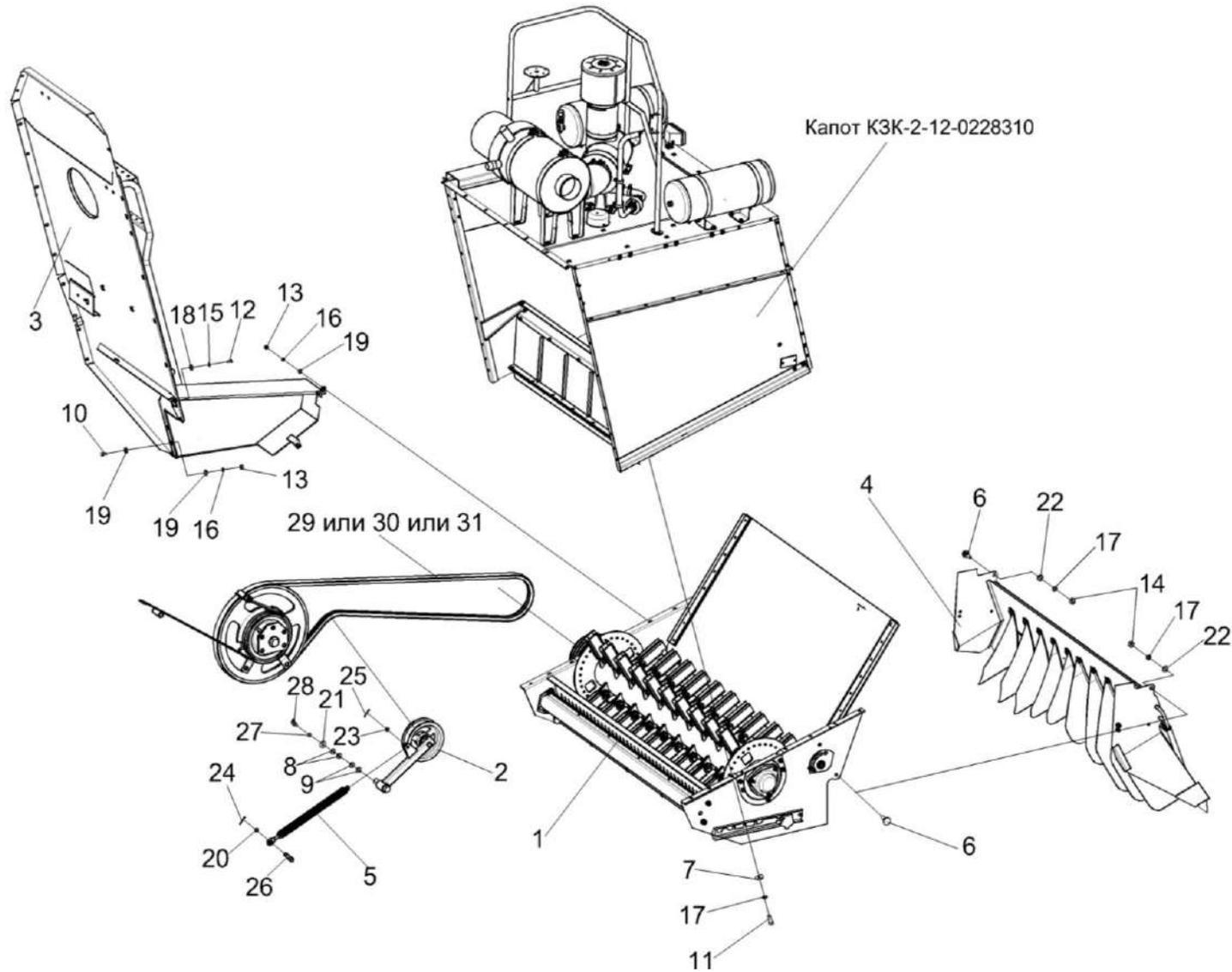
Рисунок 129 – Установка соломоизмельчителя КЗК-10-0290600 (лист 1)
