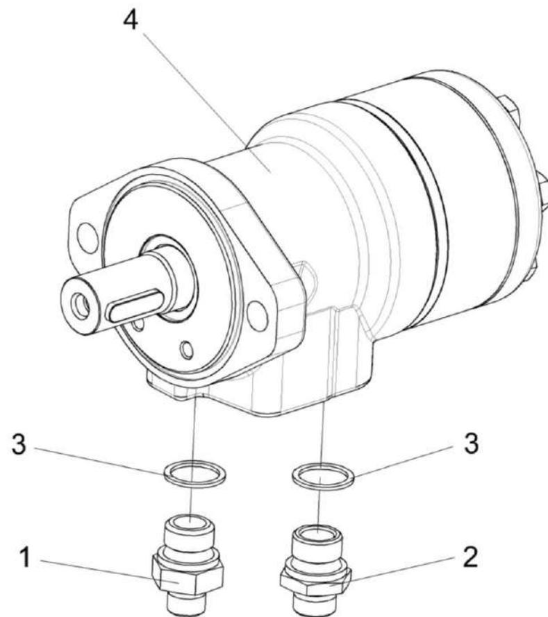
Рисунок 21 – Гидромотор КЗК-12-1790990А
