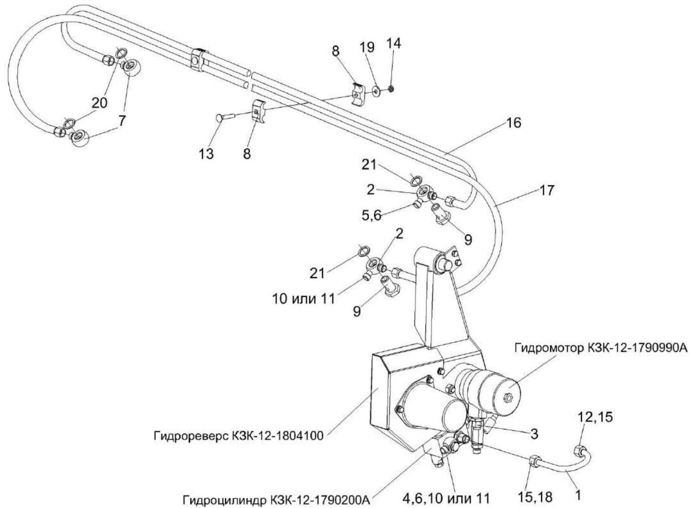
Рисунок 28 – Система гидравлическая камеры наклонной КЗК-12-1790000А
