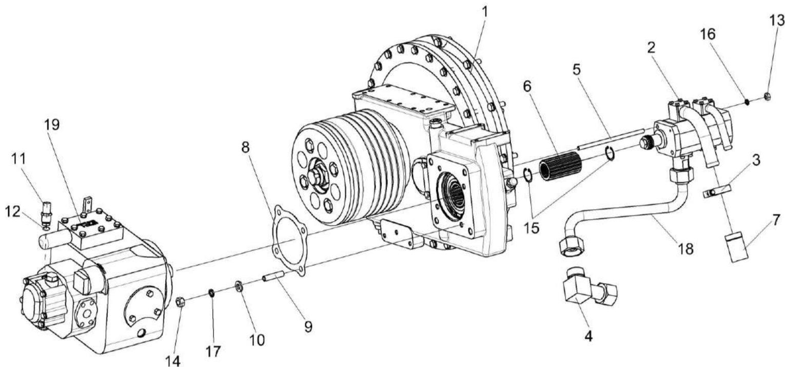
Рисунок 204 – Установка гидронасосов КЗК-12-3-0106740
