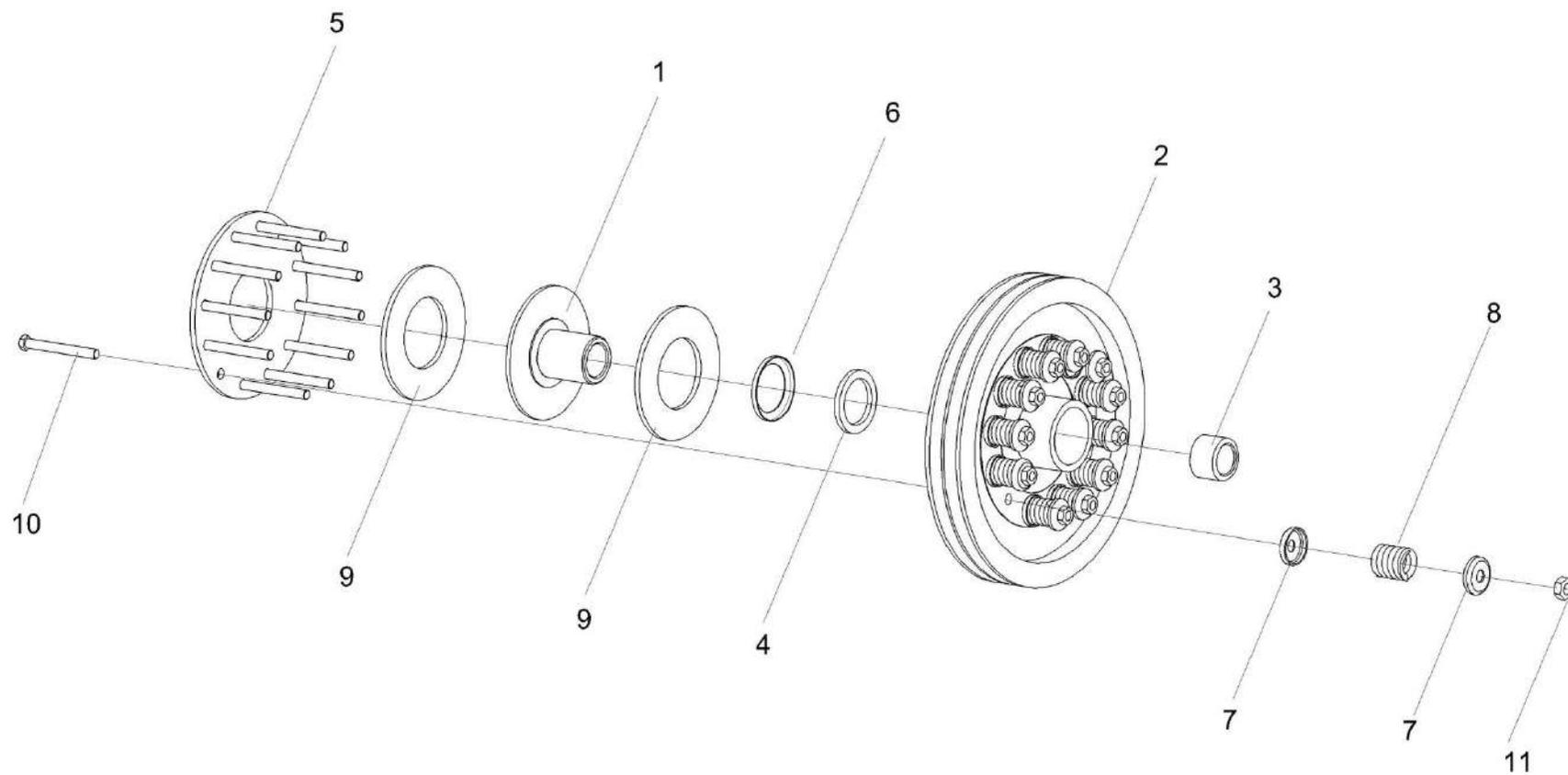
Рисунок 123 – Муфта фрикционная КЗК-10-0219100
