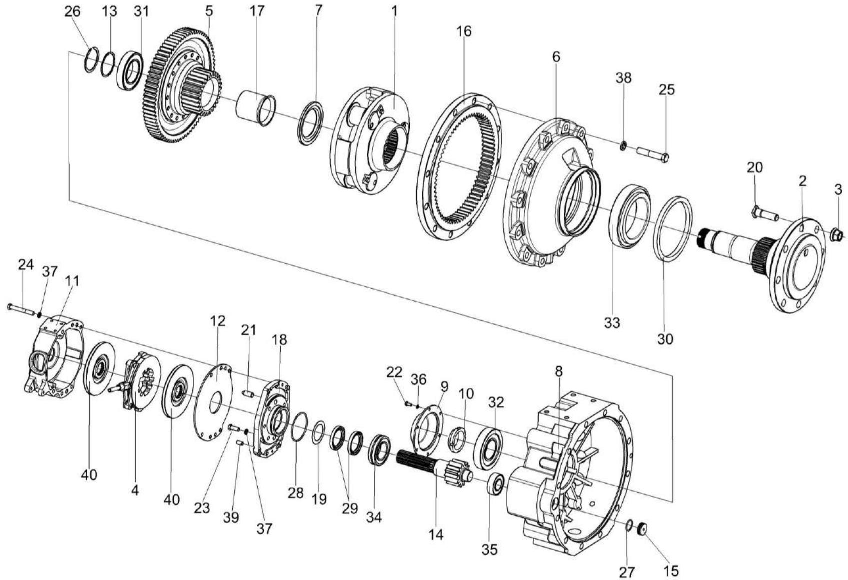
Рисунок 80 – Редуктор бортовой КЗК-10-0107200-04 (лист 2)
