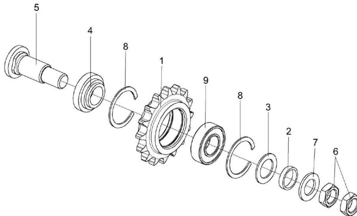
Рисунок 112 – Звездочка КЗР 0219070Б
