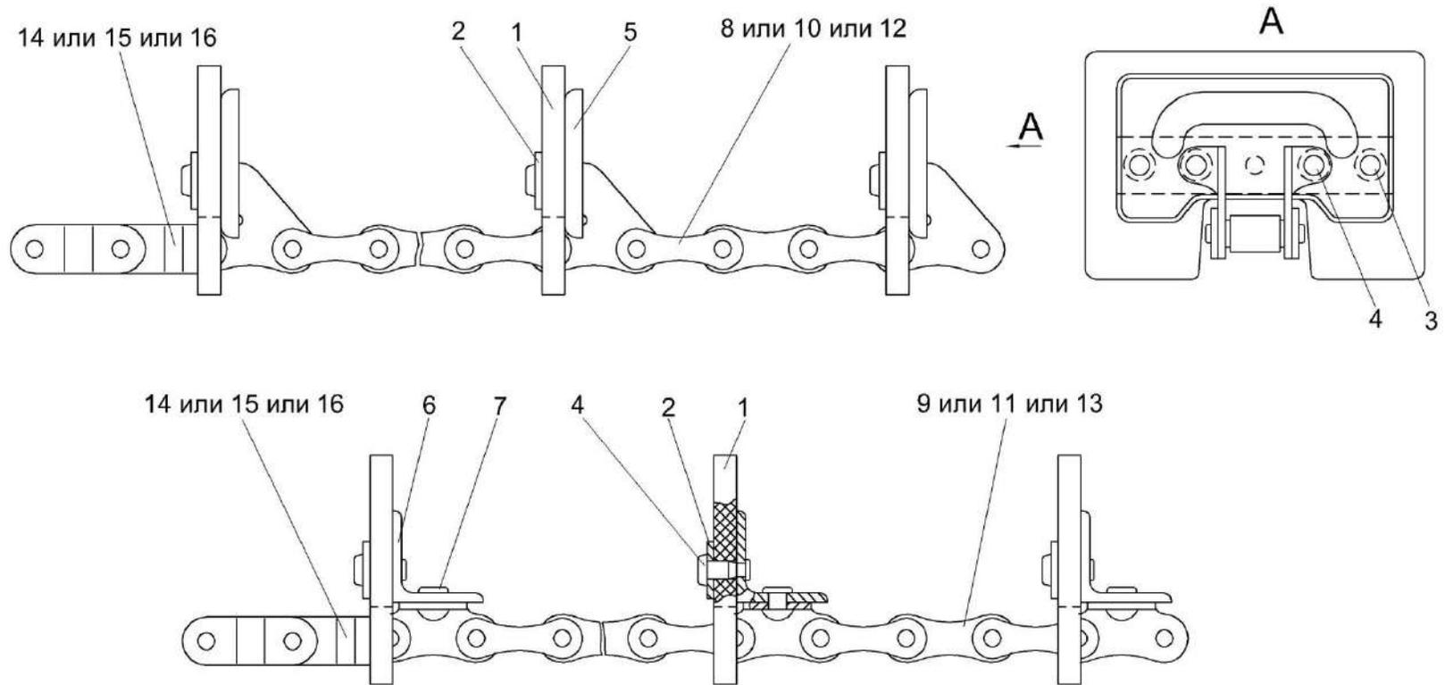
Рисунок 122 – Цепи элеватора КЗК-10-0214140 и КЗК-10-0214160
