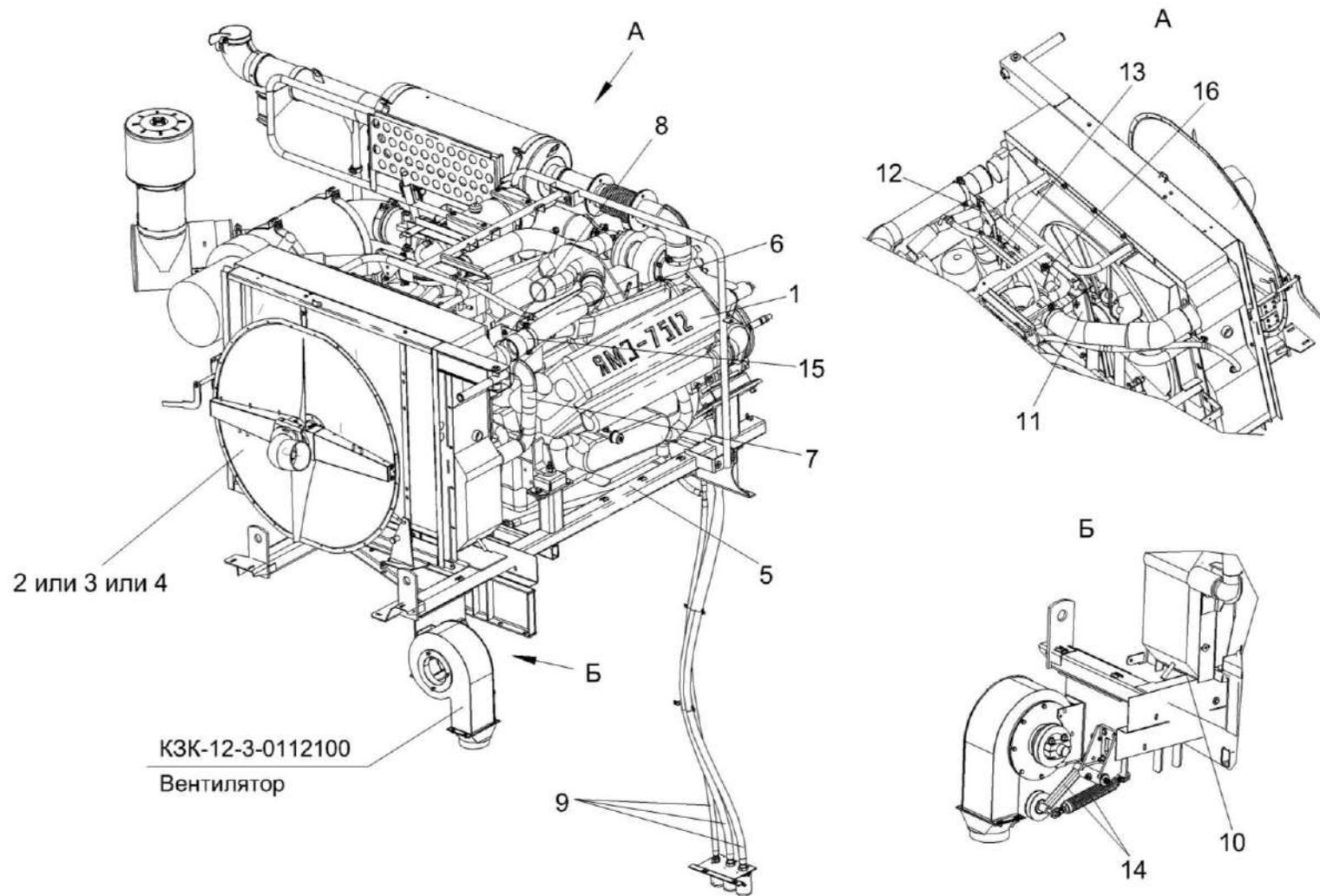
Рисунок 199 – Установка двигателя КЗК-12-3-0106000-01 (лист 2)
