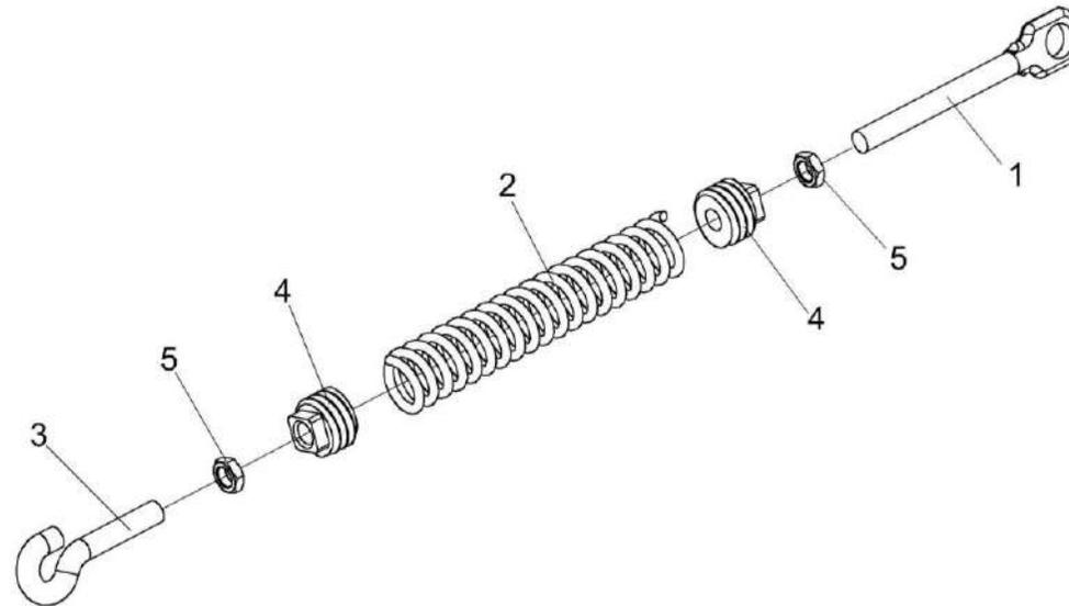
Рисунок 215 – Пружина КГС-1-0116750-01
