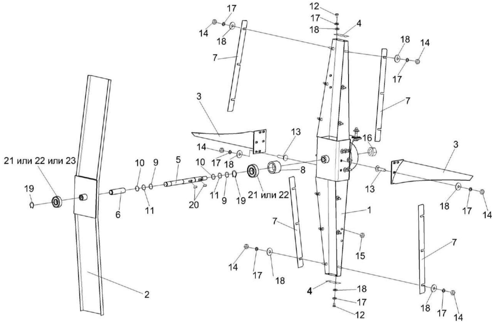
Рисунок 219 – Пылесъемник КЗК-12-3-0112130А
