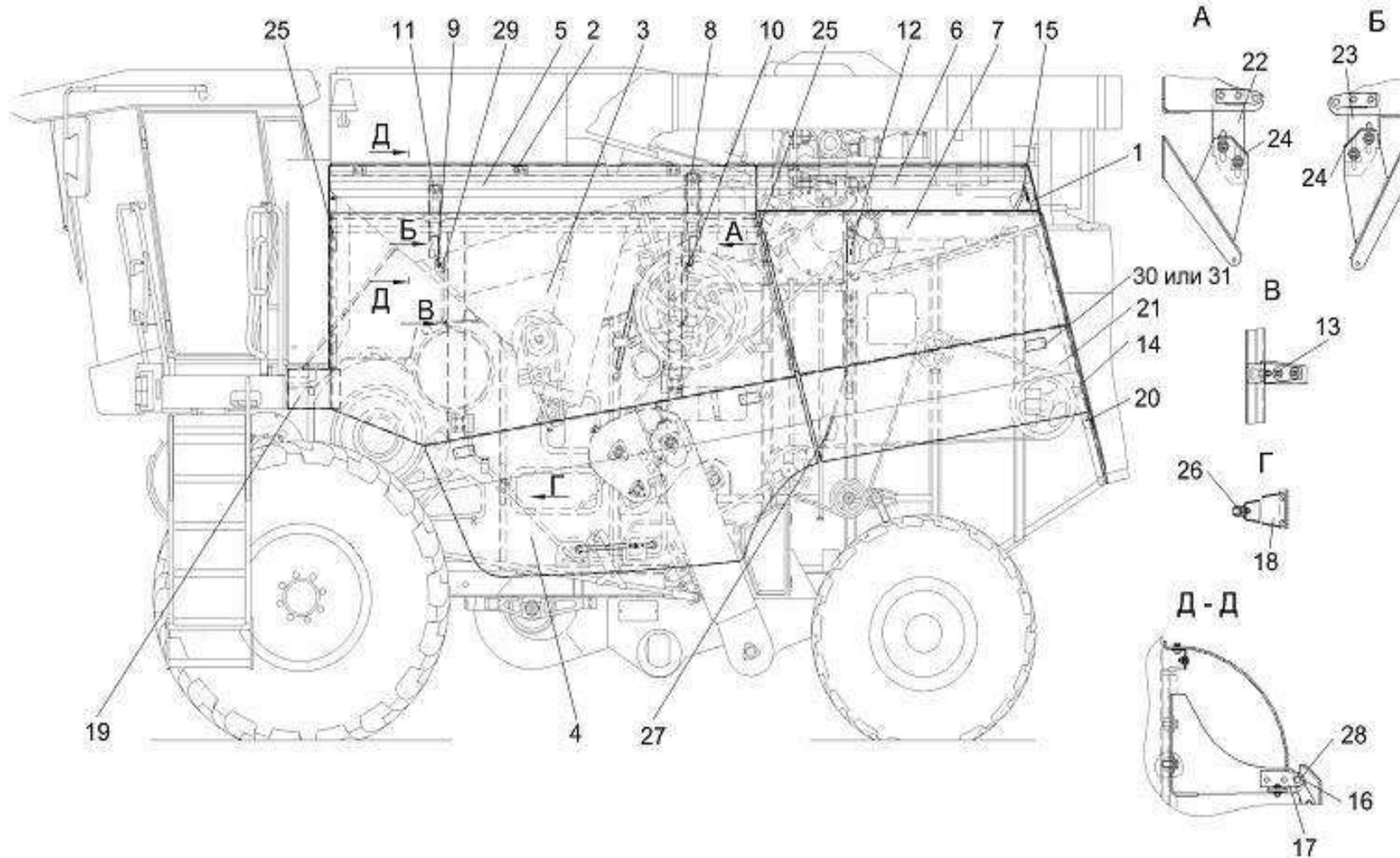
Рисунок 187 – Установка капотов и ограждения КЗК-12-0128500А (вид слева)
