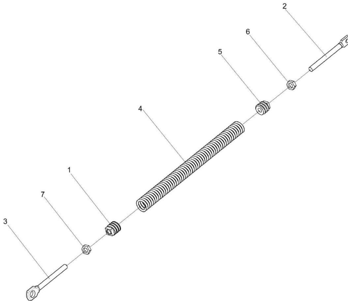
Рисунок 137 – Пружина КЗК-10-0290660
