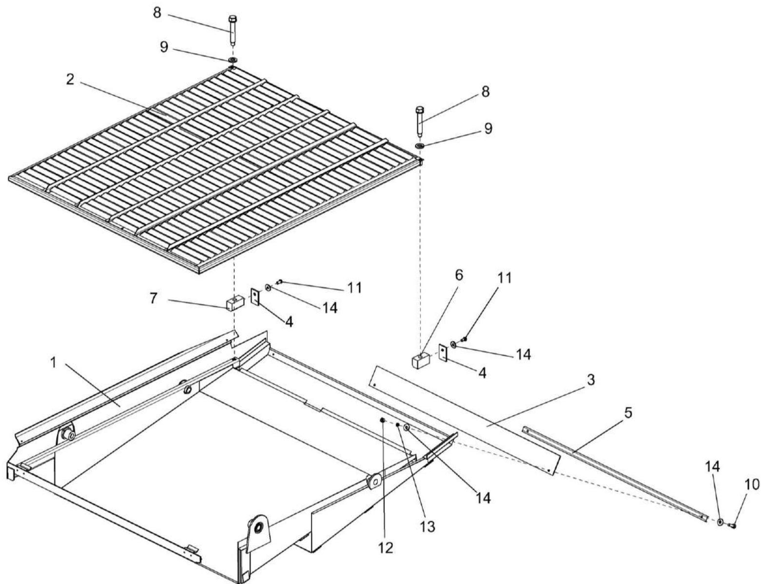
Рисунок 99 – Установка рамы стана решетного и решета
