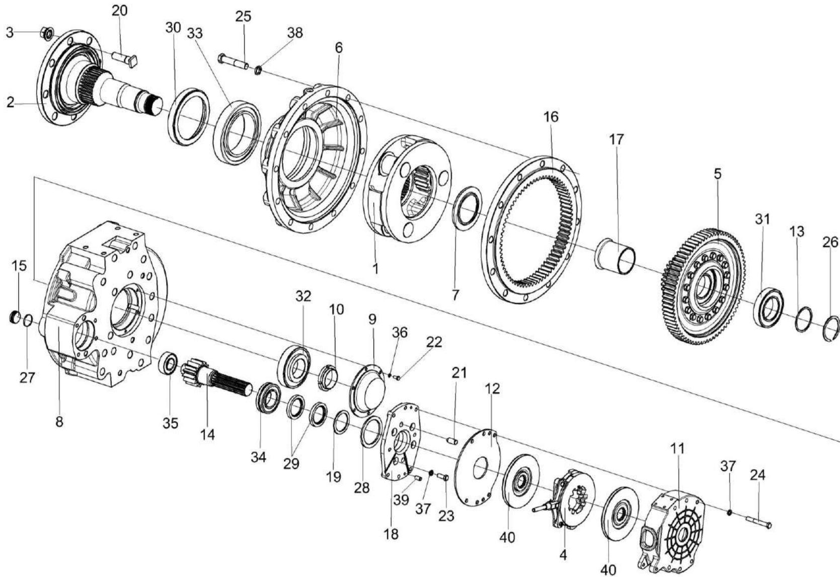
Рисунок 78 – Редуктор бортовой КЗК-10-0107200 (лист 2)
