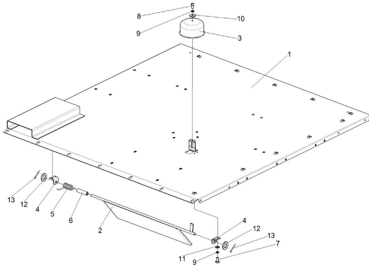
Рисунок 230 – Крыша КЗК-2-12-0228140
