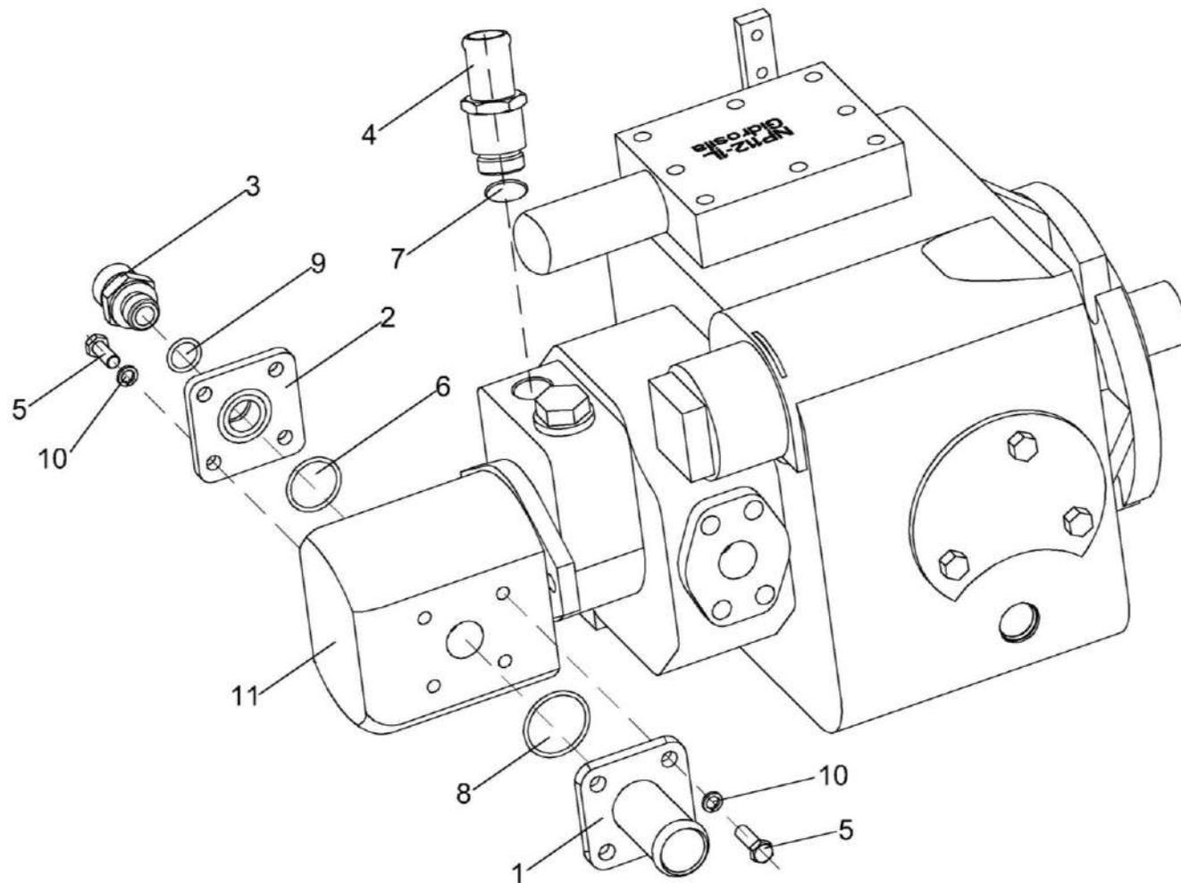
Рисунок 207 – Насос двухсекционный КЗК-12-0601400
