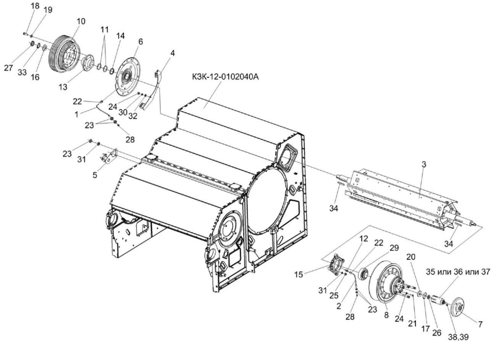
Рисунок 54 – Аппарат молотильный КЗК-12-1-0102000 (установка битера отбойного)
