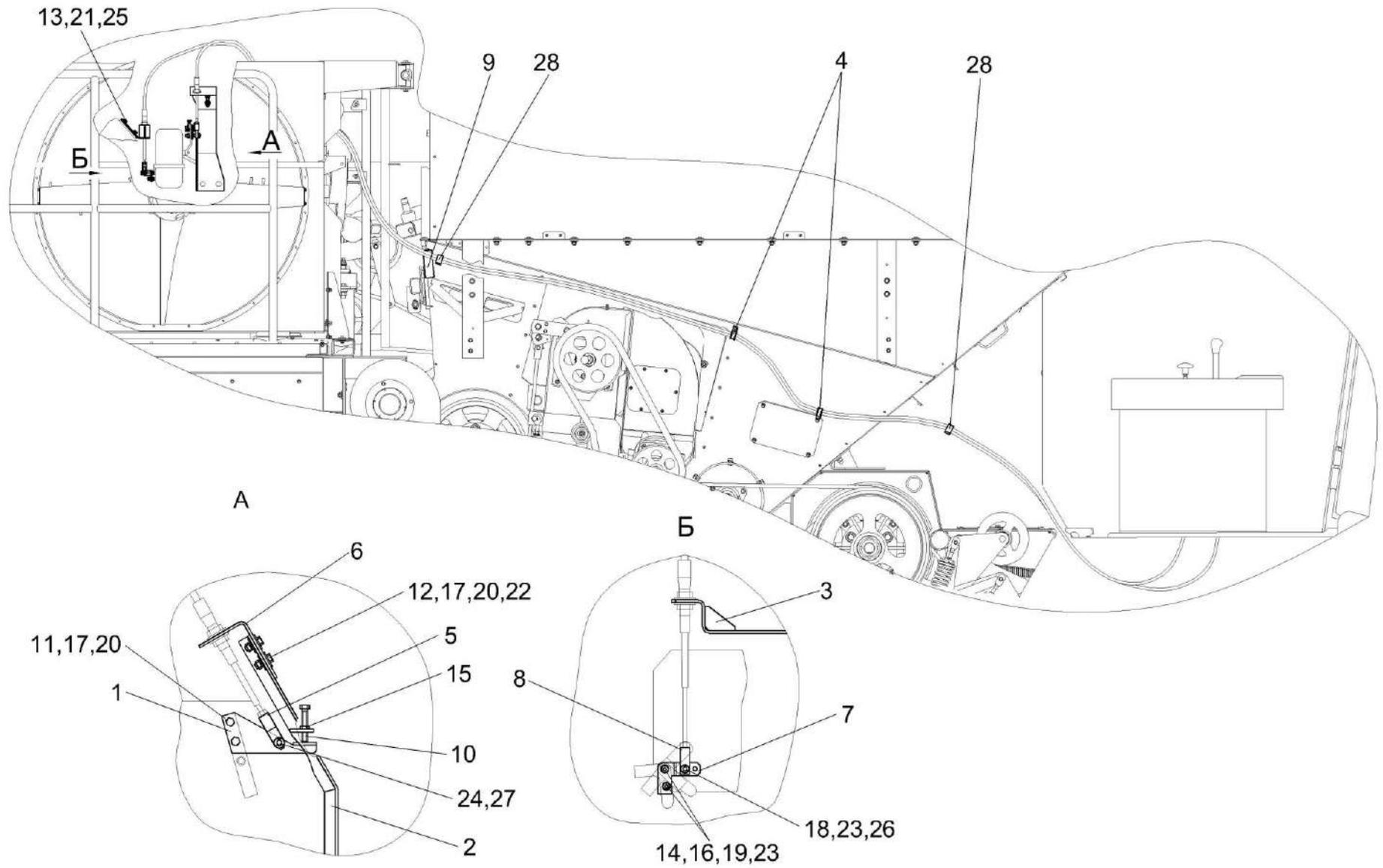
Рисунок 183 – Установка тросов управления двигателем КЗК-12-0119640В
