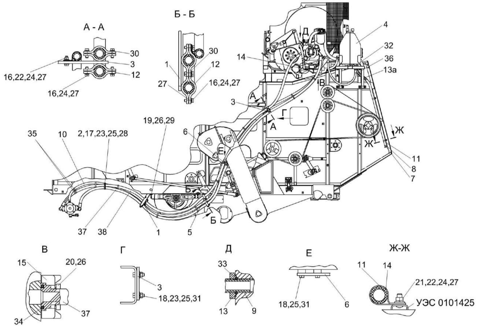
Рисунок 248 – Гидросистема привода ходовой части КЗК-12-0601000Б (вид слева)
