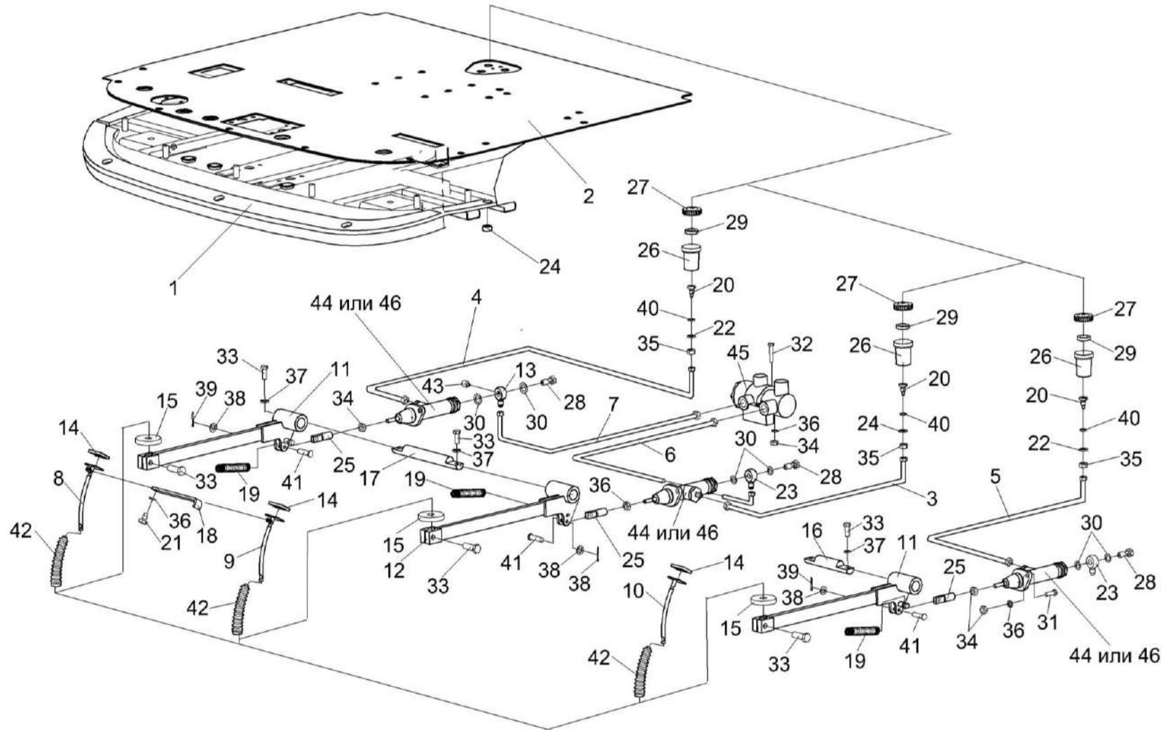
Рисунок 157 – Рычаги и трубопроводы площадки управления
