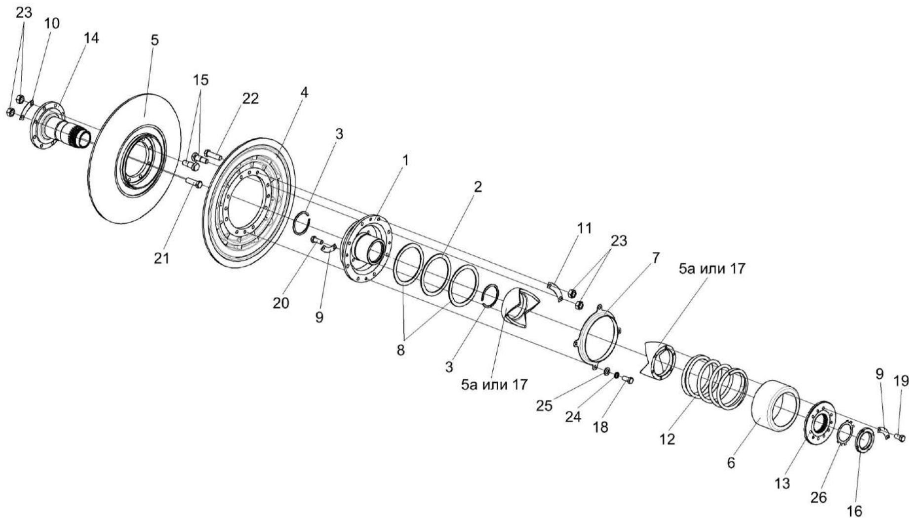
Рисунок 66 – Вариатор барабана КЗК 0123000
