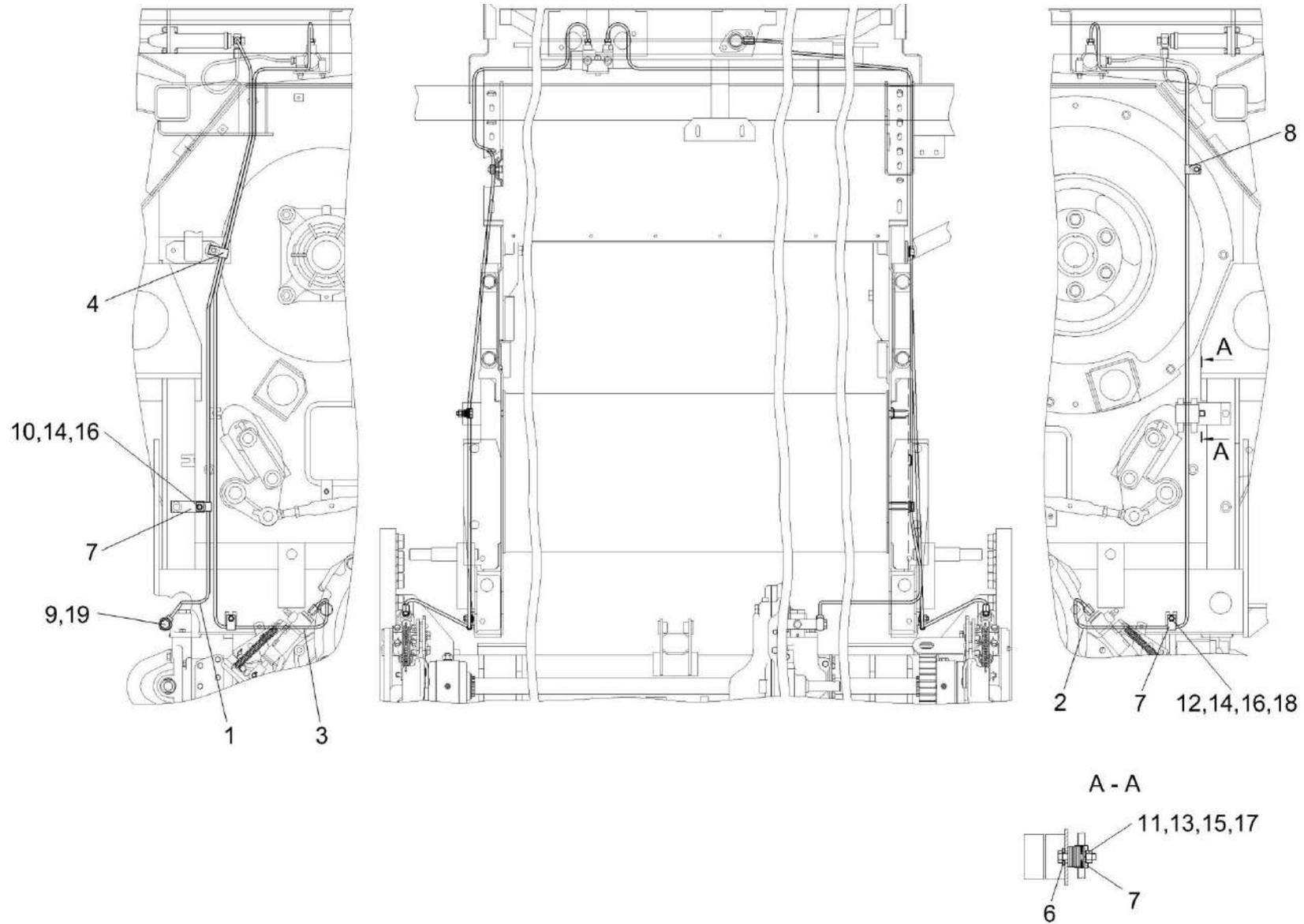
Рисунок 182 – Установка трубопроводов моста ведущих колес КЗК-12-0119630
