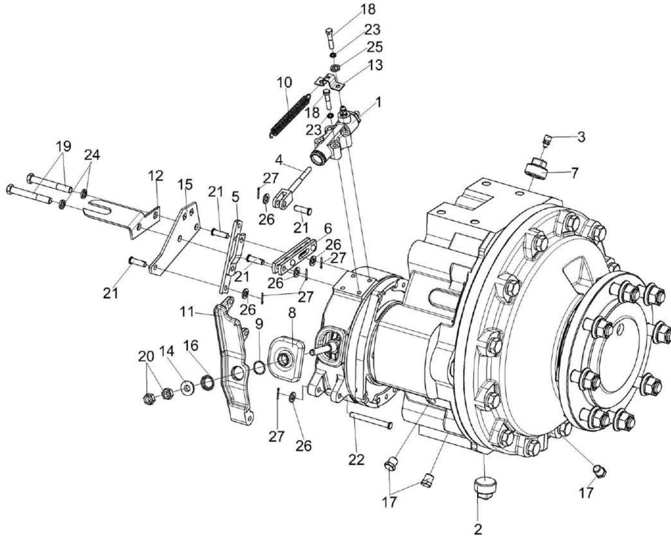
Рисунок 79 – Редуктор бортовой КЗК-10-0107200-04 (лист 1)
