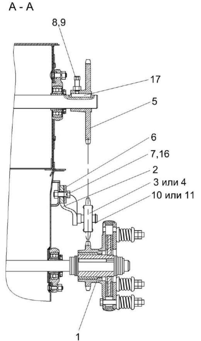
Рисунок 36 – Установка цепного привода элеватора колосового
