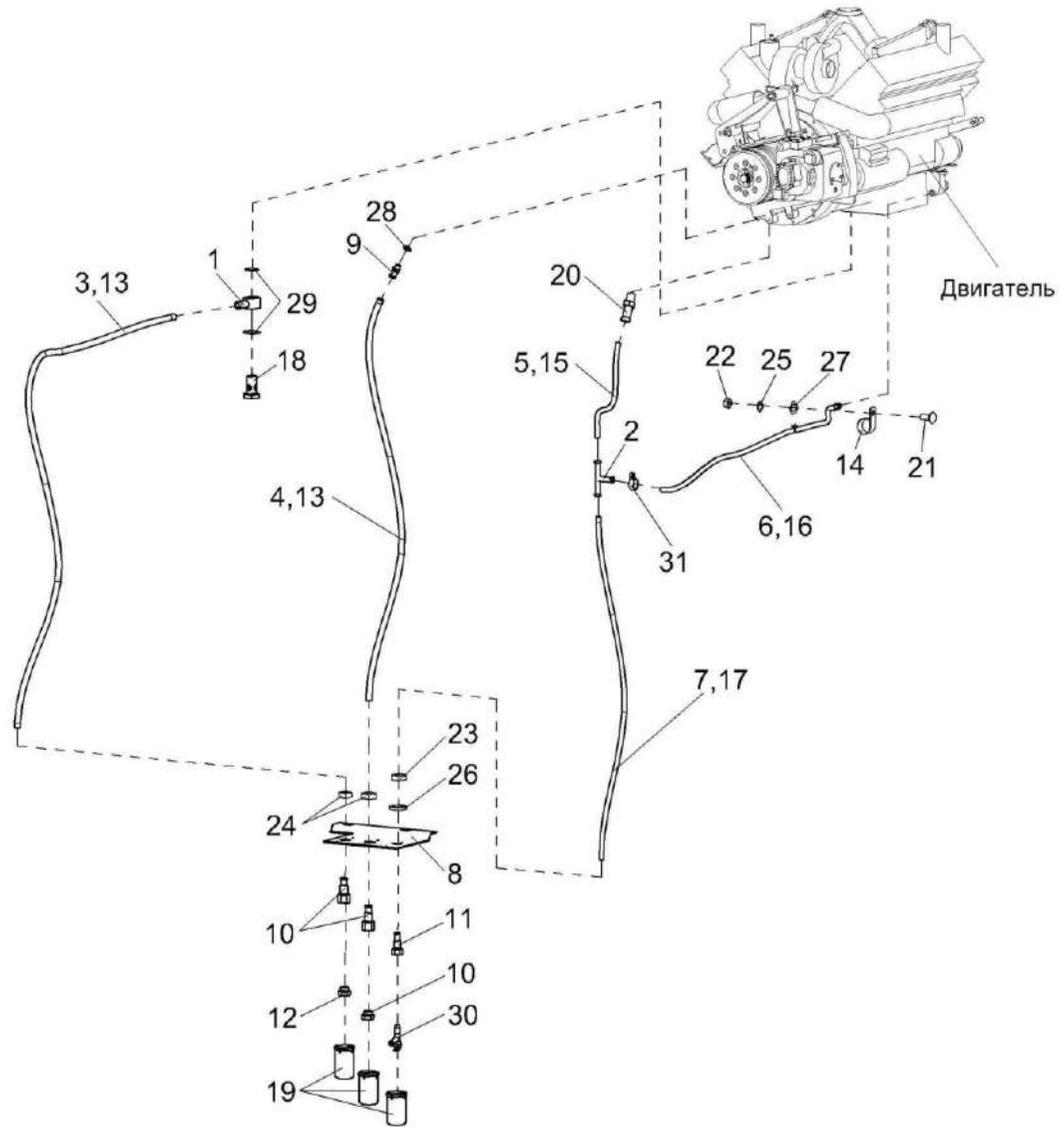
Рисунок 222 – Установка сливных рукавов КЗК-12-3-0106490
