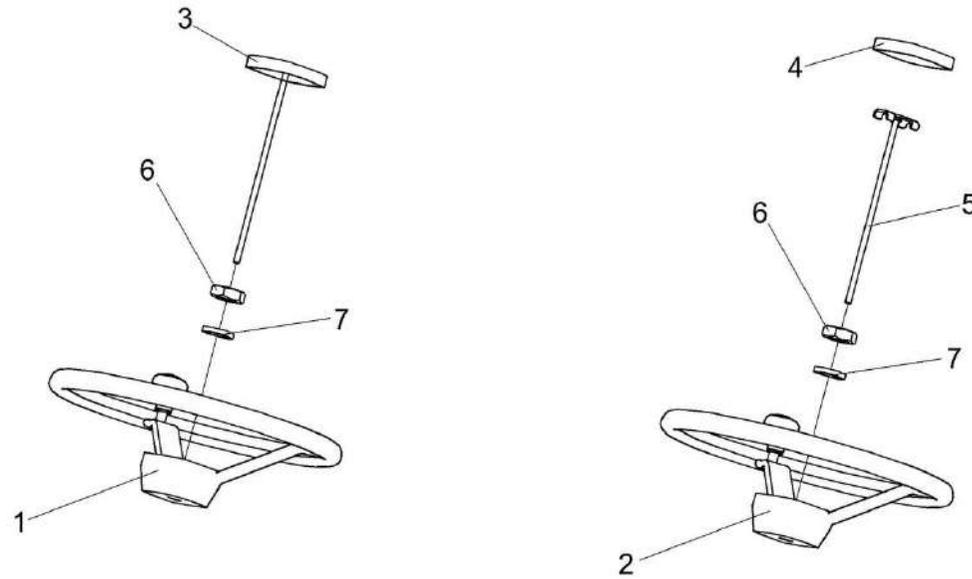
Рисунок 172 – Установка рулевого колеса КЗК-12-0122600 и КЗК-12-0122600-01
