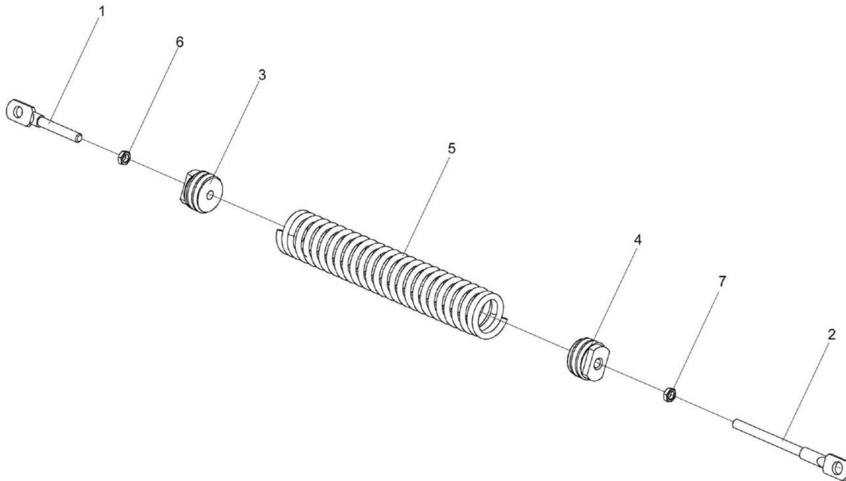
Рисунок 30 – Пружина КЗК-12-0125050
