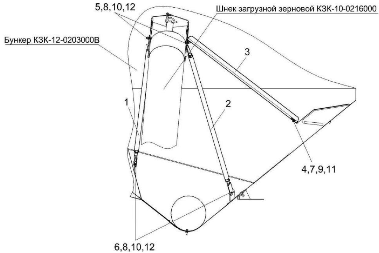
Рисунок 106 – Установка пробоотборника и раскосов КЗК-12-0203600А
