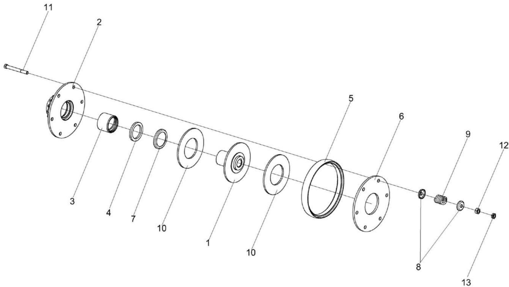
Рисунок 37 – Муфта фрикционная КЗК 0219020Б-01
