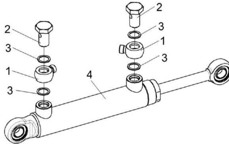
Рисунок 265 – Гидроцилиндр КЗК-12-0602700
