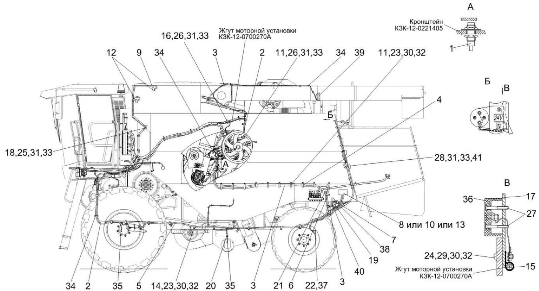
Рисунок 6 – Электрооборудование молотилки самоходной КЗК-12-010000Б-12 (лист 1)
