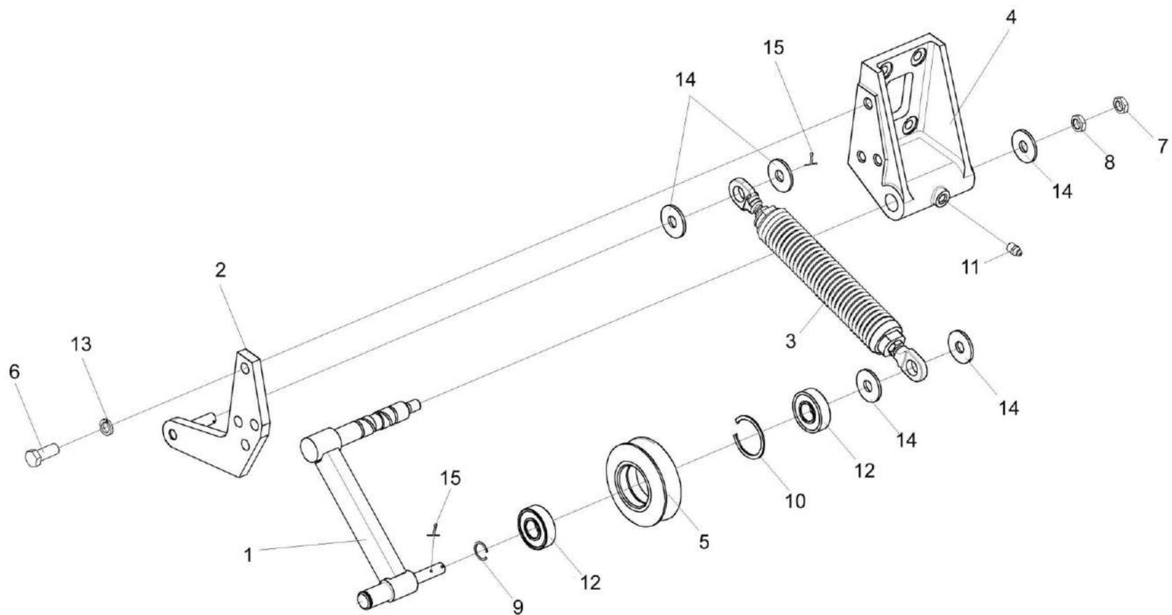
Рисунок 223 – Устройство натяжное КЗК-10-0112010
