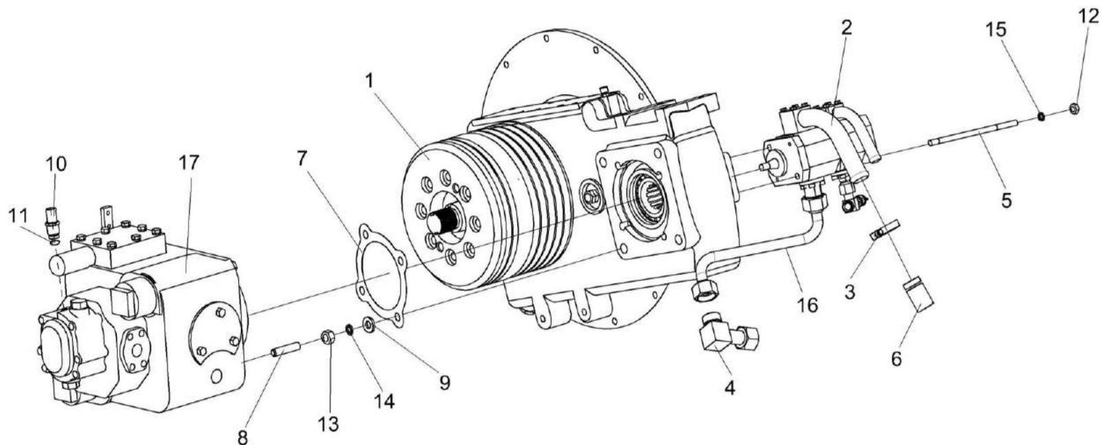
Рисунок 202 – Установка гидронасосов КЗК-12-3-0106730
