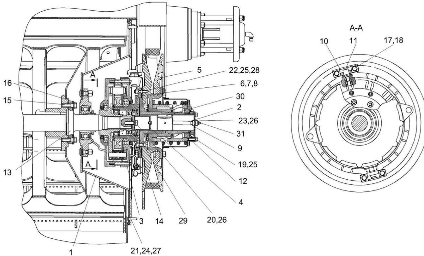
Рисунок 276 – Установка понижающего редуктора КЗК-12-0102700
