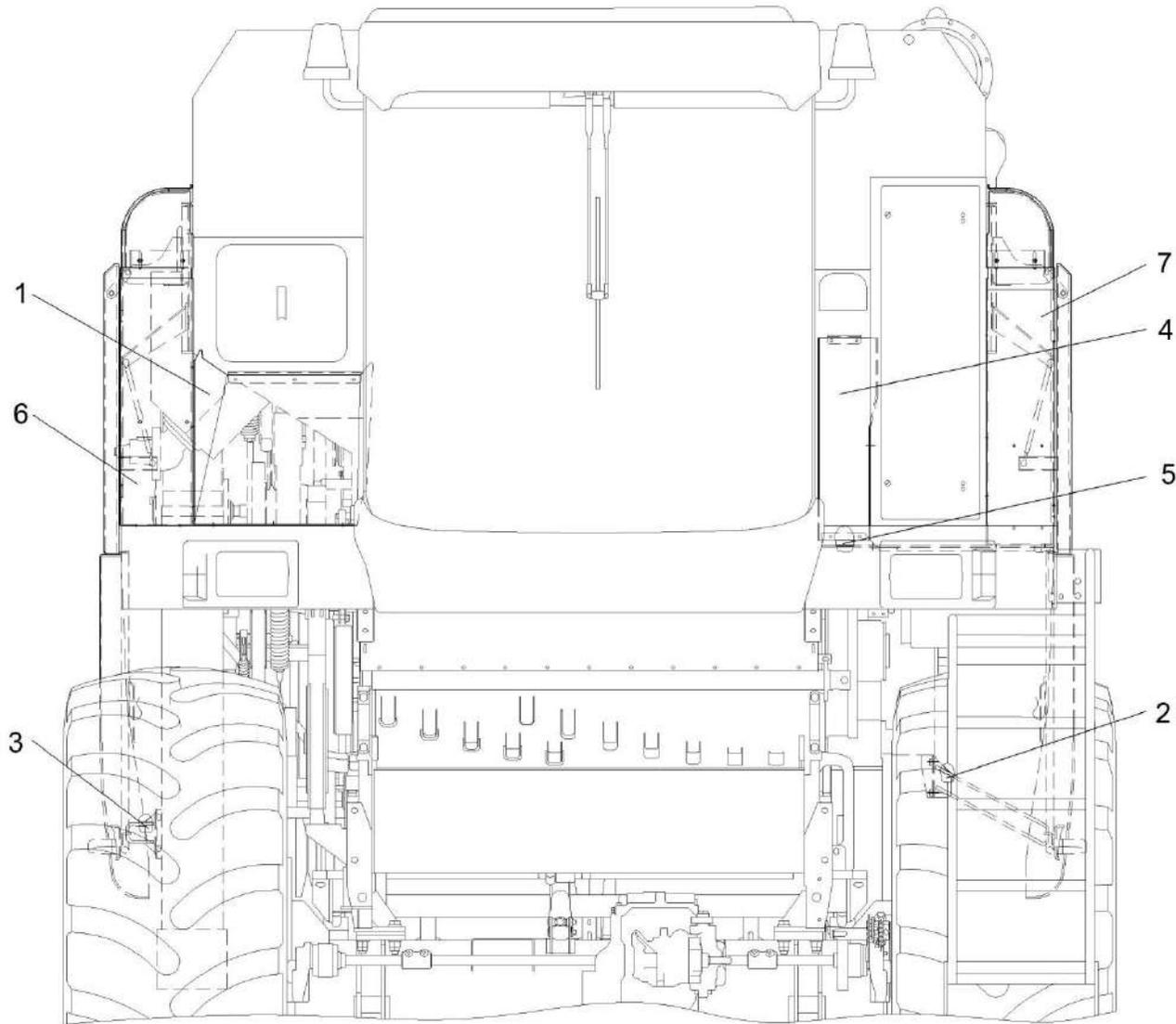
Рисунок 189 – Установка капотов и ограждения КЗК-12-0128500А (вид спереди)
