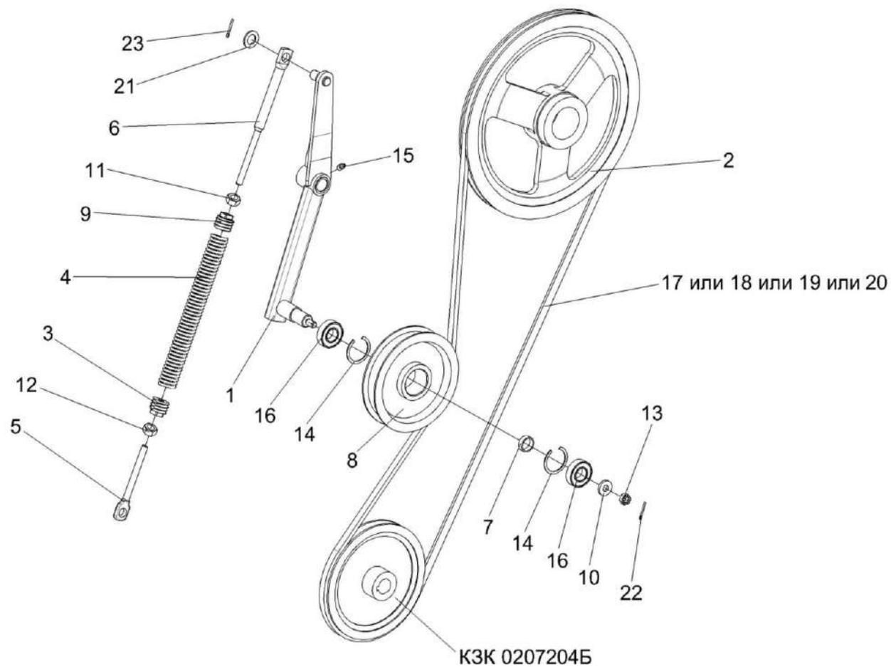
Рисунок 52 – Установка привода устройства домолачивающего
