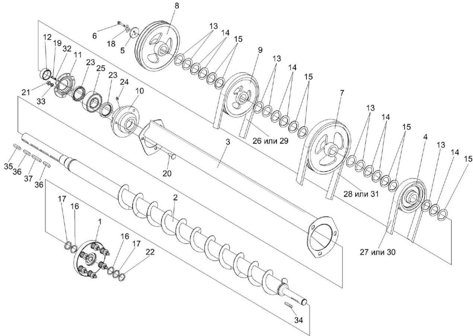
Рисунок 35 – Установка шкивов на шнек распределительный КЗК-10-0202770А
