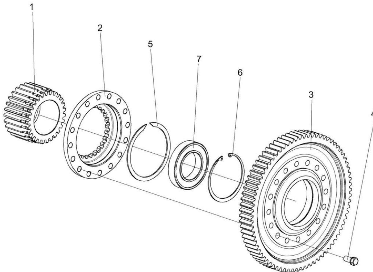
Рисунок 83 – Колесо зубчатое МК-23М.03.210
