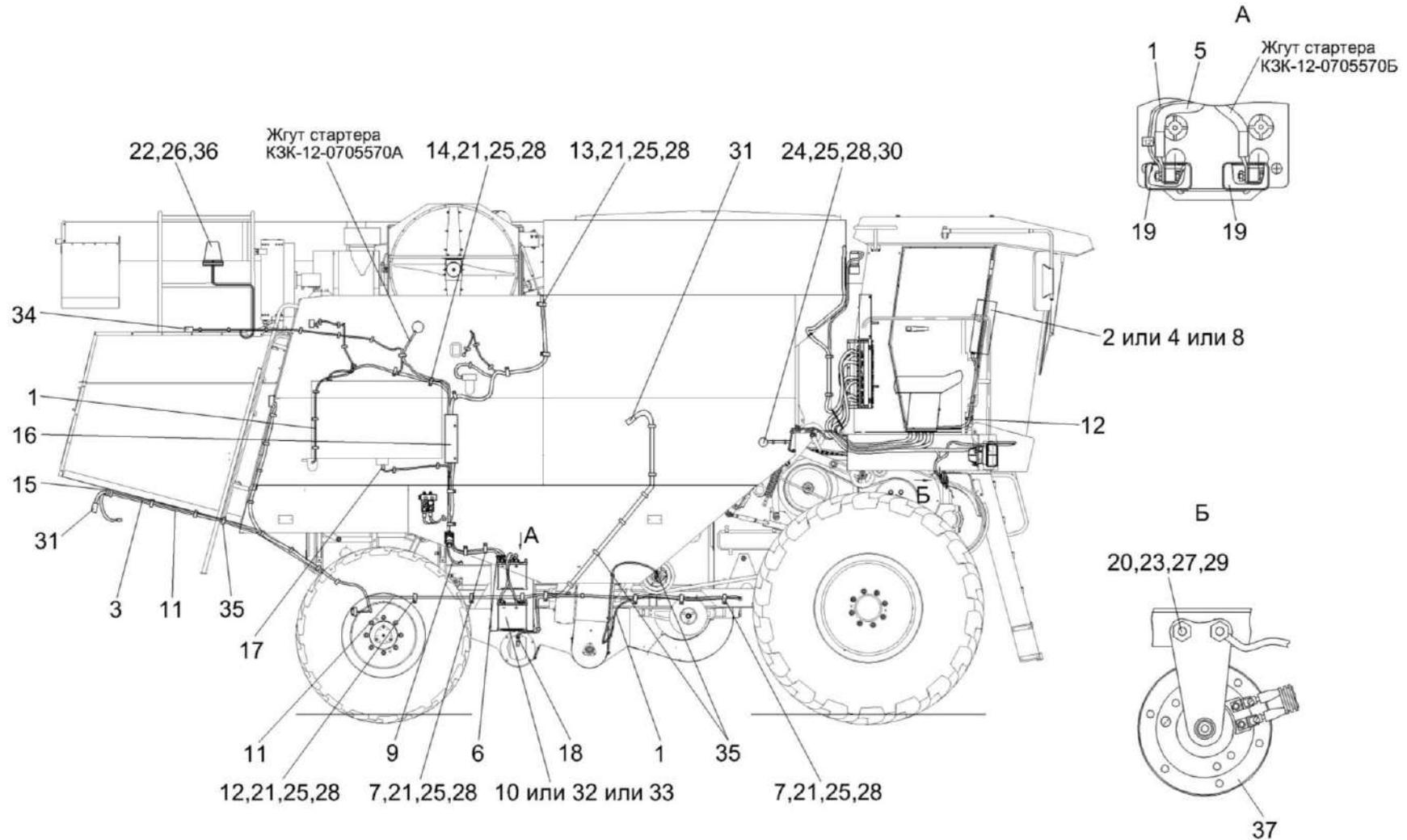
Рисунок 7 – Электрооборудование молотилки самоходной КЗК-12-010000Б-12 (лист 2)
