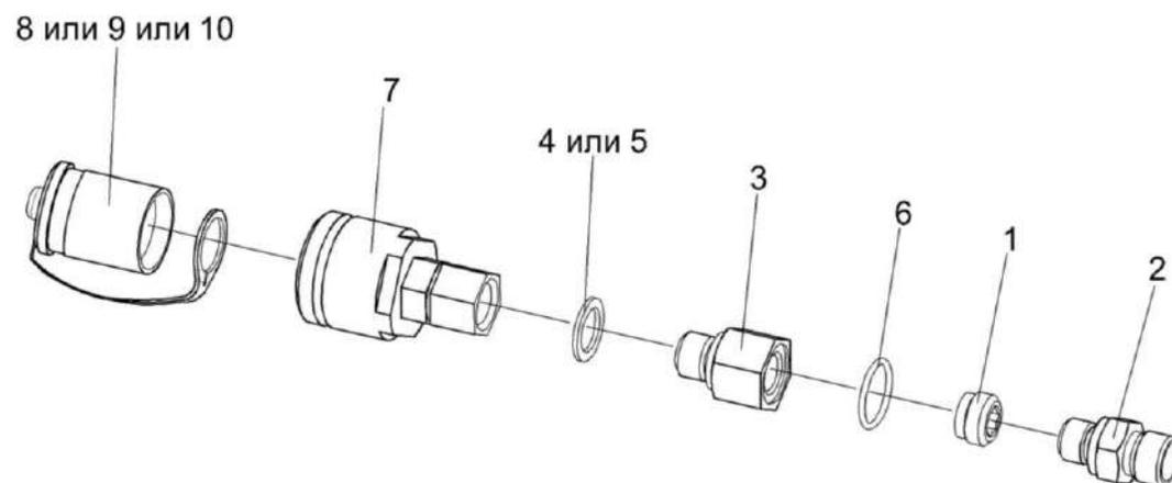
Рисунок 259 – Полумуфты молотилки КЗК-12-0602320, КЗК-12-0602320-01, КЗК-12-0602320-02
