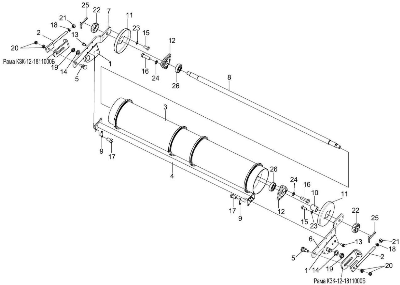
Рисунок 23 – Установка вала нижнего КЗК-12-1816000Б
