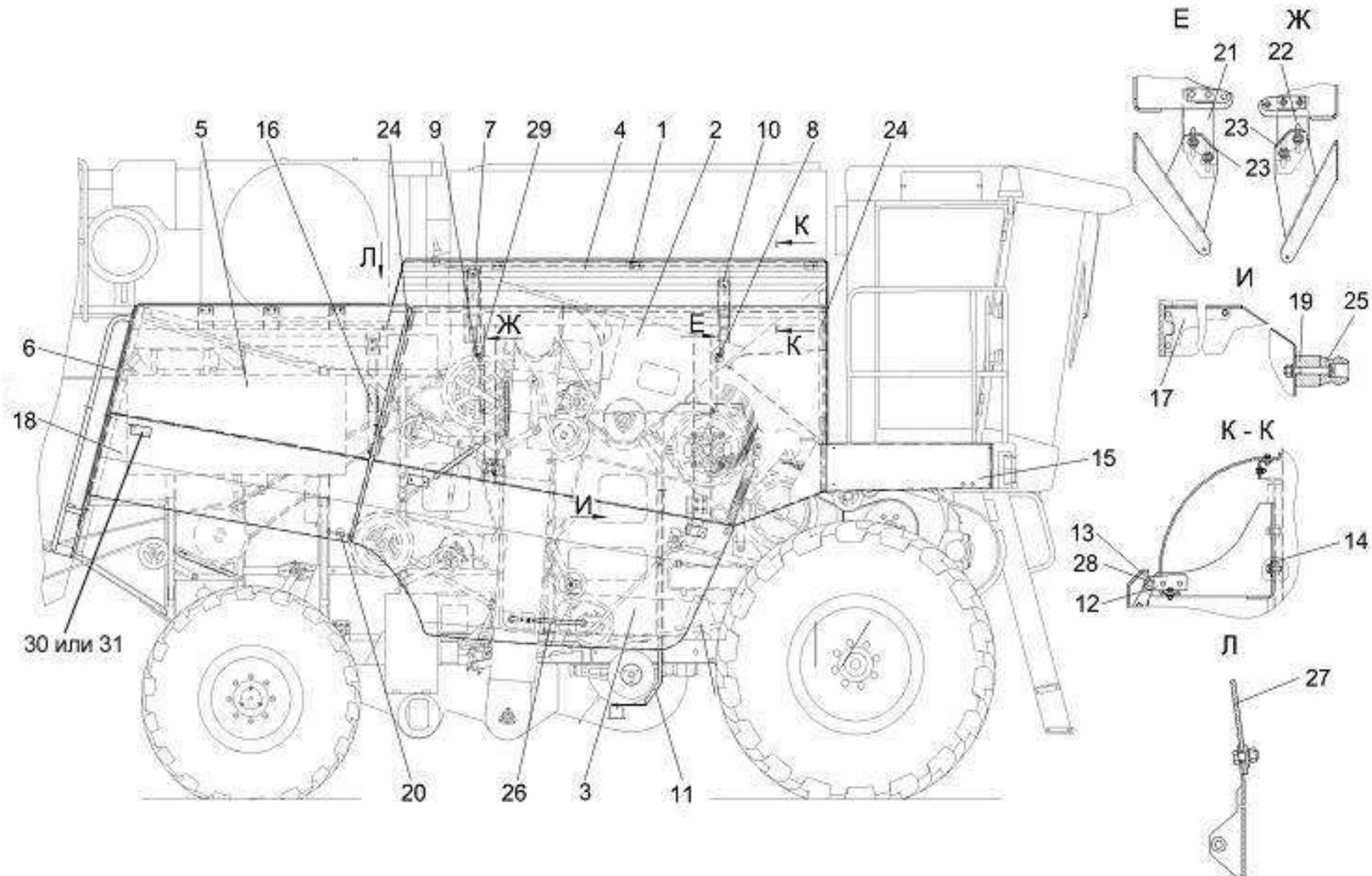
Рисунок 188 – Установка капотов и ограждения КЗК-12-0128500А (вид справа)
