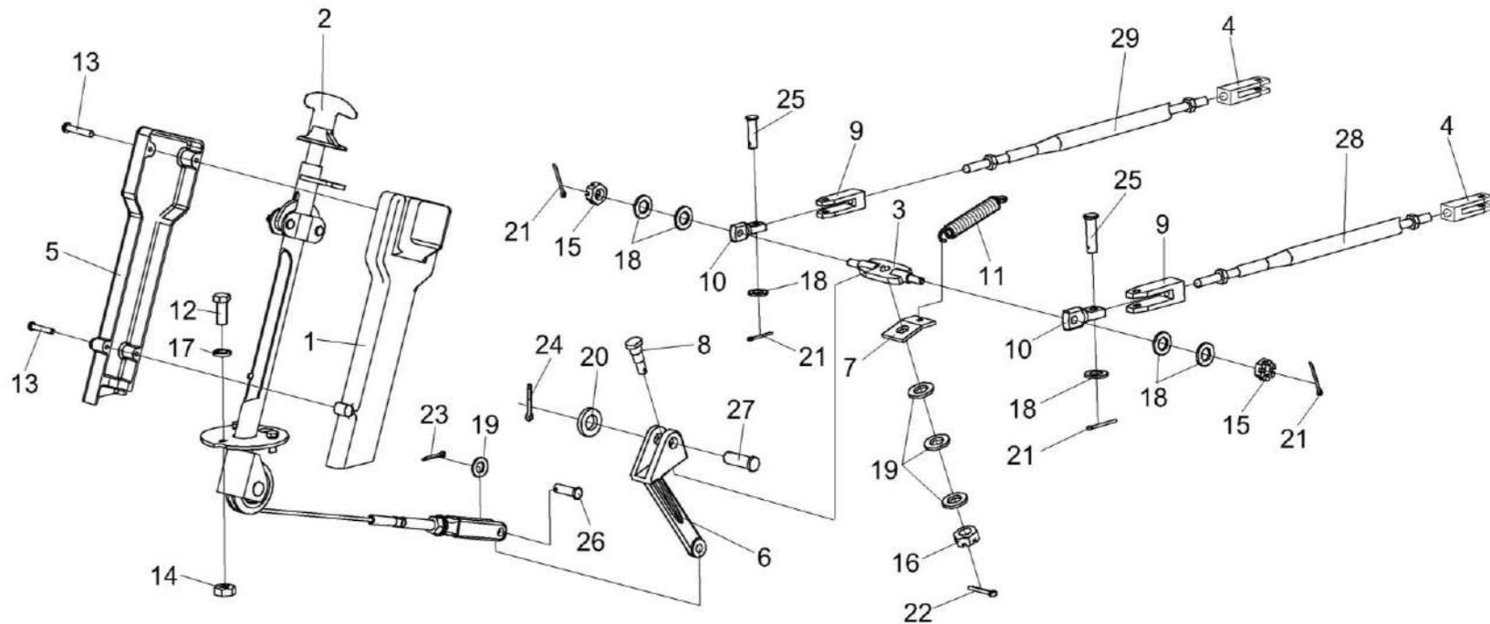
Рисунок 177 – Установка колонки привода УЭС 0300710
