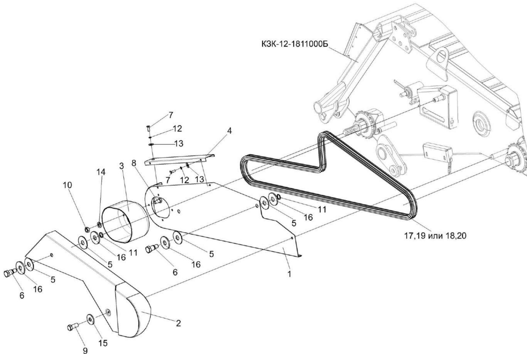
Рисунок 17 – Установка ограждений КЗК-12-1800140 и КЗК-12-1800160
