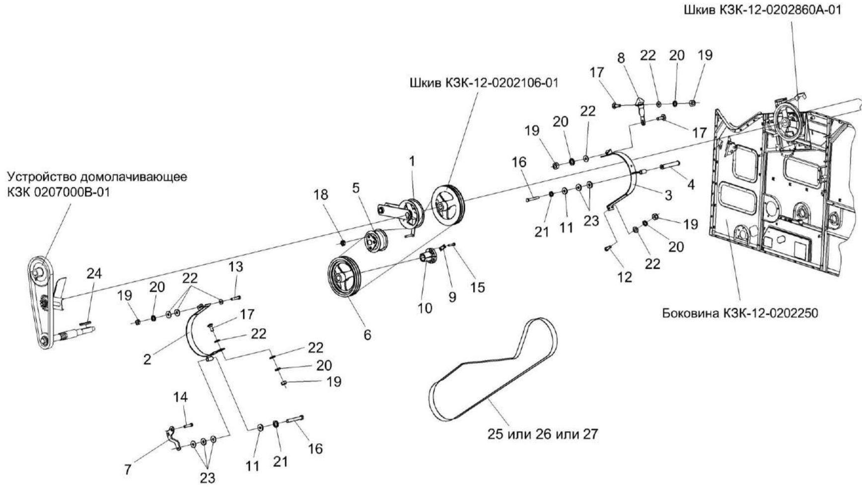
Рисунок 126 – Привод выгрузки КЗК-12-0221100А (лист 2)
