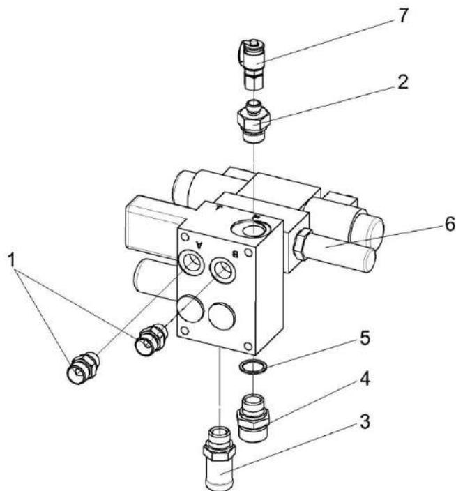
Рисунок 264 – Гидроблок односекционный КЗК-12-0602670
