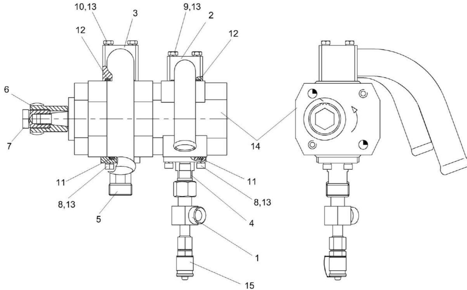
Рисунок 205 – Гидронасос двухсекционный КЗК-12-0602940А
