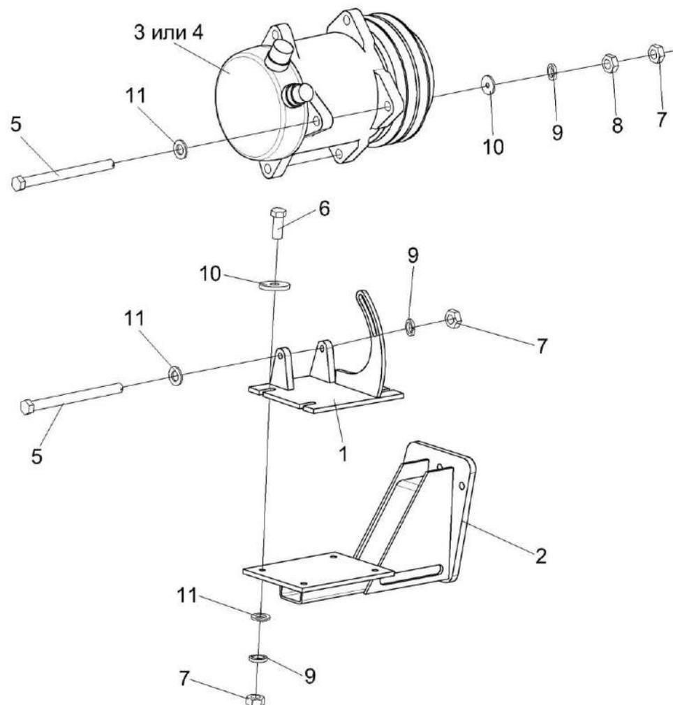
Рисунок 152 – Компрессоры КЗК-12-0113160А и КЗК-12-0113160А-01
