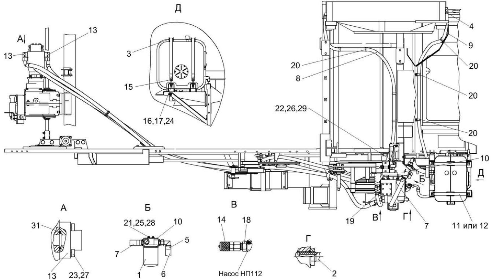
Рисунок 249 – Гидросистема привода ходовой части КЗК-12-0601000Б (вид сверху)
