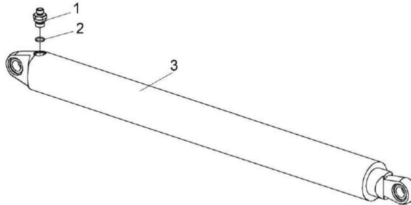
Рисунок 267 – Гидроцилиндр КЗК-12-0602740
