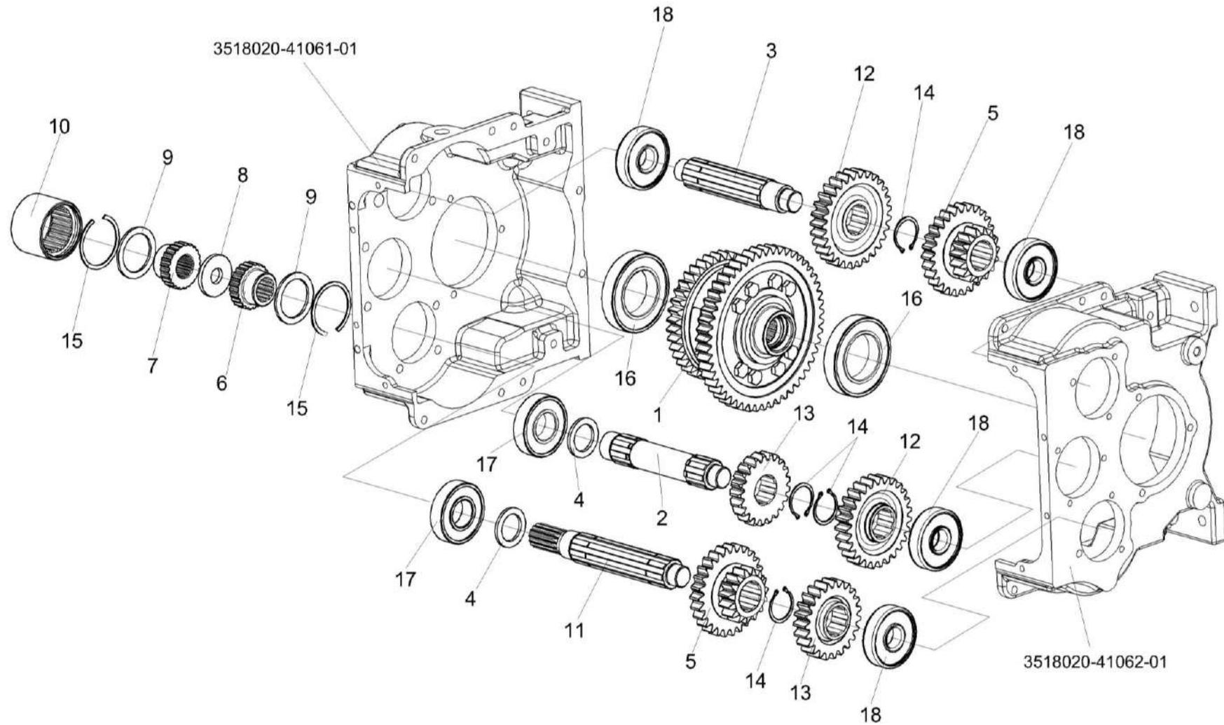
Рисунок 86 – Коробка передач КЗК-12-0107530 (валы, шестерни)
