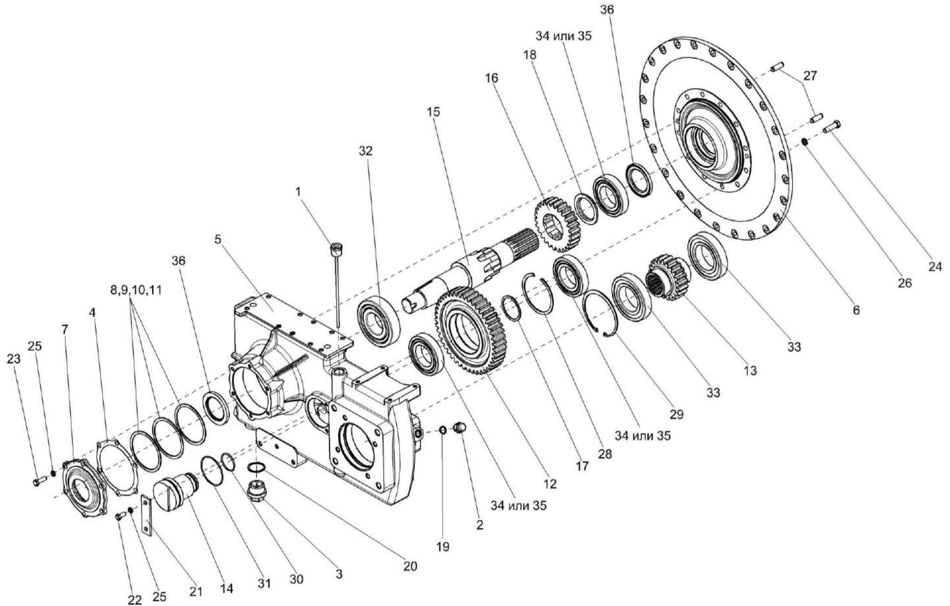
Рисунок 211 – Мультипликатор КЗК-12-0114000-01
