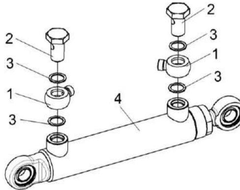
Рисунок 266 – Гидроцилиндр КЗК-12-0602730-01
