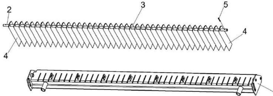
Рисунок 132 – Опора ножевая КЗК-10-0290030А
