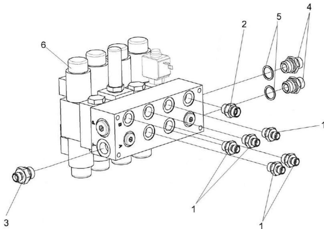
Рисунок 263 – Гидроблок четырехсекционный КЗК-12-0602490
