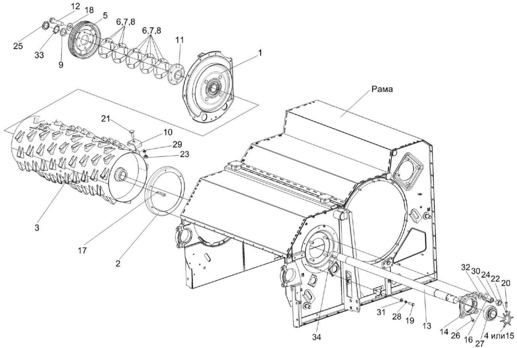
Рисунок 56 – Аппарат молотильный КЗК-12-1-0102000 (установка барабана ускоряющего)
