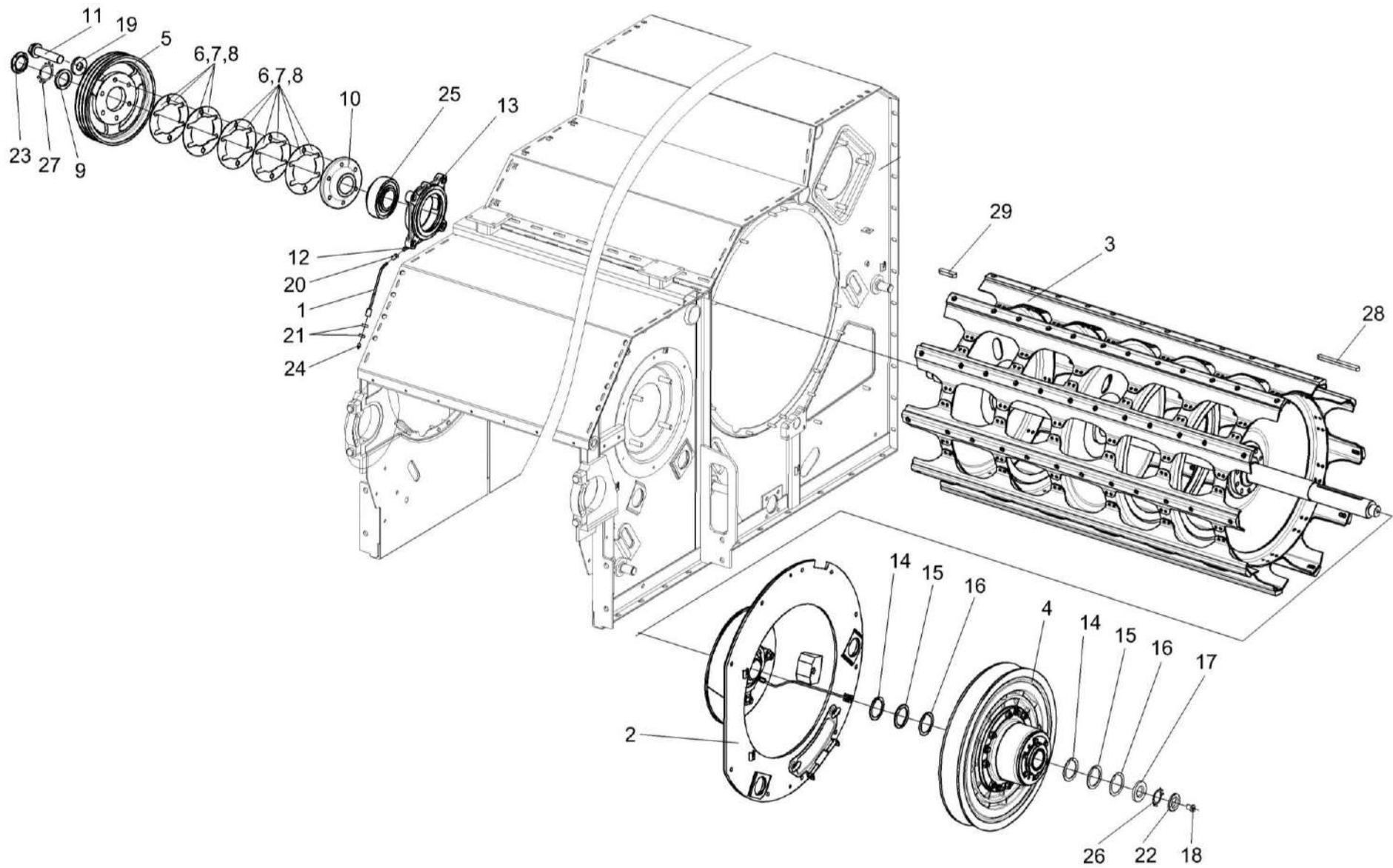
Рисунок 55 – Аппарат молотильный КЗК-12-1-0102000 (установка барабана молотильного)
