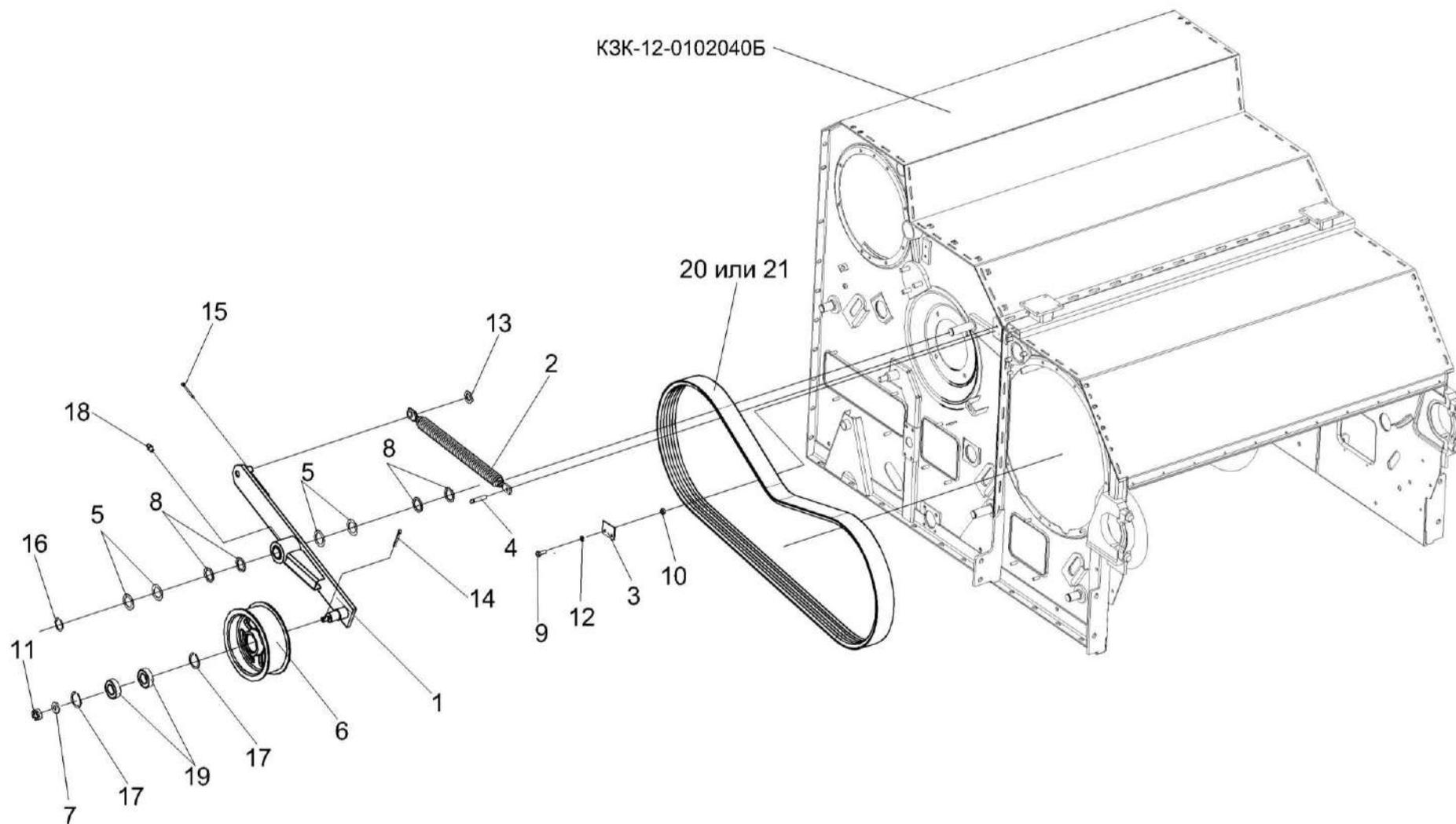
Рисунок 57 – Аппарат молотильный КЗК-12-1-0102000 (привод отбойного битера)
