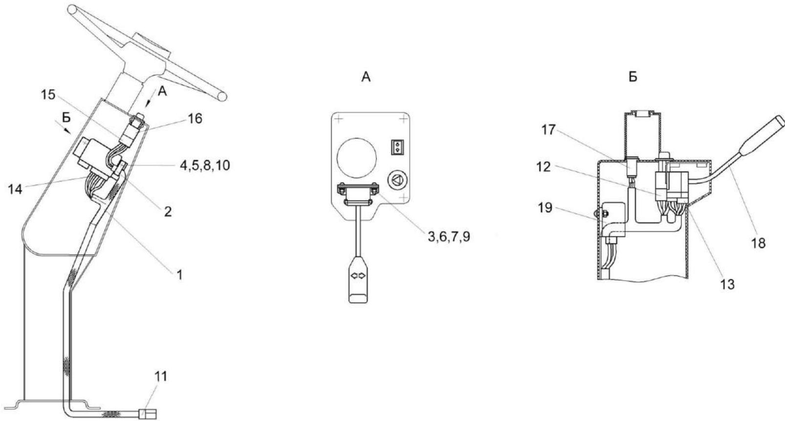
Рисунок 176 – Электрооборудование рулевой колонки КВС-1-0129230-01
