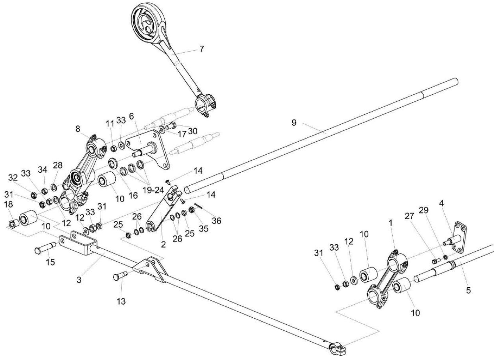
Рисунок 42 – Установка привода доски стрясной КЗК-12-0280200 (вид справа)
