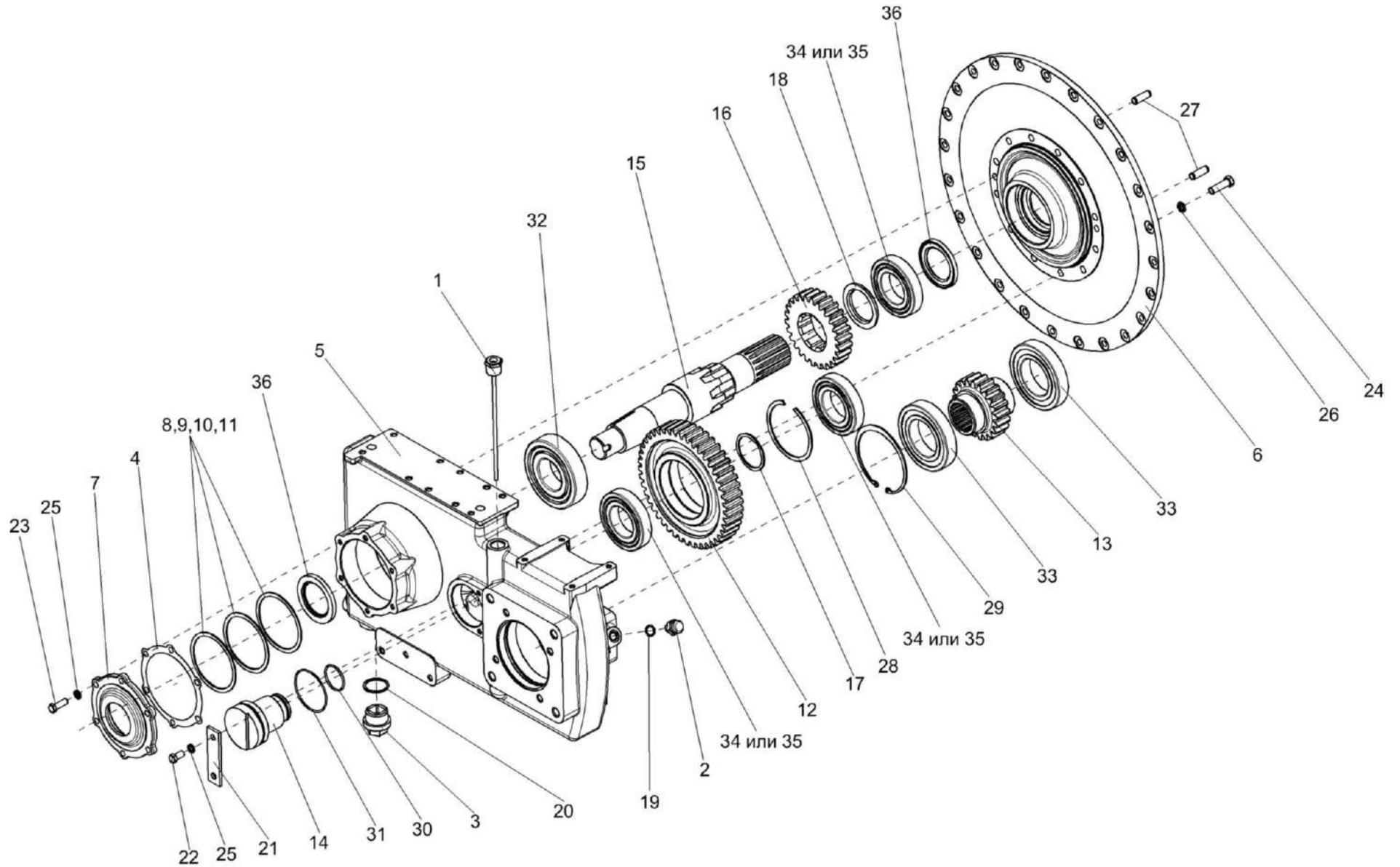
Рисунок 210 – Мультипликатор КЗК-12-0114000
