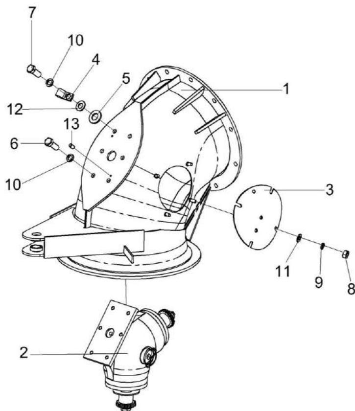
Рисунок 114 – Отвод с редуктором КЗК-12-0206230А
