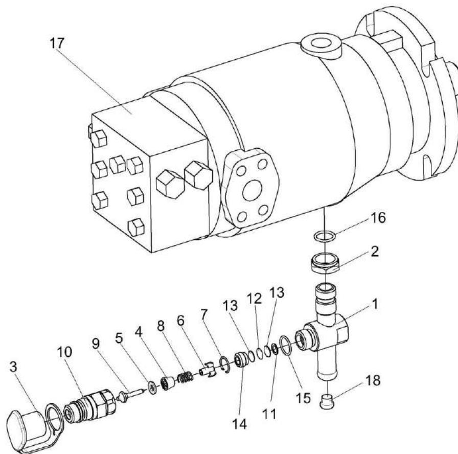
Рисунок 253 – Гидромотор КЗК-12-0601500-01
