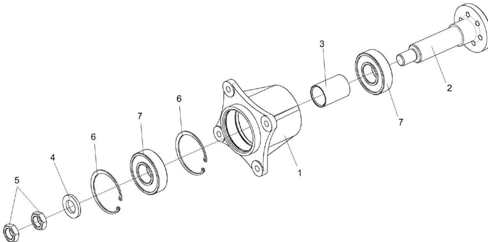
Рисунок 216 – Привод вентилятора КЗК 0106370А
