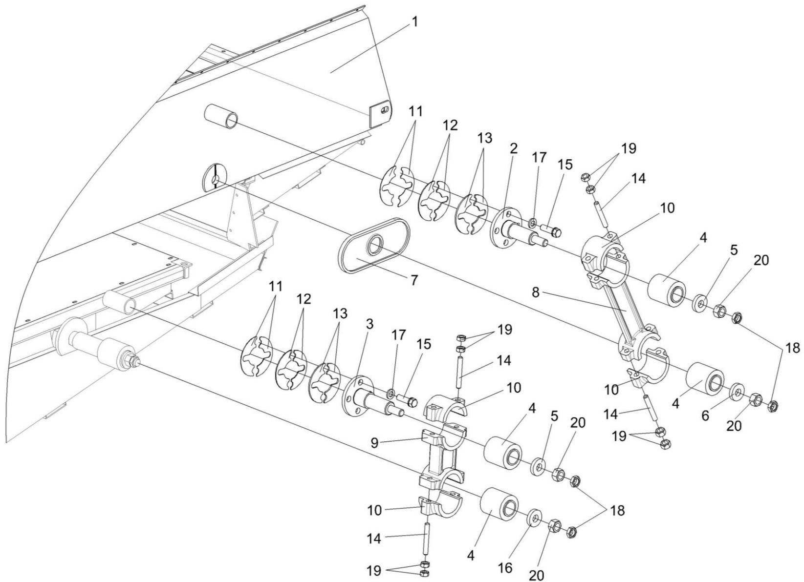
Рисунок 98 – Установка рычагов КЗР 0202190Б-02 и КЗР 0202190Б-03
