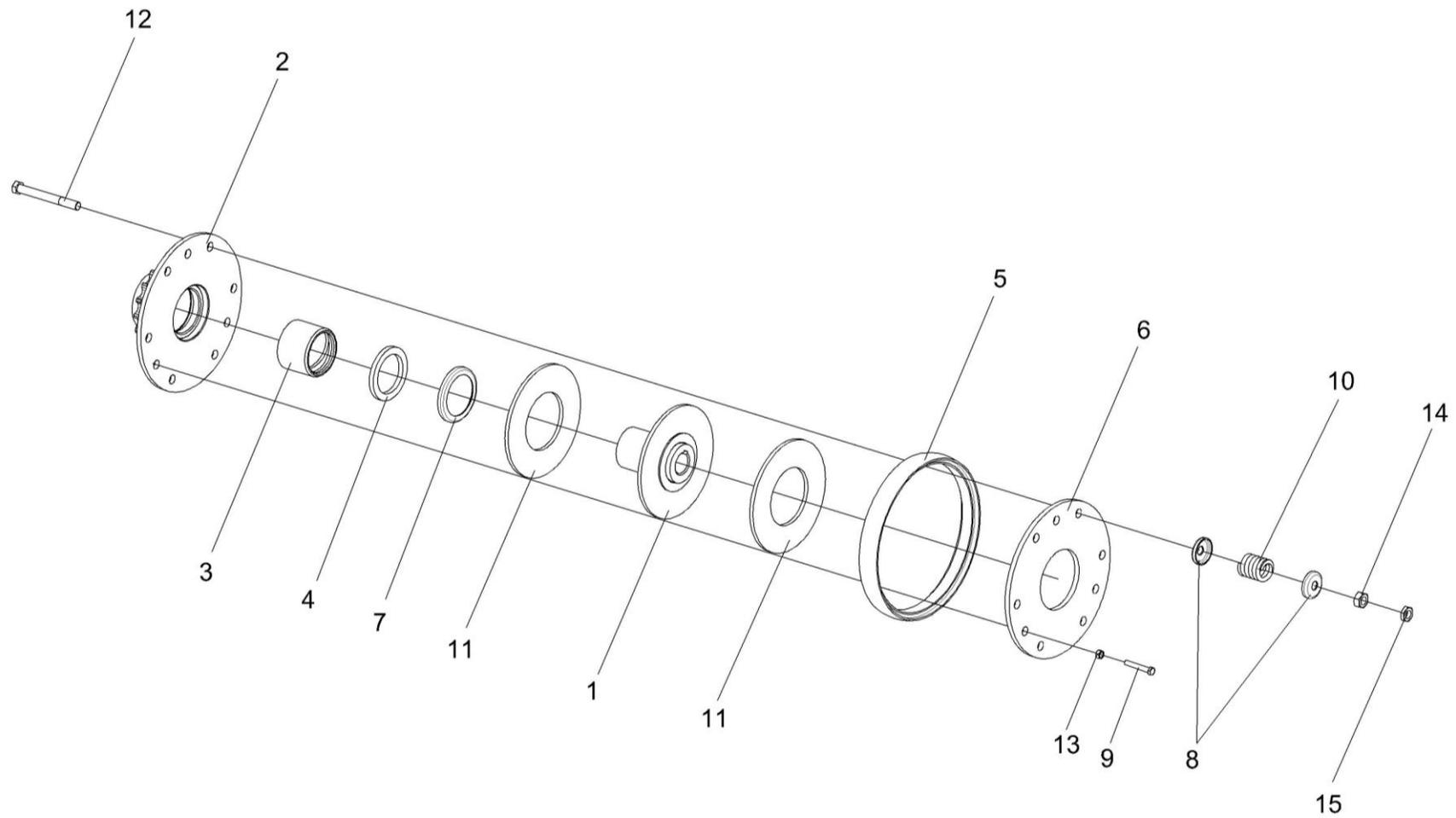
Рисунок 88 – Муфта фрикционная КЗК 0219020Б-01
