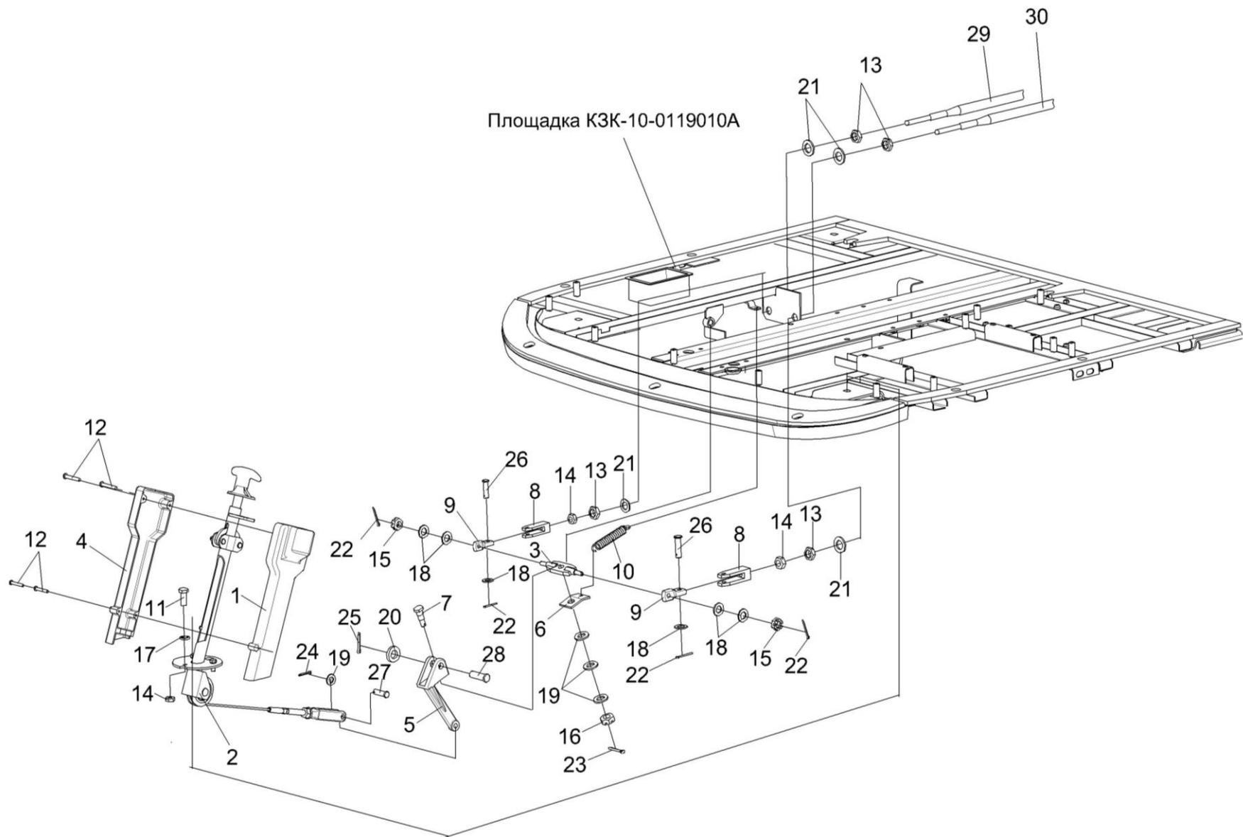
Рисунок 217 – Установка колонки привода УЭС 0300710
