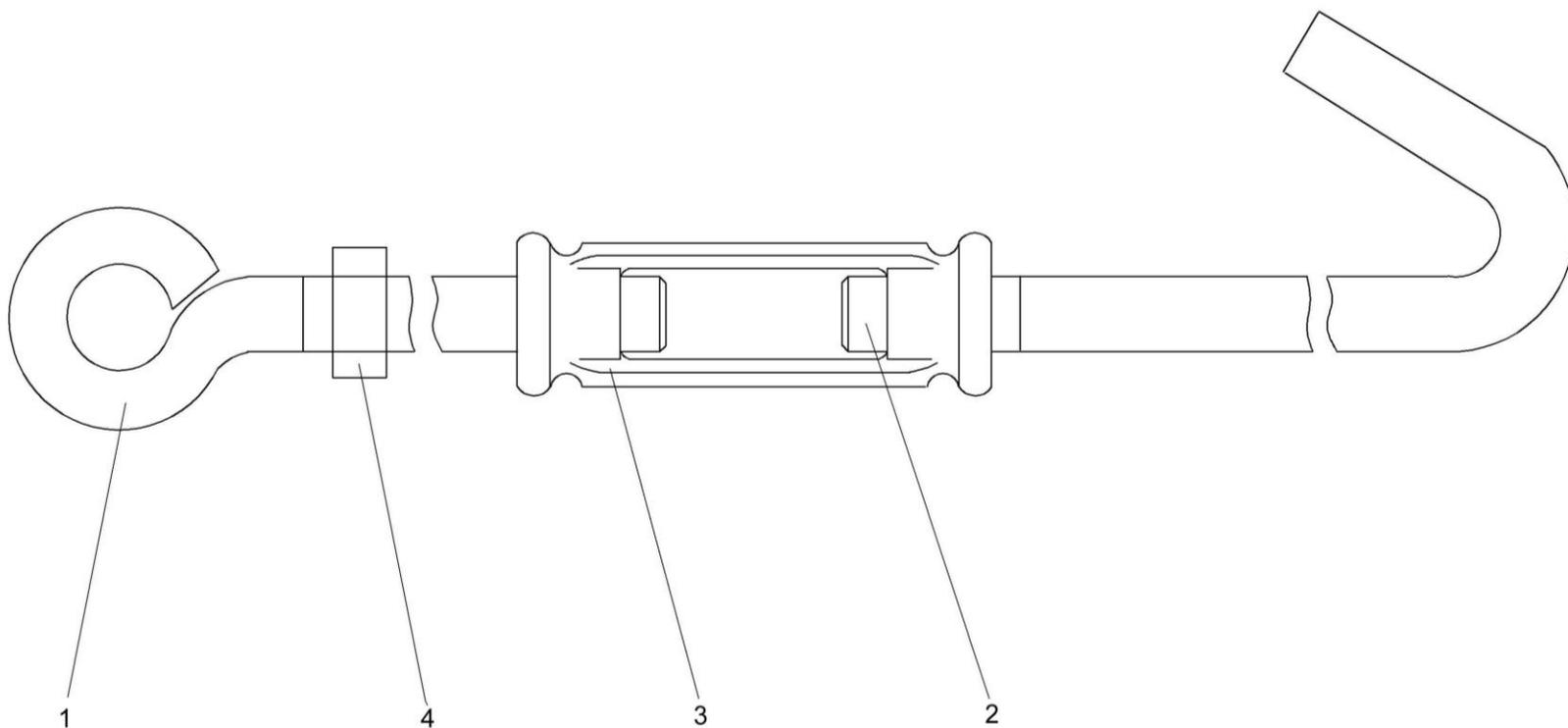
Рисунок 232 – Устройство натяжное КИС 0209020
