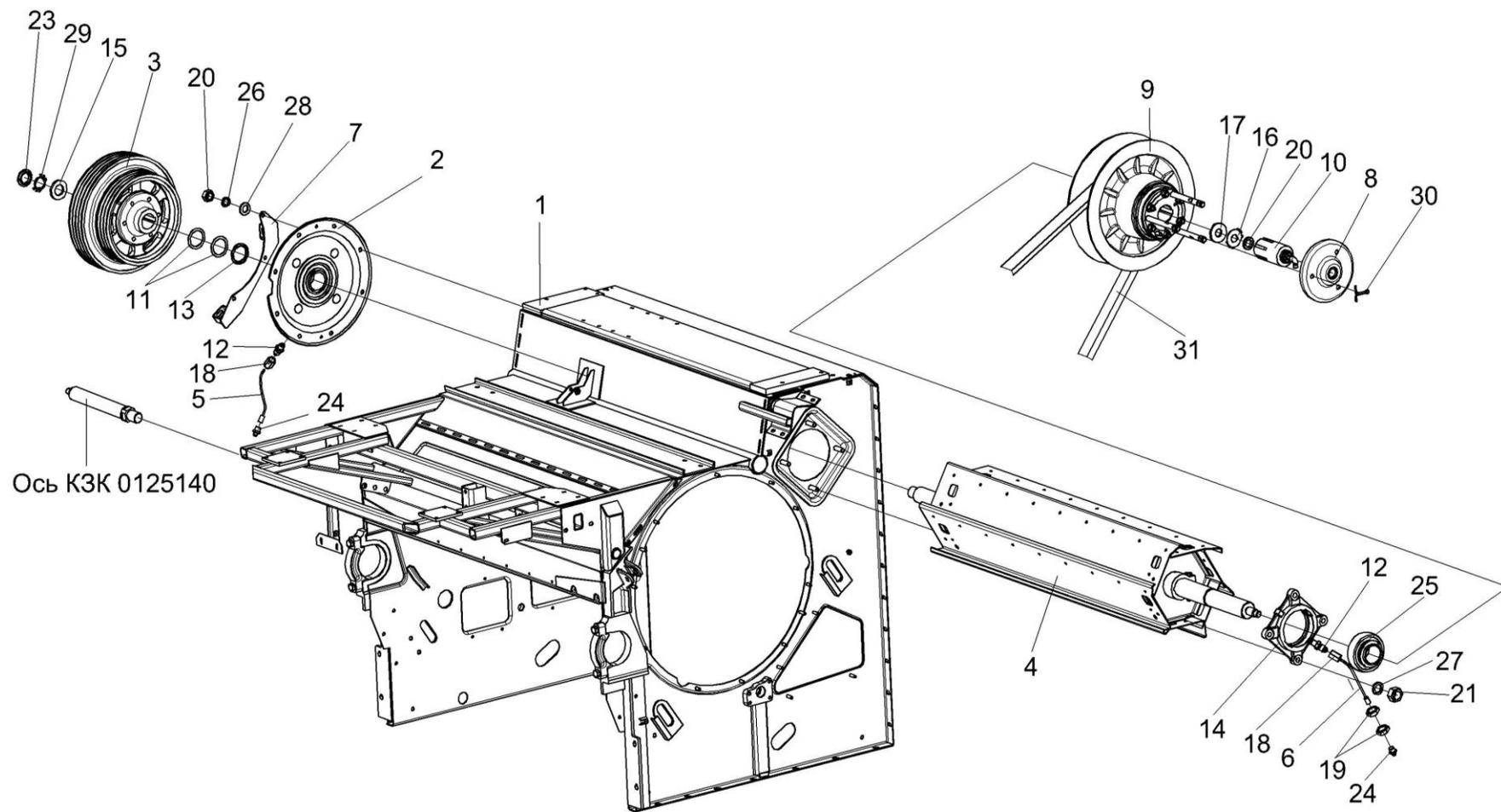
Рисунок 14 – Аппарат молотильный КЗК-10-0102000Р2 (установка битера отбойного)
