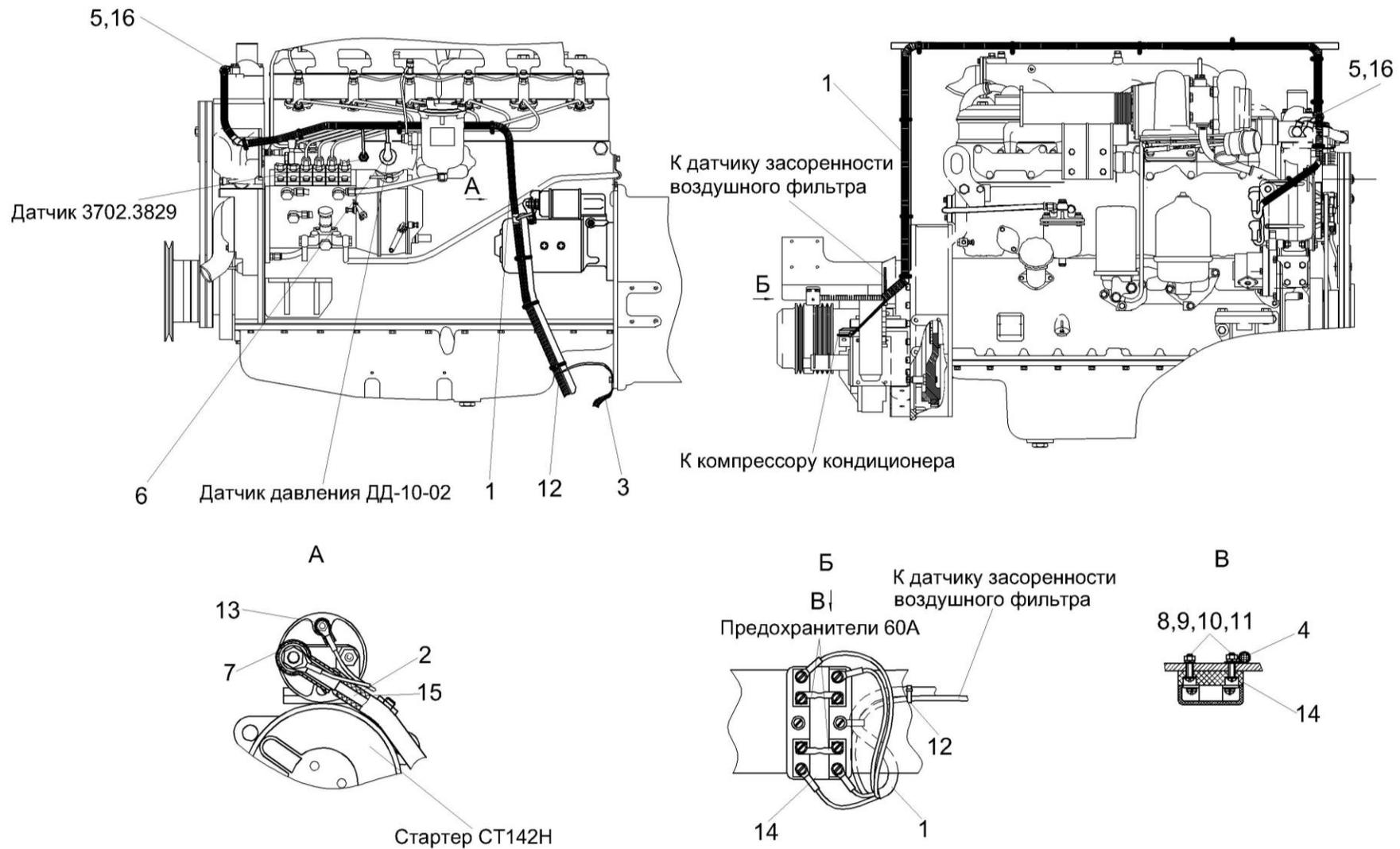
Рисунок 175 – Электрооборудование двигателя КЗК-10-1-0106000
