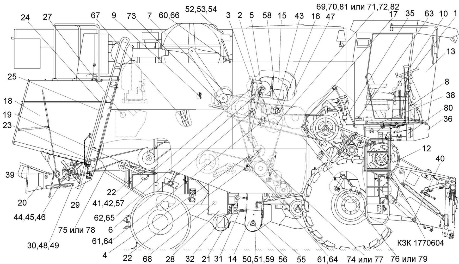
Рисунок 2 – Молотилка самоходная КЗК-10-0100000Б-03 (вид справа)
