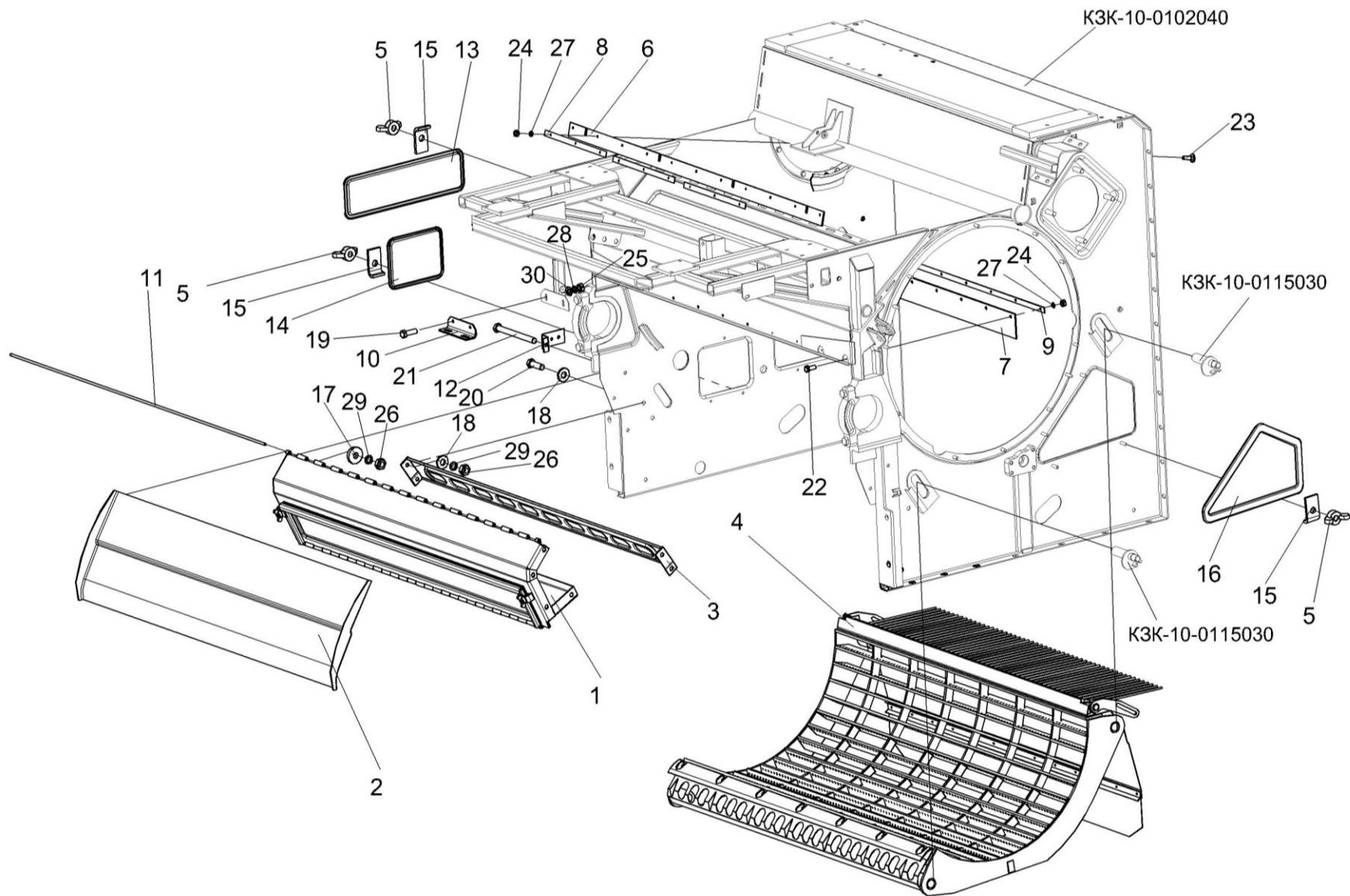
Рисунок 25 – Аппарат молотильный КЗК-10-0102000Р2 (установка камнеуловителя и подбарабанья)
