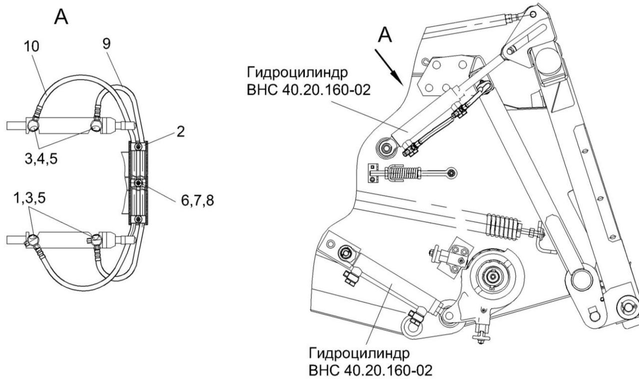
**Рисунок 139 – Система гидравлическая КЗК-10-1790000**
