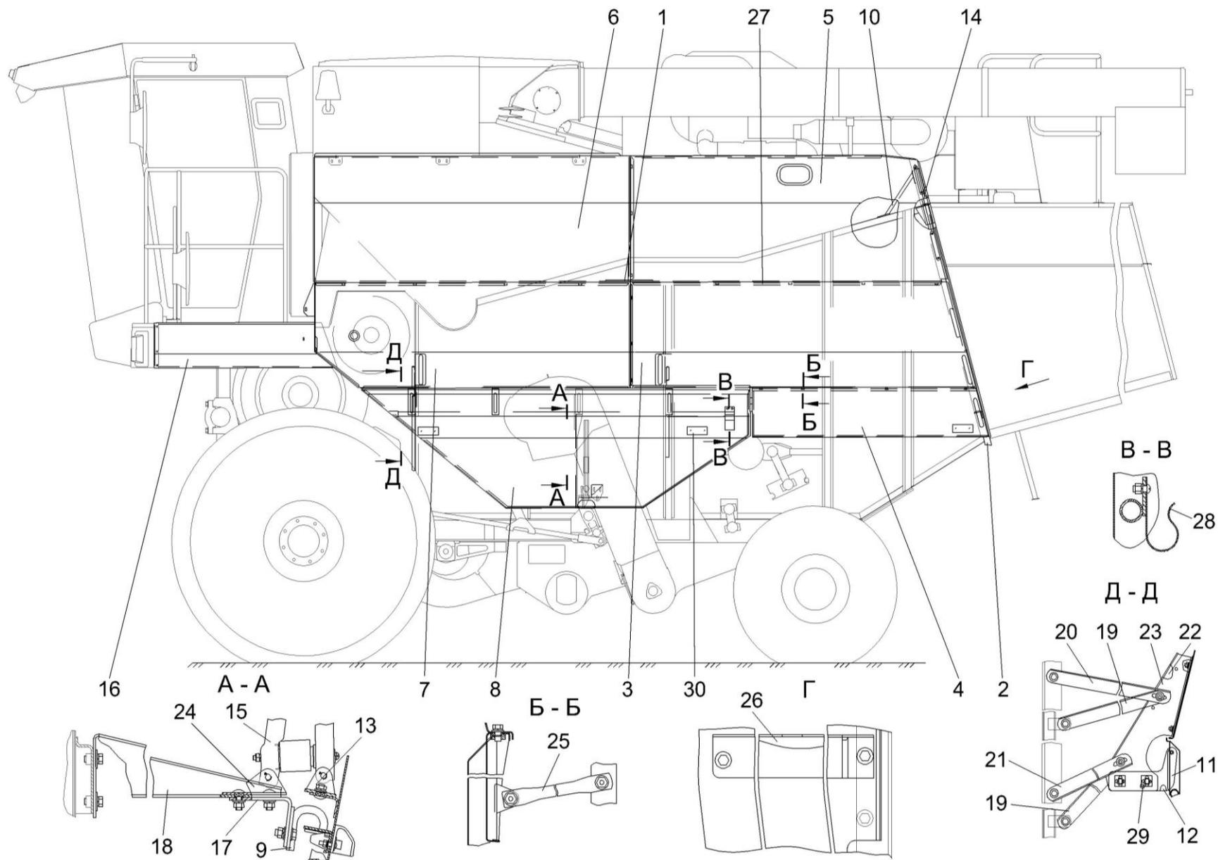
Рисунок 188 – Установка капотов и ограждений КЗК-10-0128000P2 (вид слева)
