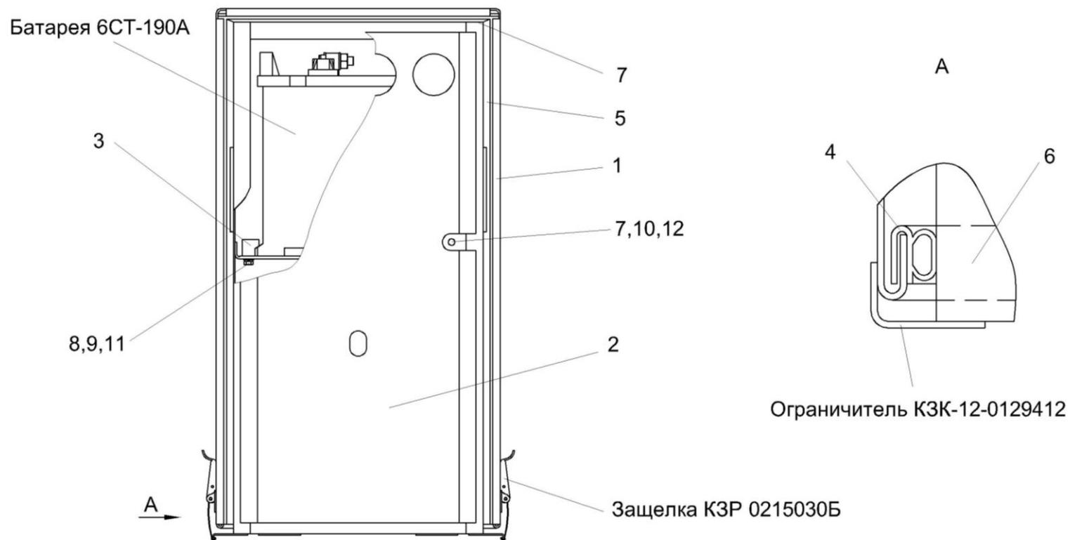
Рисунок 234 – Ящик аккумуляторный КЗК-12-0129000А
