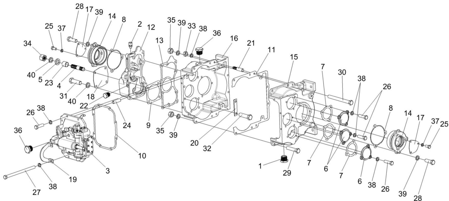
Рисунок 44 – Коробка диапазонов 3518020-46150 (корпус, крышки)
