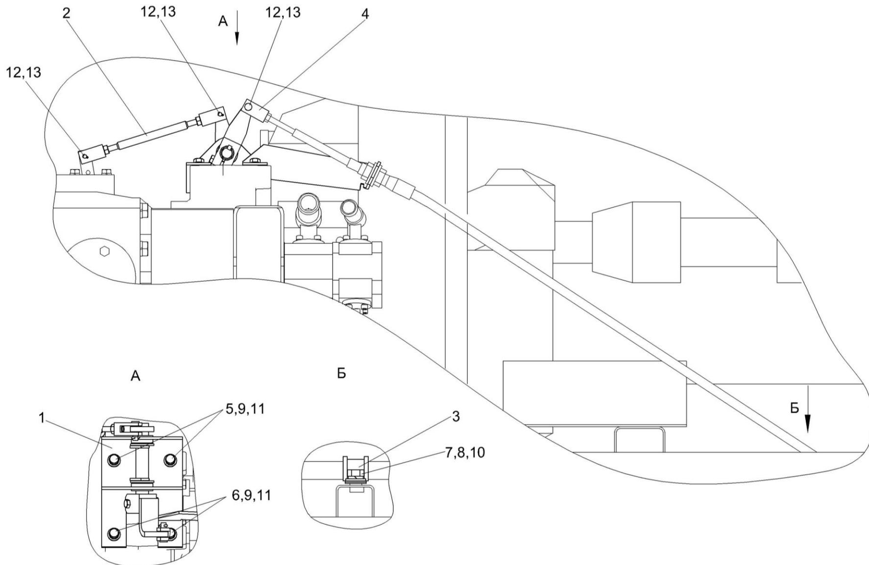
Рисунок 222 – Установка троса управления гидронасосом хода КЗК-10-1-0119150
