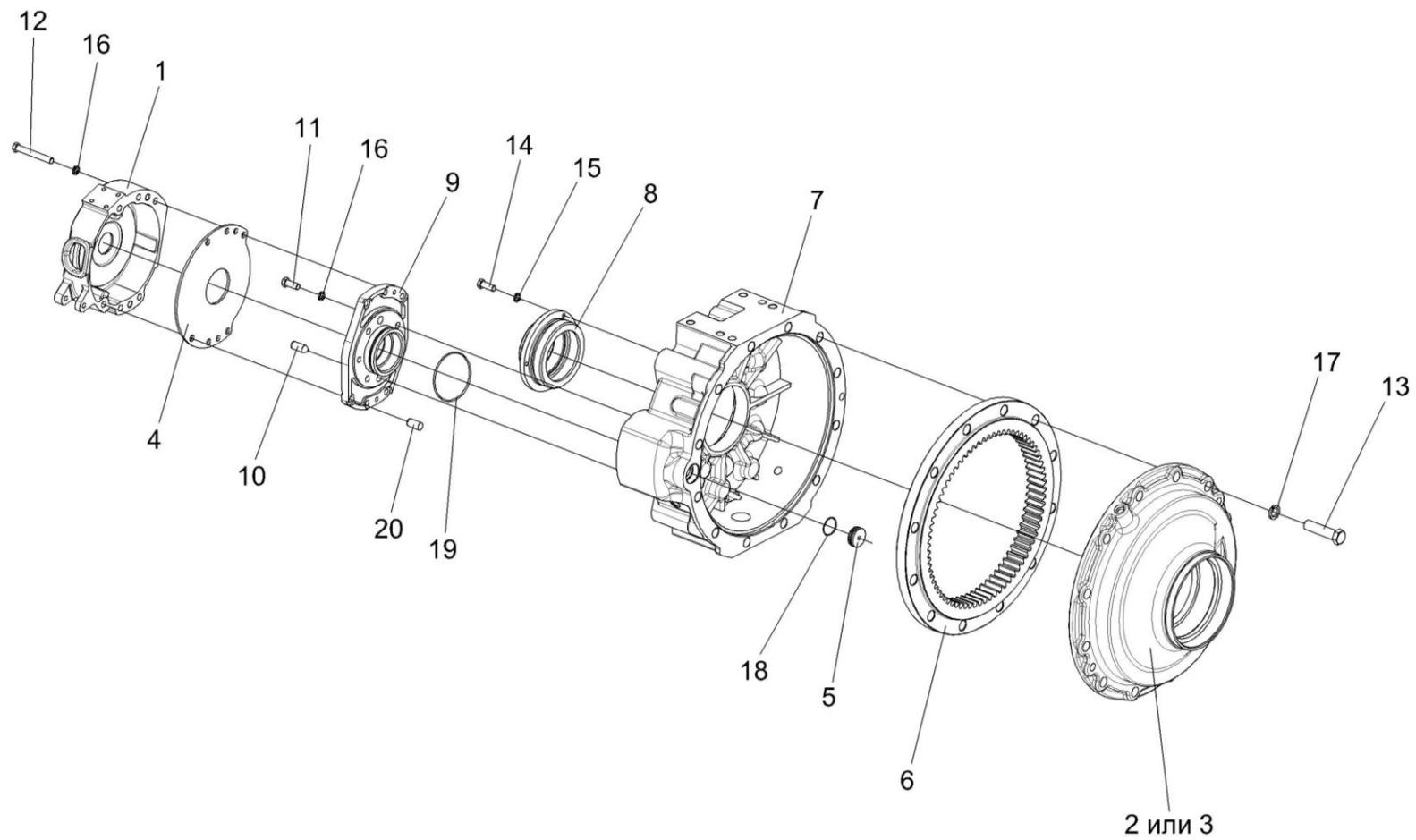
Рисунок 37 – Редуктор правый МК-23М.04.000-03 (корпус, крышки)
