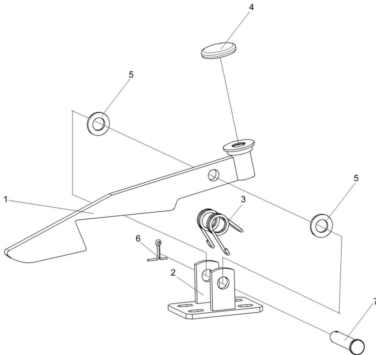
Рисунок 191 – Механизм фиксации трапа КЗС 0117100
