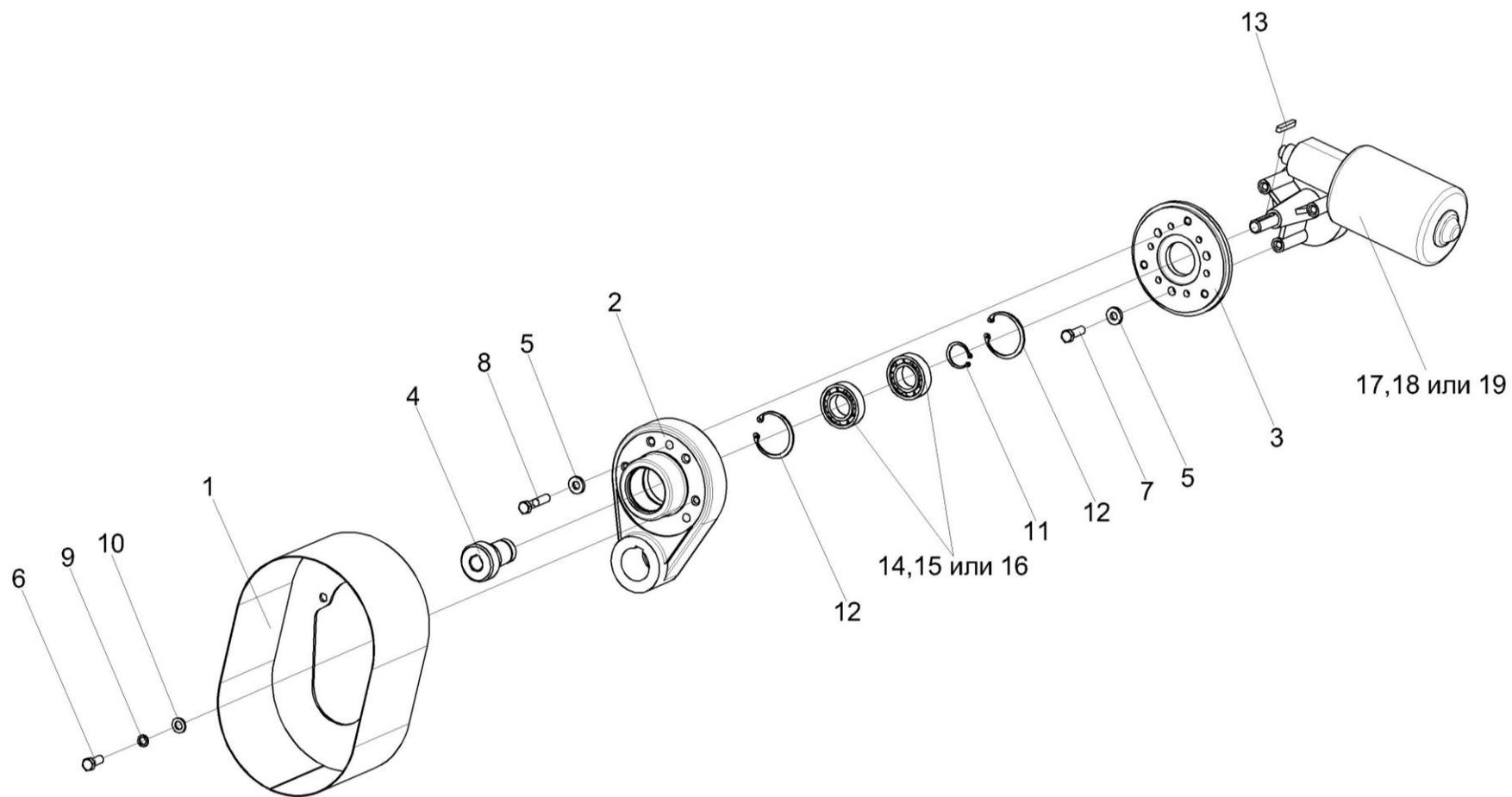
Рисунок 91 – Привод КЗК-12-0202690А
