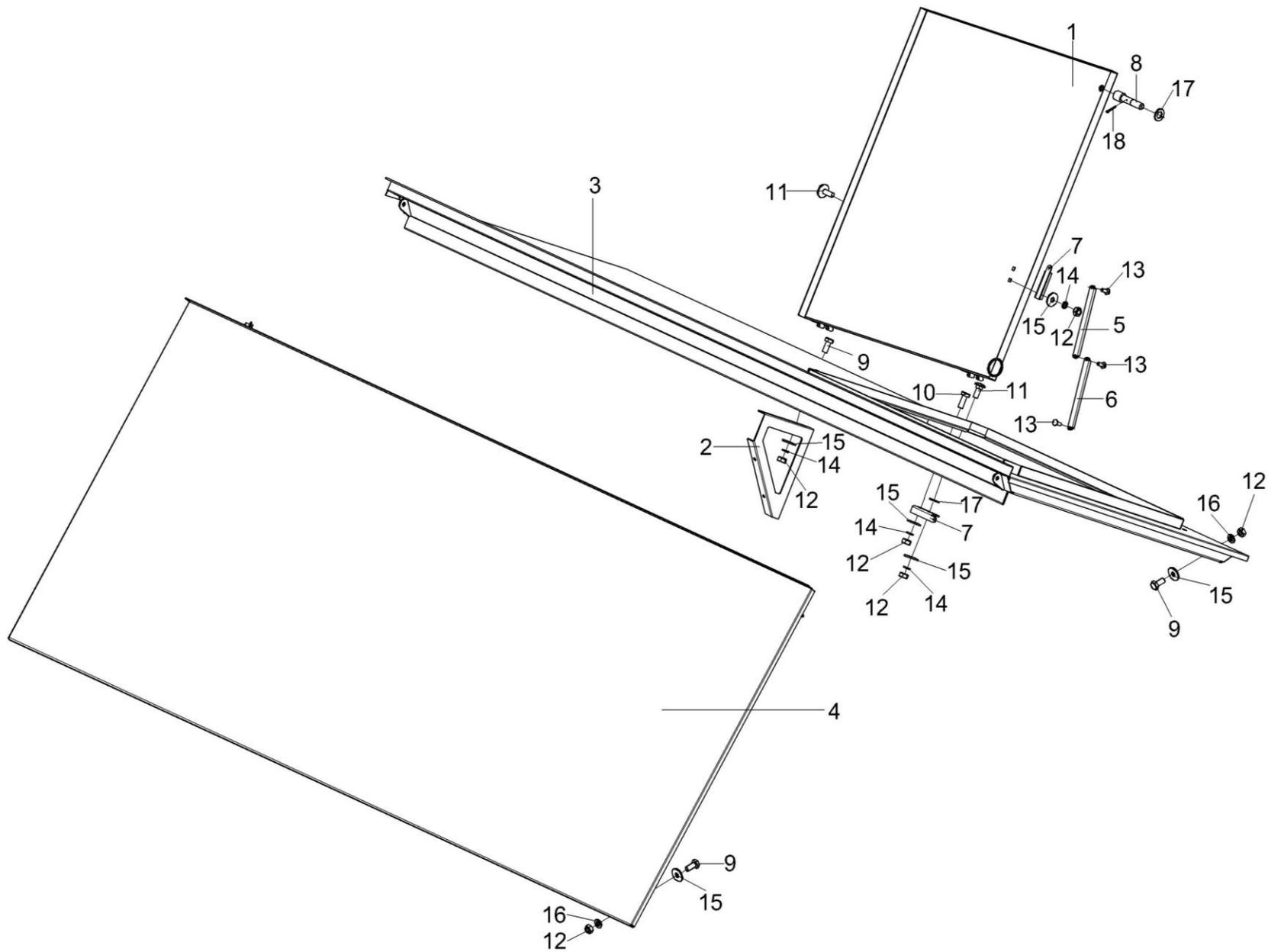
Рисунок 108 – Установка крыши КЗК-10-0204370А (лист 1)
