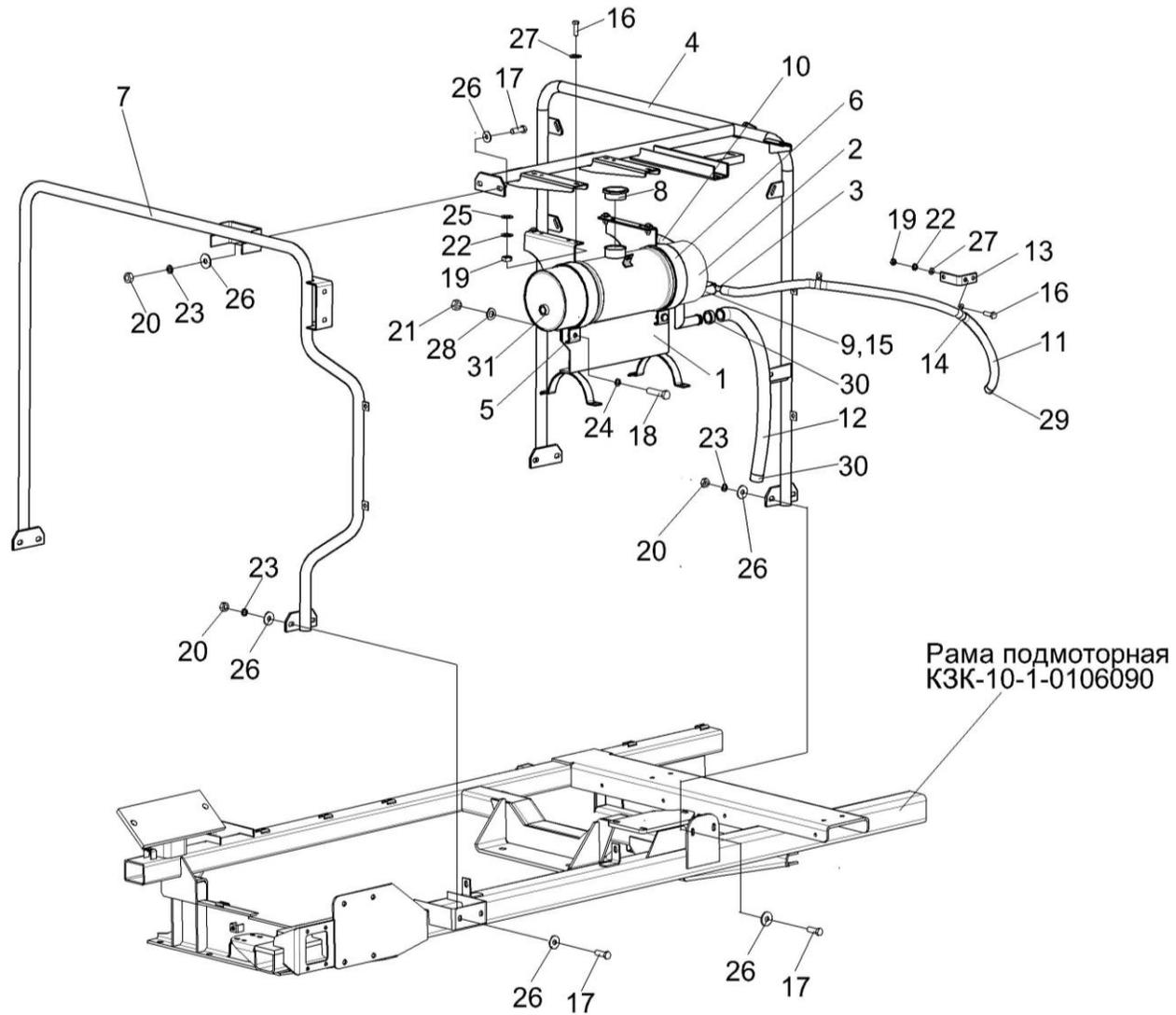
Рисунок 164 – Установка бачка расширительного K3K-10-1-0106070
