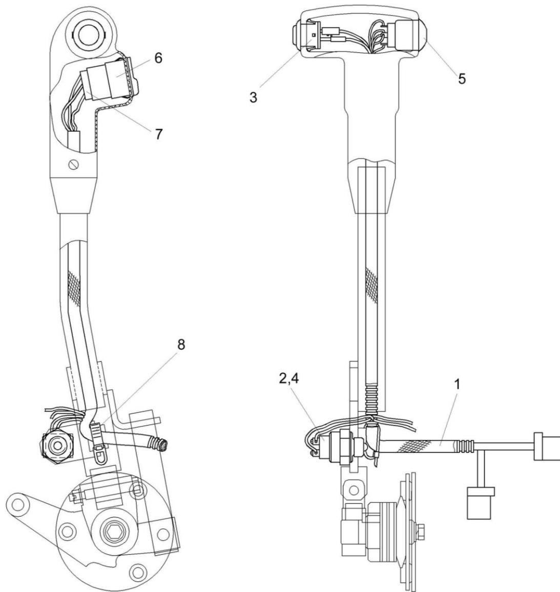
Рисунок 206 – Электрооборудование привода KBC-1-0129550A
