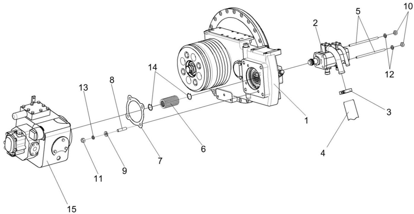
Рисунок 155 – Установка гидронасосов КЗК-10-1-0106310
