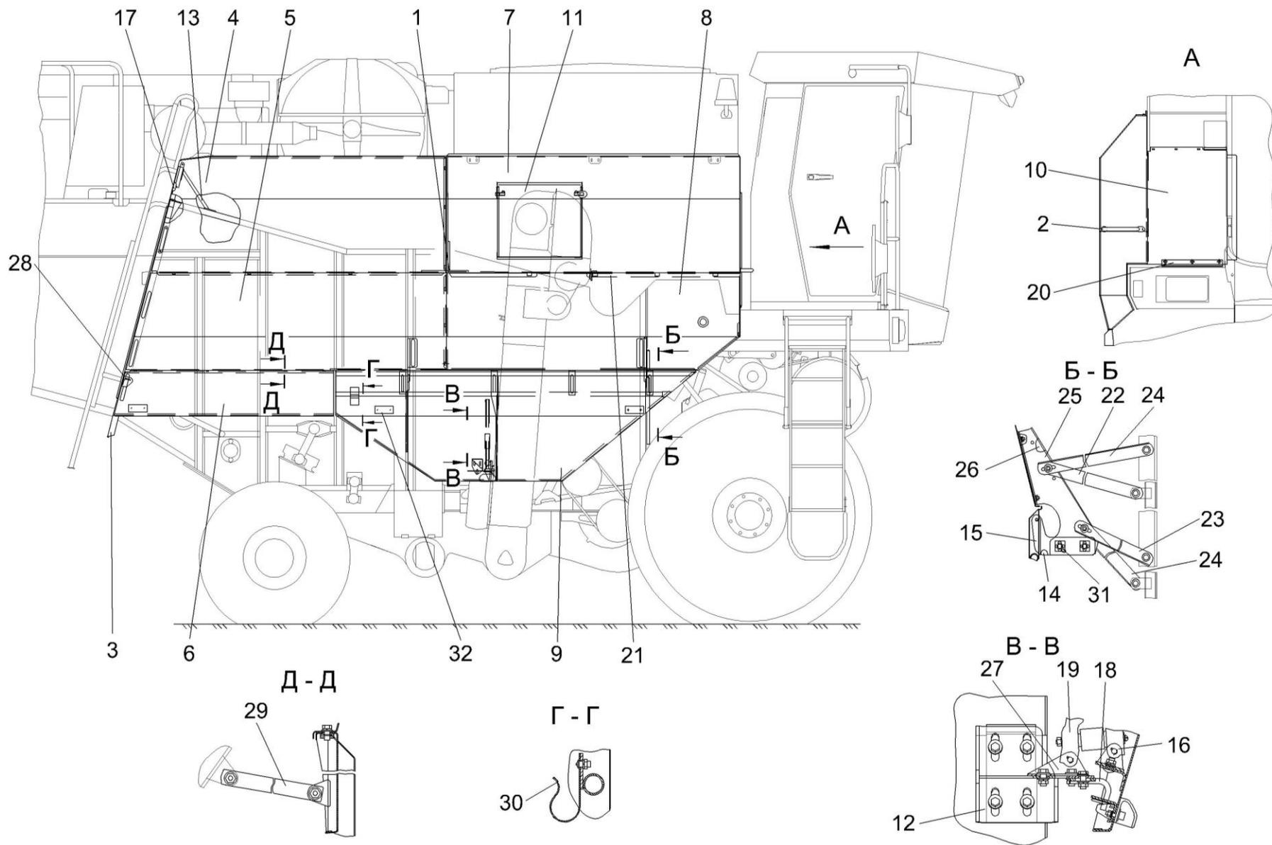
Рисунок 189 – Установка капотов и ограждений КЗК-10-0128000P2 (вид справа)
