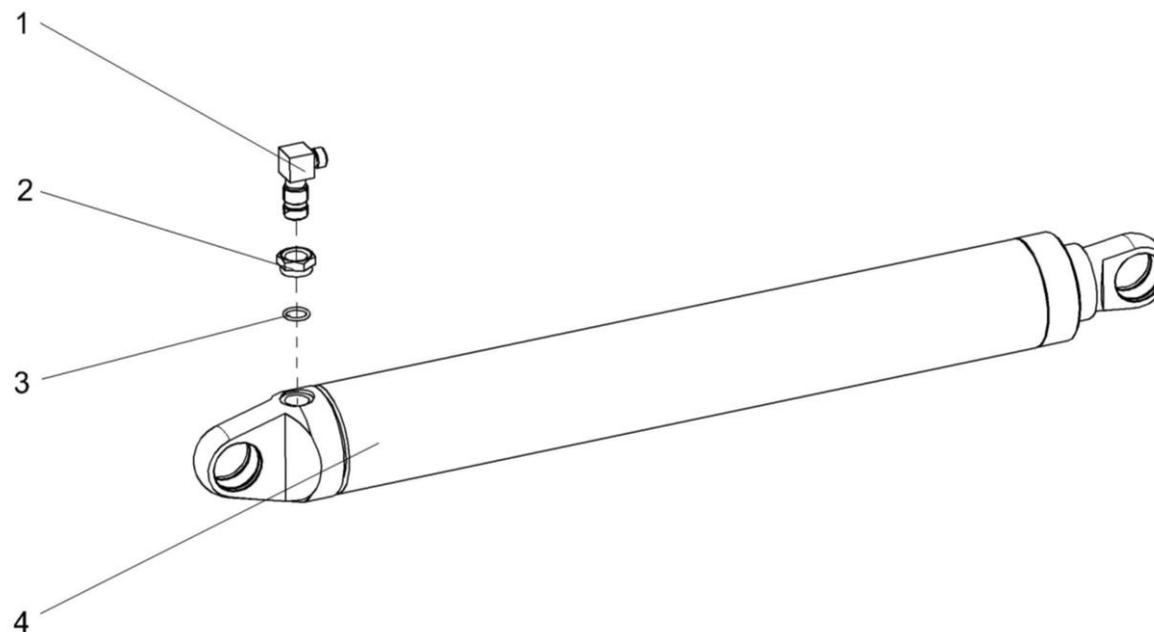
Рисунок 245 – Гидроцилиндр КЗК-10-1-0602500
