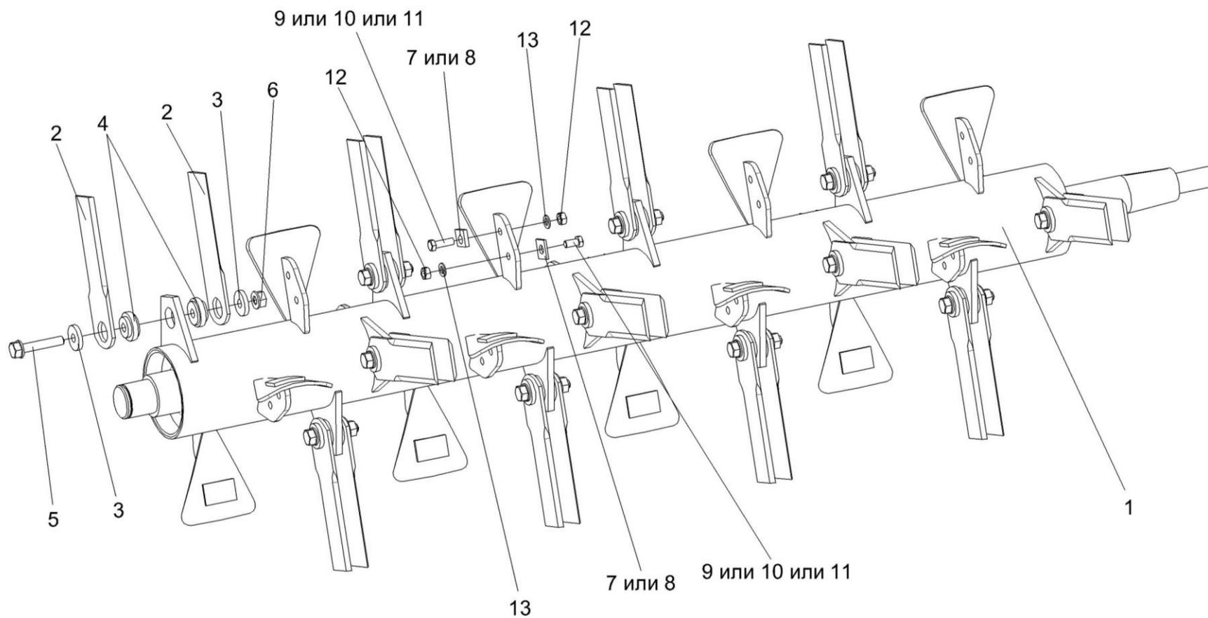
Рисунок 143 – Ротор измельчителя КЗК-10-0290140
