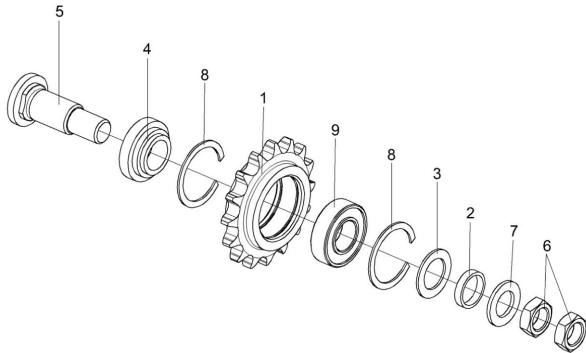
Рисунок 107 – Звездочка КЗР 0219070Б
