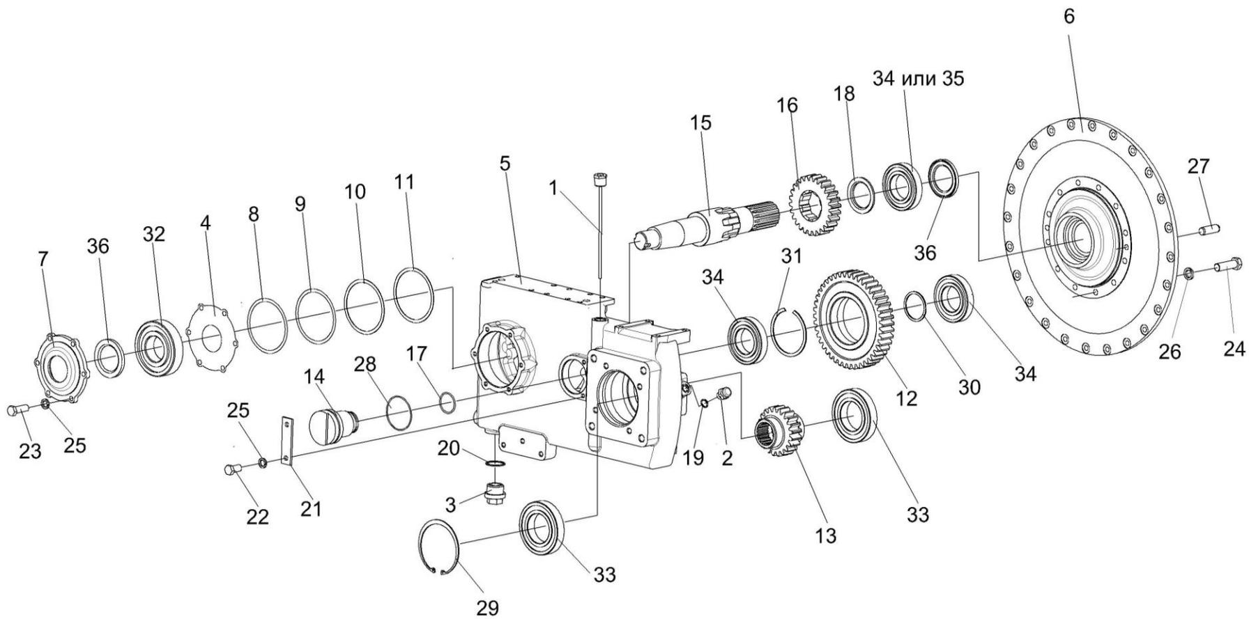
Рисунок 157 – Мультипликатор КЗК-12-0114000
