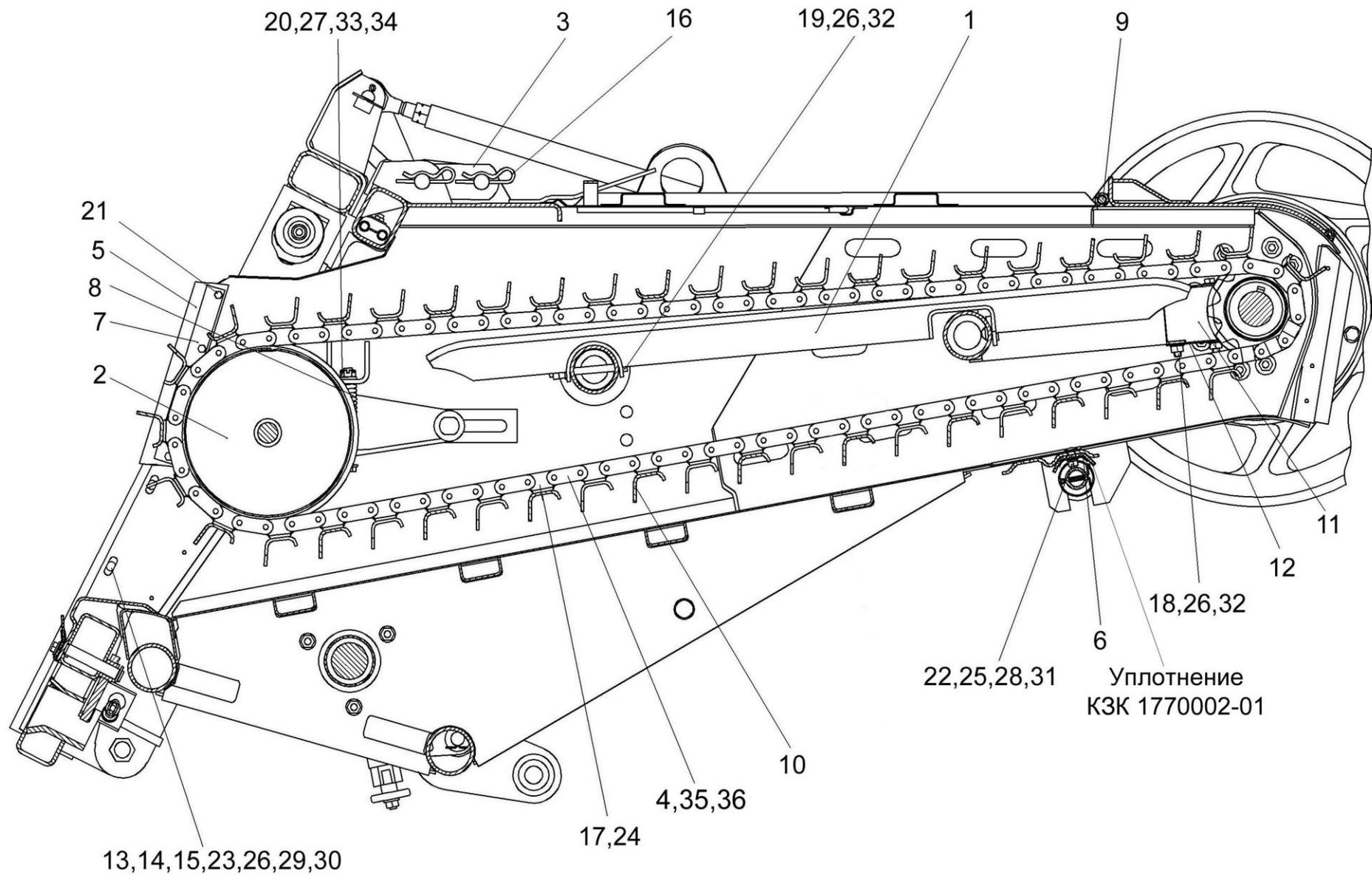
Рисунок 134 – Установка транспортера КЗК 1877400 наклонной камеры
