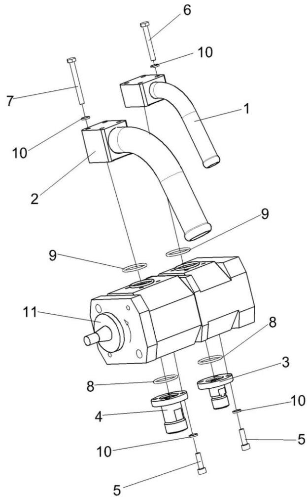
Рисунок 154 – Гидронасос двухсекционный КЗК-12-0602910
