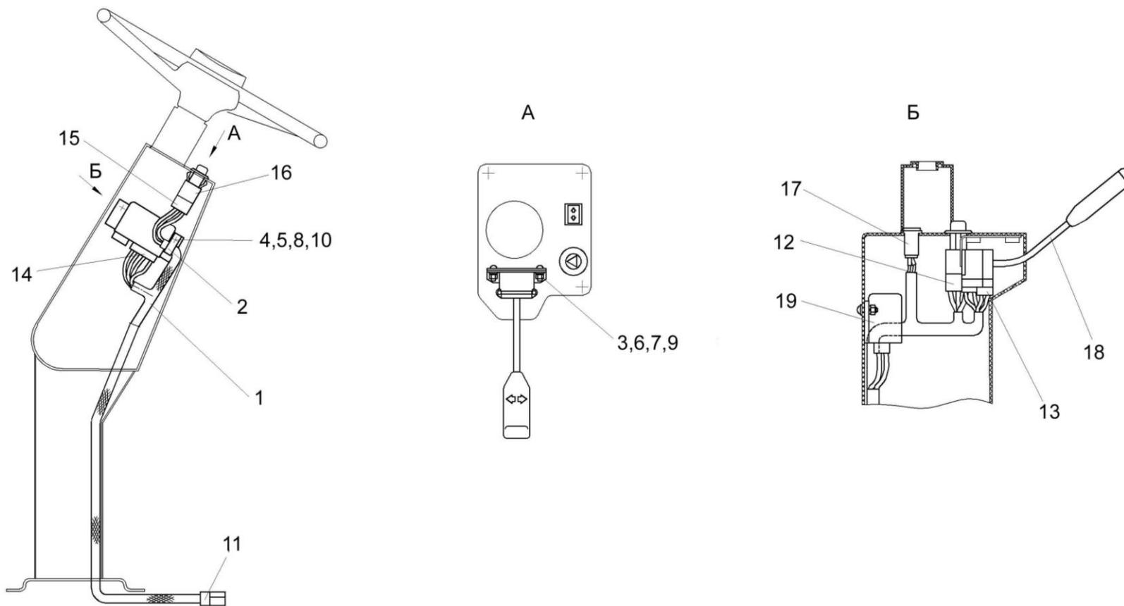
Рисунок 216 – Электрооборудование рулевой колонки КВС-1-0129230-01
