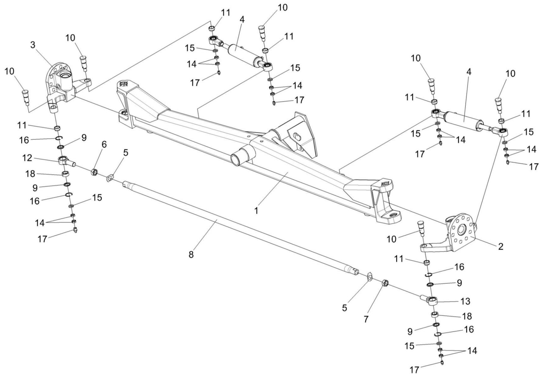
Рисунок 51 – Мост управляемых колес КЗК-10-0109300 (лист 2)
