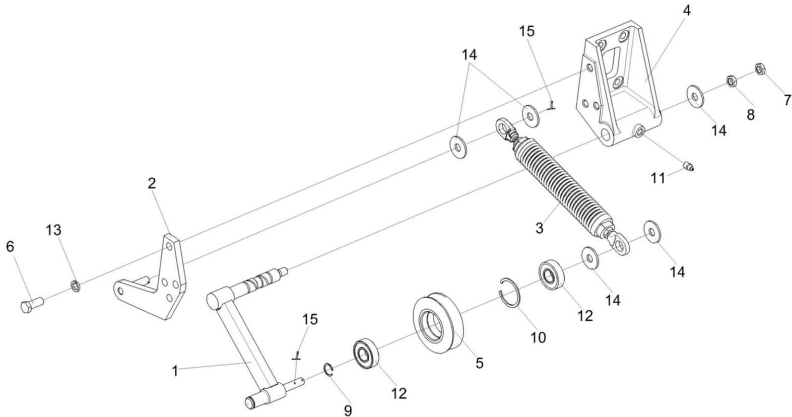
Рисунок 173 – Устройство натяжное КЗК-10-0112010
