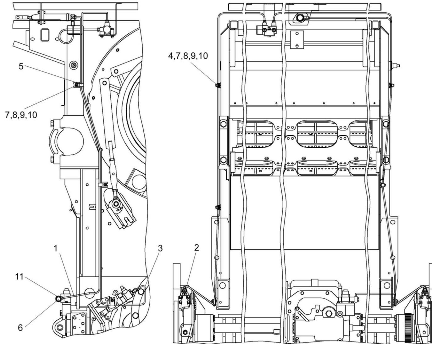
Рисунок 223 – Установка трубопроводов моста ведущих колес КЗК-10-0119250
