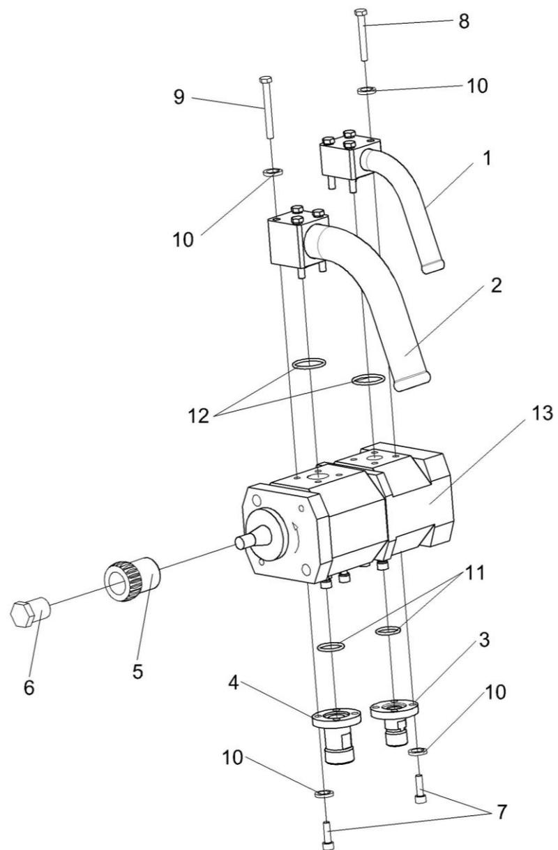
Рисунок 158 – Гидронасос двухсекционный КЗК-12-0602940
