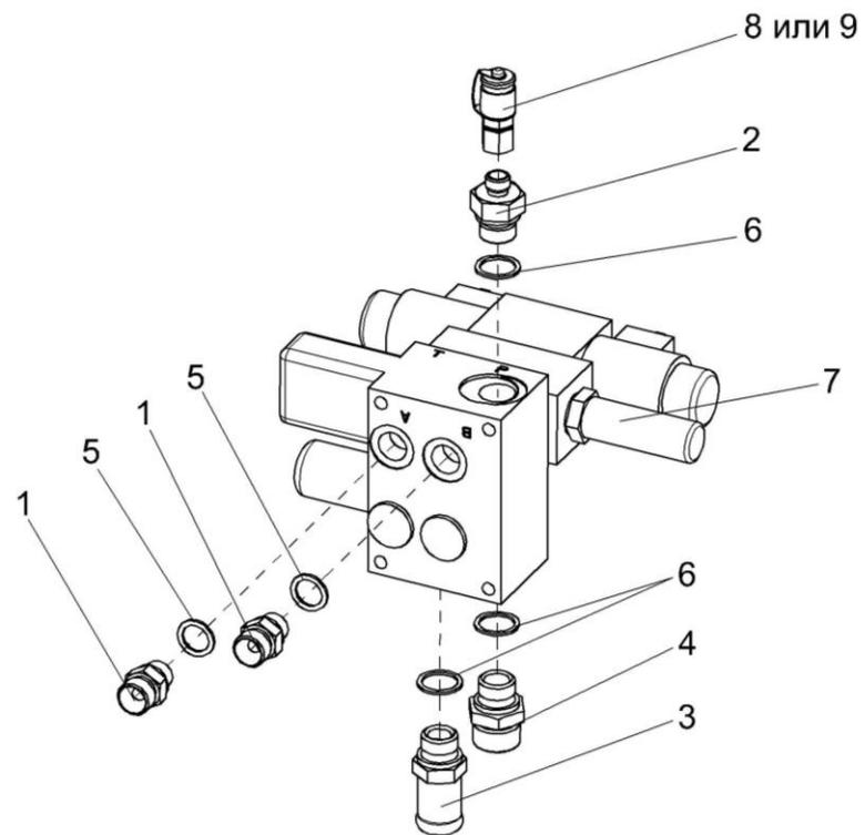
Рисунок 255 – Гидроблок односекционный КЗК-12-0602670
