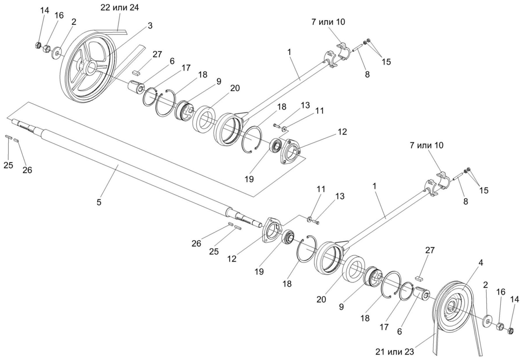
Рисунок 96 – Установка шатуна КЗР0202030Е и шкивов КЗК-12-0202109А и КЗК-12-0202111А
