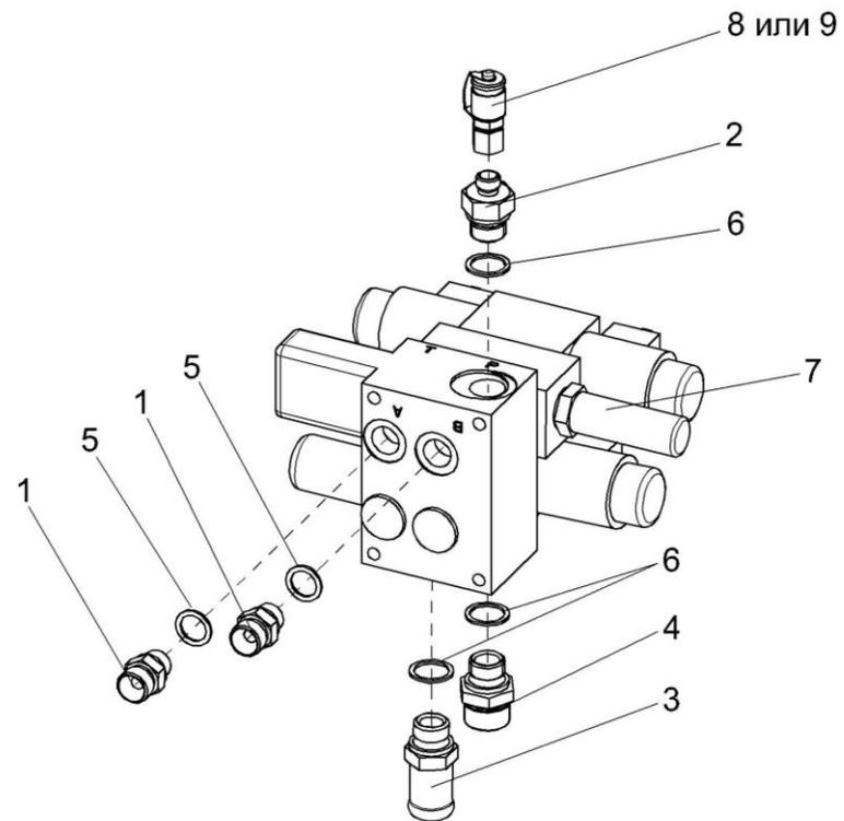
Рисунок 254 – Гидроблок двухсекционный КЗК-12-0602660
