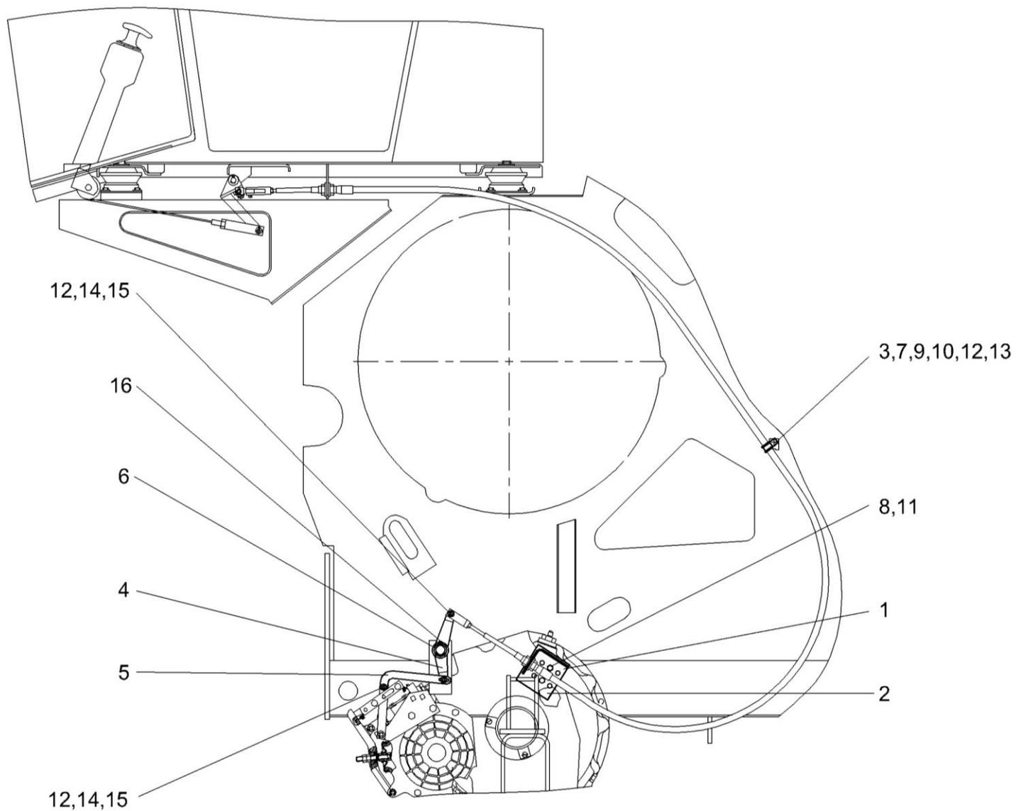
Рисунок 221 – Установка тросов управления стояночным тормозом КЗК-10-0119100
