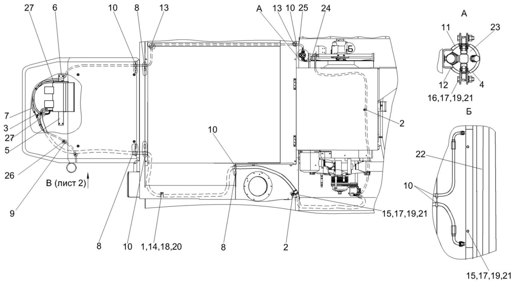
Рисунок 185 – Установка кондиционера КЗК-10-0113000В (лист 1)
