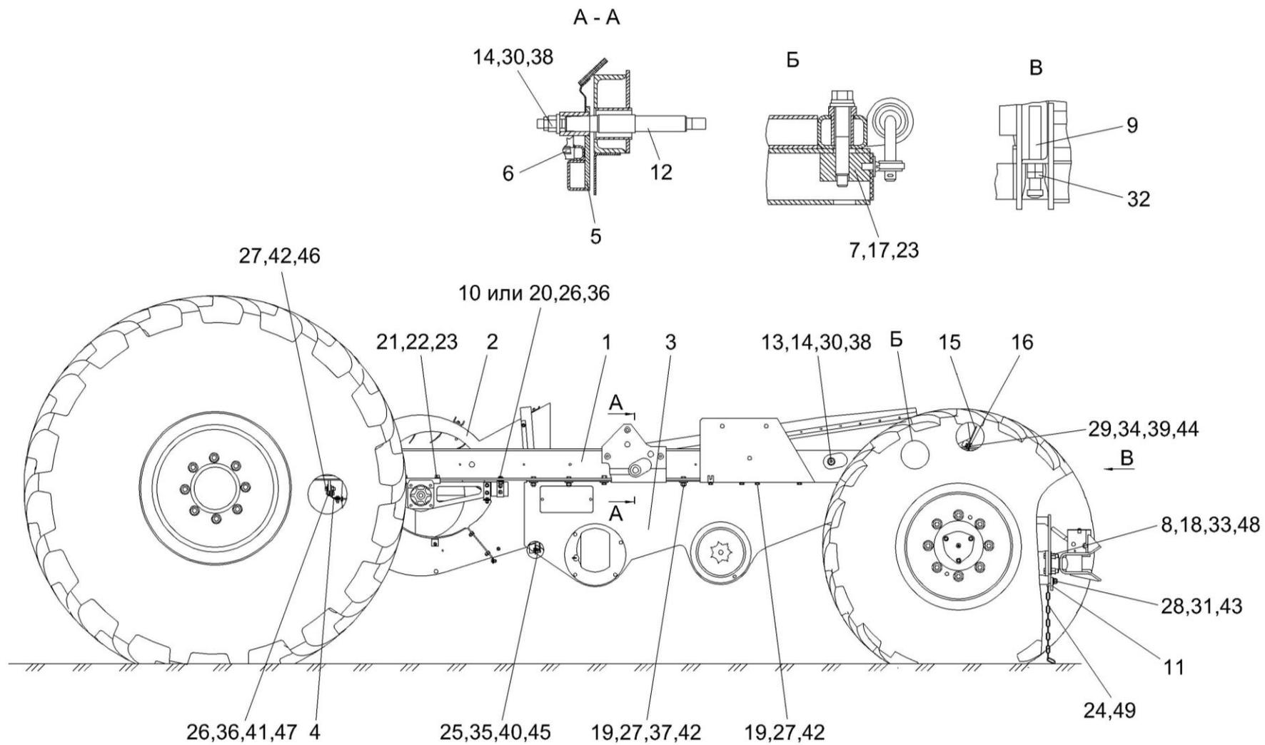
Рисунок 31 – Шасси КЗК-10-0111010P2 (вид слева)
