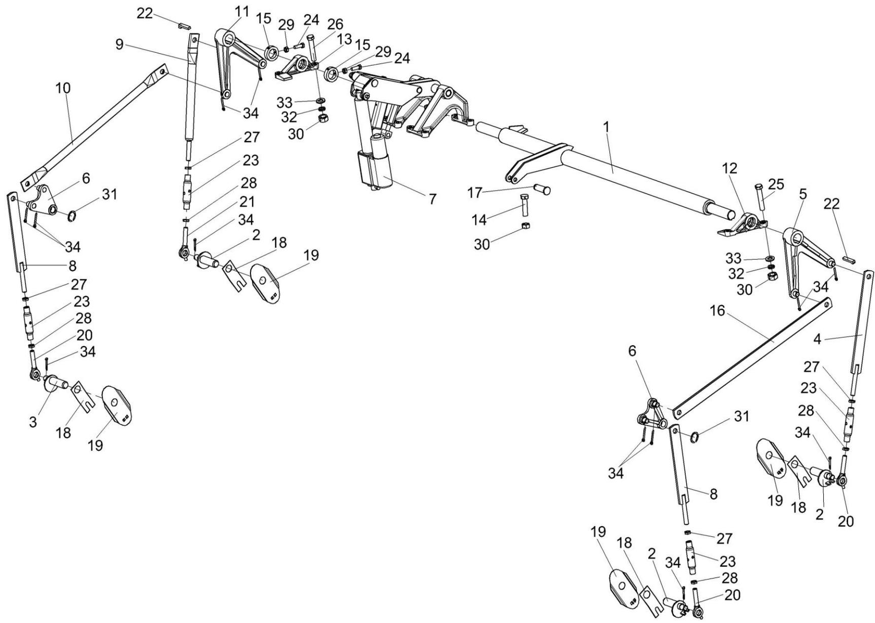
Рисунок 28 – Аппарат молотильный КЗК-10-0102000Р2 (установка механизма подъема подбарабанья)
