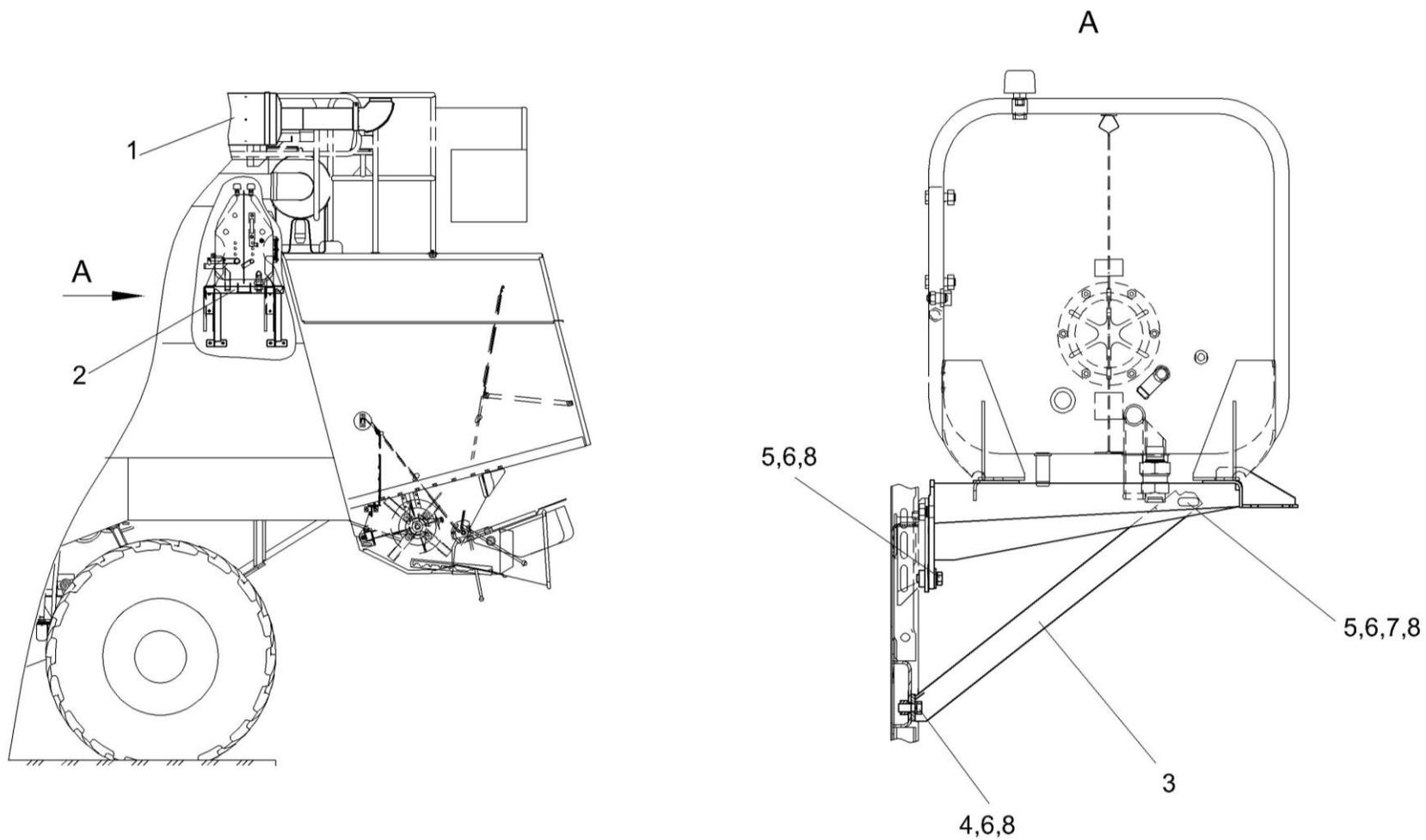
Рисунок 178 – Установка кронштейна под масляный бак КЗК-10-0100340Р2
