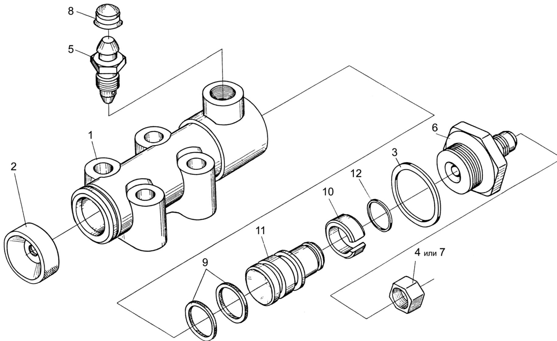
Рисунок 43 – Гидроцилиндр тормоза МК-23М.03.220А
