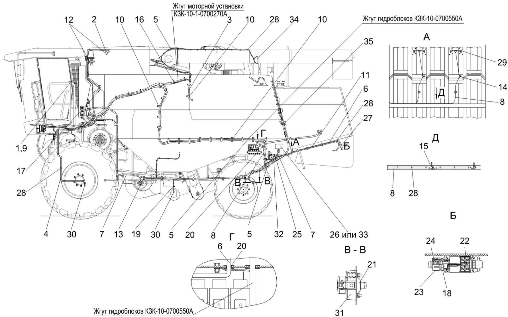
Рисунок 7 – Электрооборудование молотилки самоходной (вид слева)
