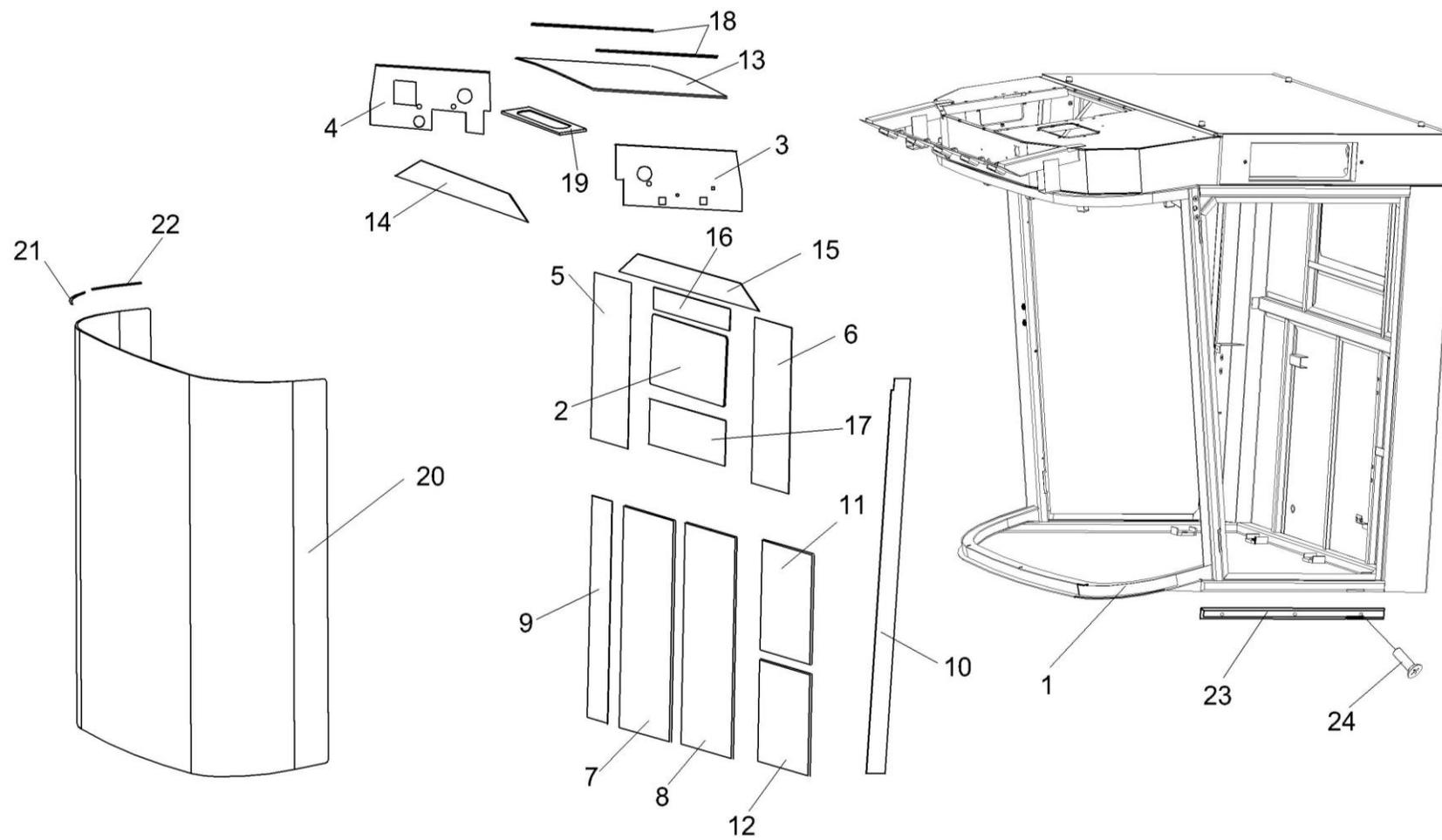
Рисунок 196 – Каркас КЗК-10-0200010
