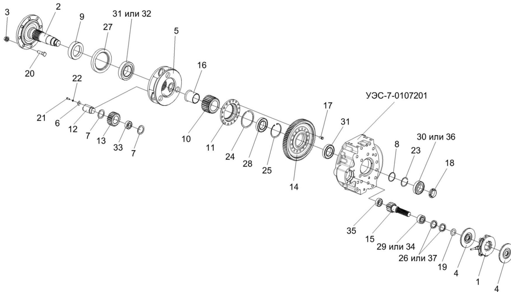
Рисунок 41 – Редуктор левый МК-23М.03.000Ж-03 (валы, шестерни)
