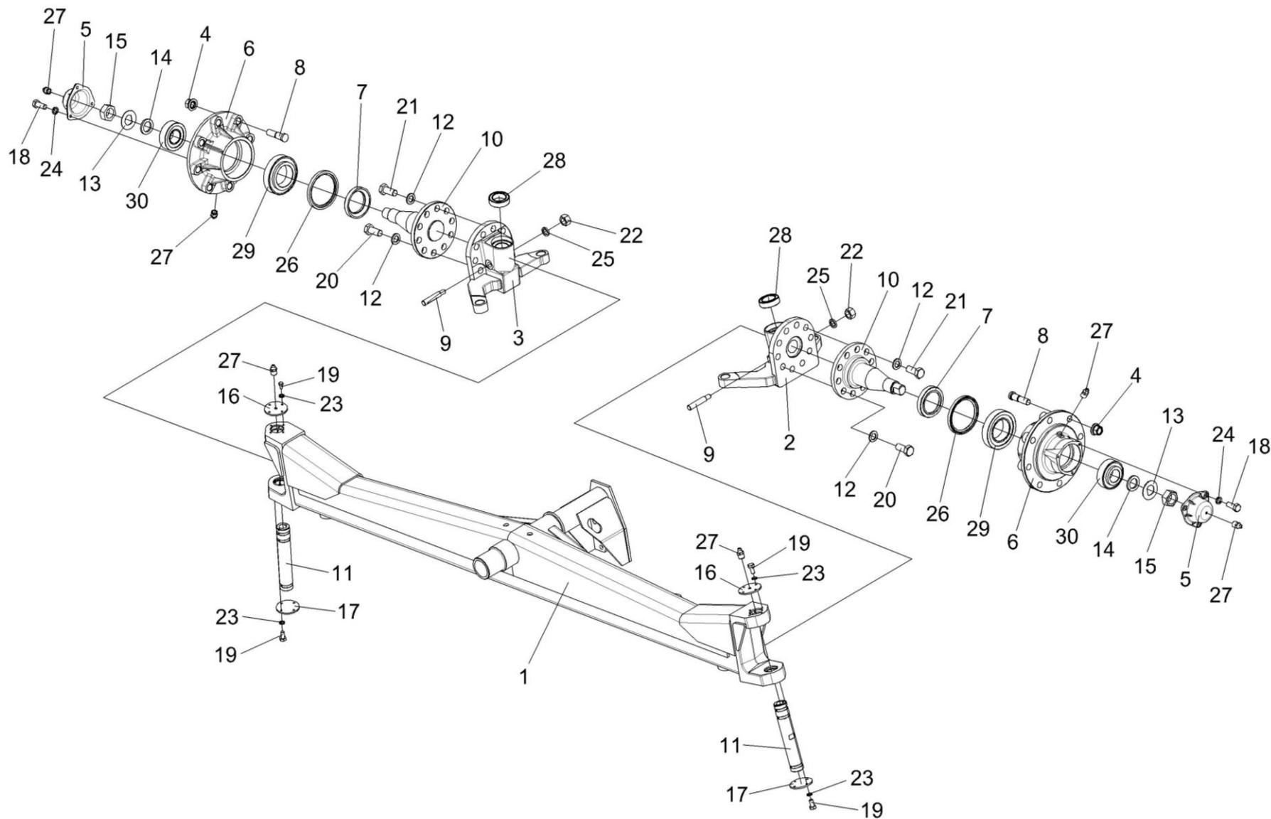
Рисунок 50 – Мост управляемых колес КЗК-10-0109300 (лист 1)
