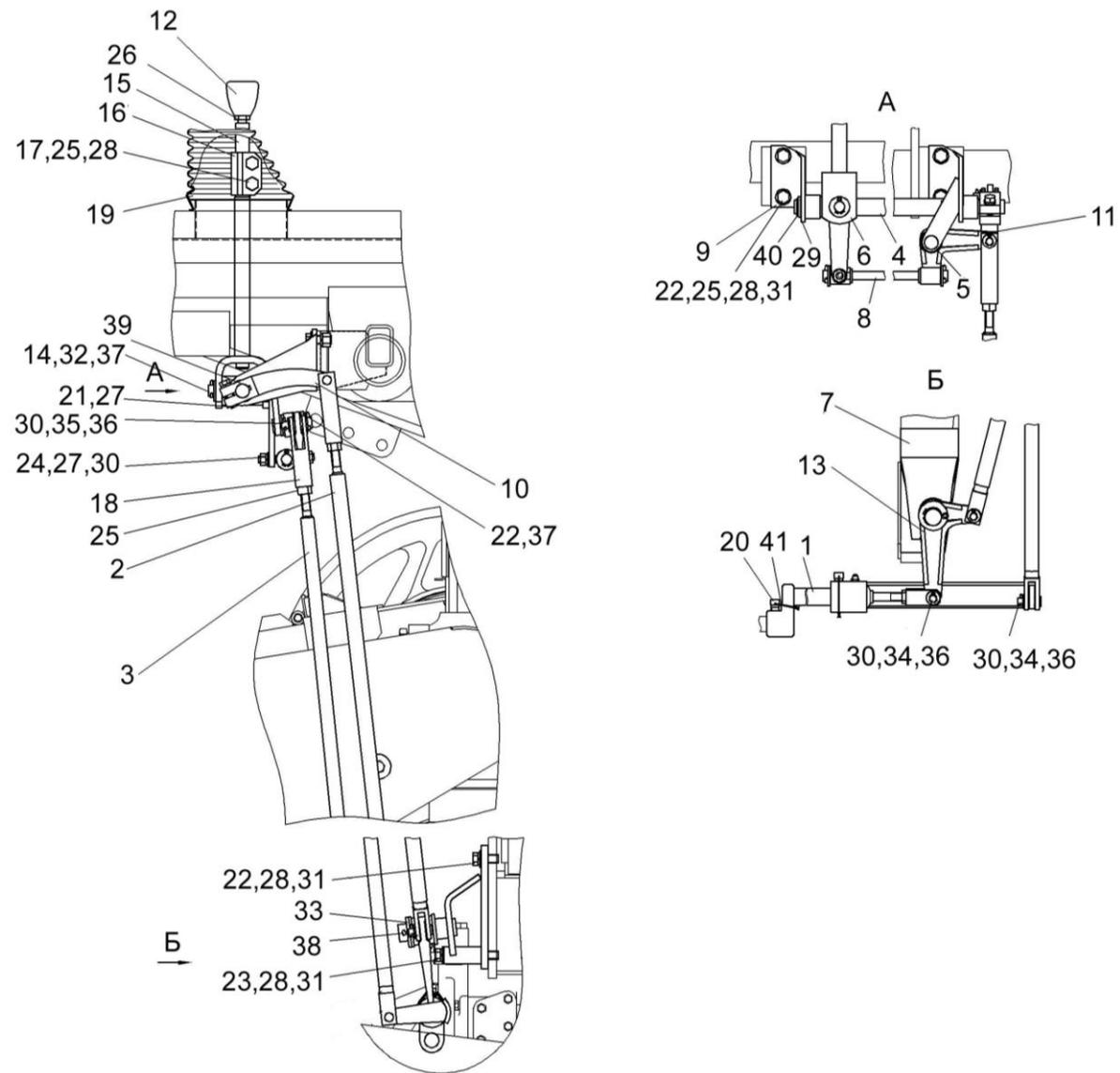
Рисунок 219 – Установка механизма управления коробкой диапазонов КЗК-10-0119040А
