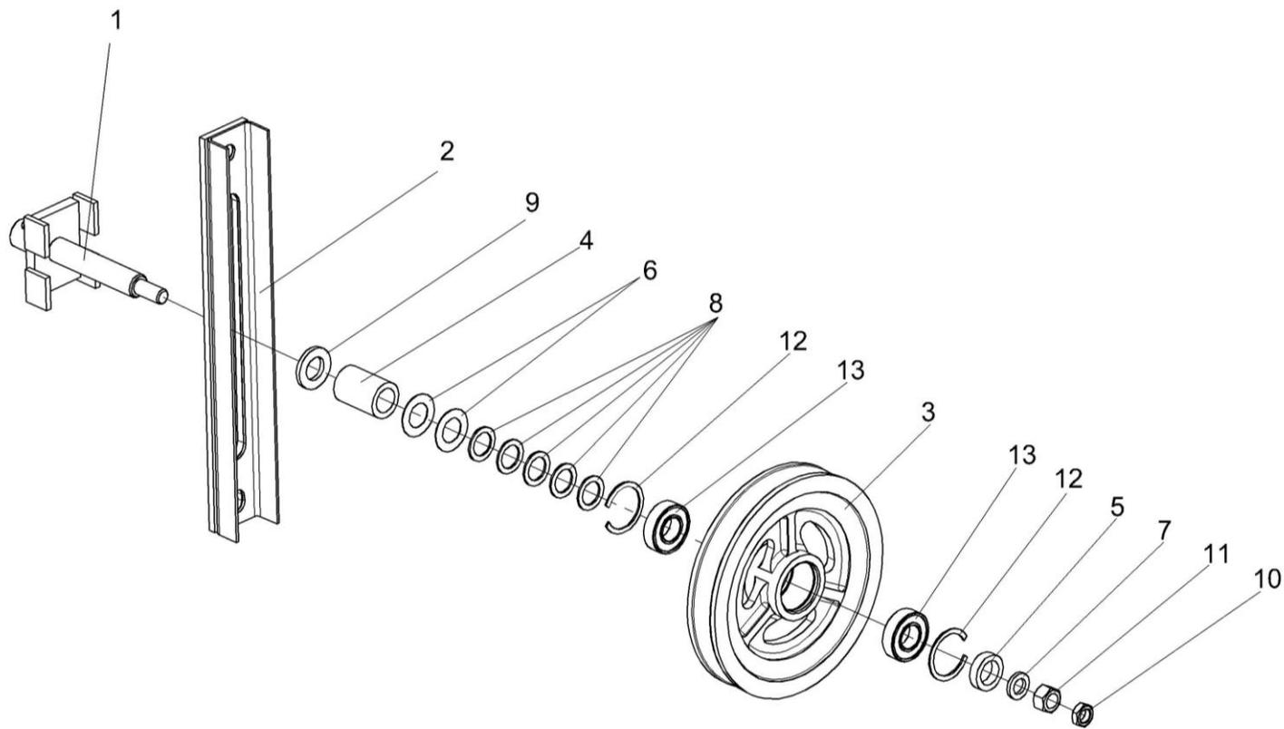
Рисунок 80 – Устройство натяжное КЗК 0202640А
