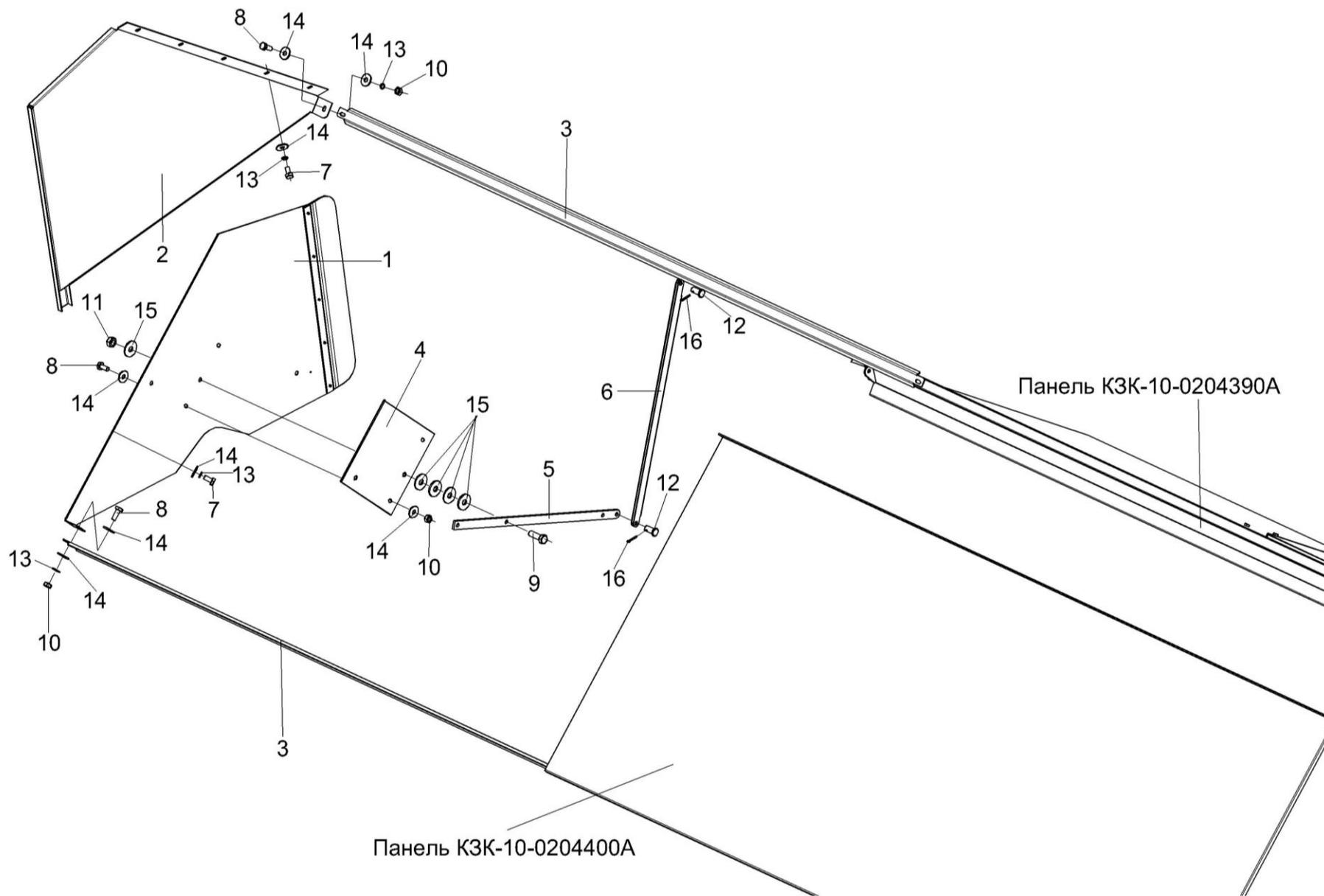
Рисунок 110 – Установка крыши КЗК-10-0204370А (лист 3)
