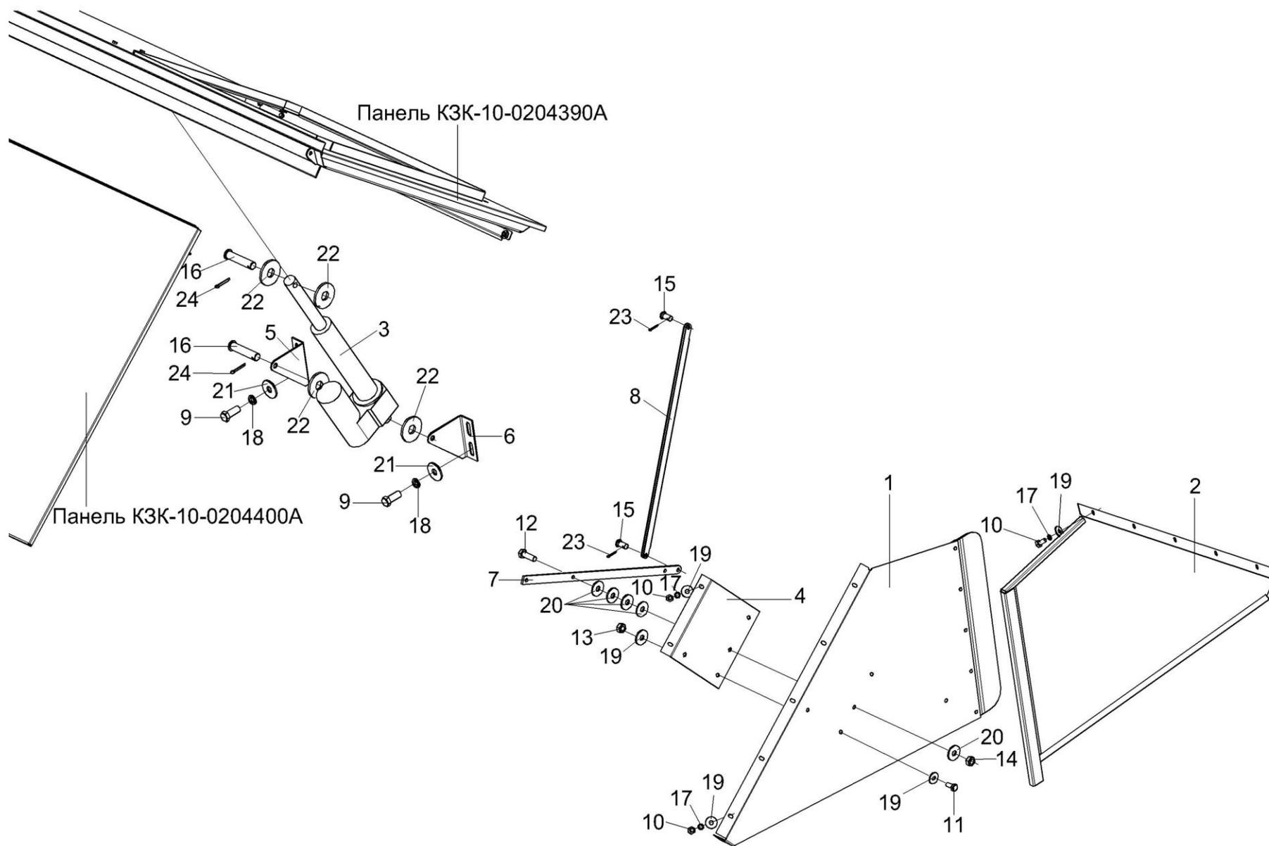
Рисунок 109 – Установка крыши КЗК-10-0204370А (лист 2)
