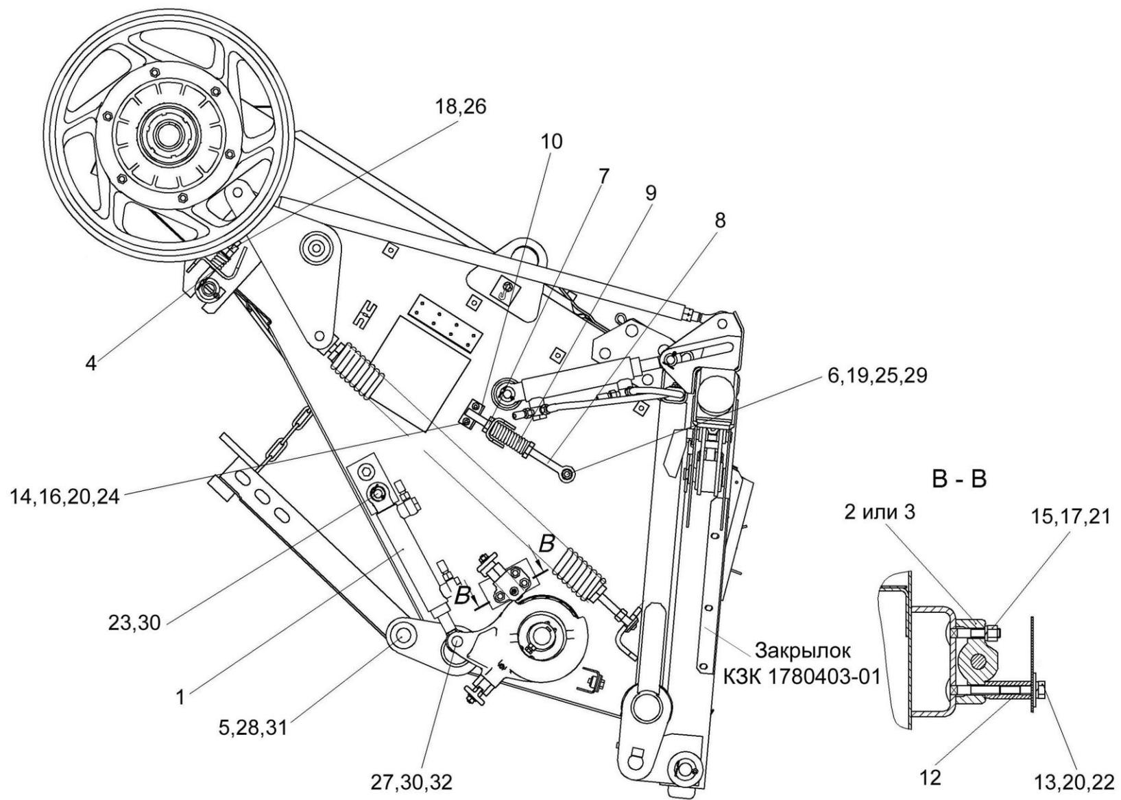
Рисунок 130 – Камера наклонная КЗК 1870000А (вид справа)
