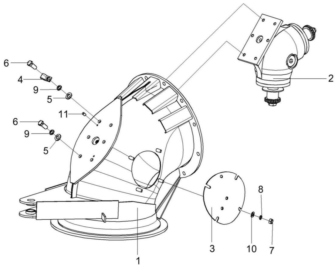
Рисунок 116 – Отвод с редуктором КЗК-12-0206090А
