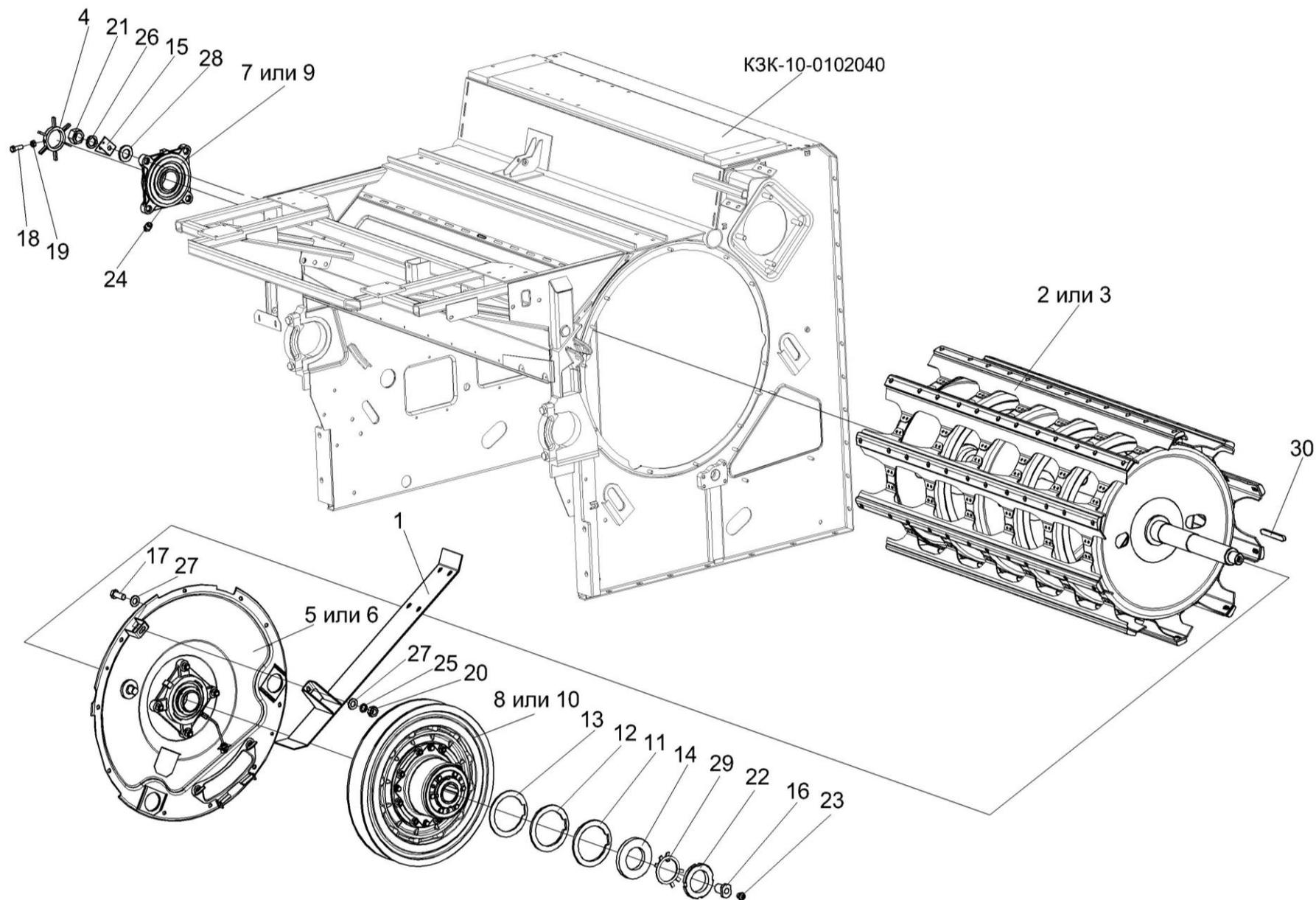
Рисунок 18 – Аппарат молотильный КЗК-10-0102000P2 (установка барабана молотильного)
