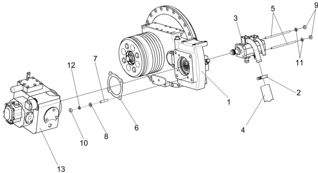
Рисунок 152 – Установка гидронасосов КЗК-10-1-0106300
