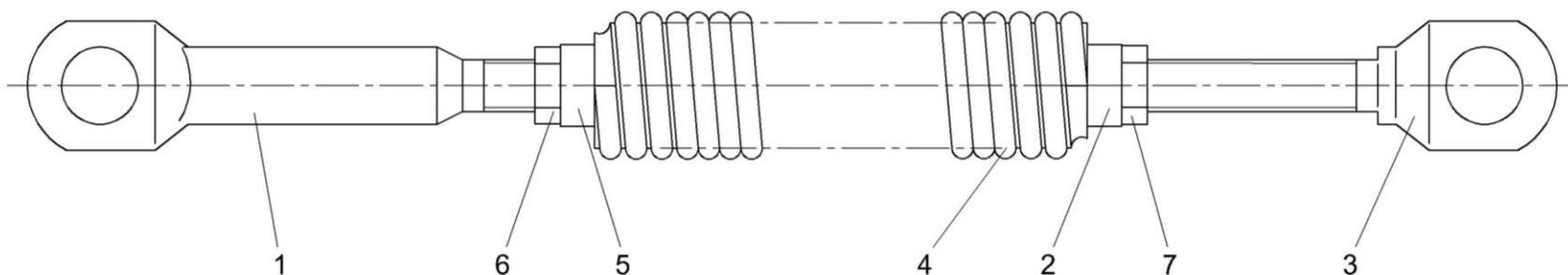
Рисунок 68 – Пружина КЗК-10-0202840
