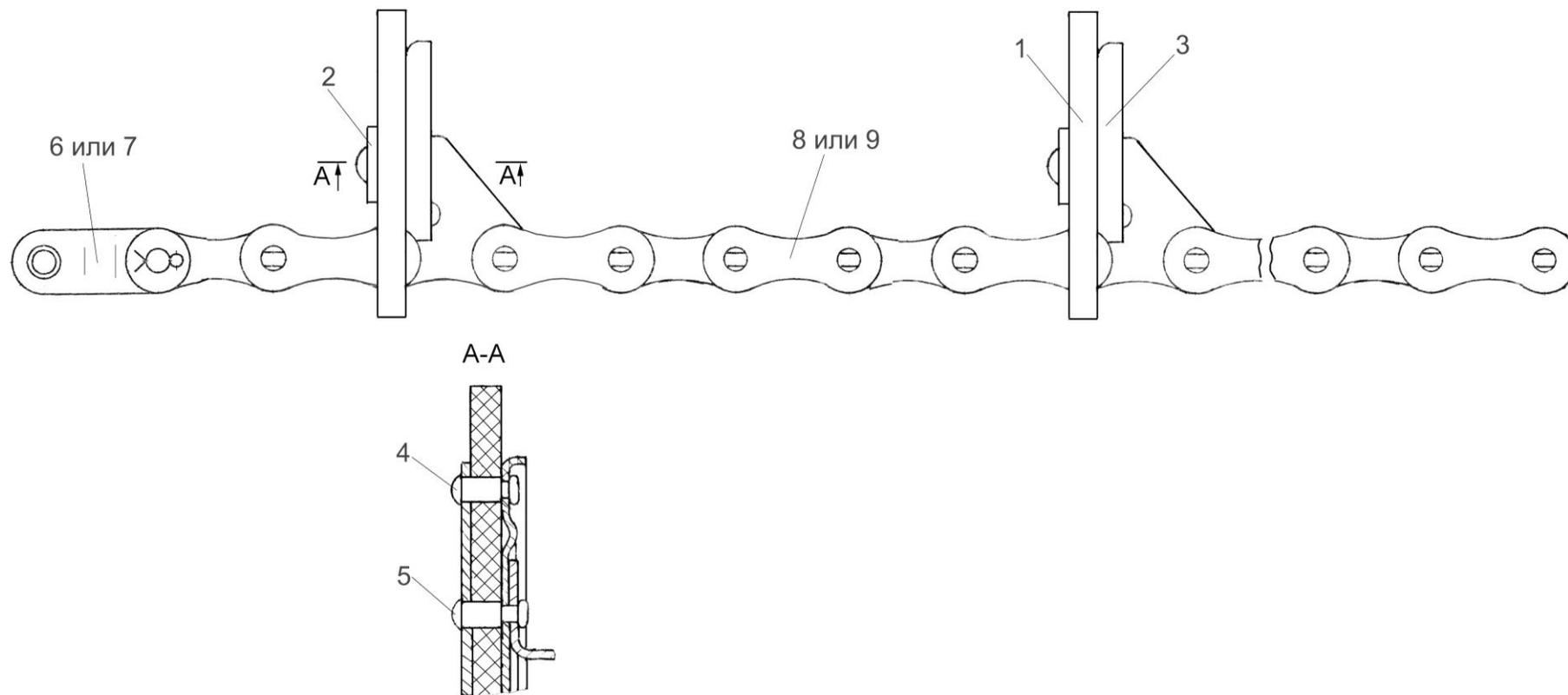
Рисунок 86 – Цепь элеватора КЗР 0208080Б
