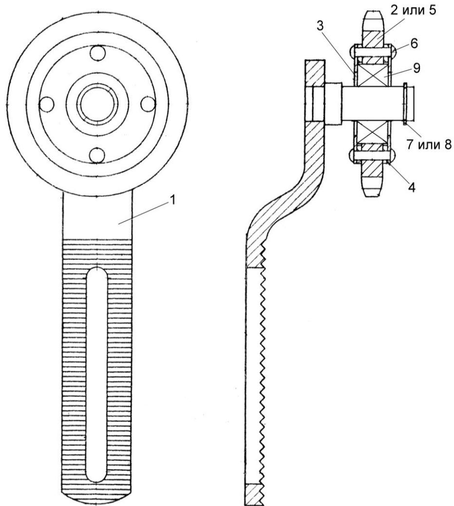
Рисунок 99 – Устройство натяжное КЗР 0202480
