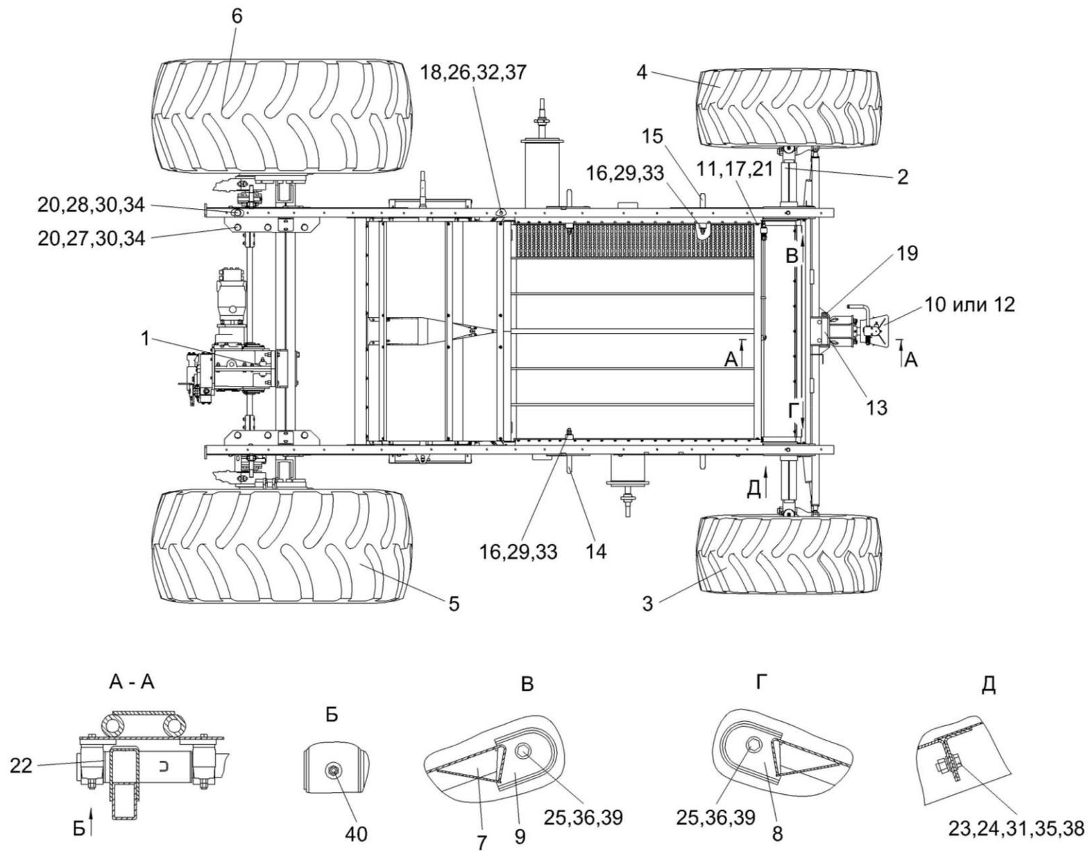
Рисунок 32 – Шасси КЗК-10-0111010P2 (вид сверху)
