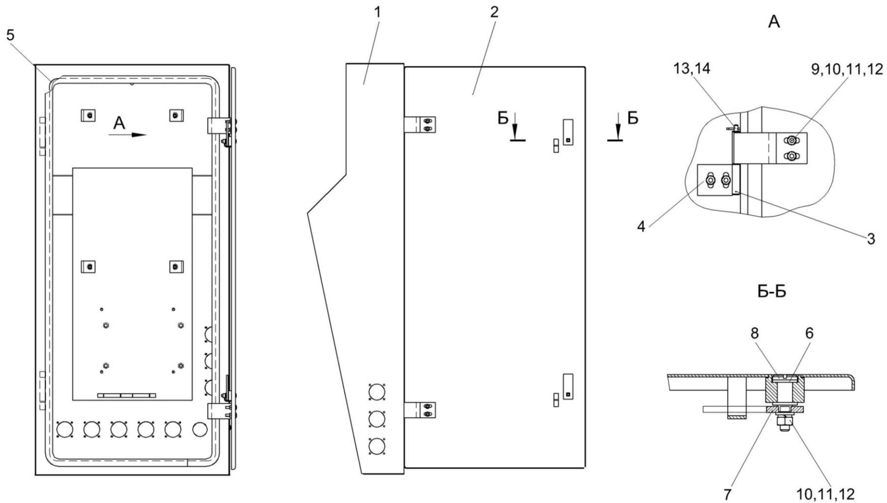
Рисунок 9 – Шкаф электрический КЗК-10-1-0116000
