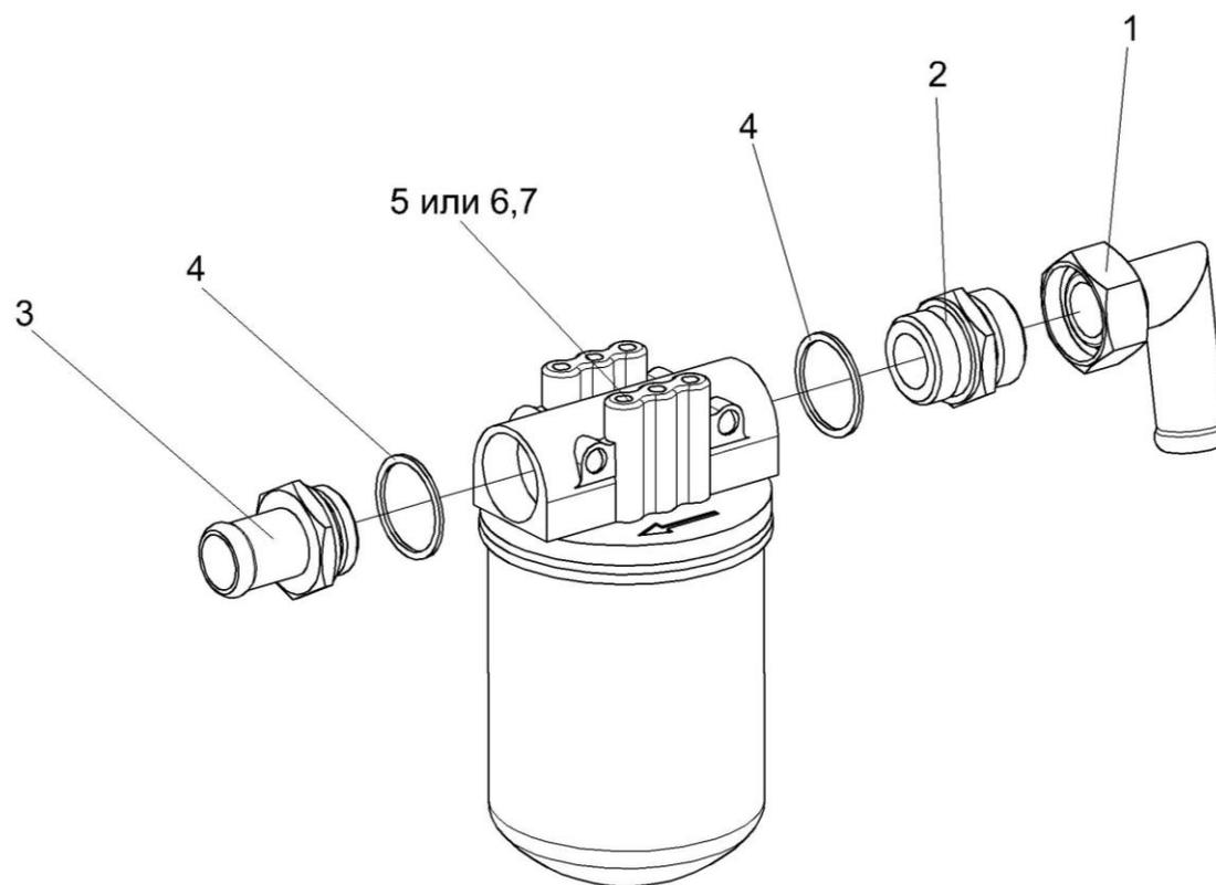
Рисунок 237 – Фильтр всасывающий КЗК-12-0601070
