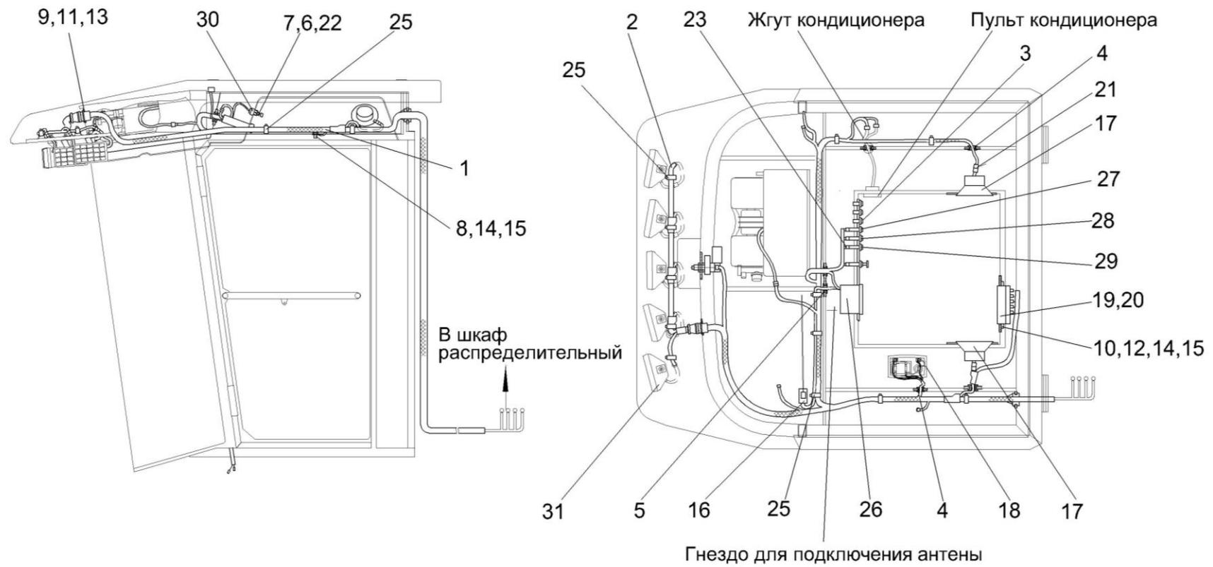
Рисунок 199 – Электрооборудование кабины К3К-10-0200000
