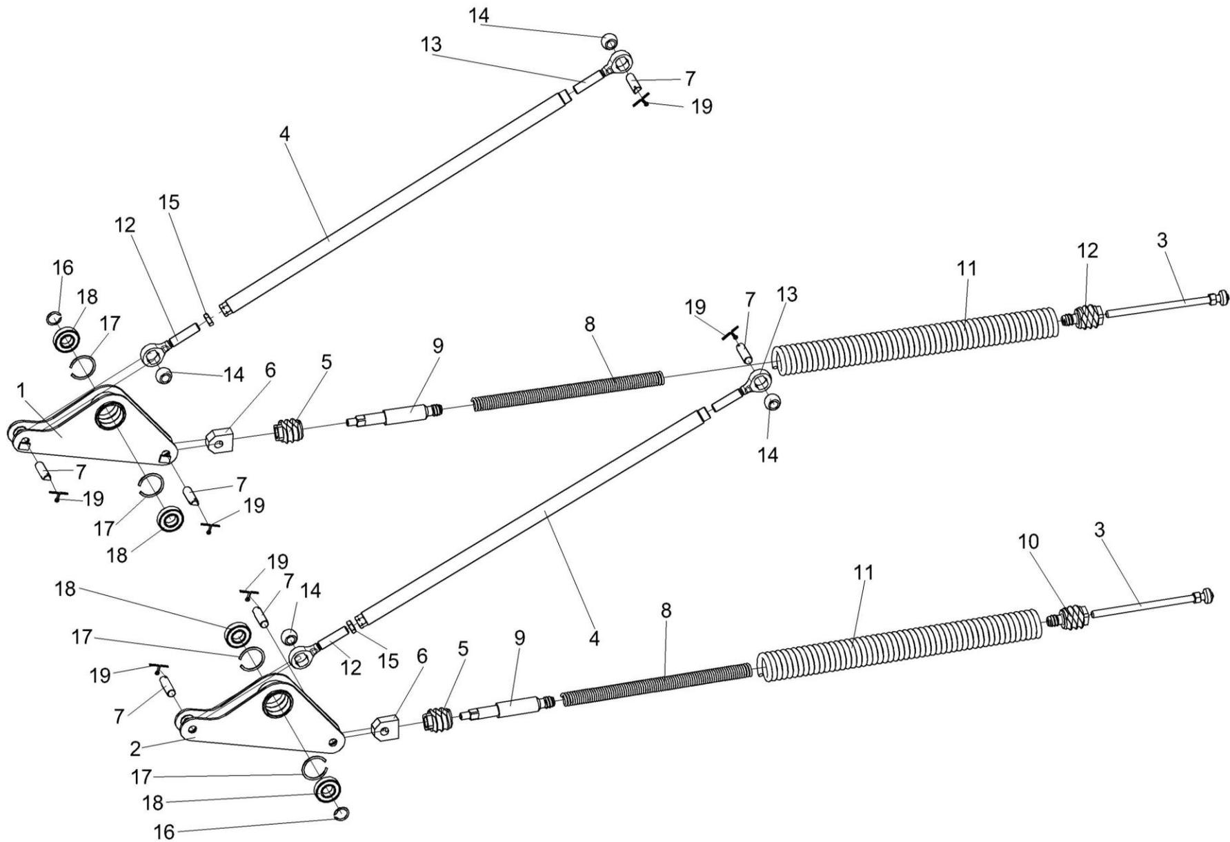
Рисунок 138 – Механизм продольного копирования КЗК 1775000А
