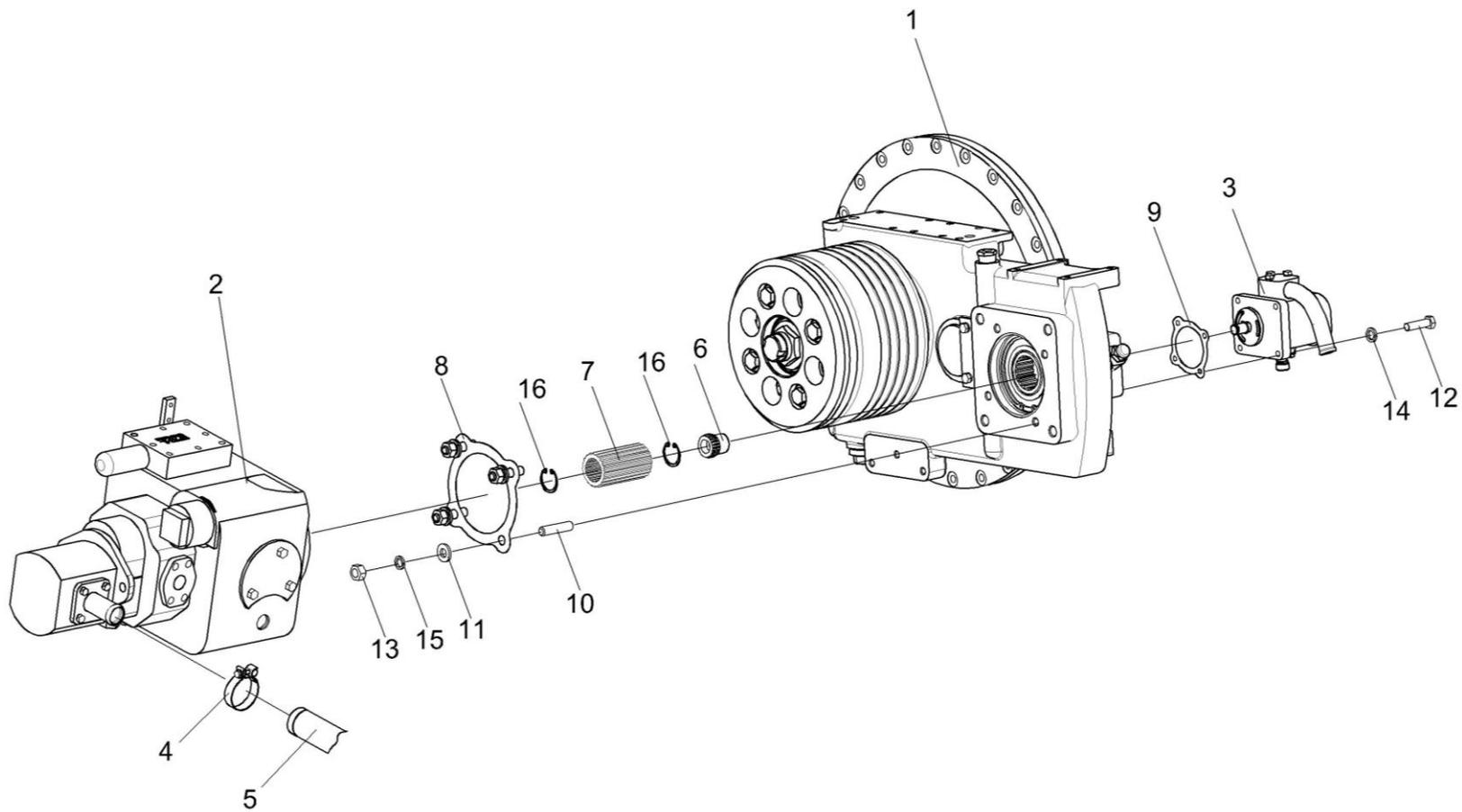
Рисунок 159 – Установка гидронасосов КЗК-10-1-0106320
