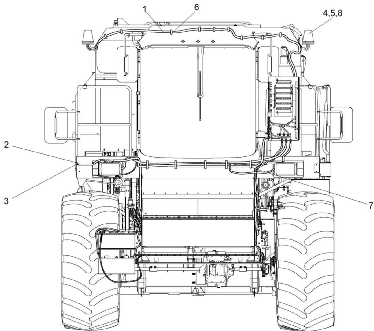
Рисунок 5 – Электрооборудование молотилки самоходной (вид сзади)
