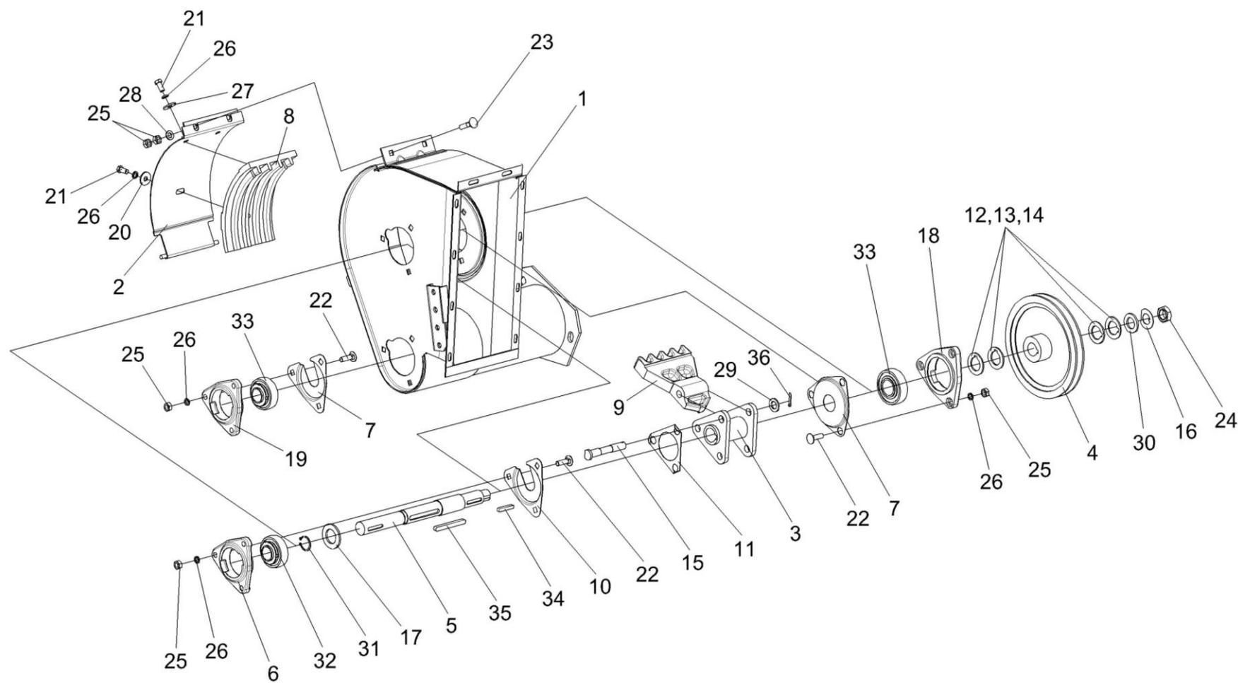
Рисунок 84 – Устройство домолачивающее КЗК 0207000В
