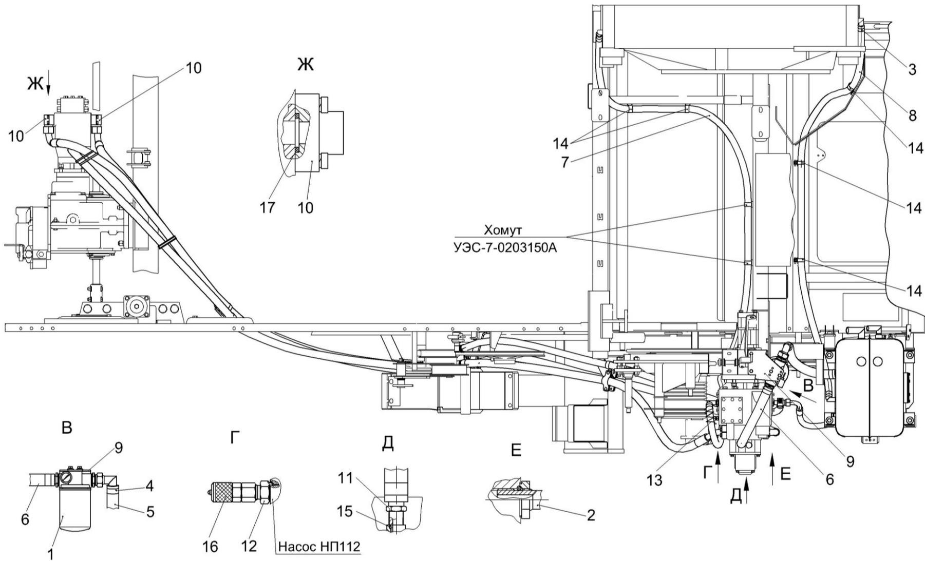
Рисунок 236 – Гидросистема привода ходовой части КЗК-10-1-0601000 (вид сверху)
