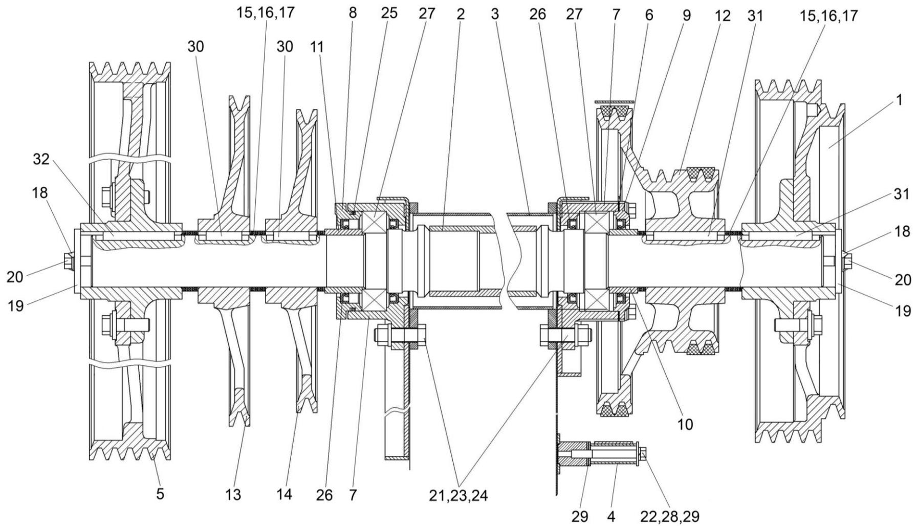
Рисунок 63 – Установка шкивов очистки
