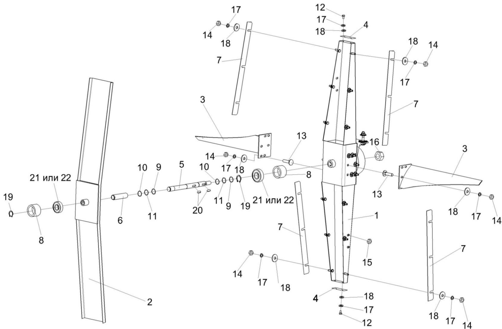
Рисунок 171 – Пылесъемник КЗК-12-3-0112130А
