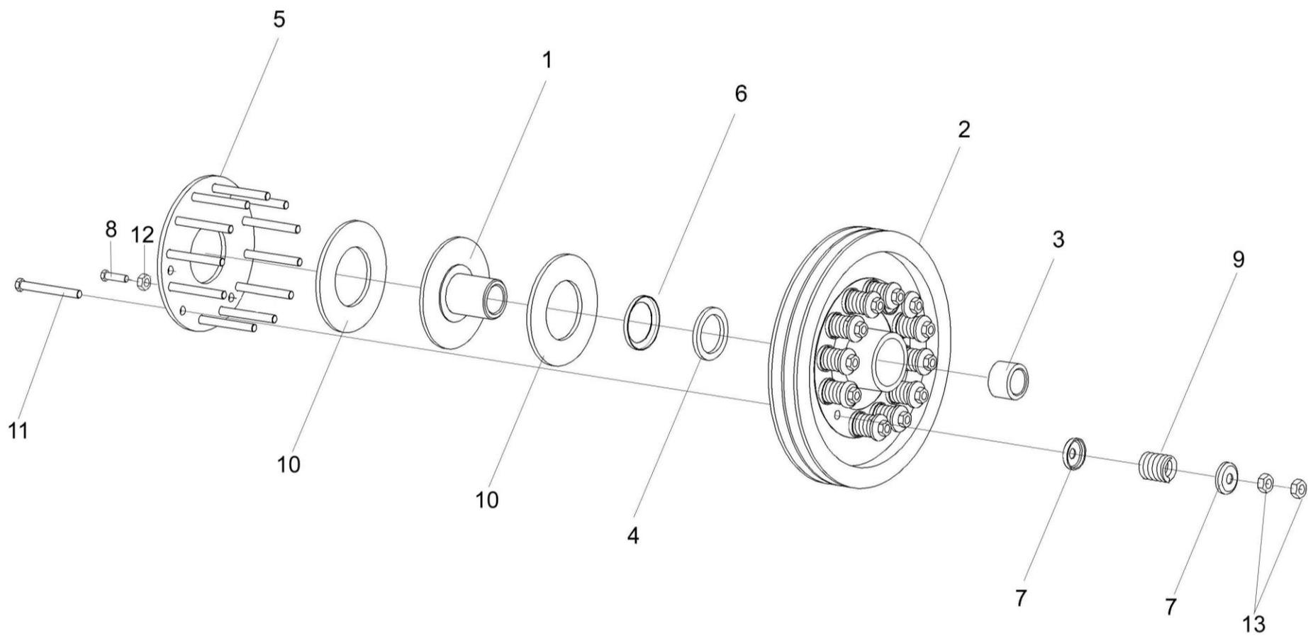
Рисунок 125 – Муфта фрикционная КЗК-10-0219100
