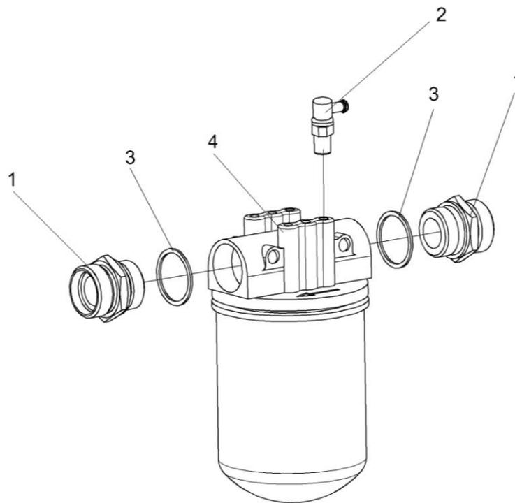
Рисунок 249 – Фильтр сливной КЗК-12-0602060-01
