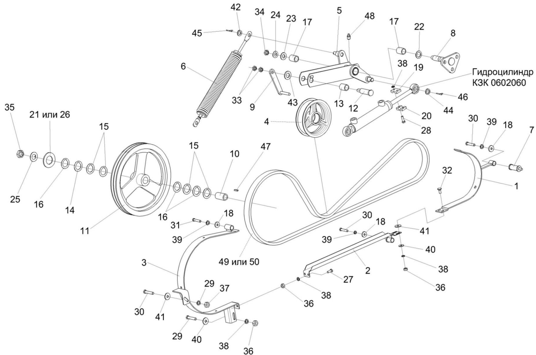
Рисунок 127 – Привод горизонтального шнека КЗК-10-0221000
