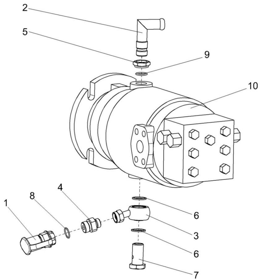
Рисунок 240 – Гидромотор КЗК-12-0601200
