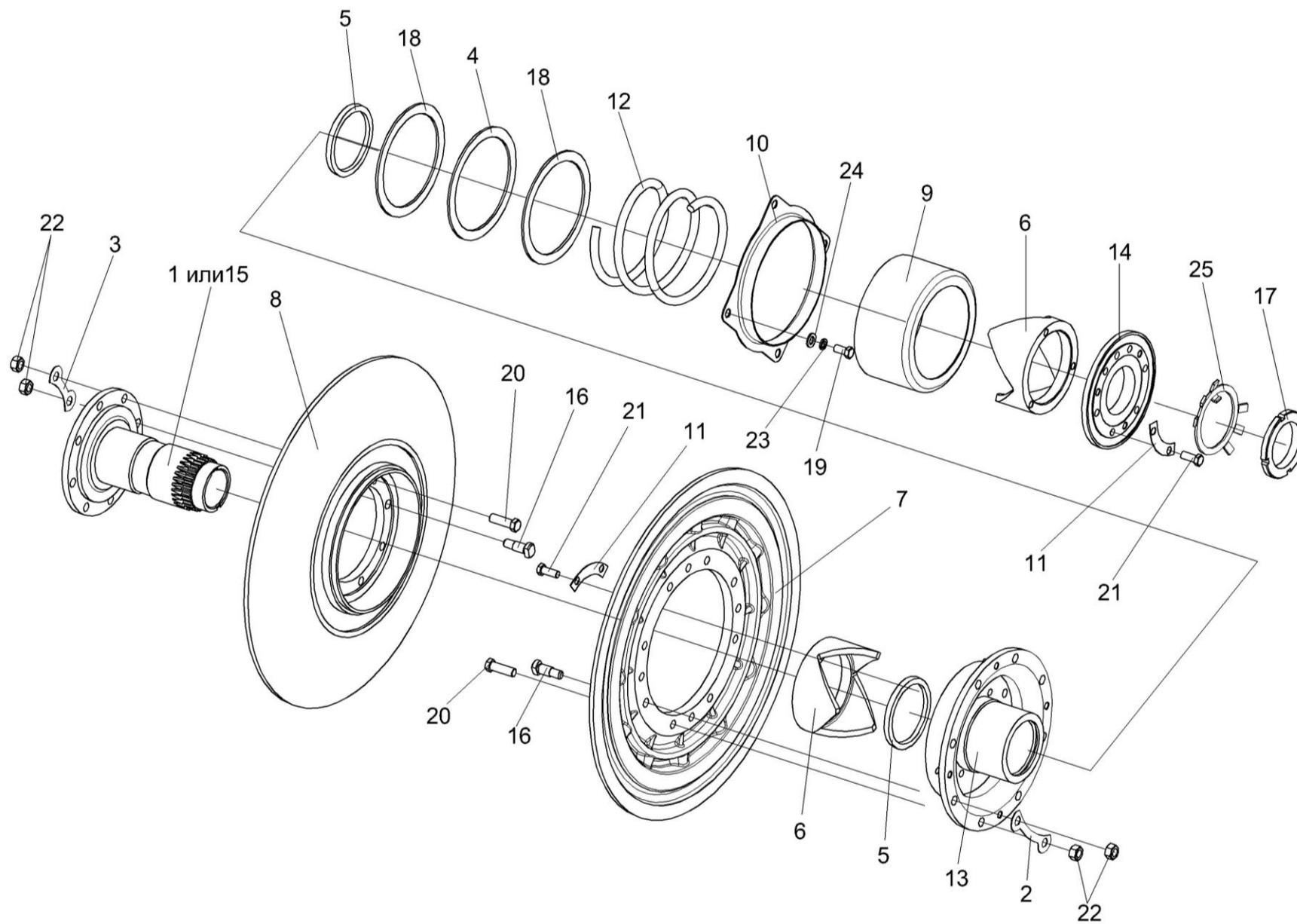
Рисунок 24 – Вариатор барабана РСМ-10.01.18.060Б
