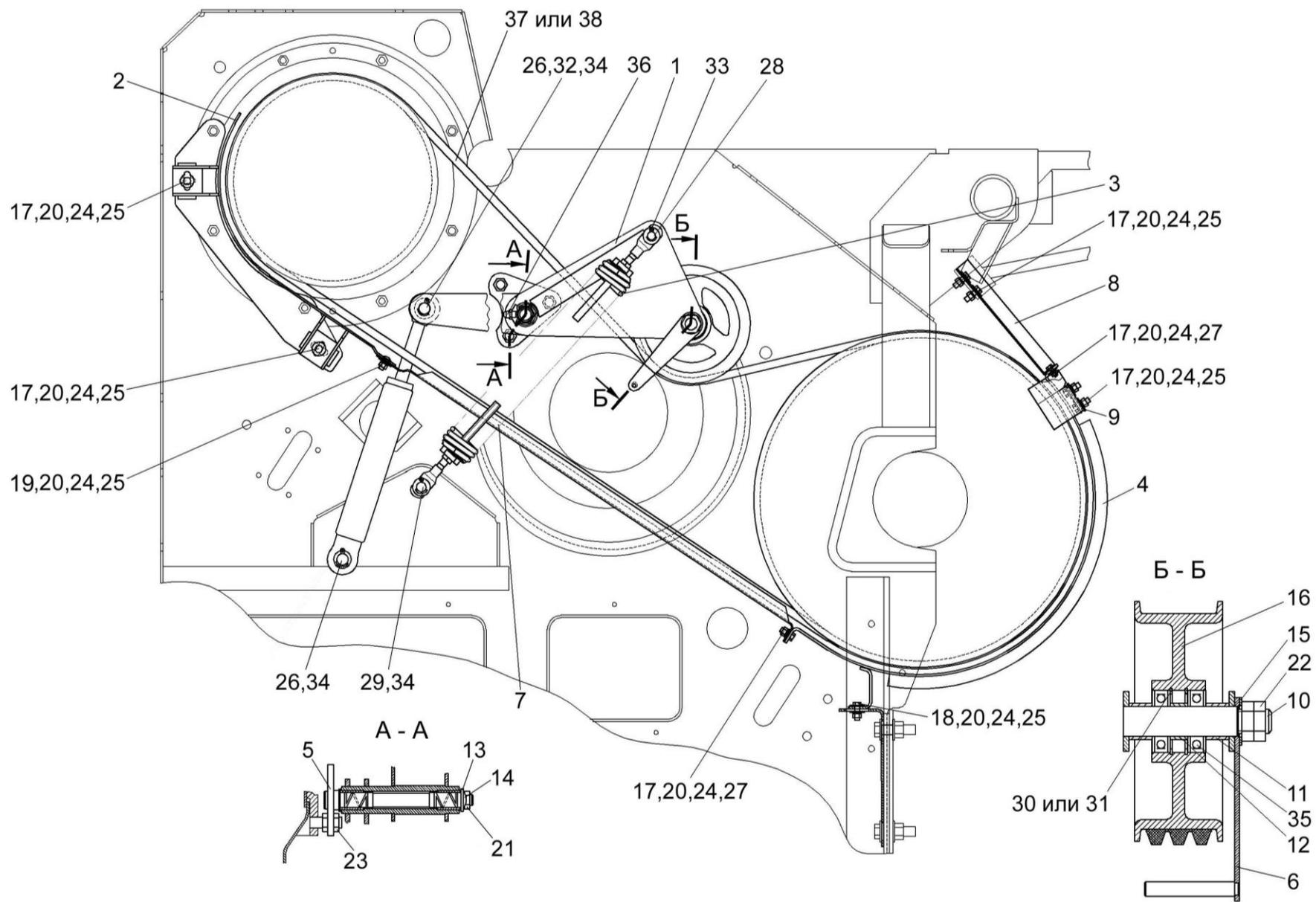
Рисунок 140 – Привод наклонной камеры КЗК-10-0125000
