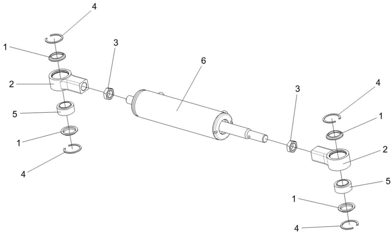
Рисунок 52 – Гидроцилиндр УЭС-7-0109100
