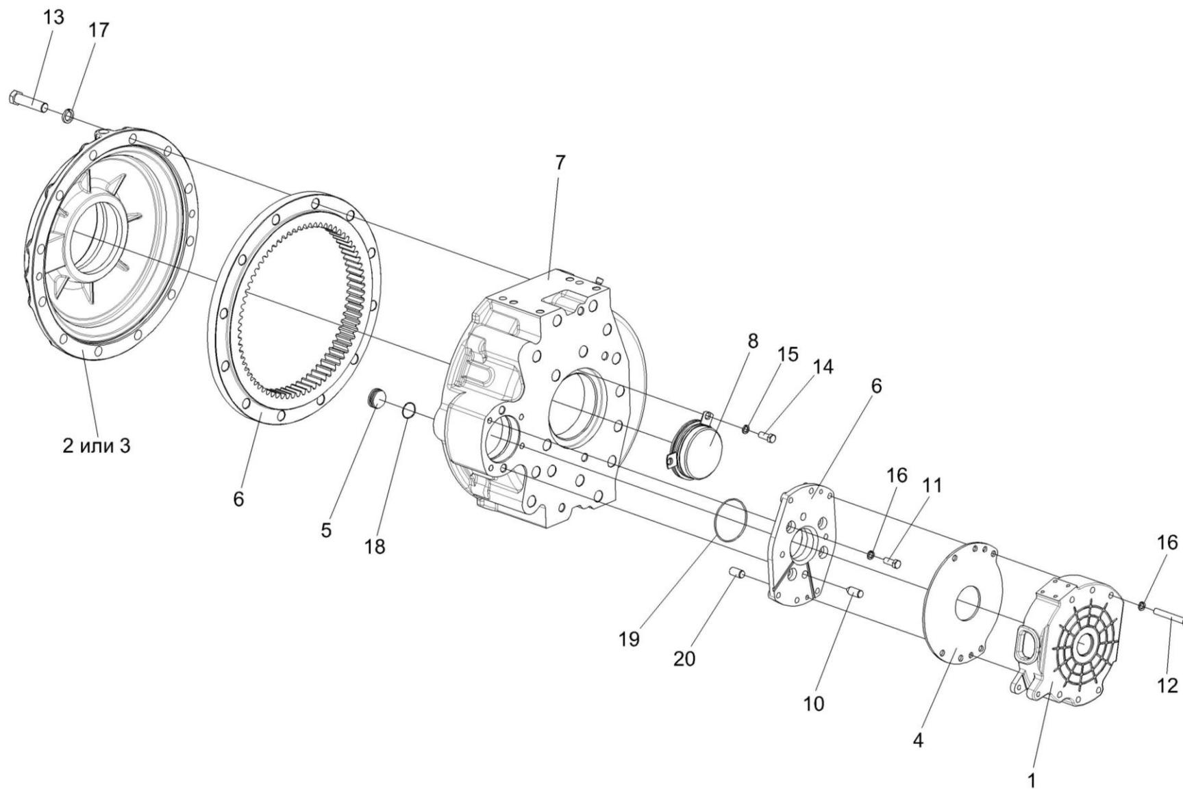
Рисунок 40 – Редуктор левый МК-23М.03.000Ж-03 (корпус, крышки)
