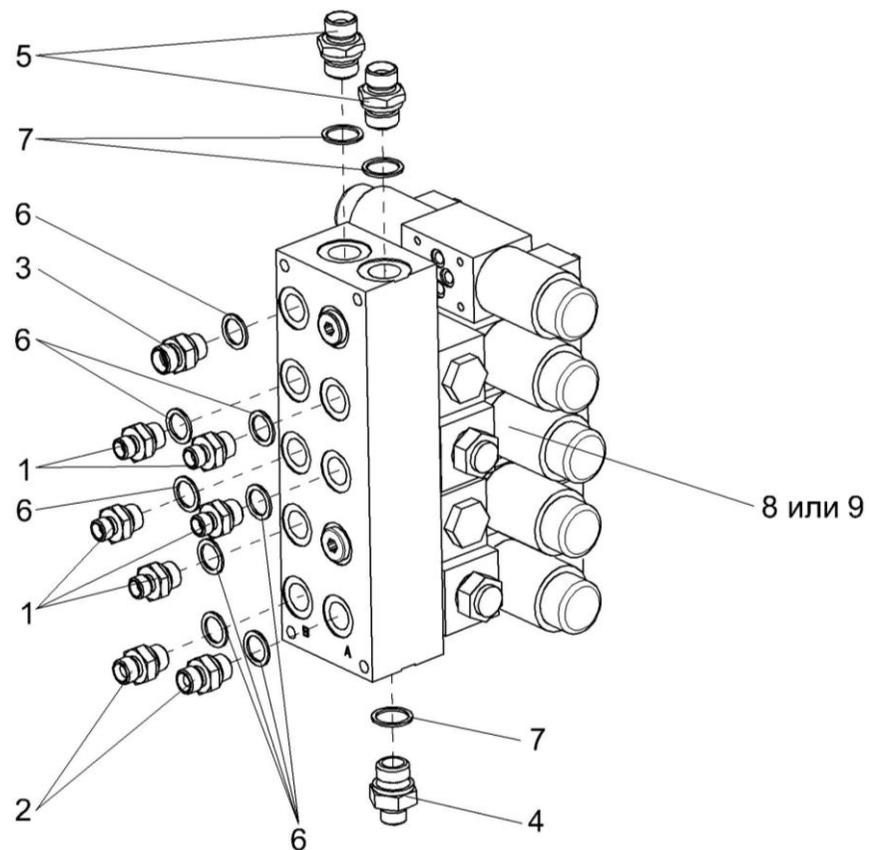
Рисунок 246 – Гидроблок пятисекционный КЗК-10-1-0602570
