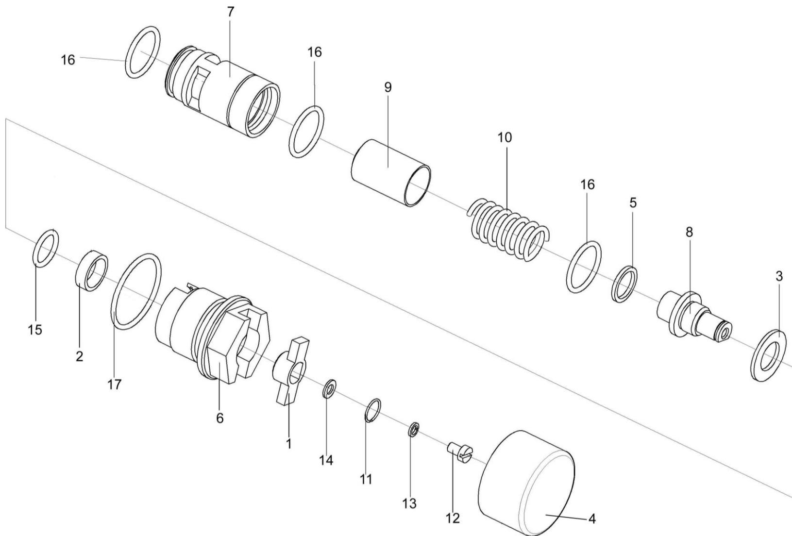
Рисунок 253 – Клапан-сигнализатор УЭС 0603660-01
