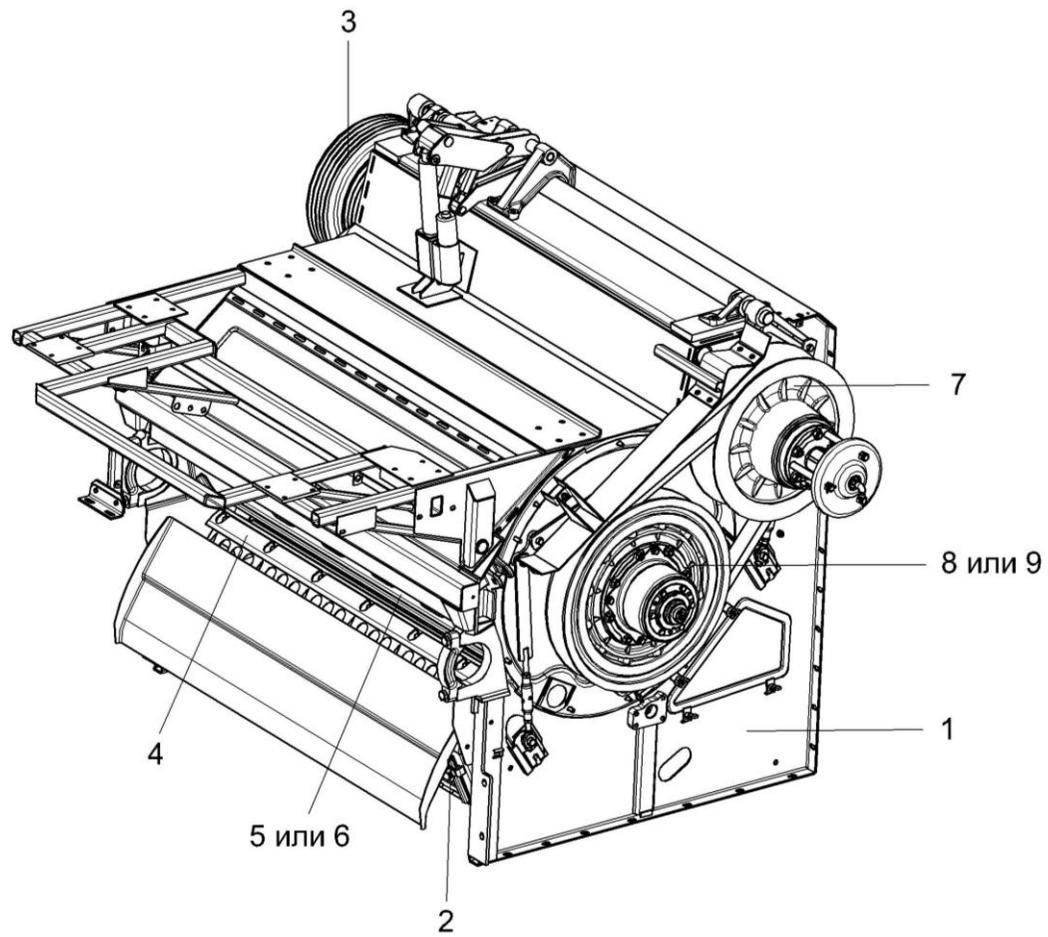
Рисунок 13 – Аппарат молотильный КЗК-10-0102000Р2
