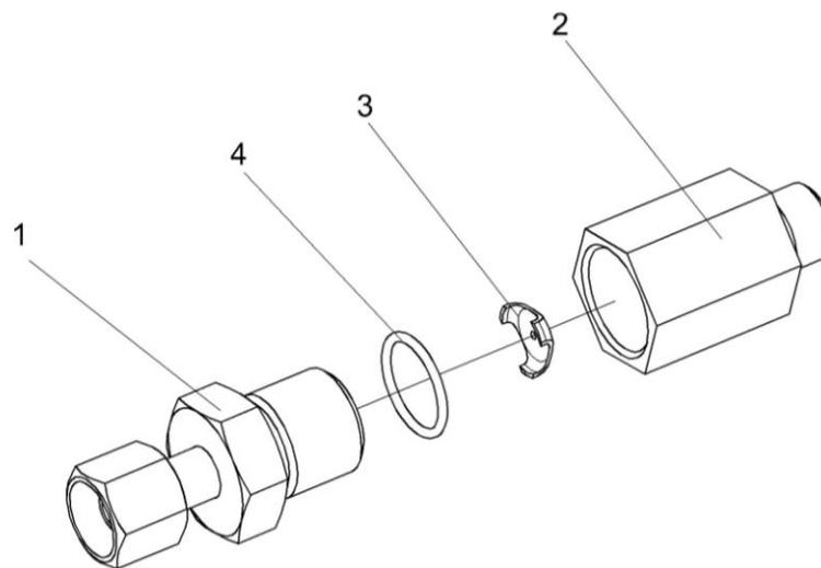
Рисунок 248 – Дроссели с обратным клапаном КЗК 0602520А, КЗК 0602520А-01
