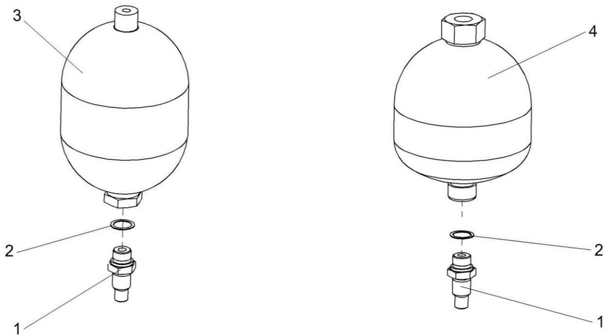
Рисунок 257 – Пневмогидроаккумуляторы УЭС-7-0602440-02 и УЭС-7-0602470
