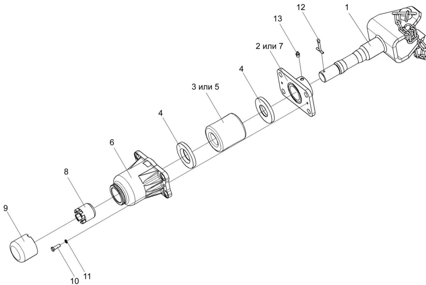
Рисунок 59 – Устройство прицепное КИС 0122000А
