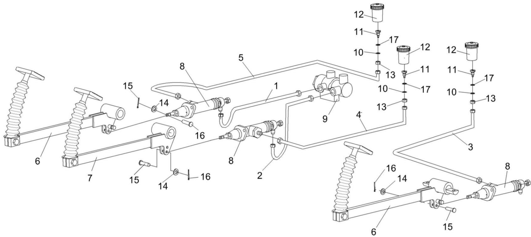
Рисунок 202 – Рычаги и трубопроводы площадки управления КЗК-10-0119000А
