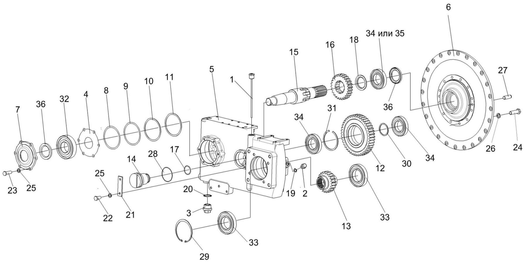
Рисунок 161 – Мультипликатор КЗК-12-0114000-01
