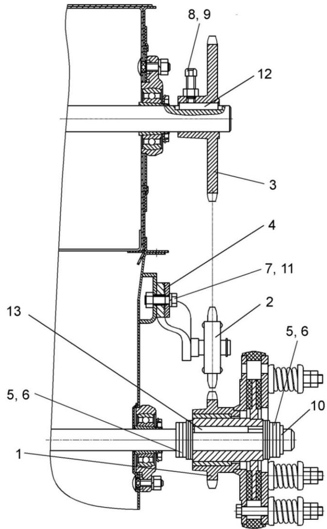
Рисунок 87 – Установка муфты фрикционной КЗК 0219020Б-01
