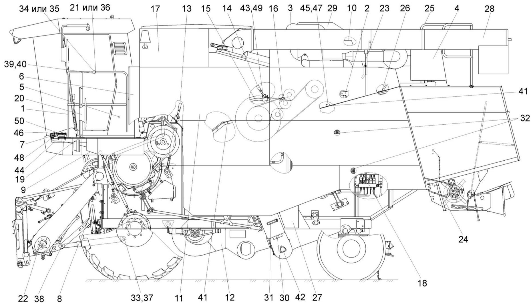
Рисунок 3 – Молотилка самоходная КЗК-10-0100000Б-03 (вид слева)
