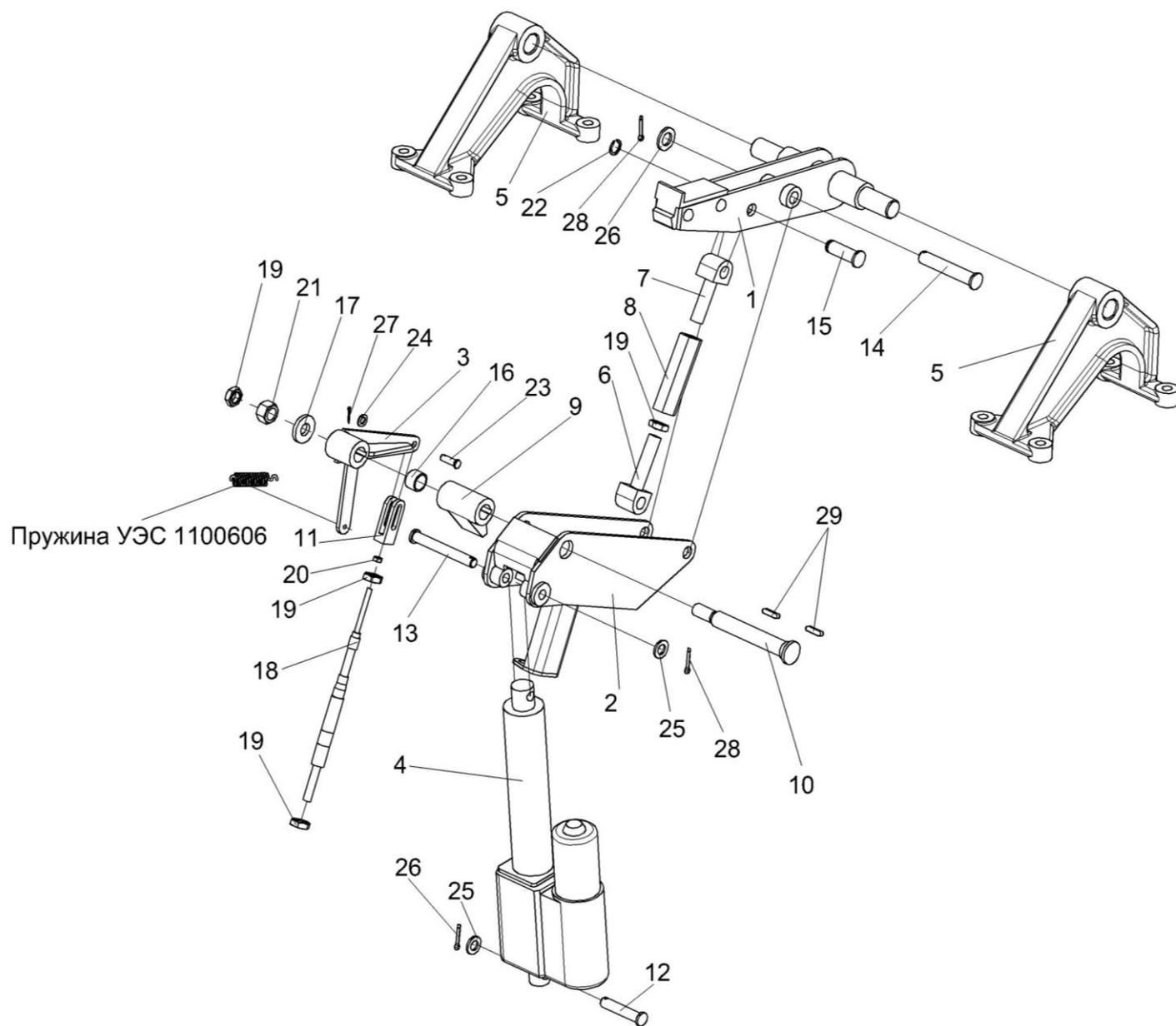
Рисунок 29 – Аппарат молотильный КЗК-10-0102000Р2 (установка электромеханизма подбарабанья)
