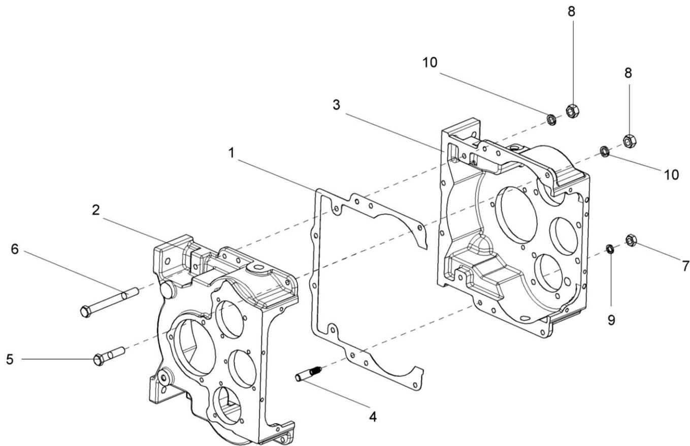
Рисунок 47 – Корпус коробки диапазонов 3518020-46170
