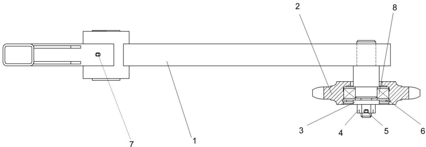
Рисунок 228 – Рычаг КЗК-10-0100680А
