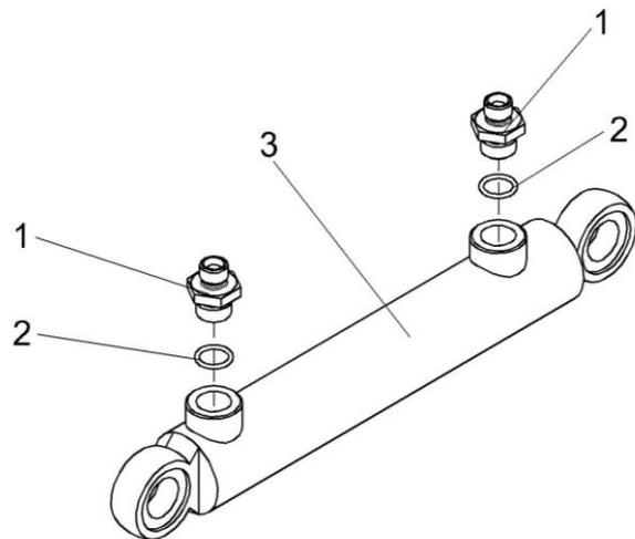
Рисунок 251 – Гидроцилиндр КЗК-12-0602310
