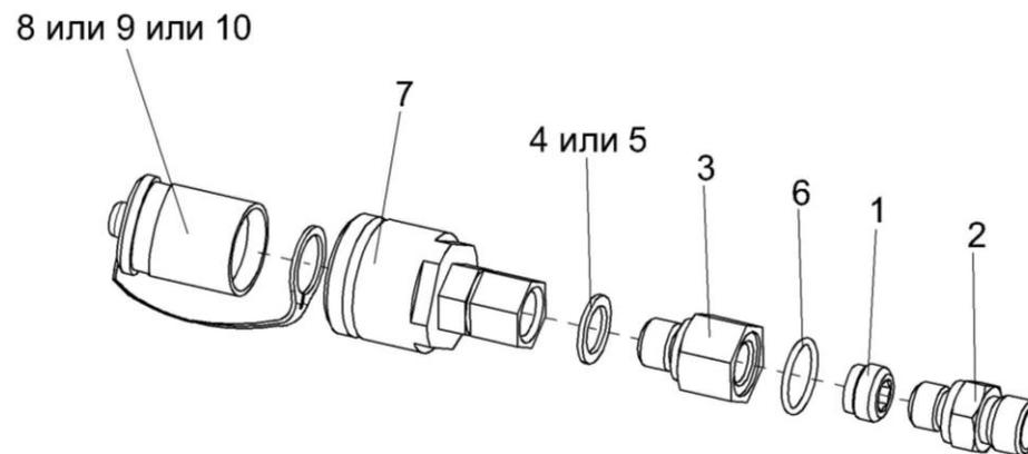
Рисунок 250 – Полумуфты молотилки КЗК-12-0602320, КЗК-12-0602320-01, КЗК-12-0602320-02
