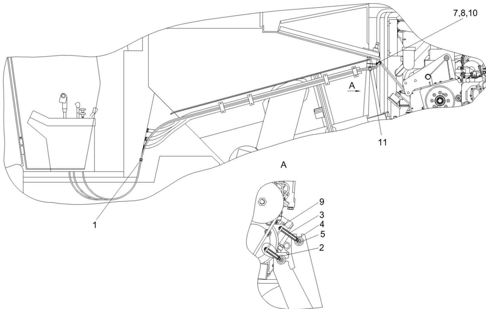
Рисунок 224 – Установка тросов управления двигателем КЗК-10-1-0119300
