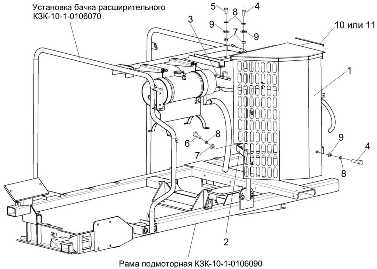
Рисунок 172 – Установка ограждения КЗК-12-3-0106330А
