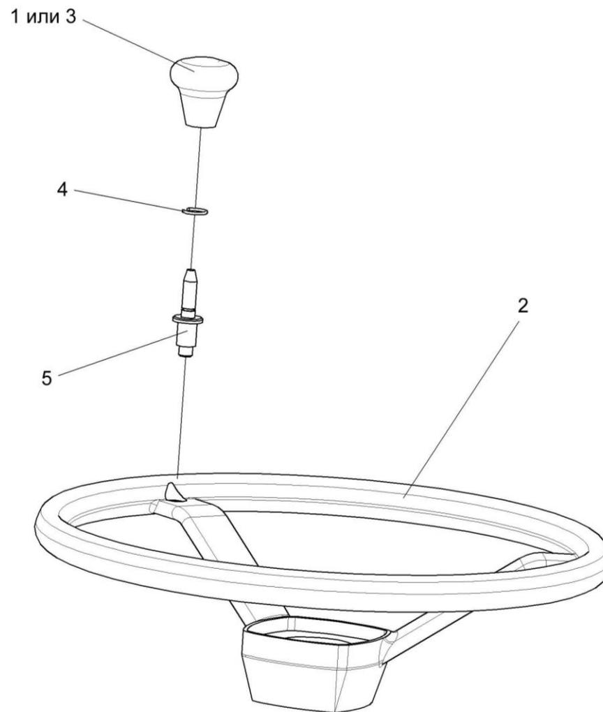
Рисунок 215 – Колесо рулевое УЭС 0302560
