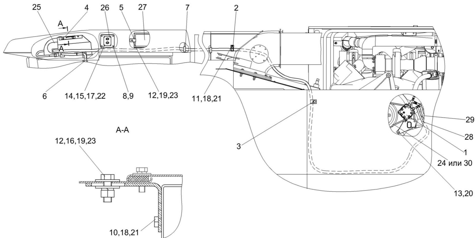
Рисунок 186 – Установка кондиционера КЗК-10-0113000В (лист 2)
