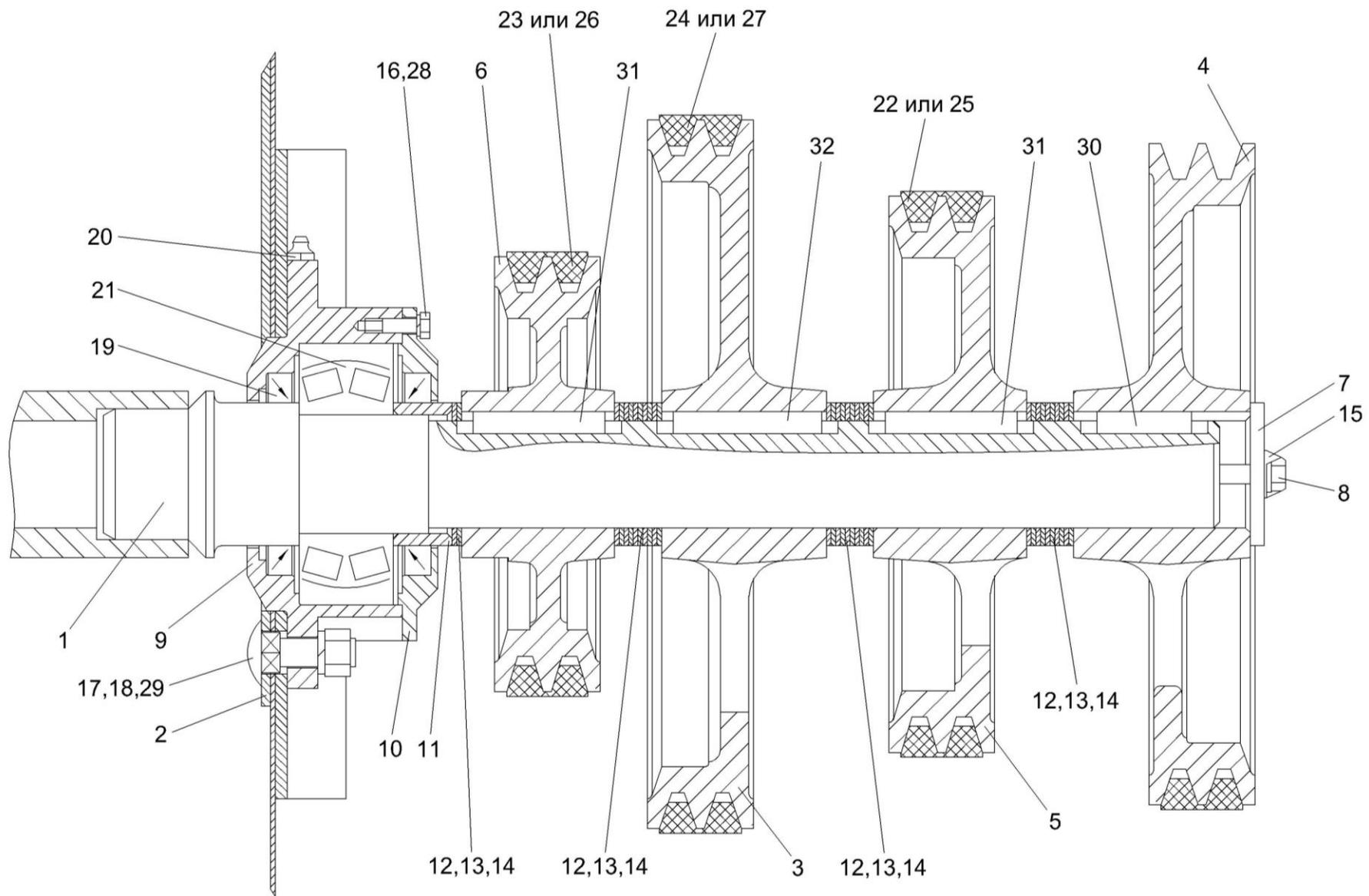
Рисунок 67 – Установка шнека КЗК-10-0202770, поддон, шкивы
