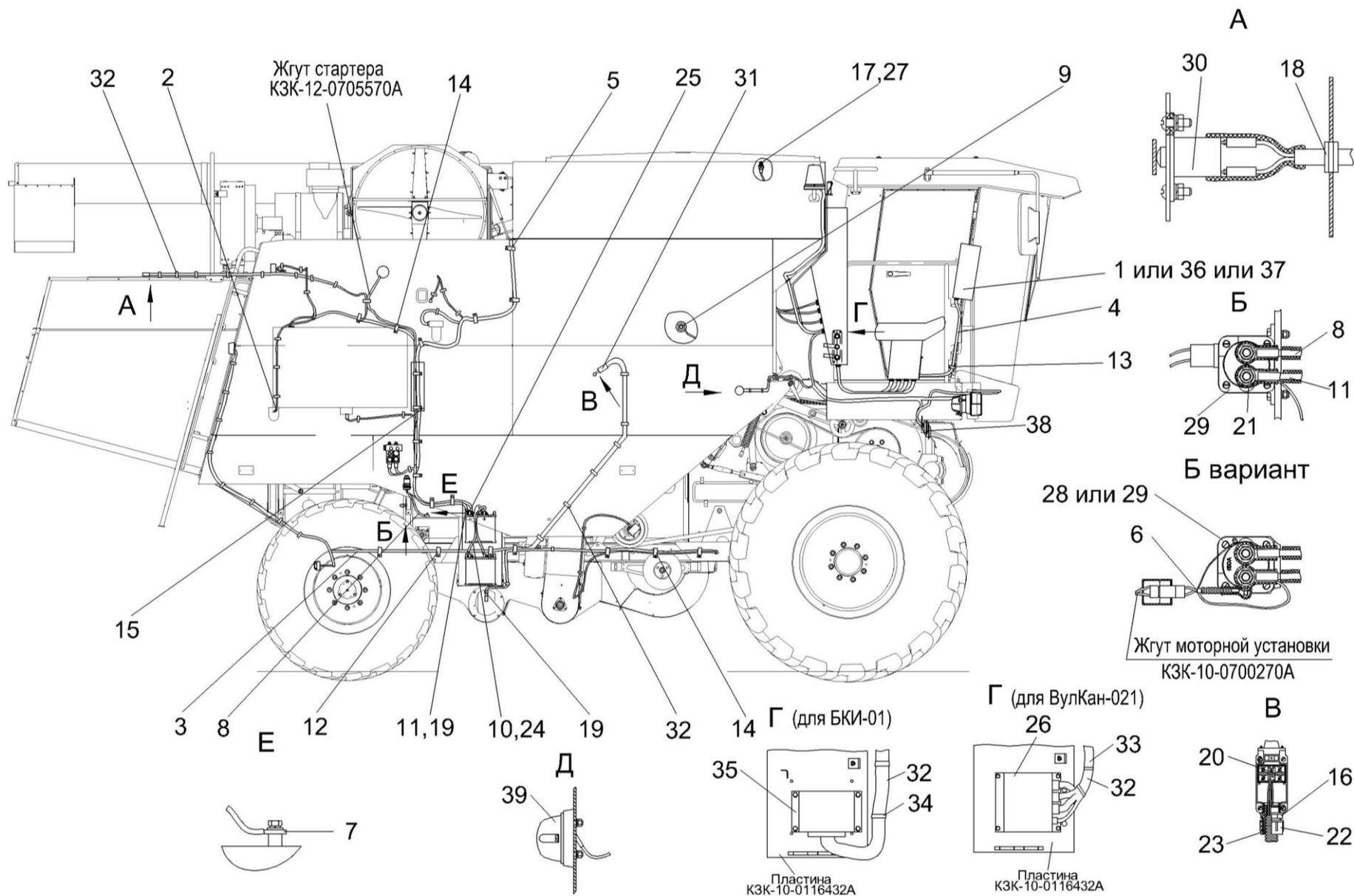
Рисунок 6 – Электрооборудование молотилки самоходной (вид справа)
