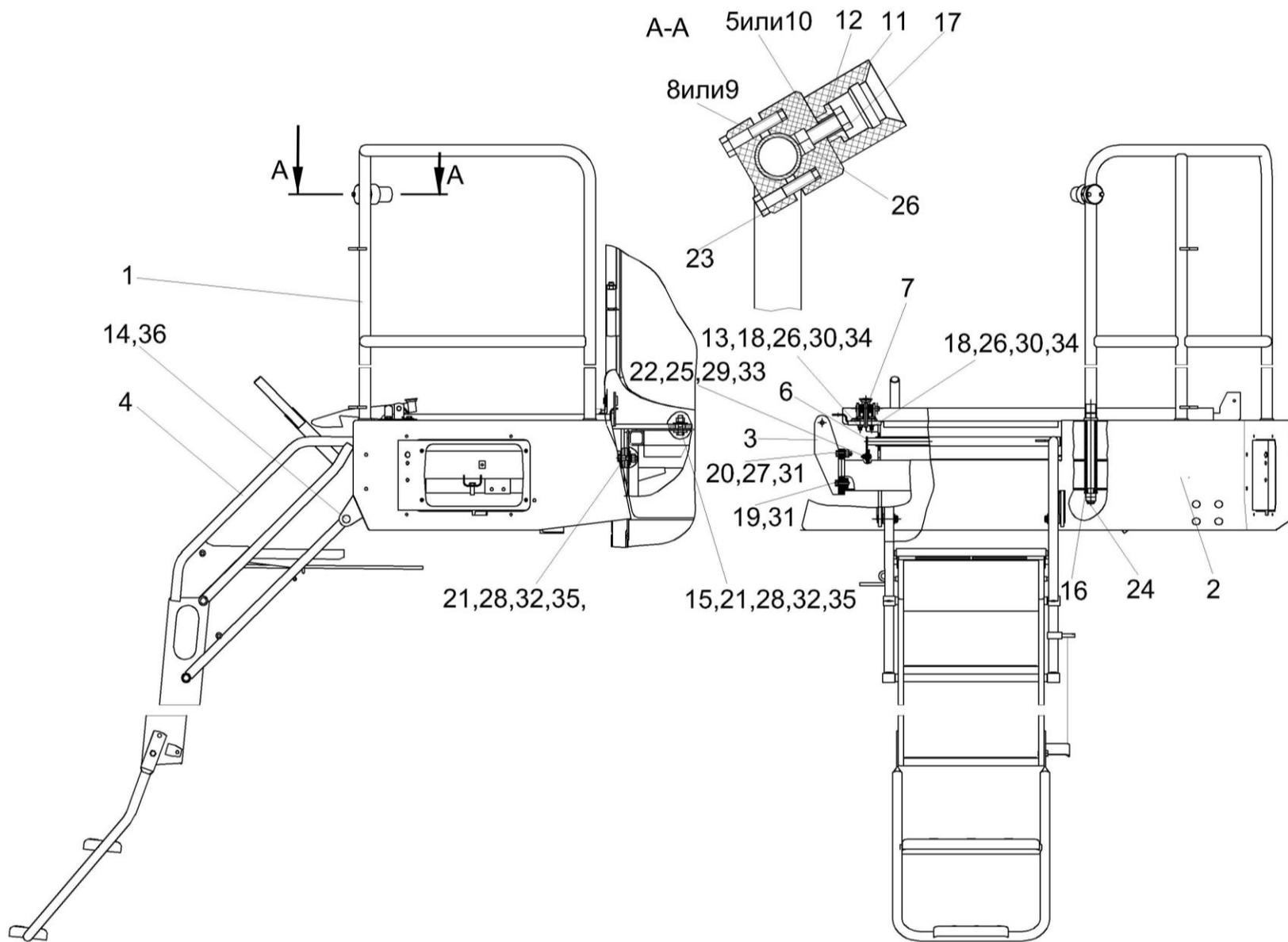
Рисунок 190 – Установка площадки входа КЗК-10-0121000Р1
