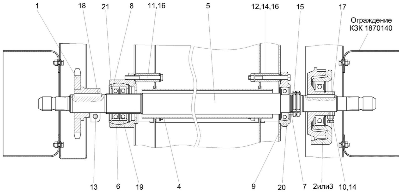
Рисунок 131 – Установка вала КЗК 1870605 наклонной камеры
