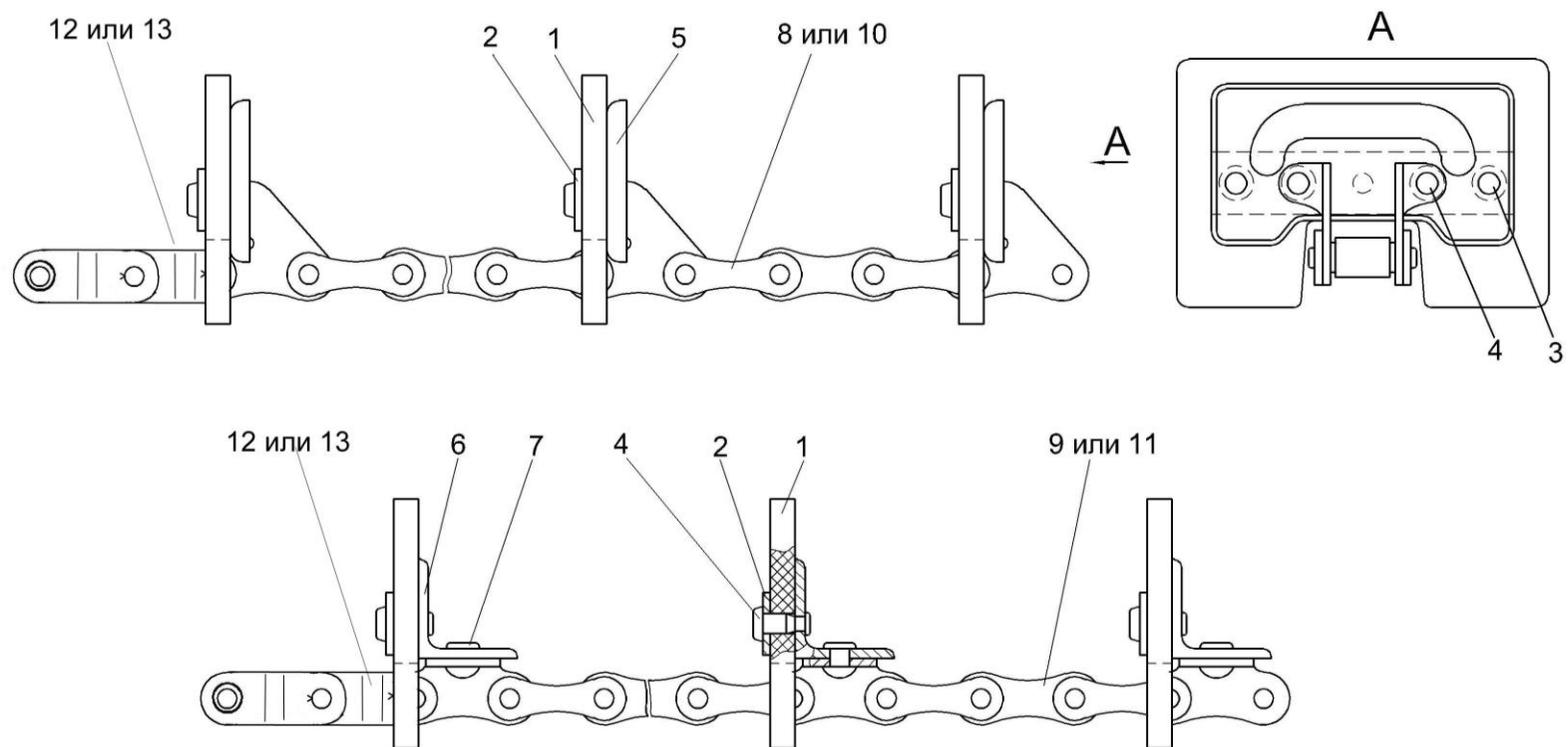
**Рисунок 124 – Цепи элеватора КЗК-10-0214140 и КЗК-10-0214160**
