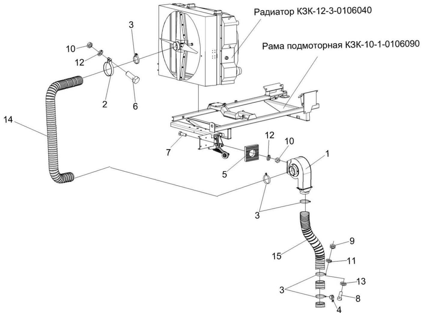
Рисунок 176 – Установка вентилятора КЗК-12-3-0112240
