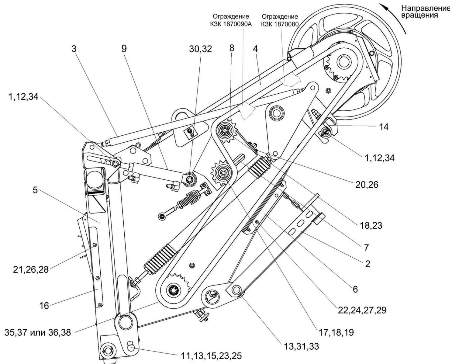
Рисунок 129 – Камера наклонная КЗК 1870000А (вид слева)
