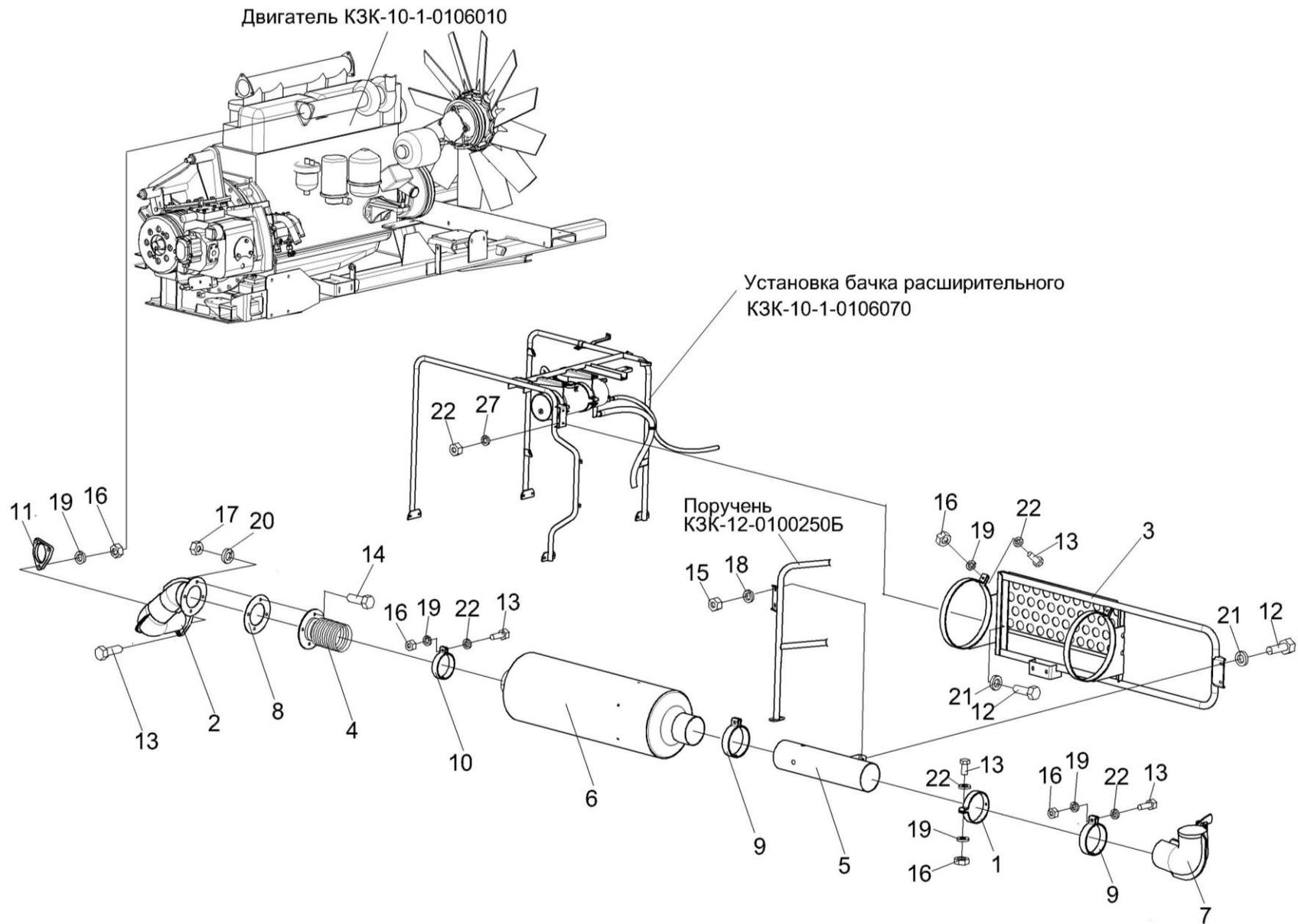
Рисунок 179 – Установка глушителя КЗК-10-1-0106060
