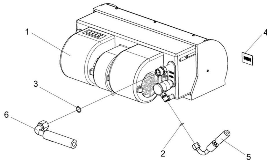
Рисунок 92 – Блок испарительный КГС 0120710
