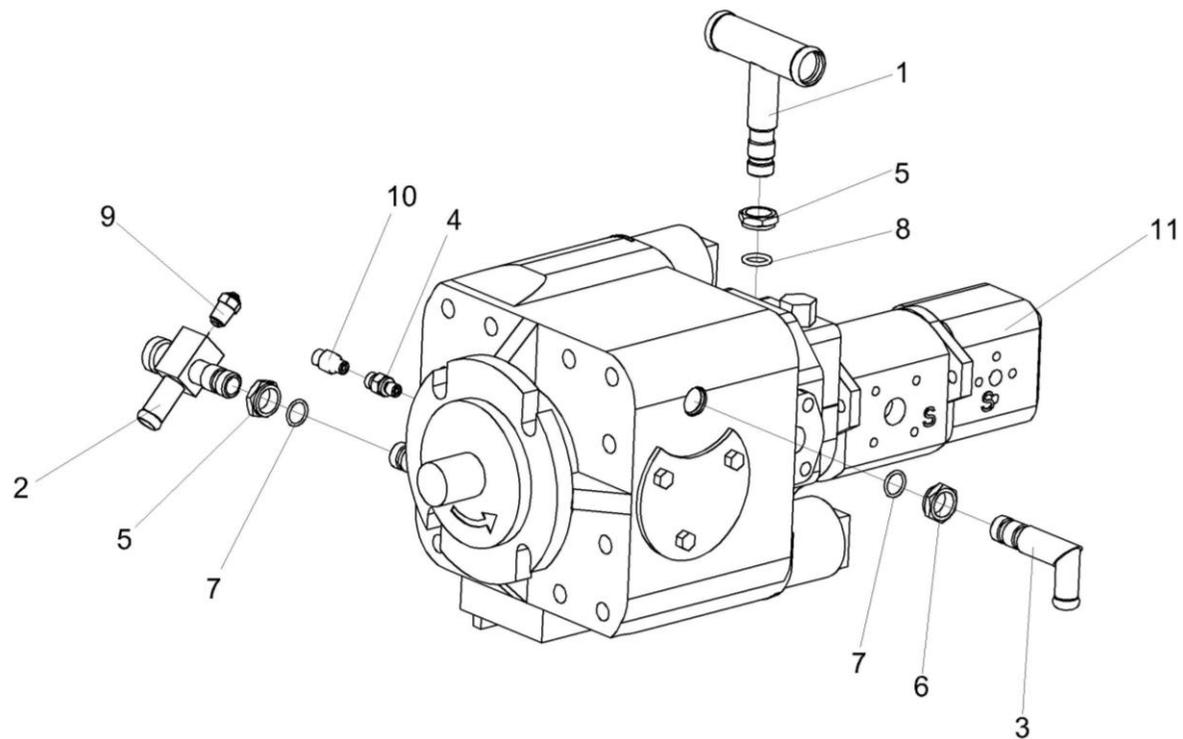
Рисунок 142 – Гидронасос трехсекционный КГС 0108010А
