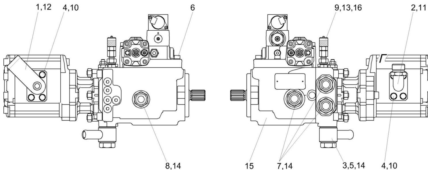
Рисунок 156 – Гидронасос двухсекционный КГС 0115310А
