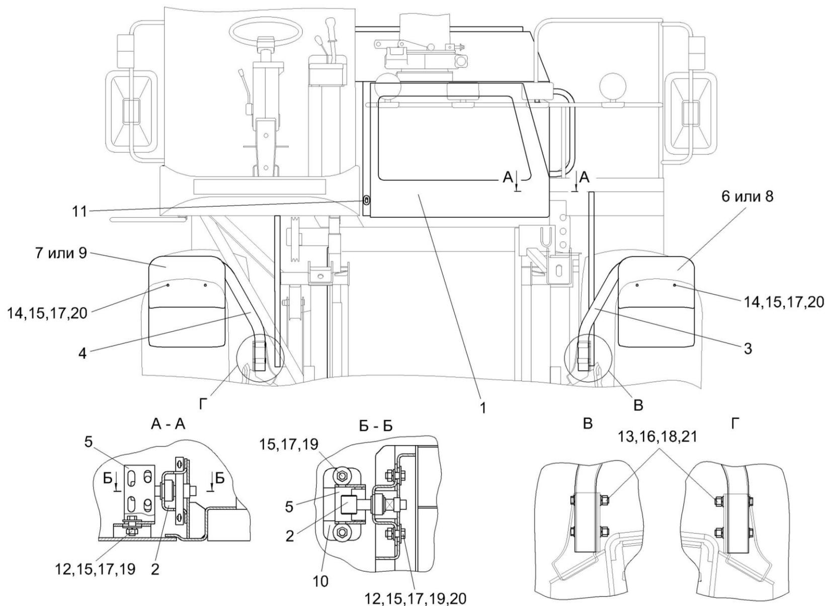
Рисунок 129 – Установка капотов КГС 0128000 (вид спереди)
