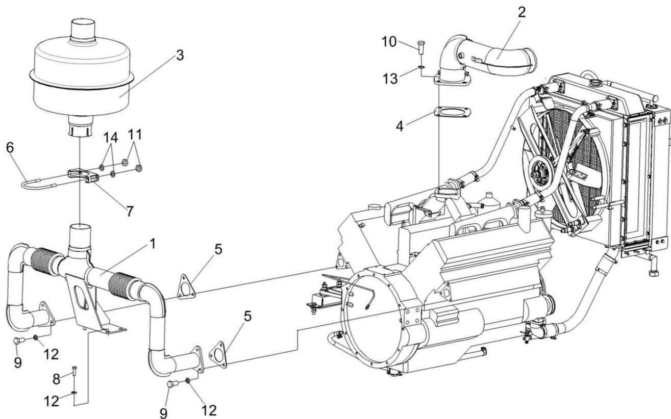
Рисунок 38 – Установка глушителя КИЛ 0116630
