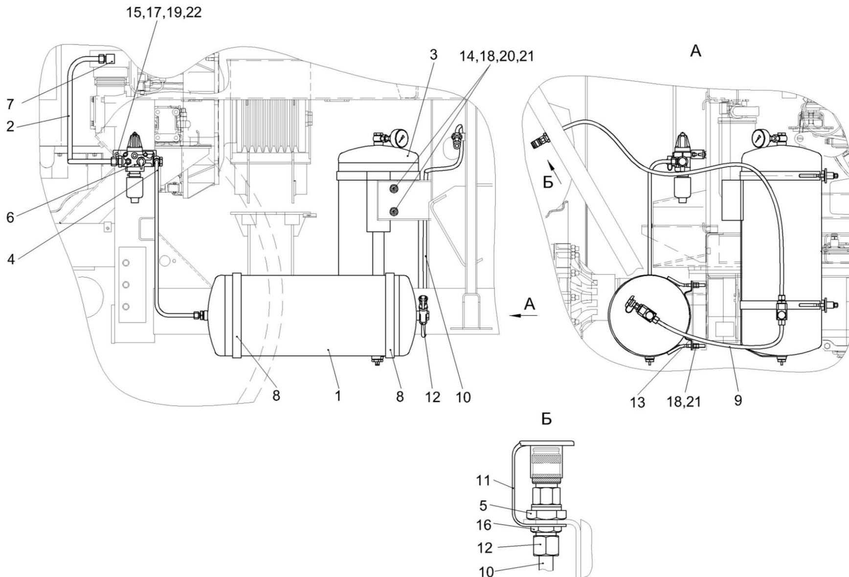
Рисунок 168 – Пневмосистема КГС 0180000
