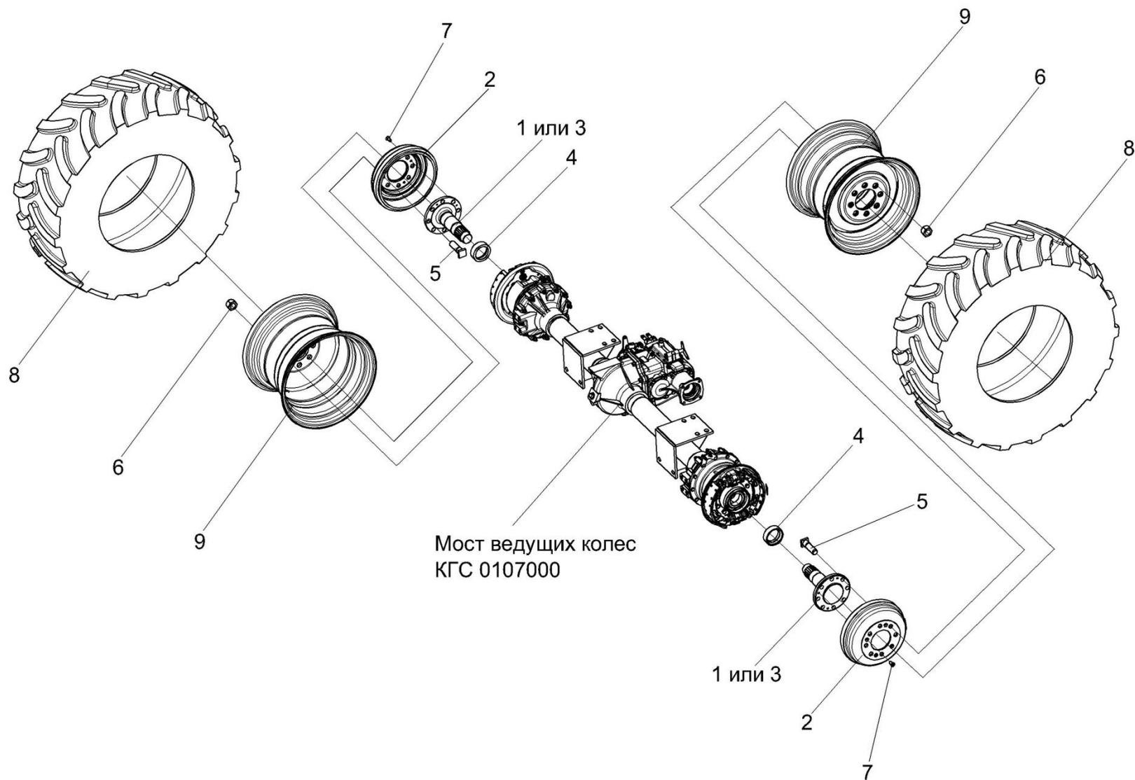
Рисунок 68 – Установка колес 54-4-6 и 54-4-7
