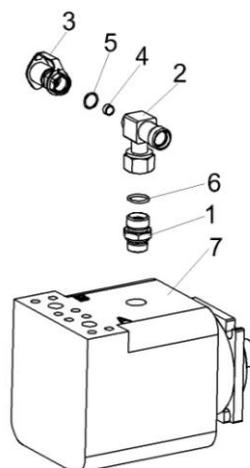
Рисунок 66 – Гидромотор привода питающего аппарата КГС 0115730
