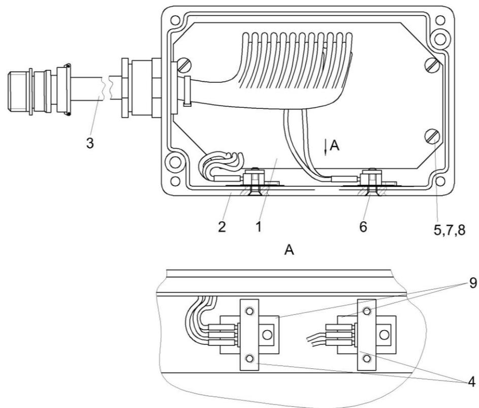
Рисунок 157 – Блок управления питающим аппаратом КГС 0171200А и КГС 0171200А-01
