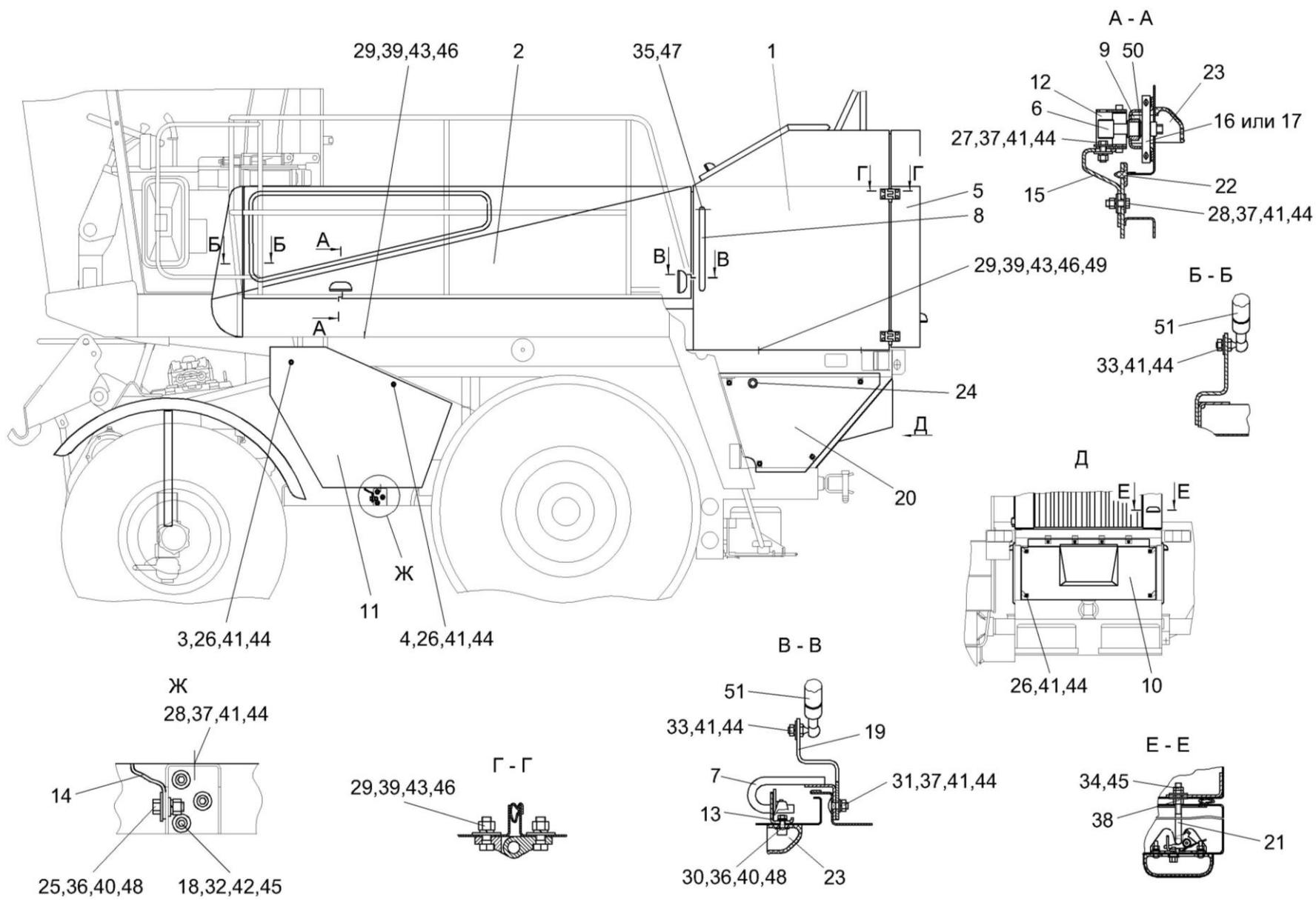
Рисунок 126 – Установка капотов КГС 0128000 (вид слева)
