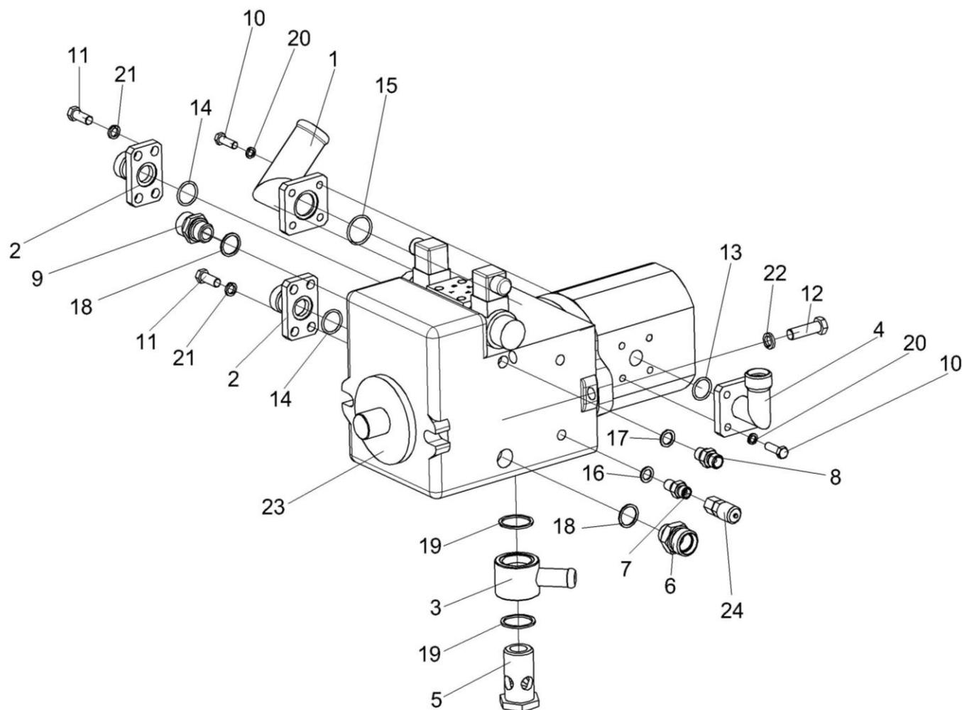
Рисунок 155 – Гидронасос двухсекционный КГС 0115300А
