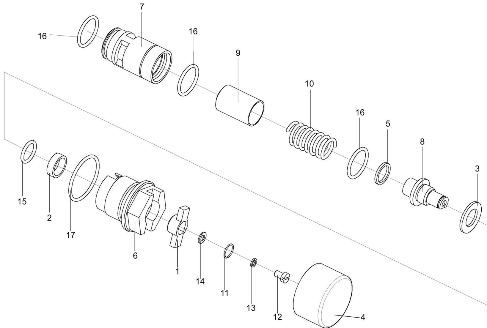
Рисунок 166 – Клапан-сигнализатор УЭС 0603660
