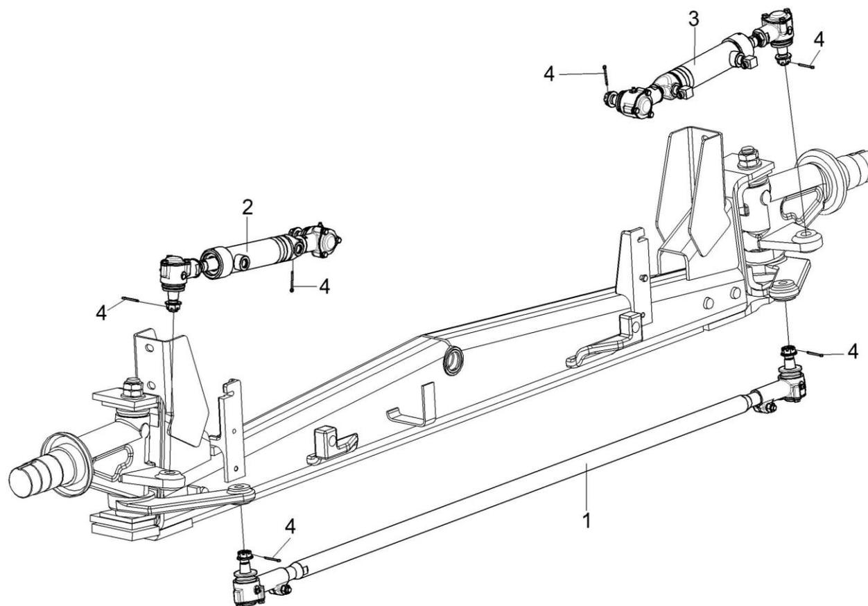
Рисунок 80 – Мост управляемых колес КГС 0109000 (тяга поперечная, гидроцилиндры)
