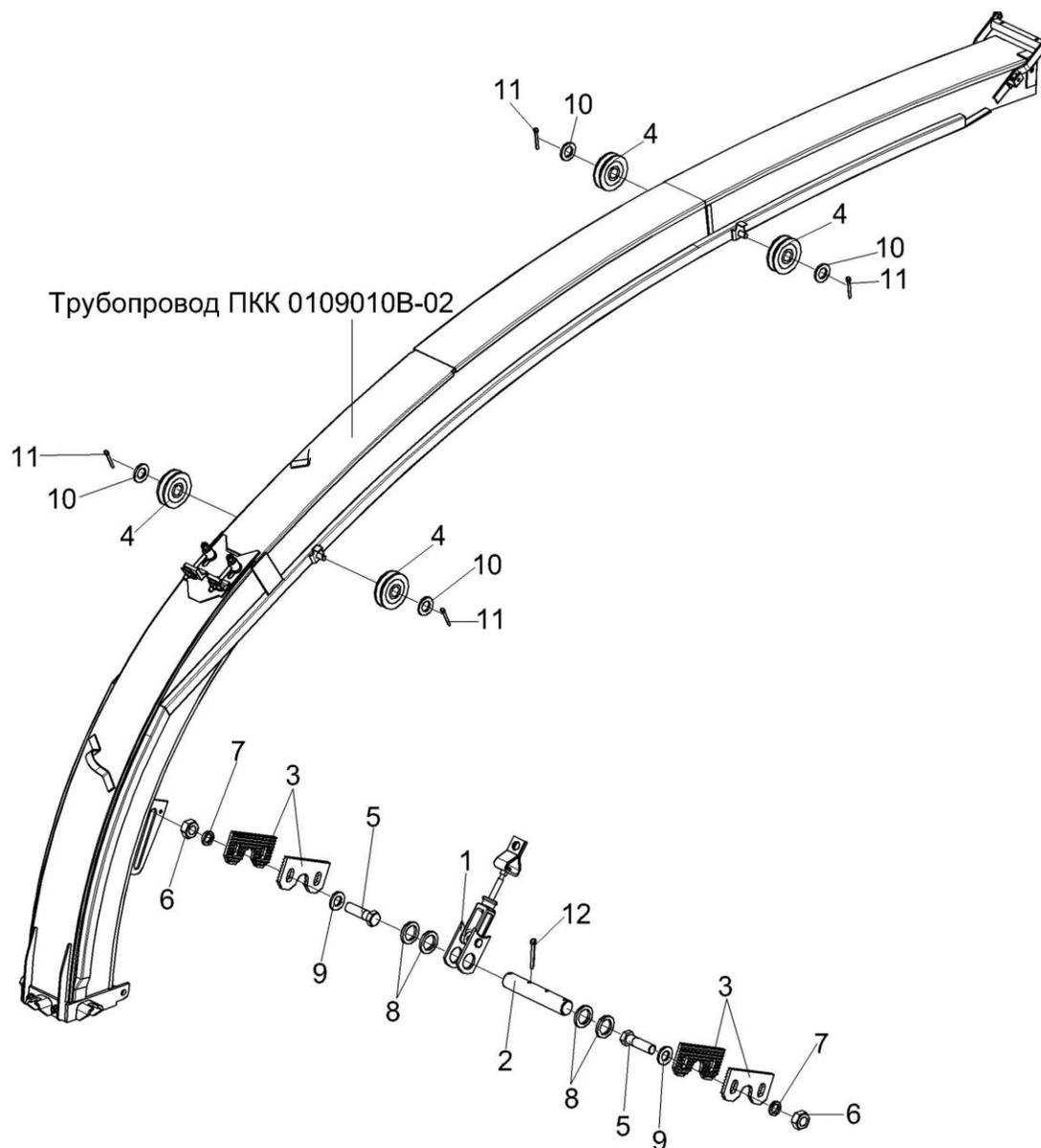
Рисунок 29 – Силопровод ПКК 0109000В-03 (установка устройства натяжного)
