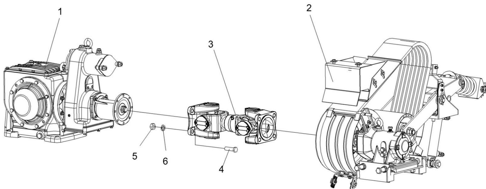
Рисунок 50 – Установка вала карданного КИЛ 0113070
