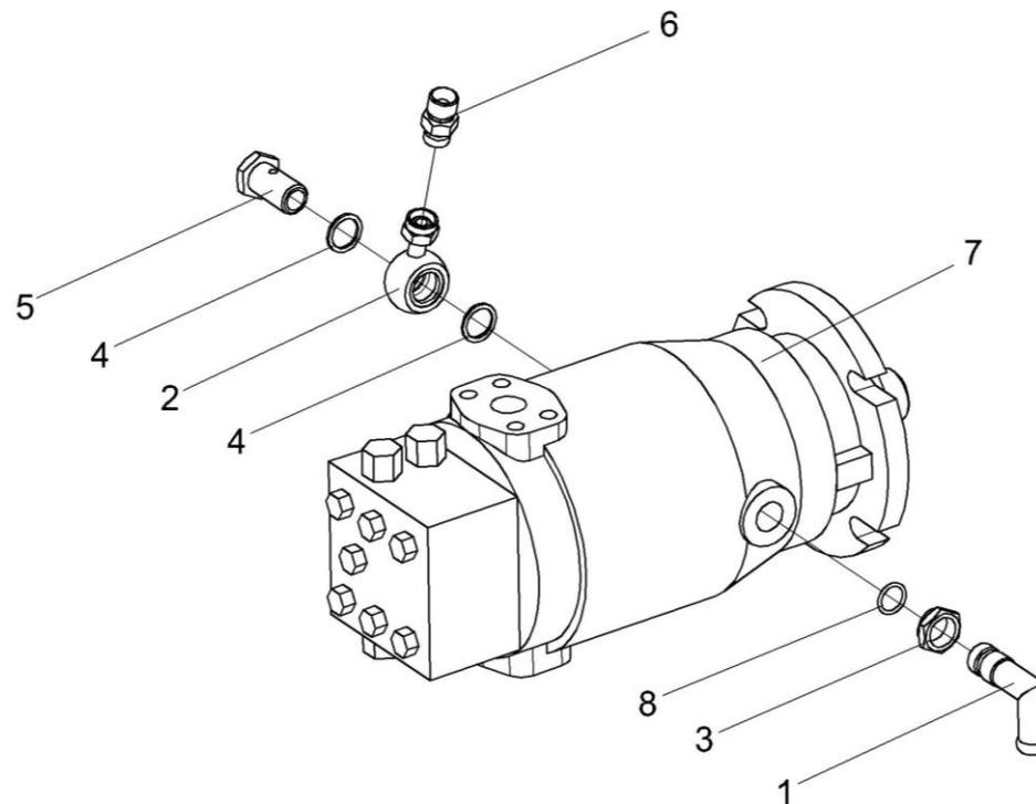
Рисунок 143 – Гидромотор КГС 0108020
