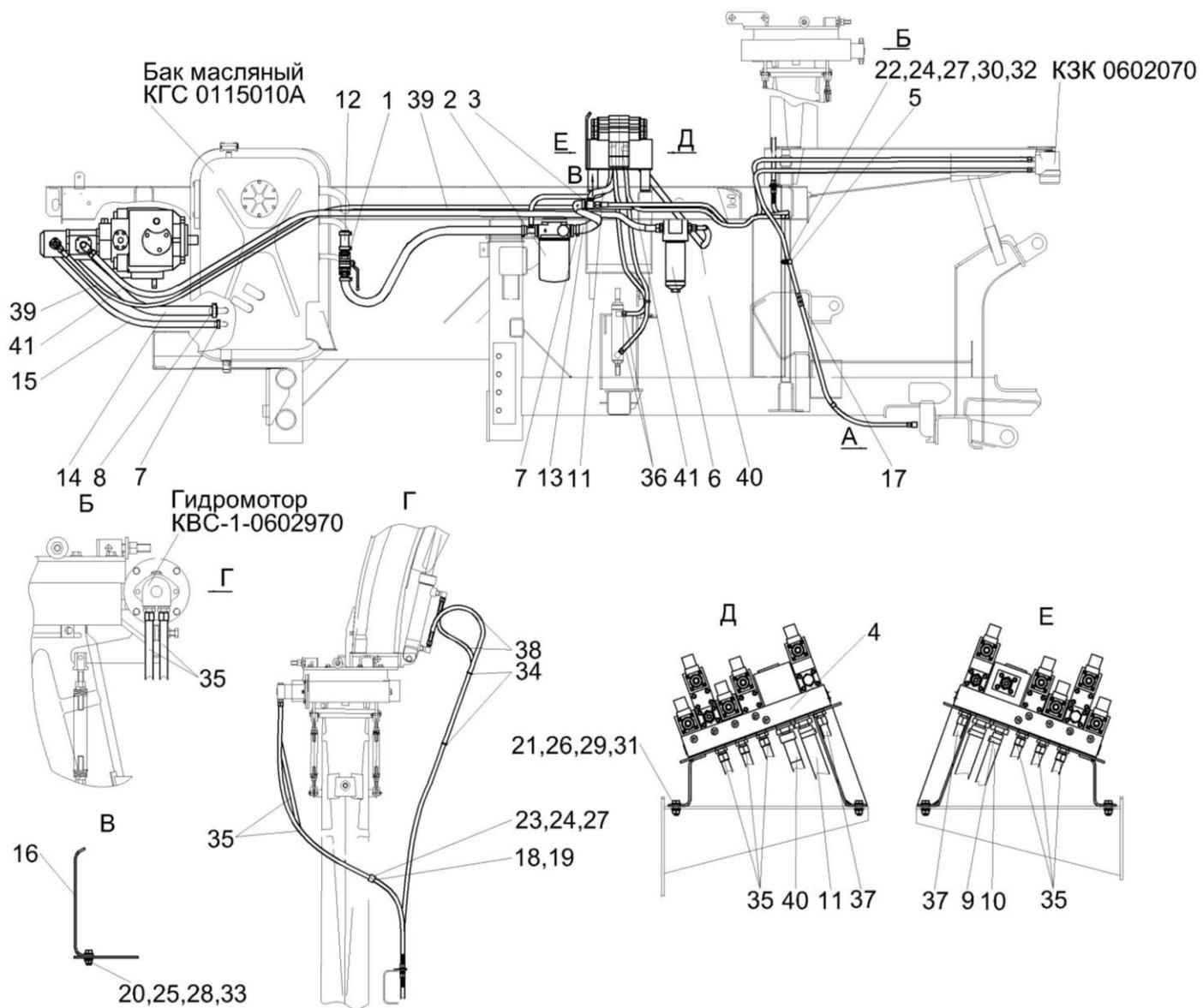
Рисунок 159 – Гидросистема рабочих органов и рулевого управления КГС 0125000 (вид справа)
