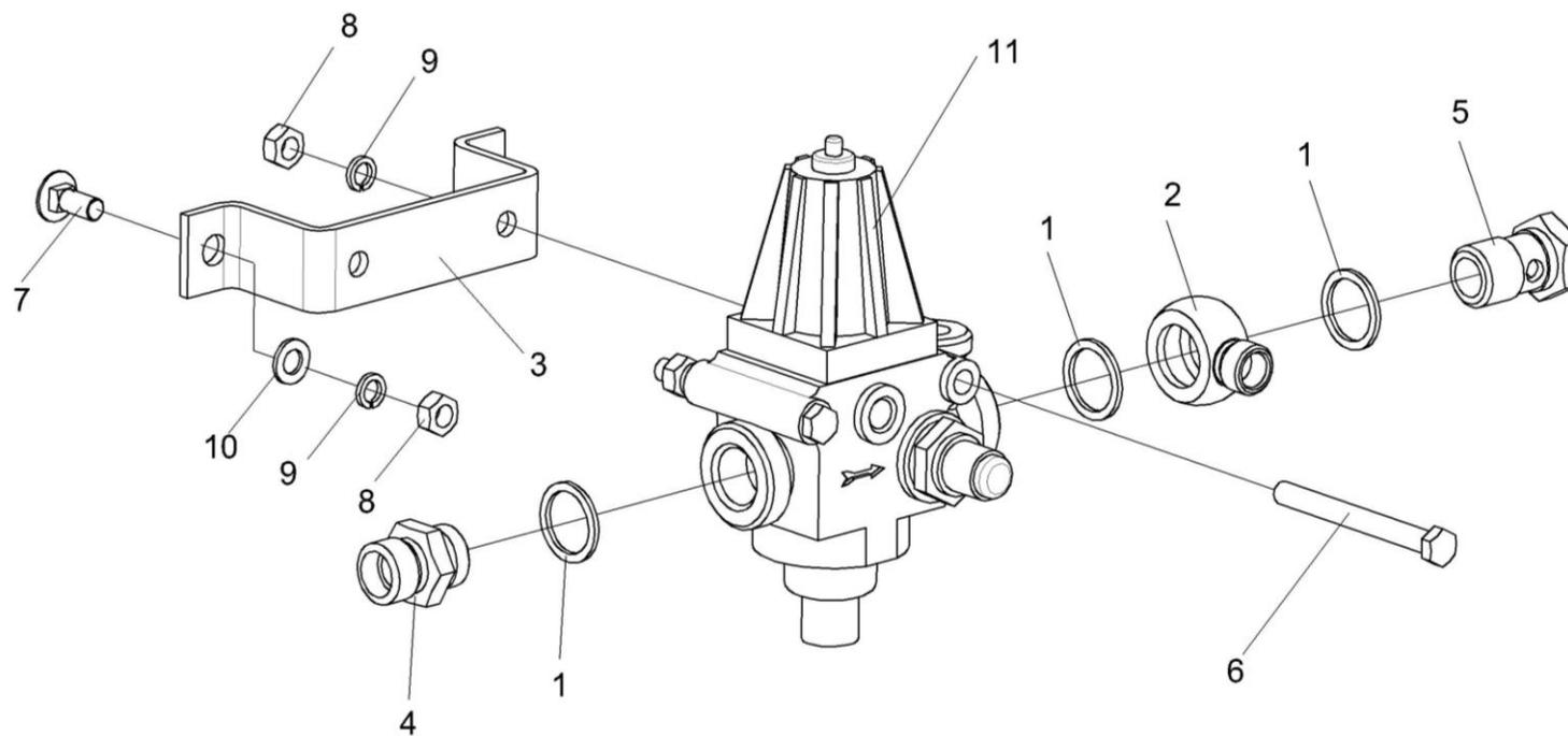
Рисунок 171 – Регулятор давления КГС 0180190
