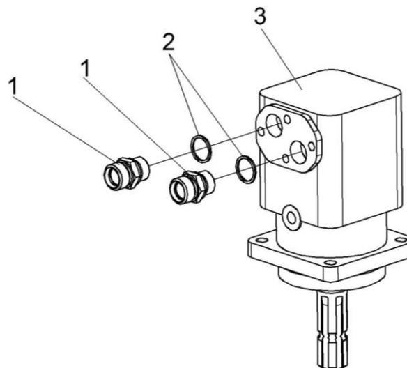
Рисунок 152 – Гидромотор привода адаптеров КГС 0115380
