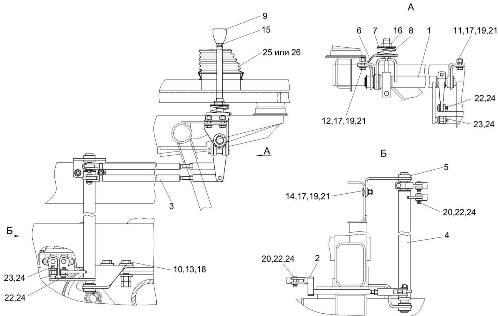
Рисунок 119 – Установка механизма управления коробкой передач КГС 0119030
