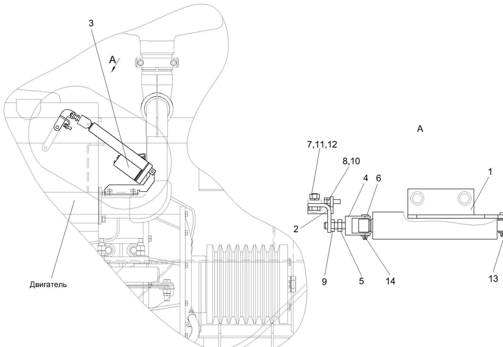
Рисунок 121 – Механизм управления топливным насосом КГС 0119120
