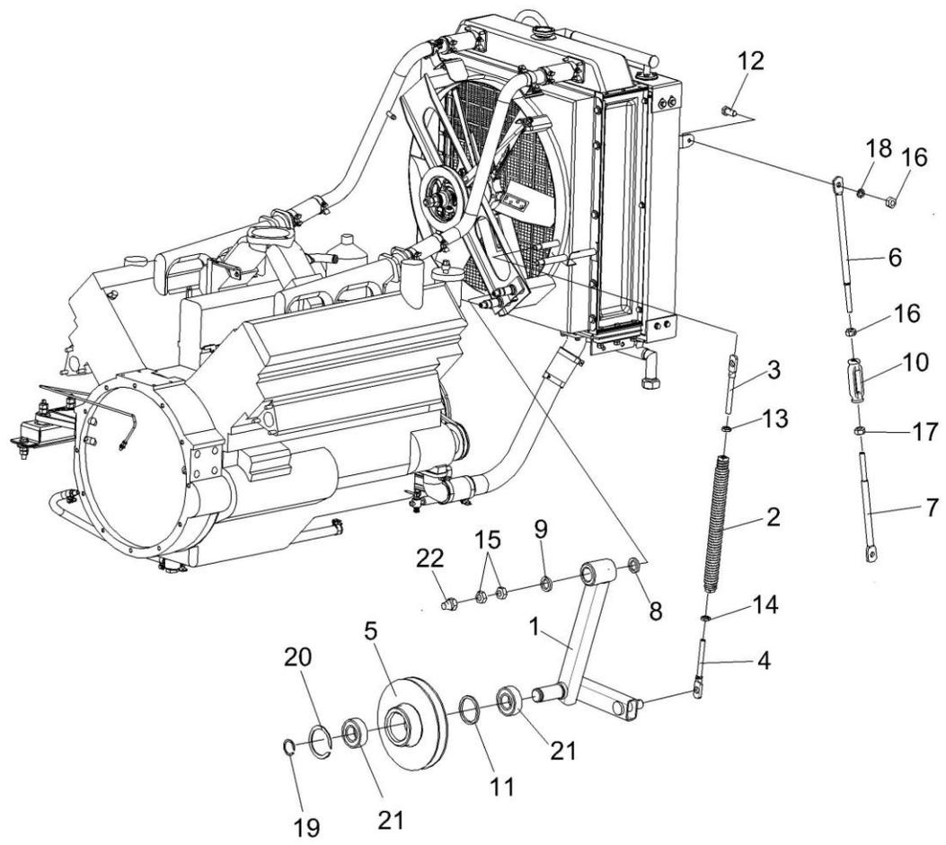
Рисунок 39 – Установка рычага КГС 0116230 и растяжки КИЛ-1-0116330
