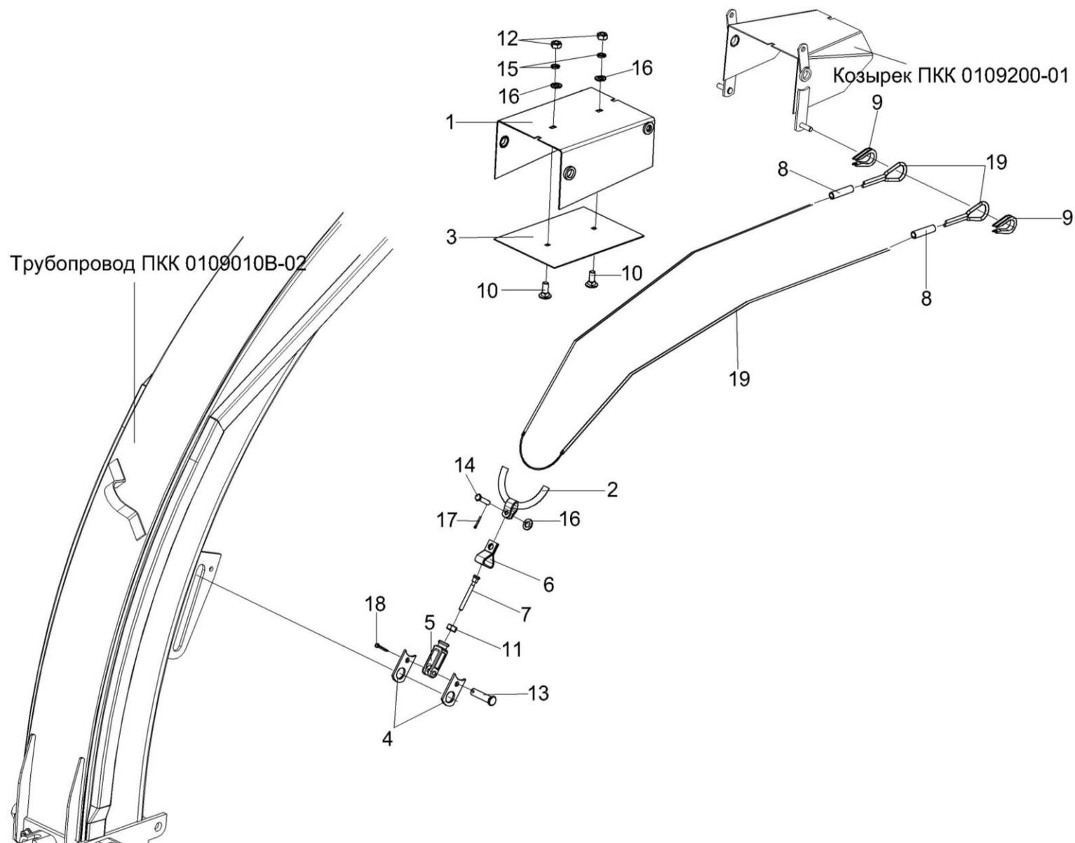
Рисунок 31 – Устройство натяжное, канат, козырьки силосопровода
