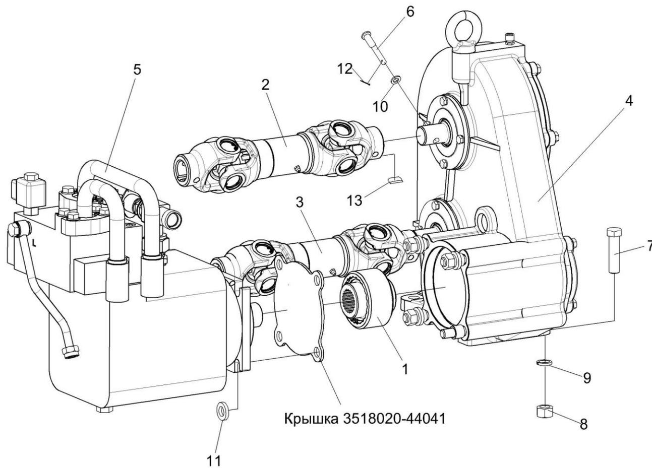
Рисунок 60 – Установка редуктора КГС 0114000
