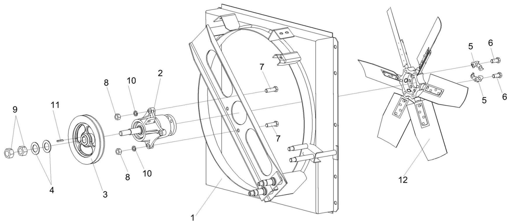
Рисунок 44 – Установка привода вентилятора КГС 0116250Б
