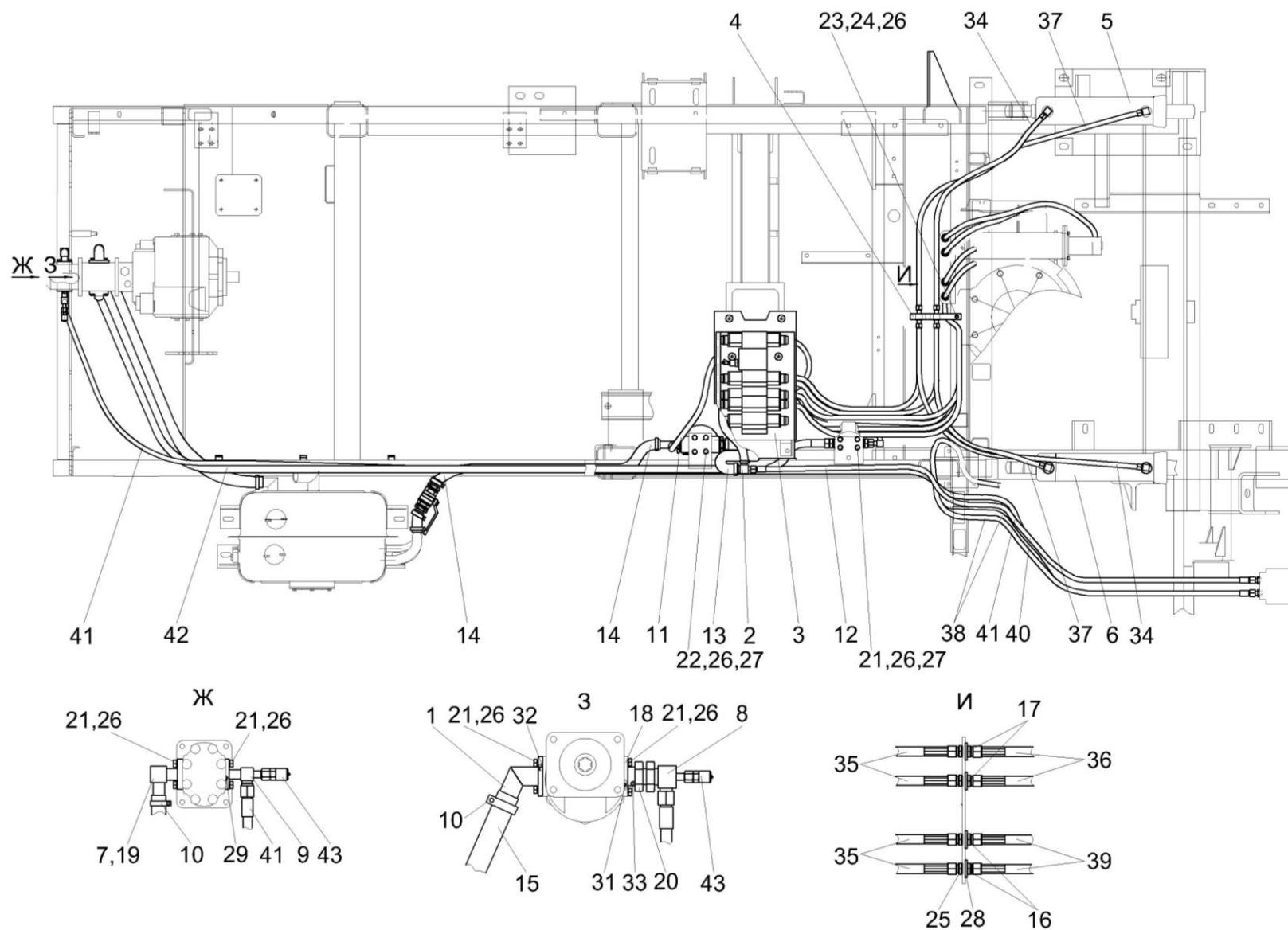
Рисунок 160 – Гидросистема рабочих органов и рулевого управления КГС 0125000 (вид сверху)
