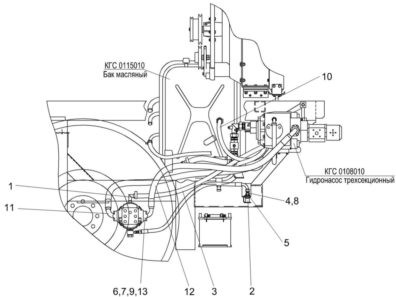
Рисунок 138 – Гидросистема привода ходовой части КГС 0108000А (вид слева)
