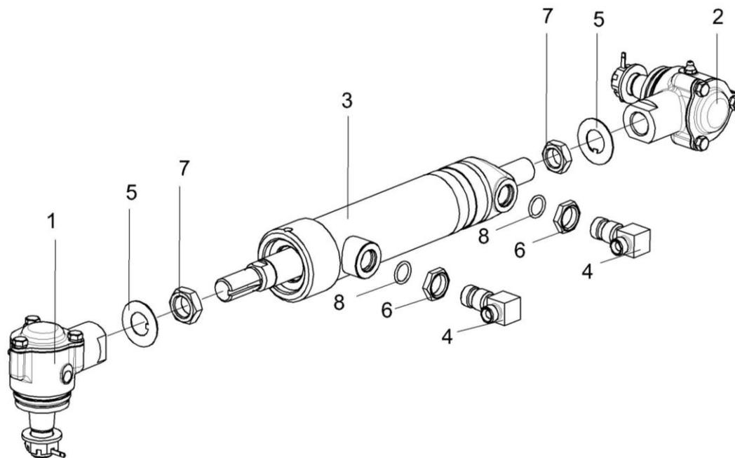
Рисунок 82 – Гидроцилиндр КИЛ 0118450
