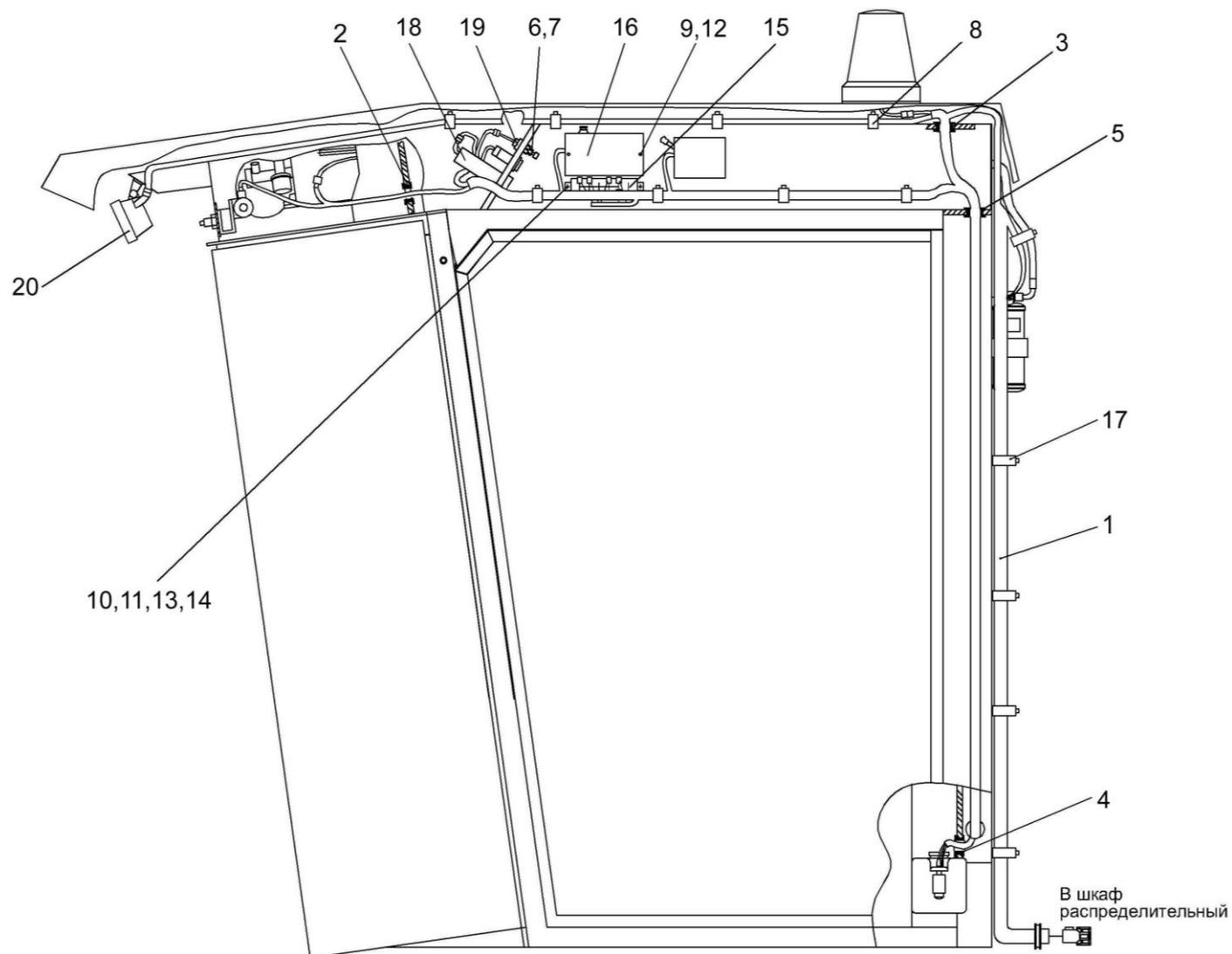
Рисунок 94 – Электрооборудование кабины КГС 0120000 (вид слева)
