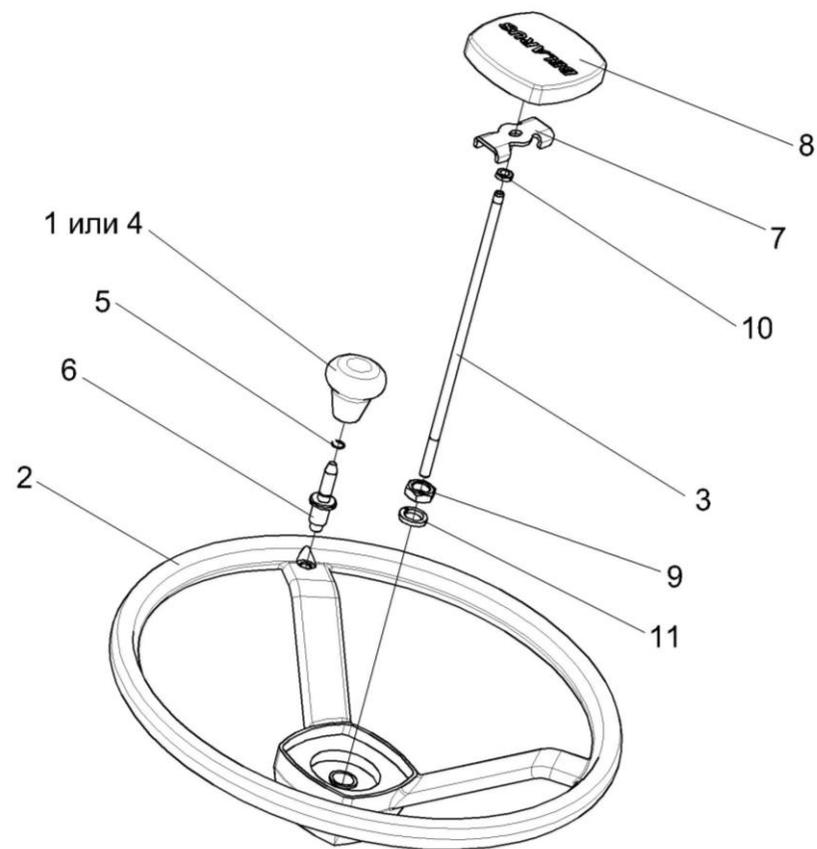
Рисунок 115 – Установка колеса рулевого КЗК-12-0122600-01
