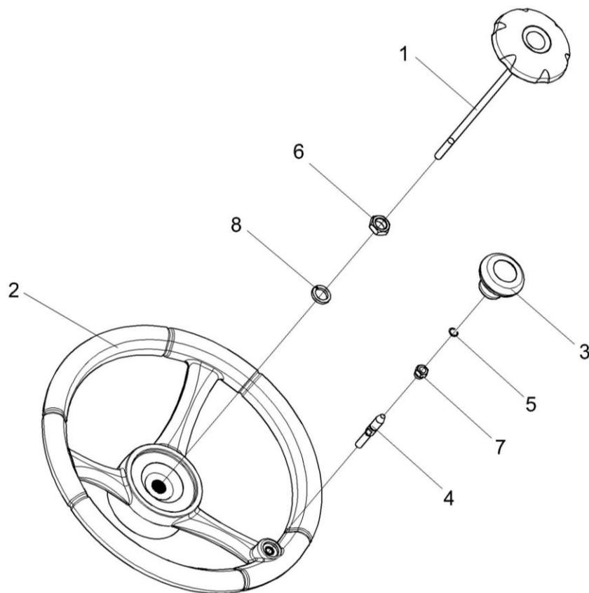
Рисунок 114 – Установка колеса рулевого КЗК-12-0122600
