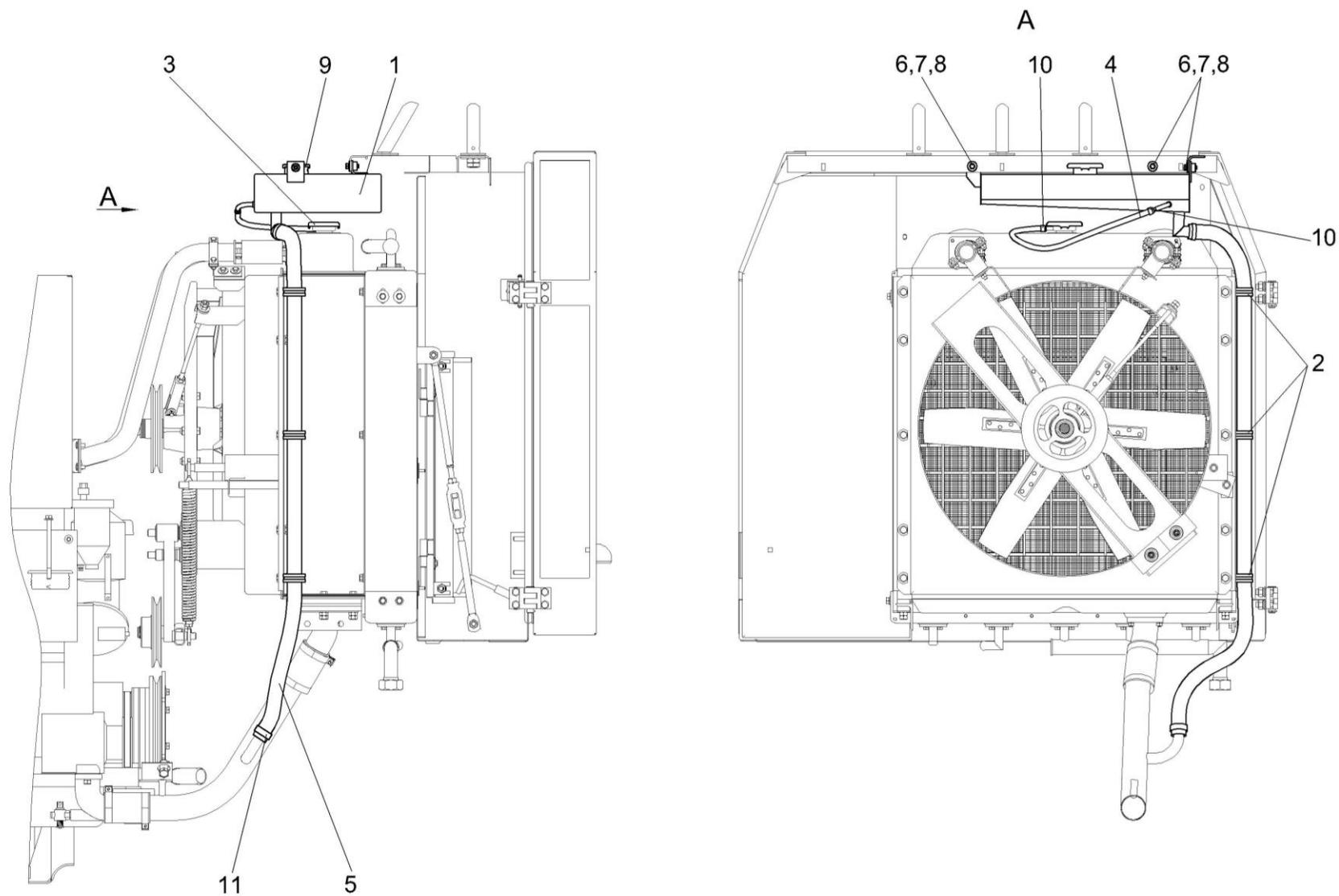
Рисунок 46 – Установка бачка расширительного КГС 0116630
