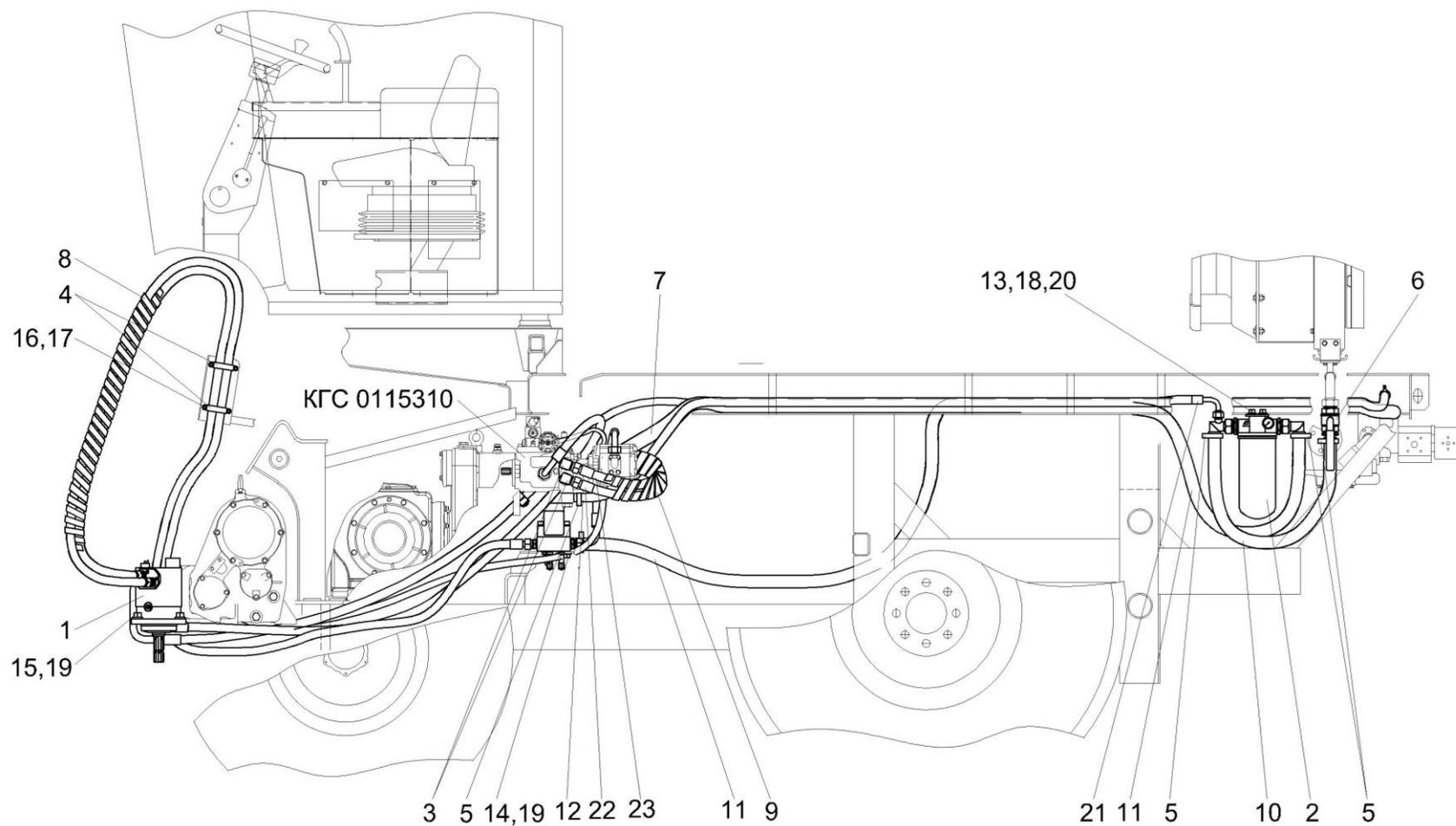
Рисунок 148 – Гидросистема привода питающего аппарата и адаптеров КГС 0118000 (вид слева)
