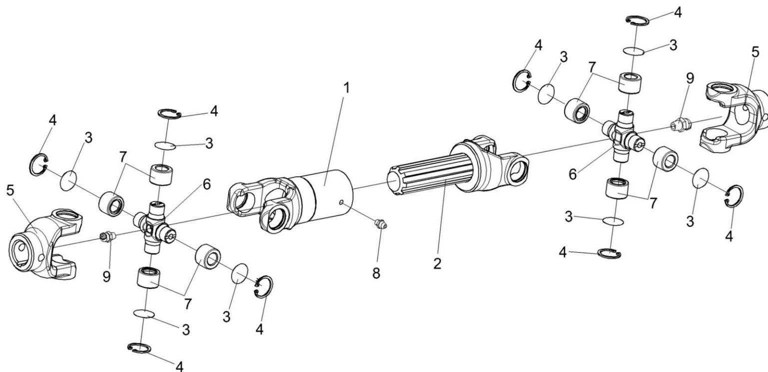
Рисунок 65 – Вал карданный телескопический КГС 0112400
