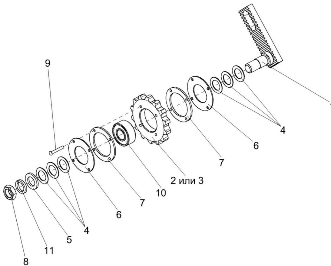
Рисунок 23 – Устройство натяжное КИС 0103470
