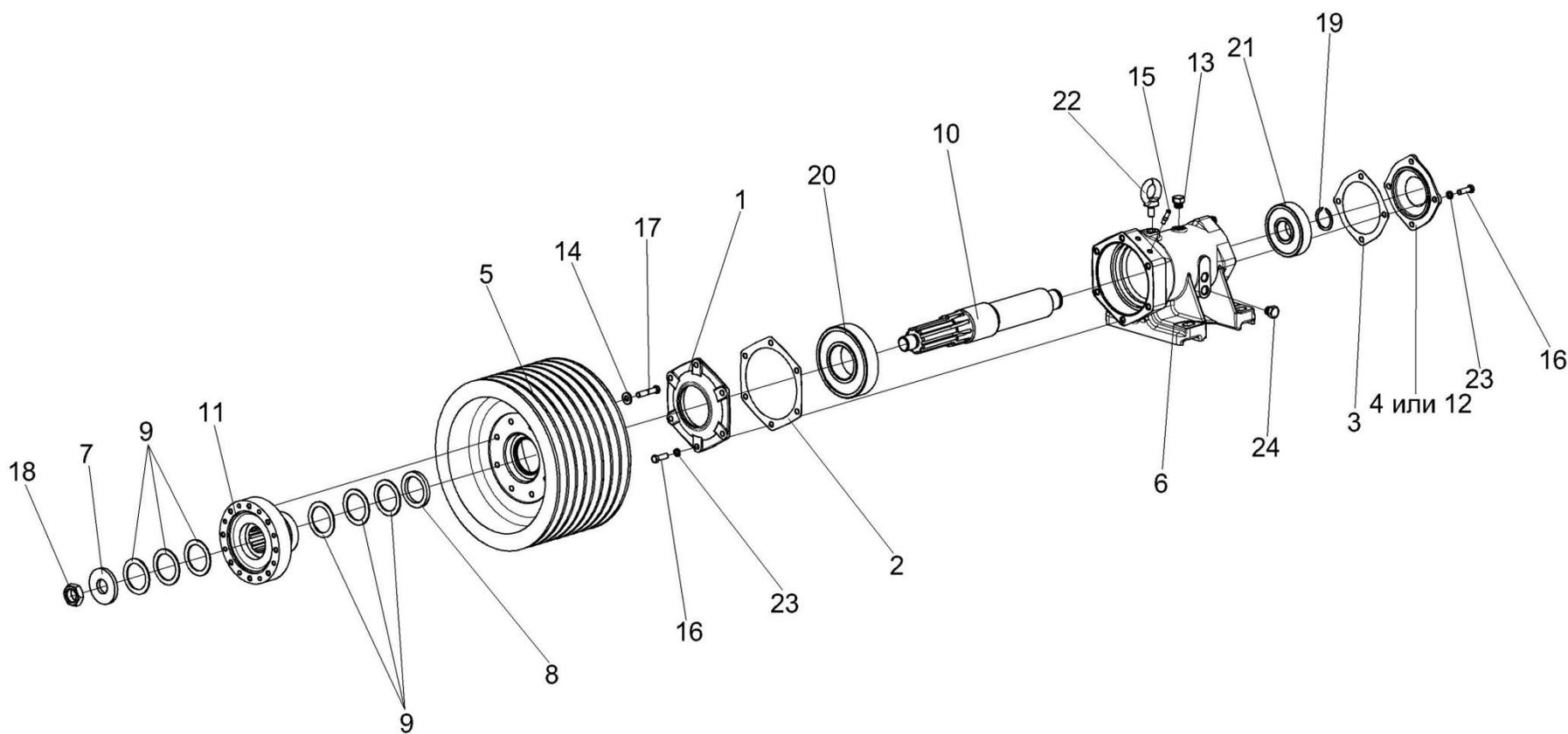
Рисунок 59 – Контрпривод КИЛ 0149100
