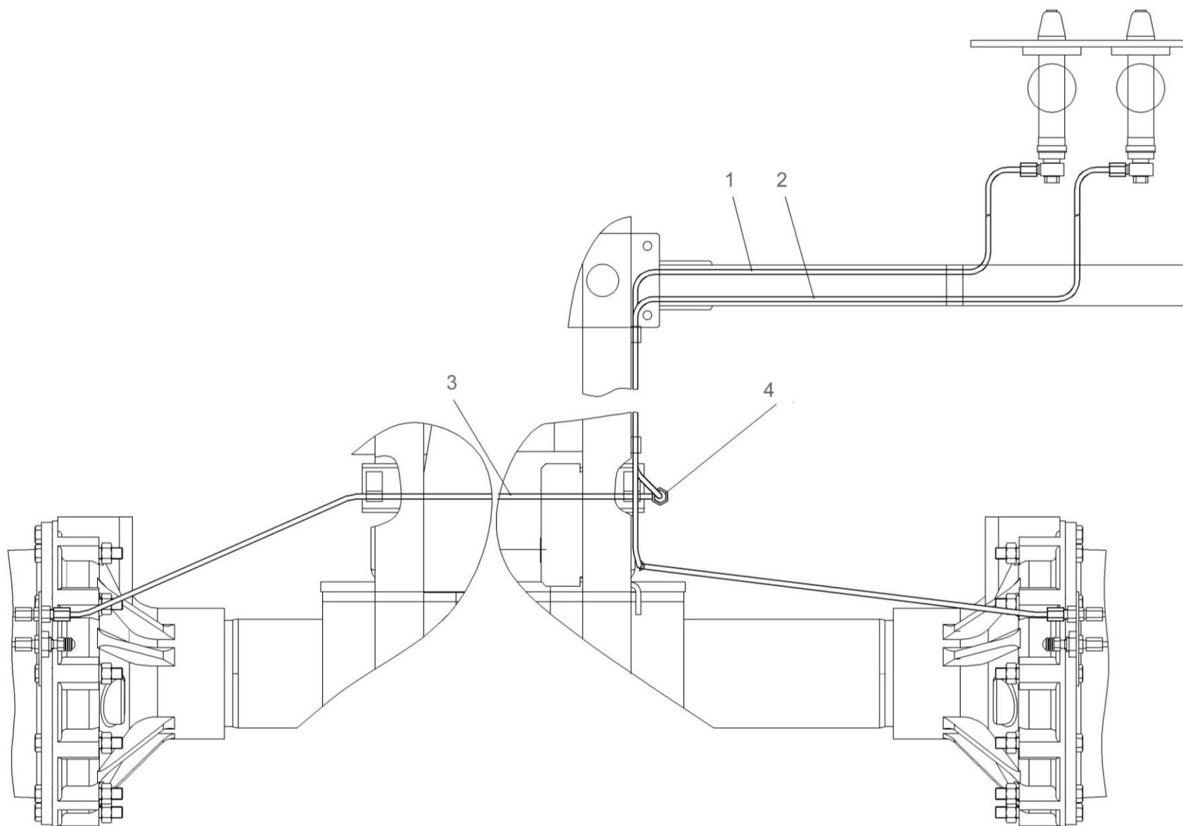
Рисунок 125 – Установка трубопроводов управления тормозами КГС 0119700
