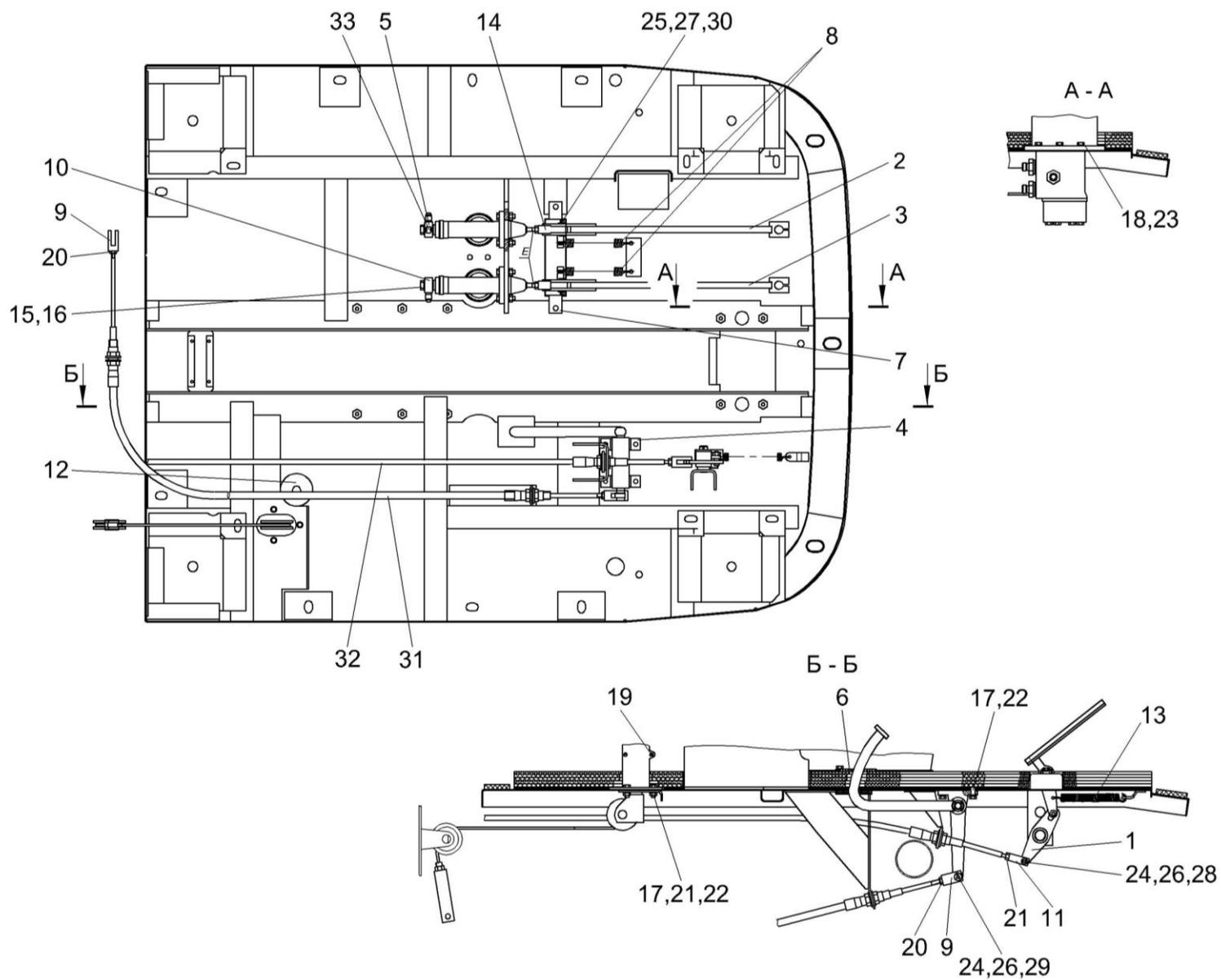
Рисунок 102 – Площадка управления КГС 0119000 (вид снизу)
