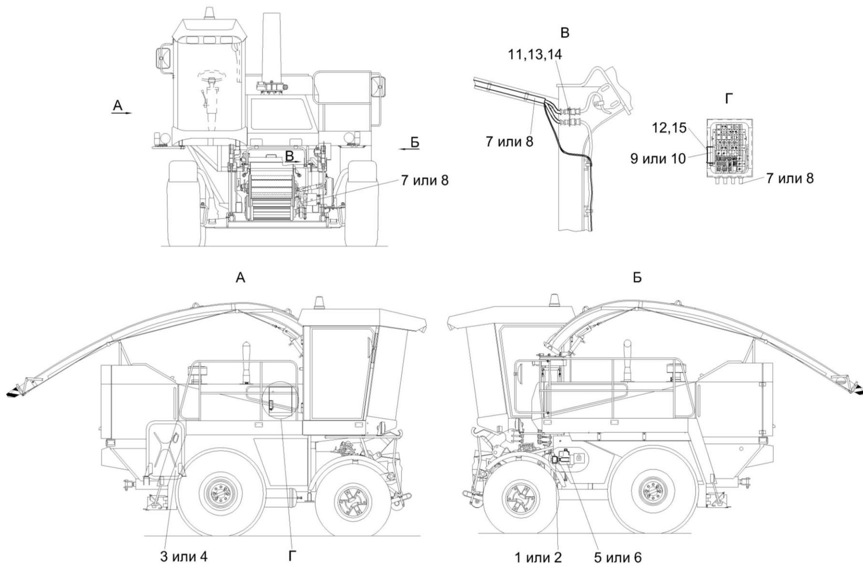
Рисунок 144 – Установка гидросистемы КГС 0100100 и КГС 0100100-01
