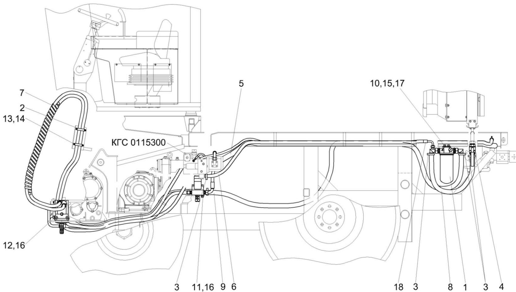
Рисунок 146 – Гидросистема привода питающего аппарата и адаптеров КГС 0115000 (вид слева)
