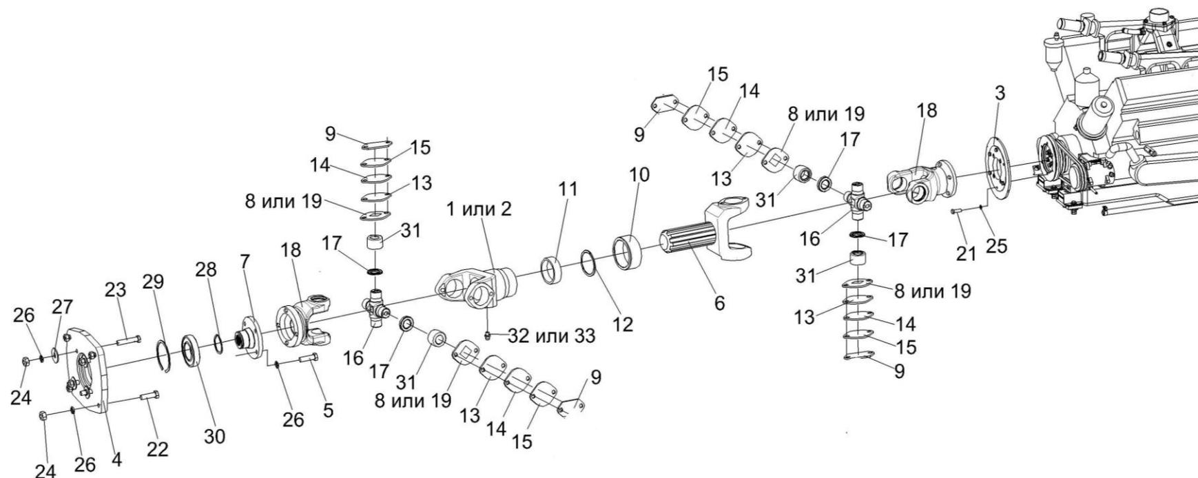
Рисунок 37 – Установка вала карданного КИЛ 0106850
