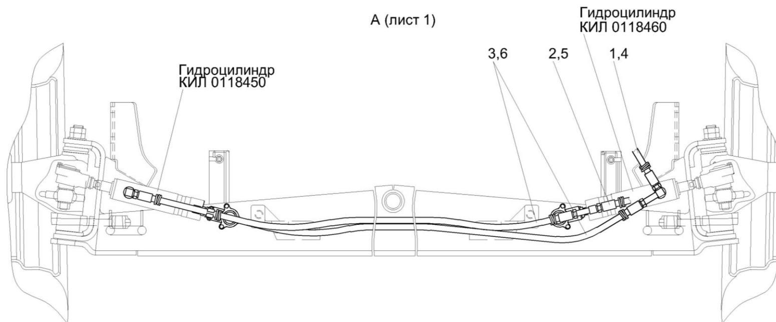
Рисунок 161 – Гидросистема рабочих органов и рулевого управления КГС 0125000
