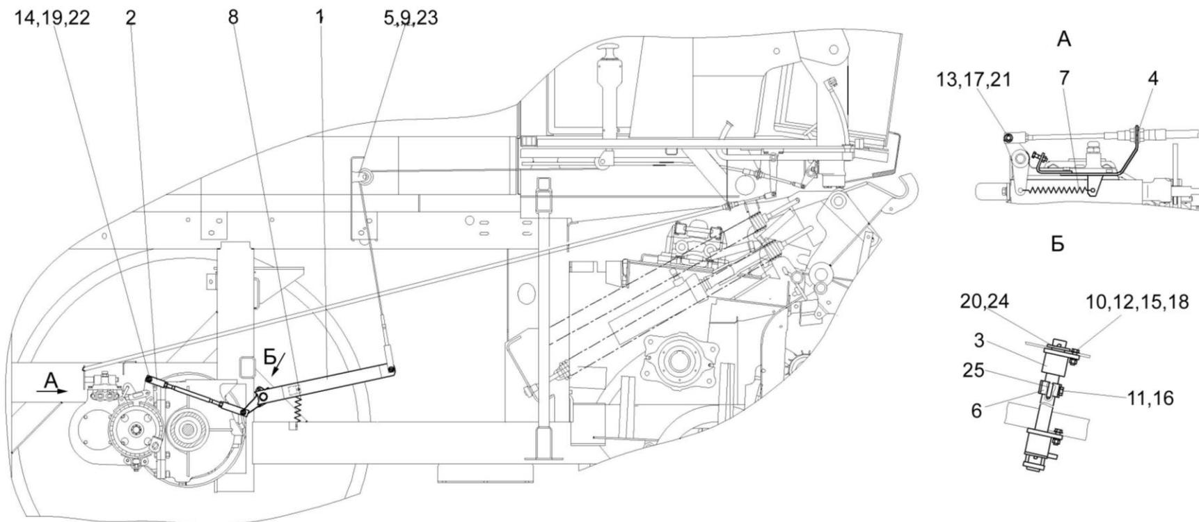
Рисунок 123 – Установка приводов стояночного тормоза и блокировки КГС 0119530
