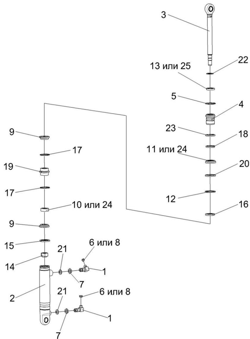
Рисунок 32 – Гидроцилиндр ПКК 0113200-06
