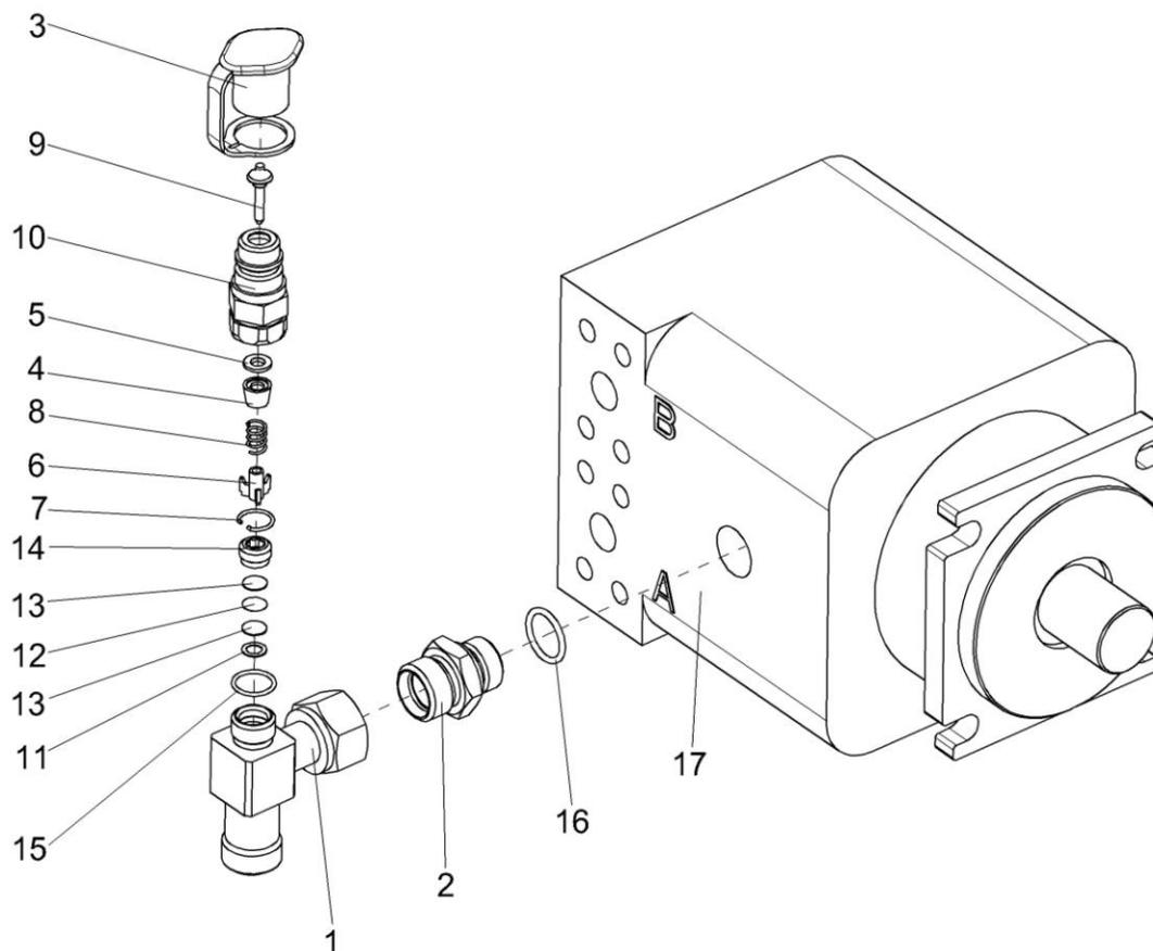
Рисунок 158 – Гидромотор привода питающего аппарата КГС 0115730
