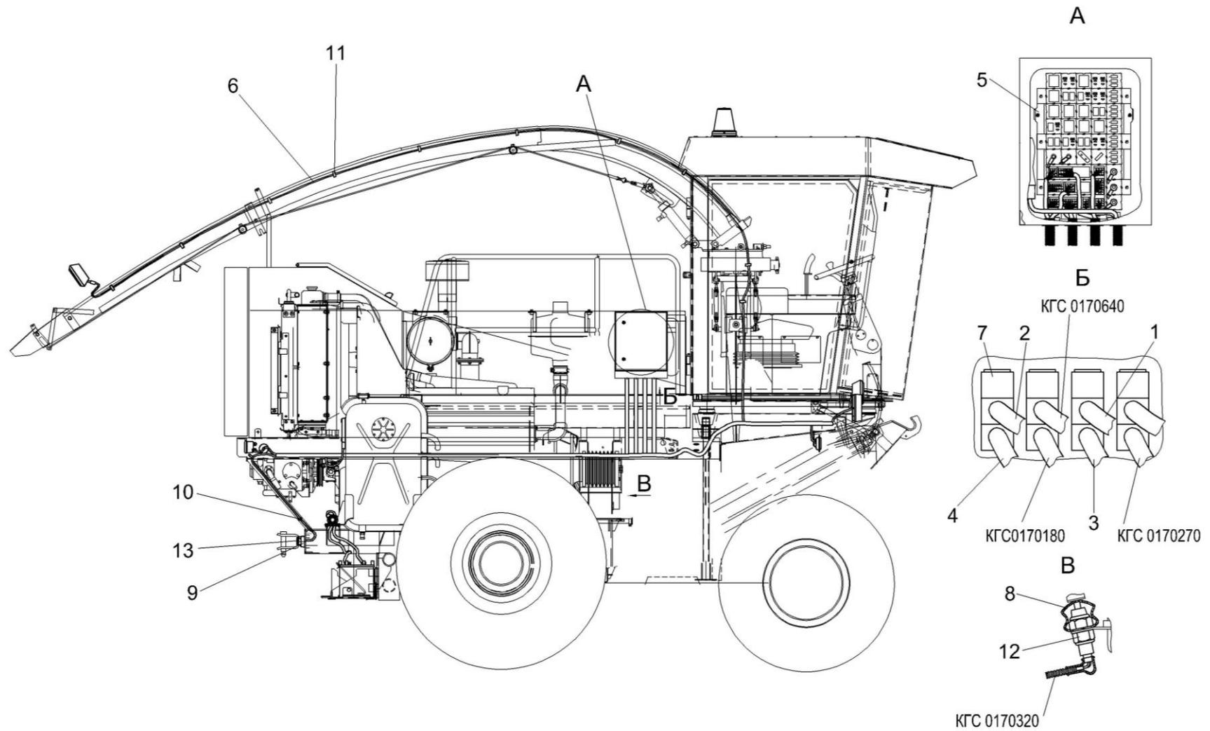
Рисунок 5 – Электрооборудование измельчителя самоходного (вид справа)
