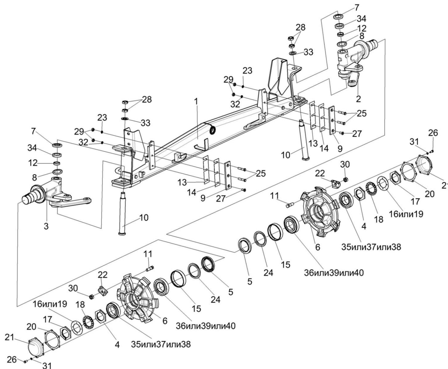
Рисунок 79 – Мост управляемых колес КГС 0109000 (установка ступиц)
