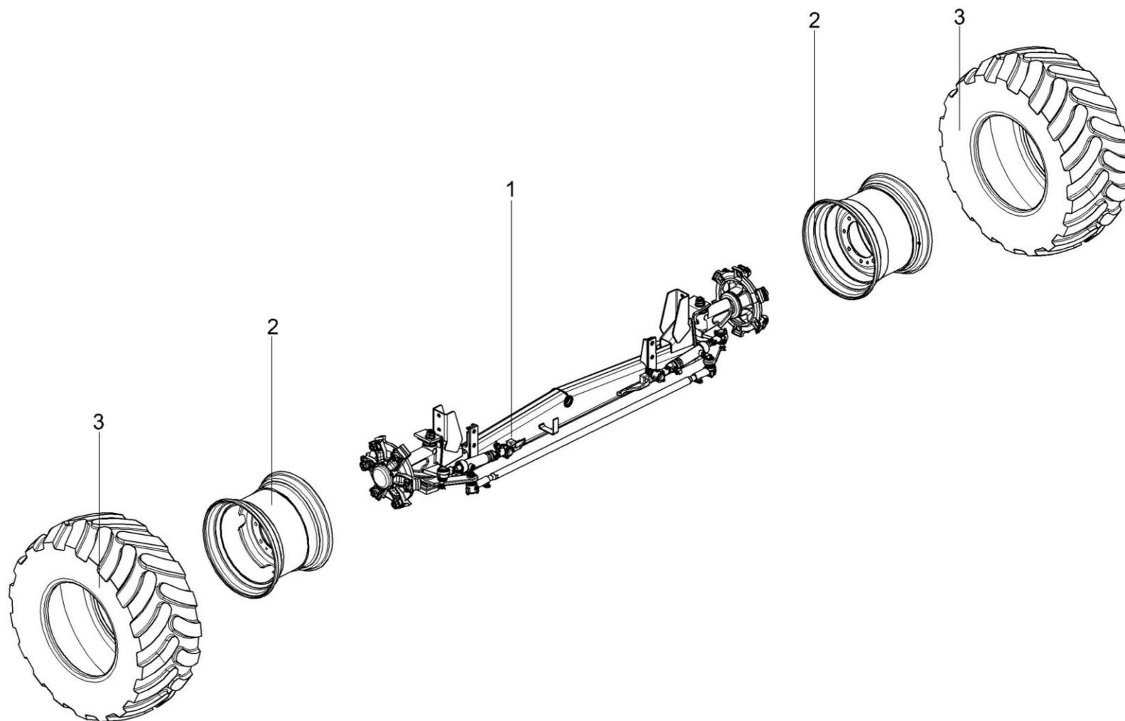
Рисунок 78 – Установка колес КГС 0110000 и КГС 0110000-01
