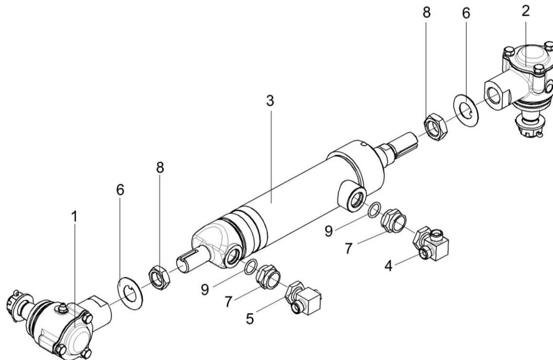
Рисунок 83 – Гидроцилиндр КИЛ 0118460
