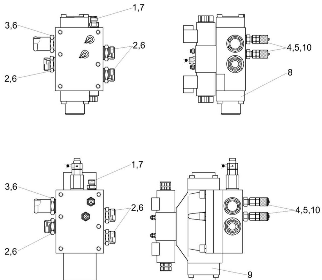
Рисунок 151 – Гидроблок адаптеров КГС 0115150 и КГС 0115160
