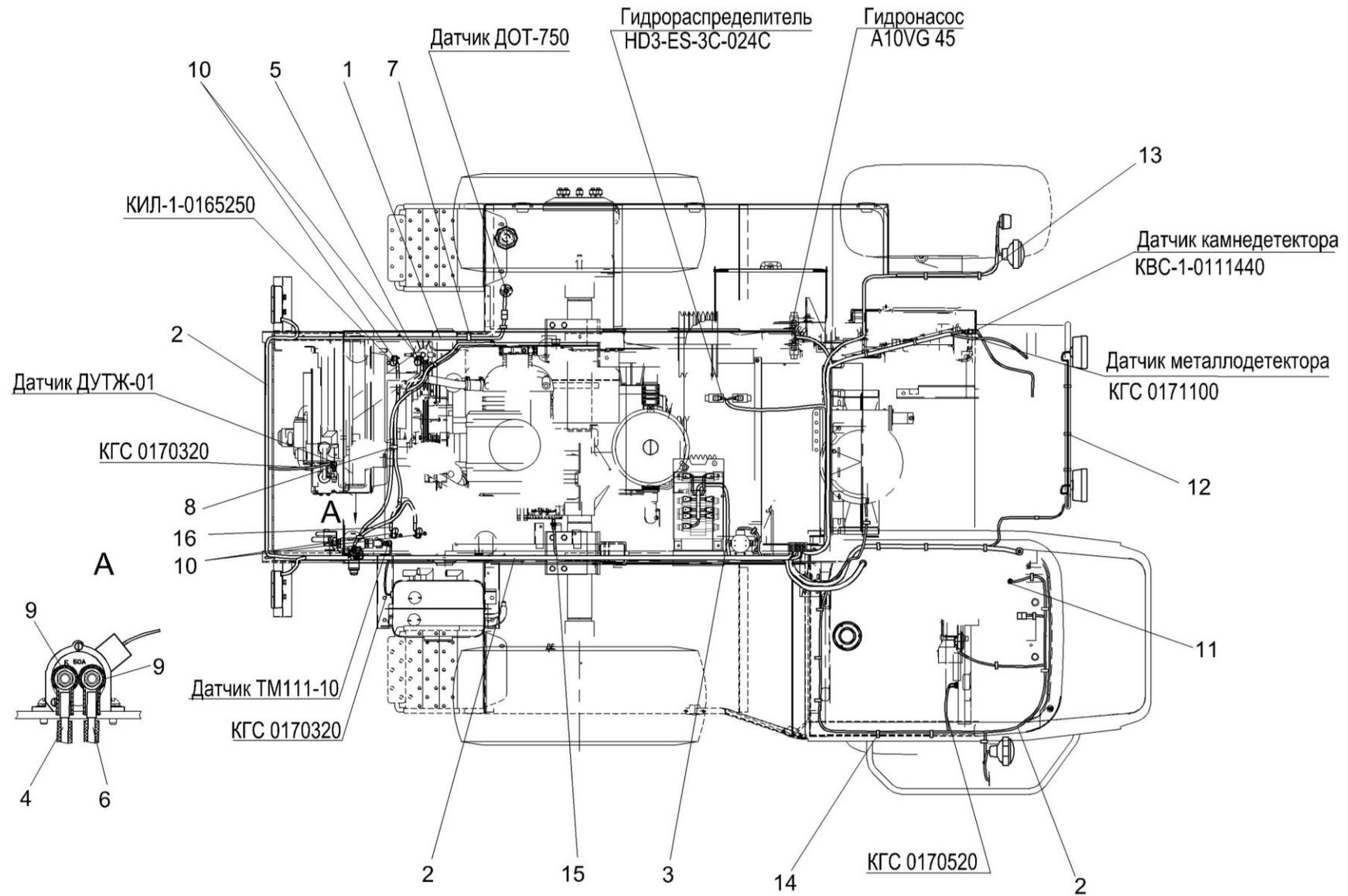
Рисунок 6 – Электрооборудование измельчителя самоходного (вид сверху)
