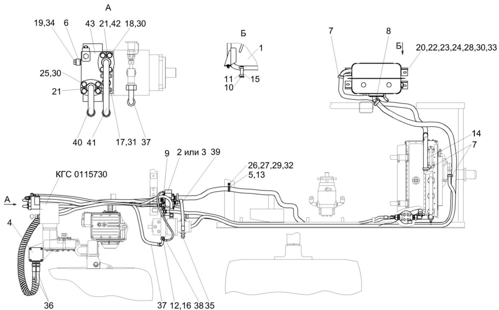
Рисунок 147 – Гидросистема привода питающего аппарата и адаптеров КГС 0115000 (вид сверху)
