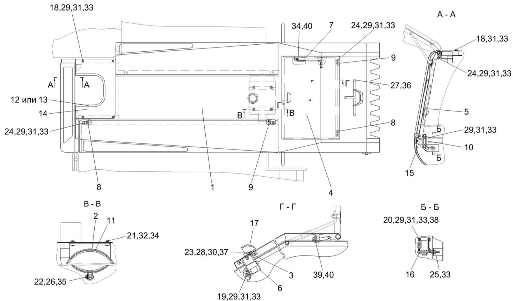
Рисунок 128 – Установка капотов КГС 0128000 (вид сверху)
