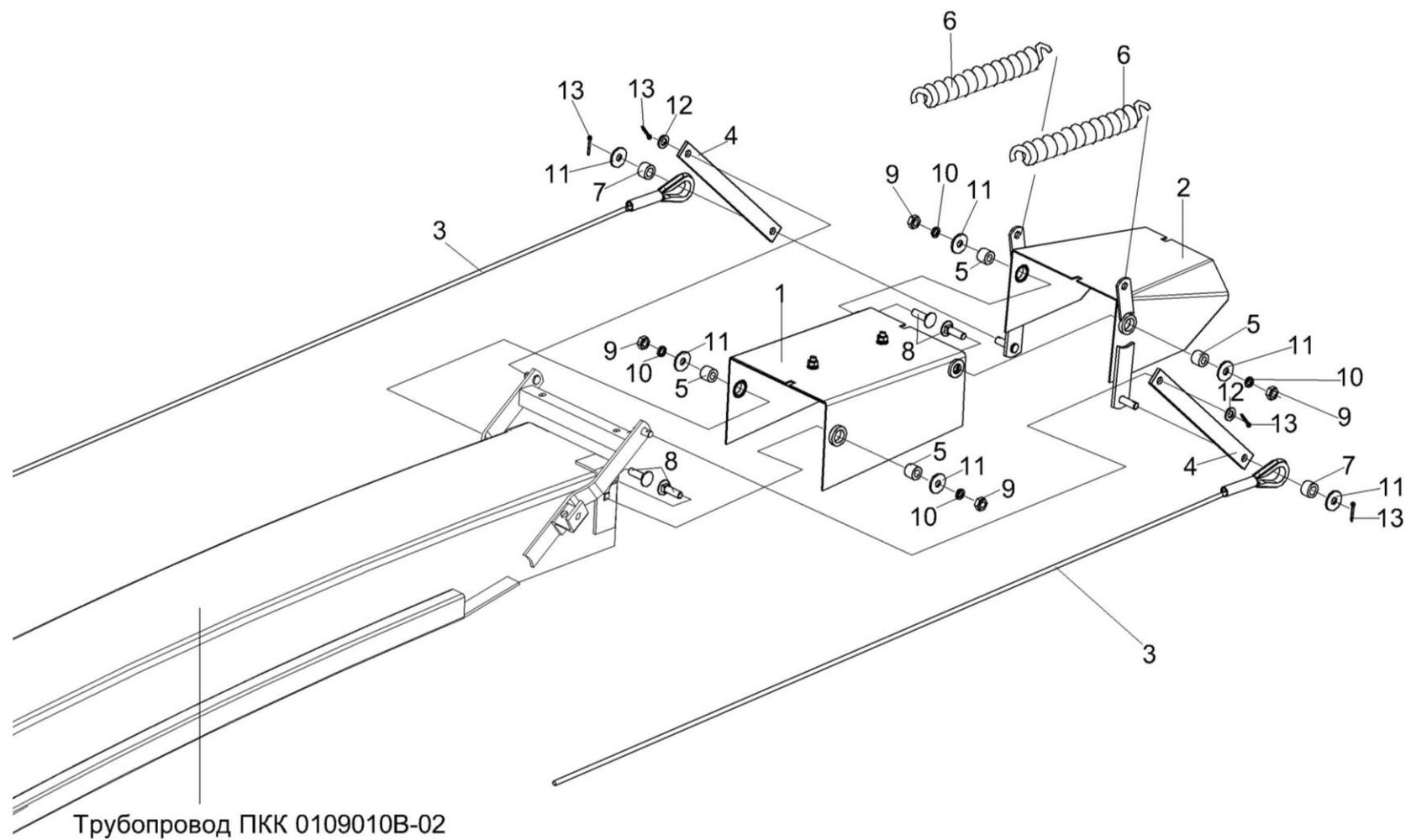
Рисунок 28 – Силосопровод ПКК 0109000В-03 (установка козырьков)
