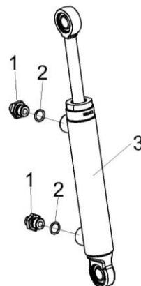
Рисунок 58 – Гидроцилиндр КЗК-12-0602310
