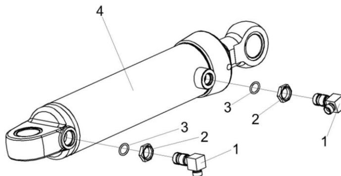
Рисунок 167 – Гидроцилиндры КИЛ 0118440 и КИЛ 0118440-02
