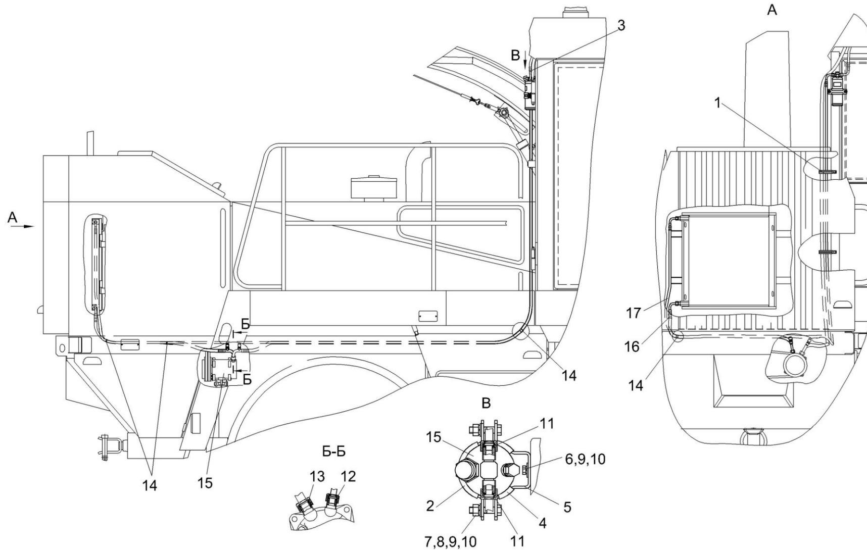
Рисунок 96 – Установка климатическая КГС 0121000
