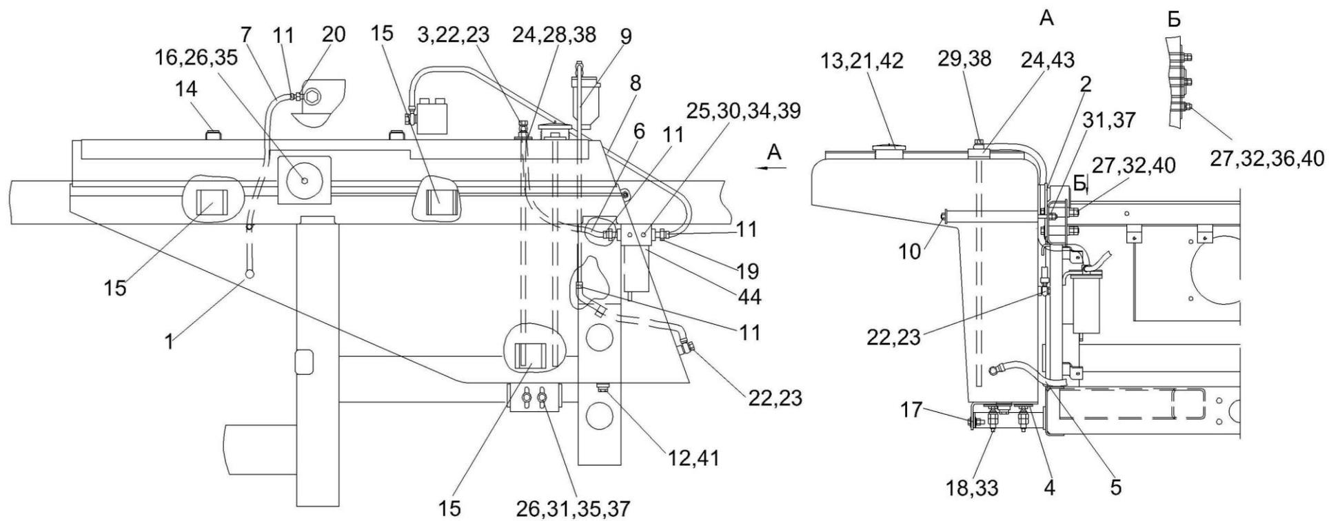
Рисунок 99 – Установка топливного оборудования КГС 0123000
