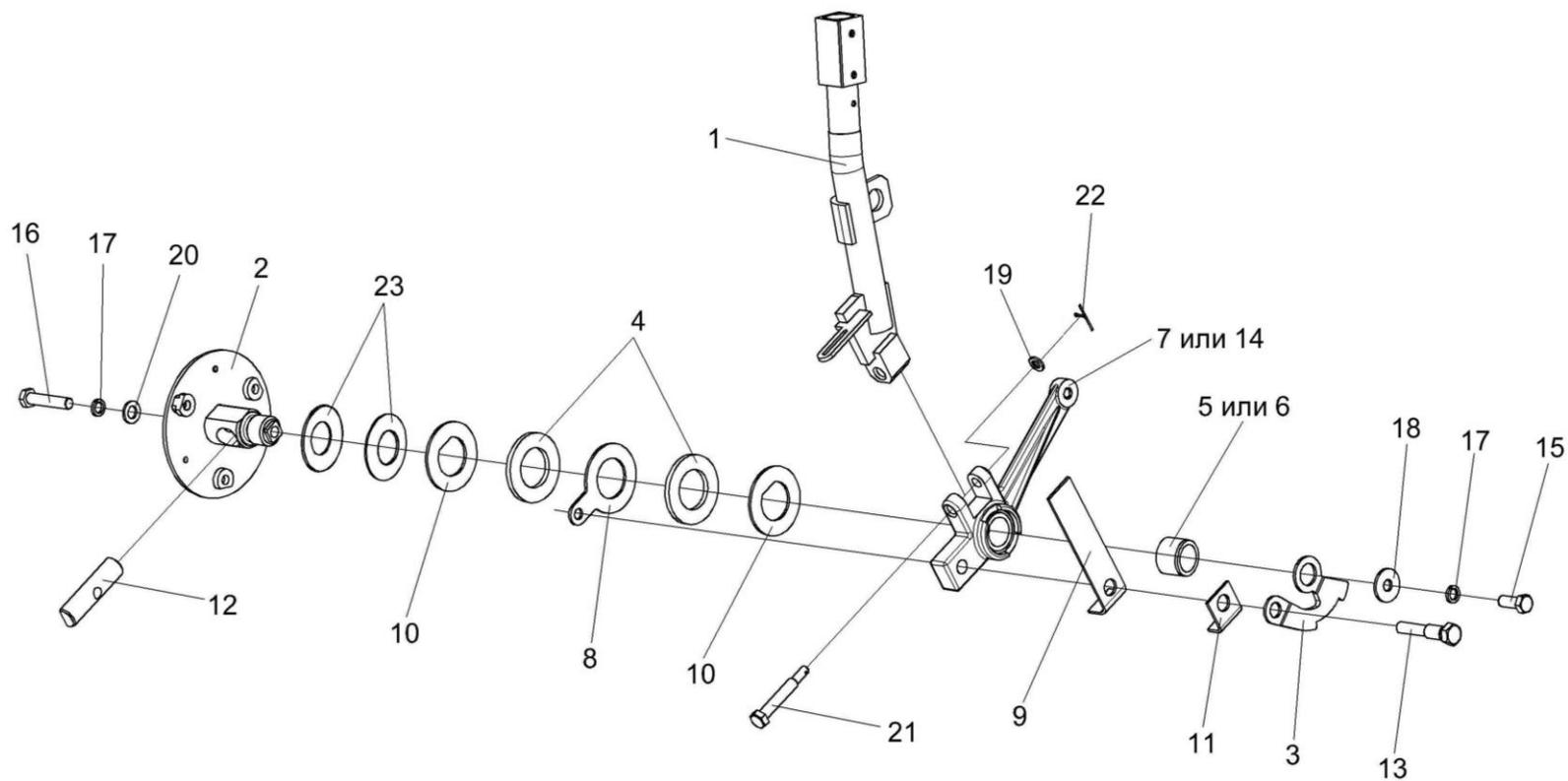
Рисунок 106 – Привод КГС 0119300
