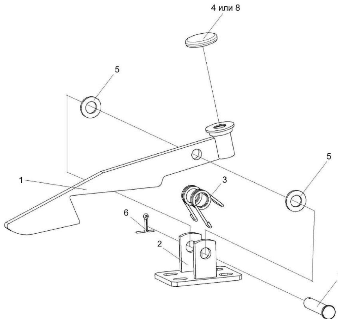
Рисунок 238 – Механизм фиксации трапа КЗС 0117100
