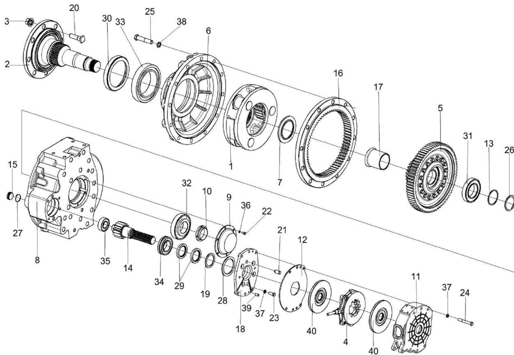
Рисунок 84 – Редуктор бортовой КЗК-10-0107200 (лист 2)
