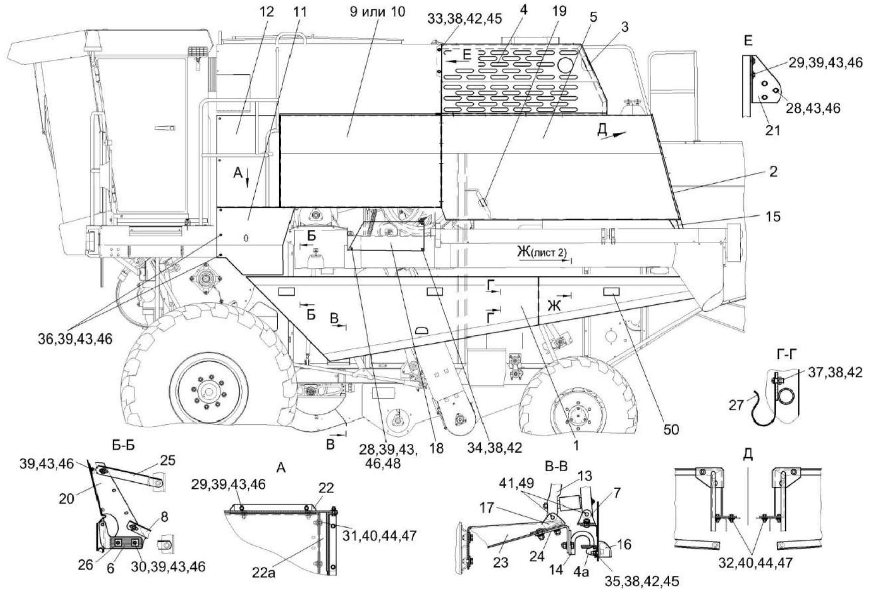
Рисунок 229 – Установка капотов и ограждений КЗК-8А-0128000-03 (вид слева)
