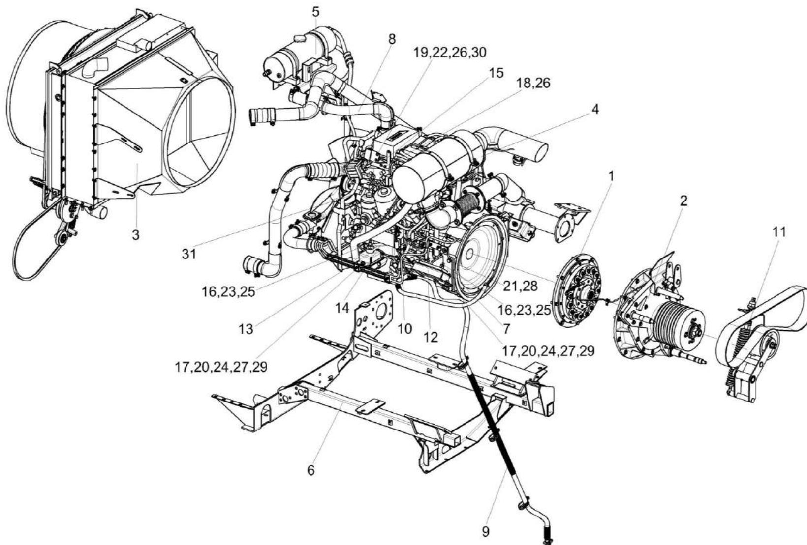
Рисунок 153 – Двигатель КЗК-8А-10-1-0106010 (лист 1)
