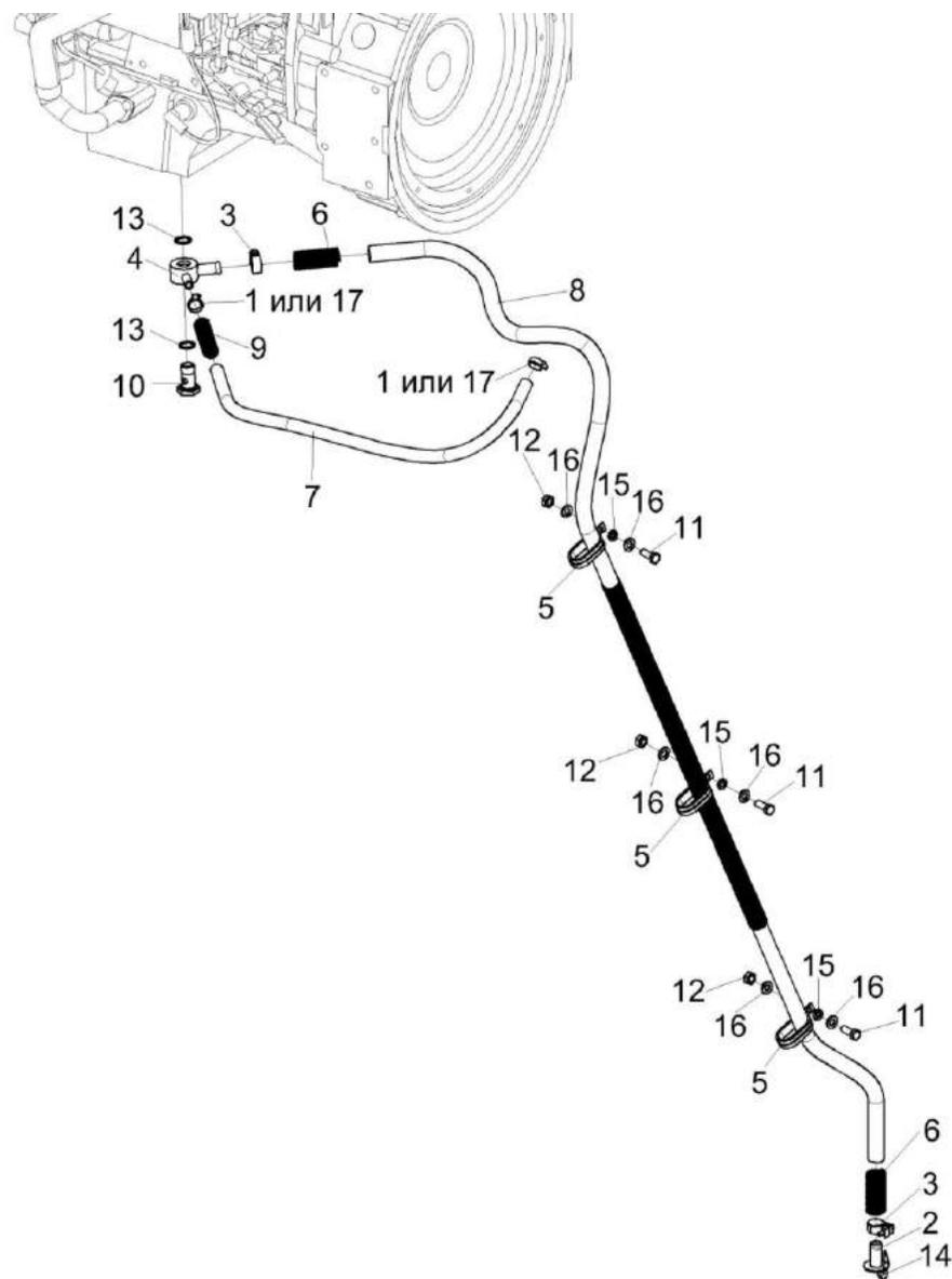
Рисунок 170 – Установка сливных рукавов КЗК-8А-10-1-0106490
