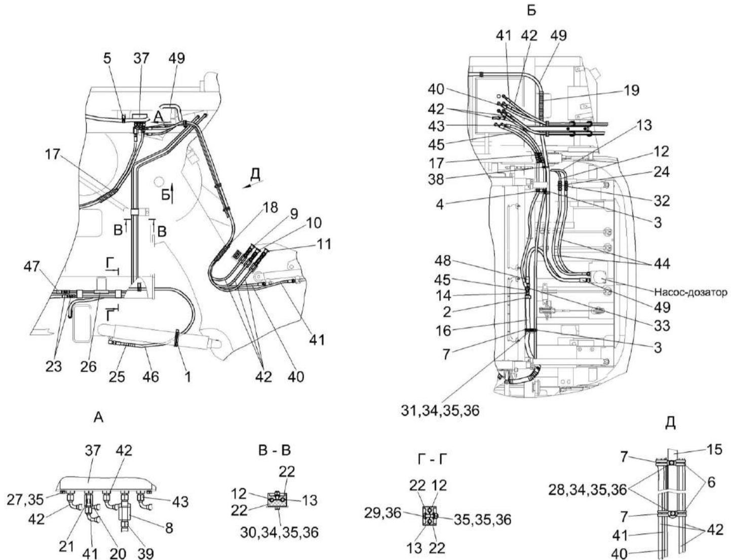
Рисунок 248 – Гидросистема рулевого управления и силовых гидроцилиндров КЗК-8А-2-0602000 (вид справа)
