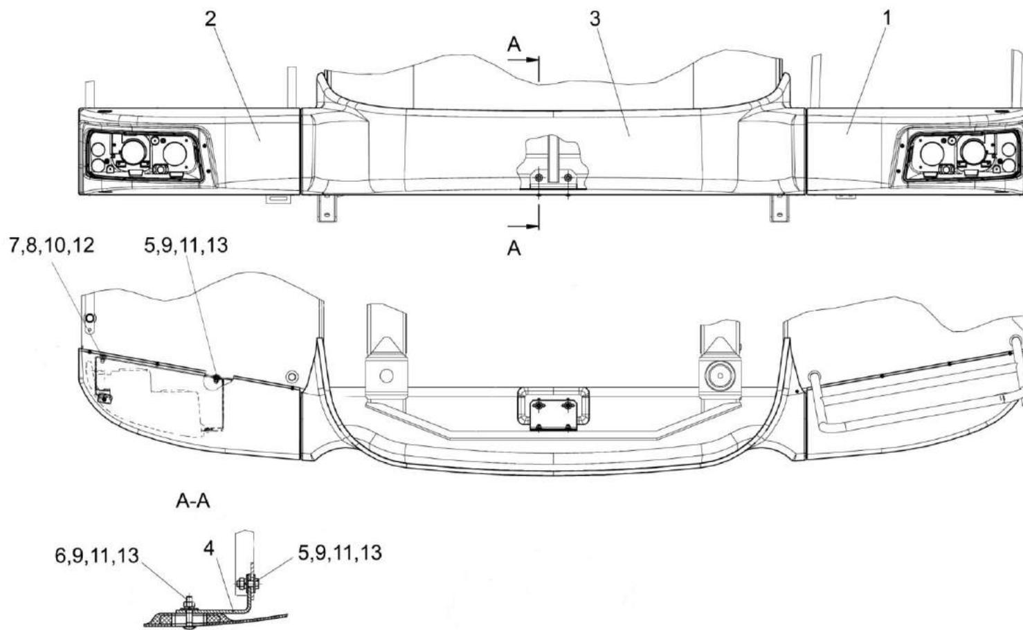
Рисунок 239 – Установка бампера КЗК-8-3-0132000
