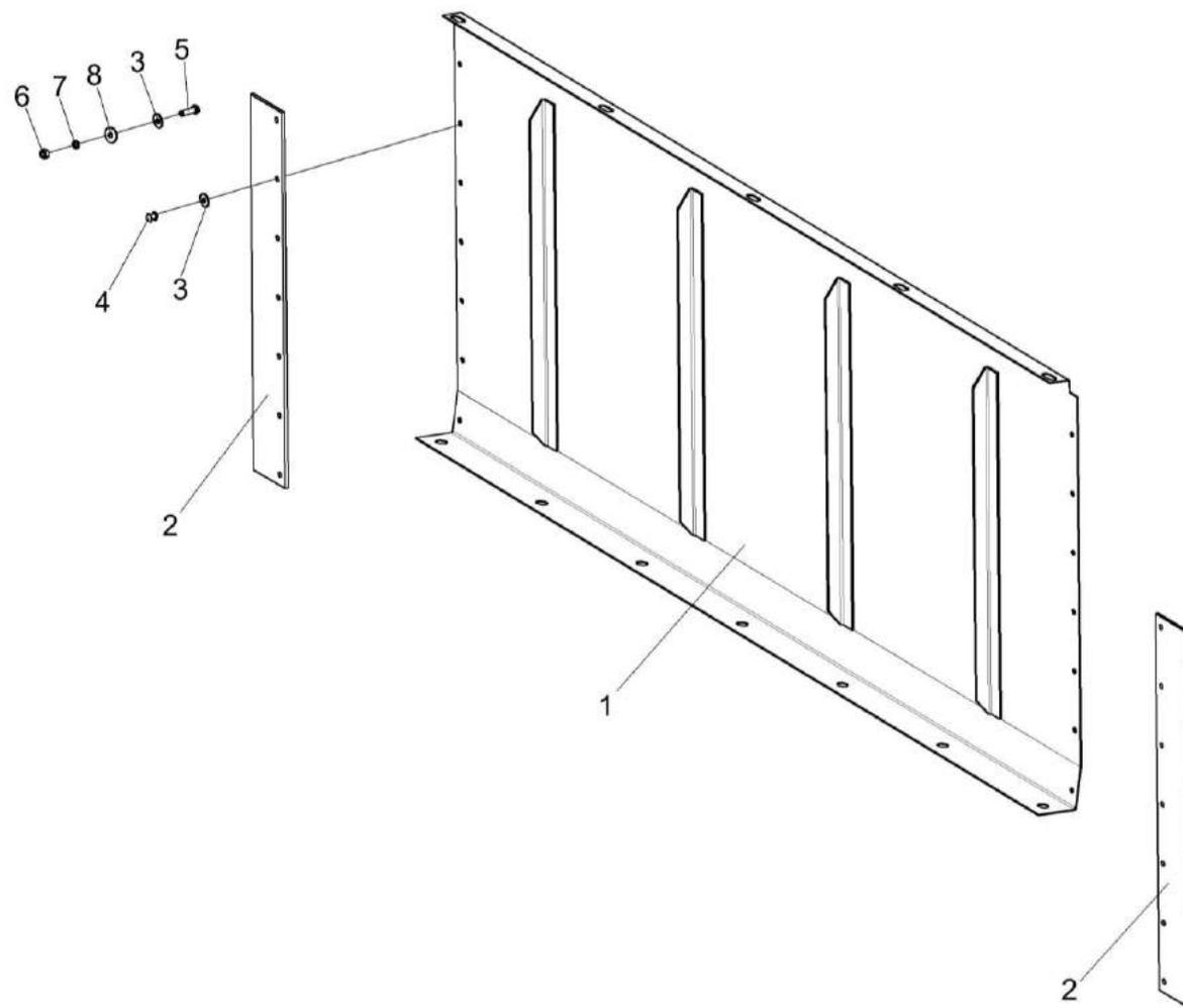
Рисунок 148 – Стенки КЗК 0290290А и КЗК 0290290А-01
