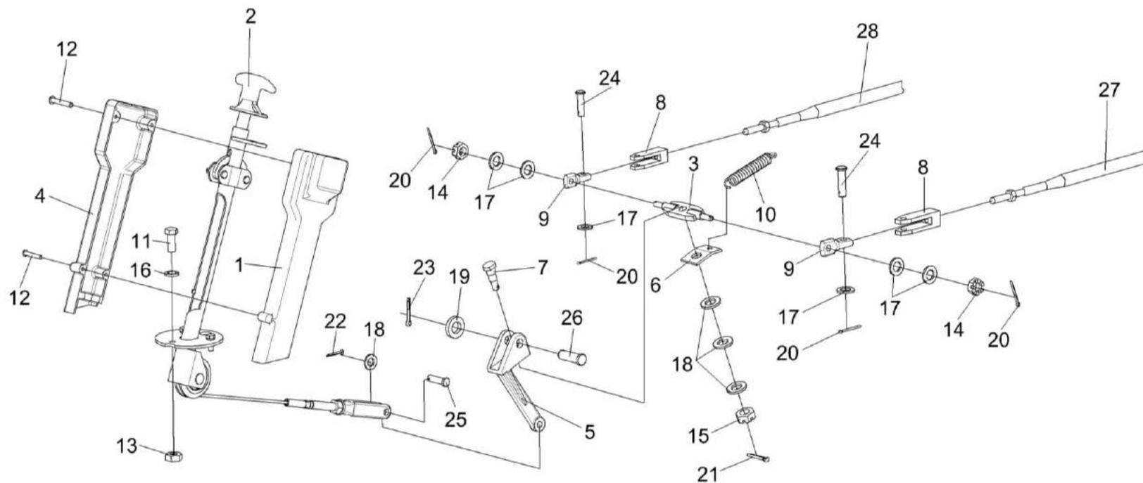
Рисунок 221 – Установка колонки привода УЭС 0300710
