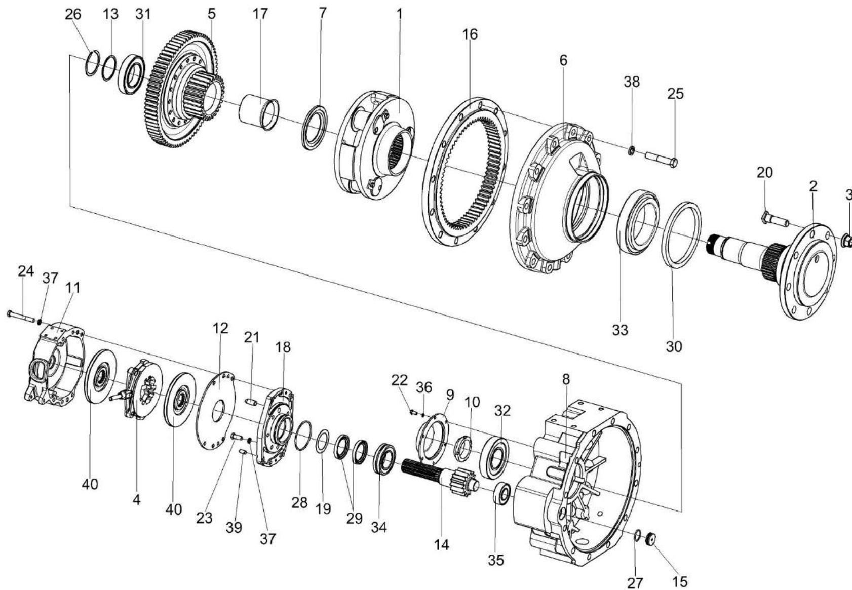
Рисунок 82 – Редуктор бортовой КЗК-10-0107200-04 (лист 2)
