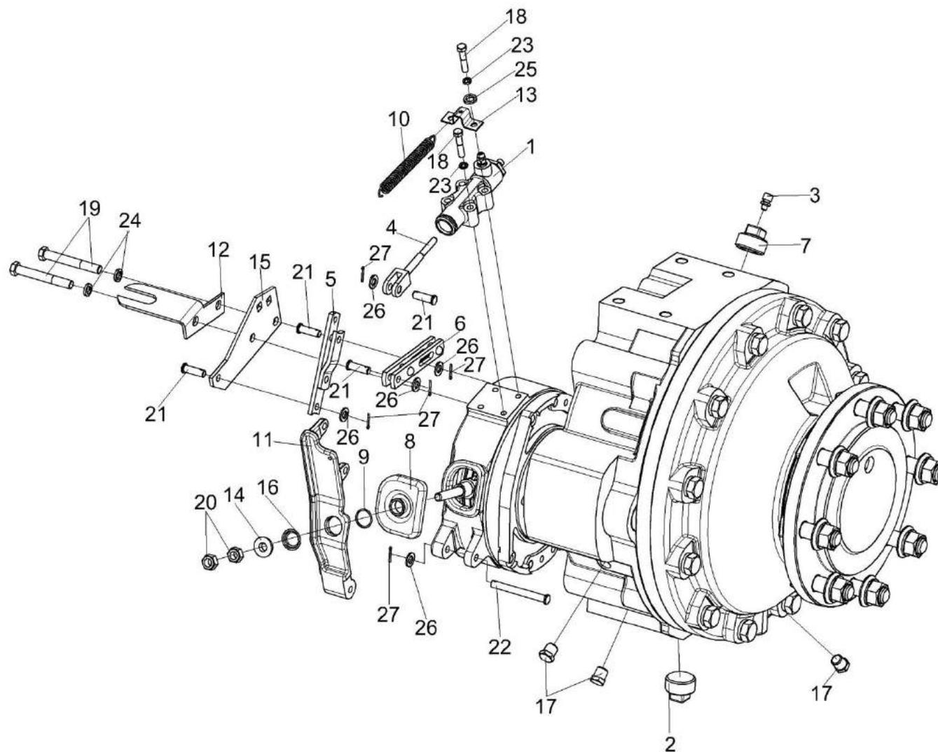
Рисунок 81 – Редуктор бортовой КЗК-10-0107200-04 (лист 1)
