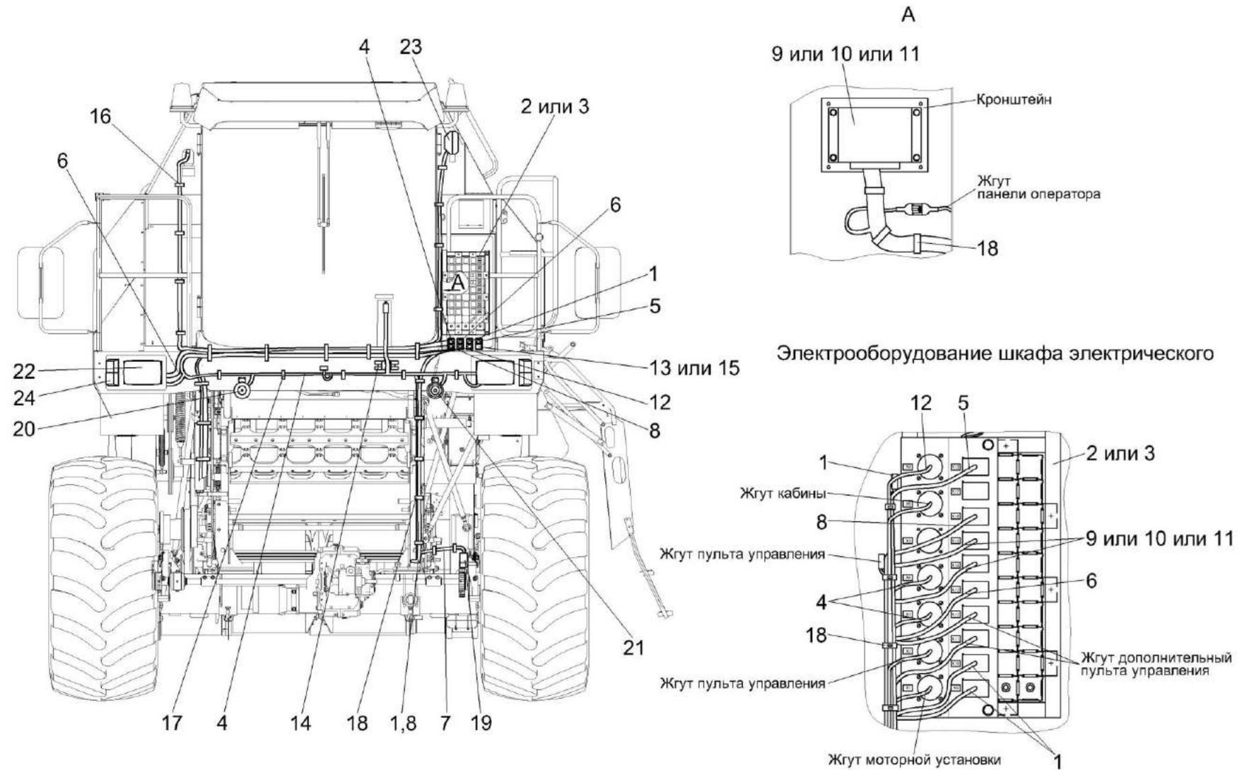
Рисунок 7 – Установка электрооборудования молотилки КЗК-8А-10-1-0721000 (вид спереди)
