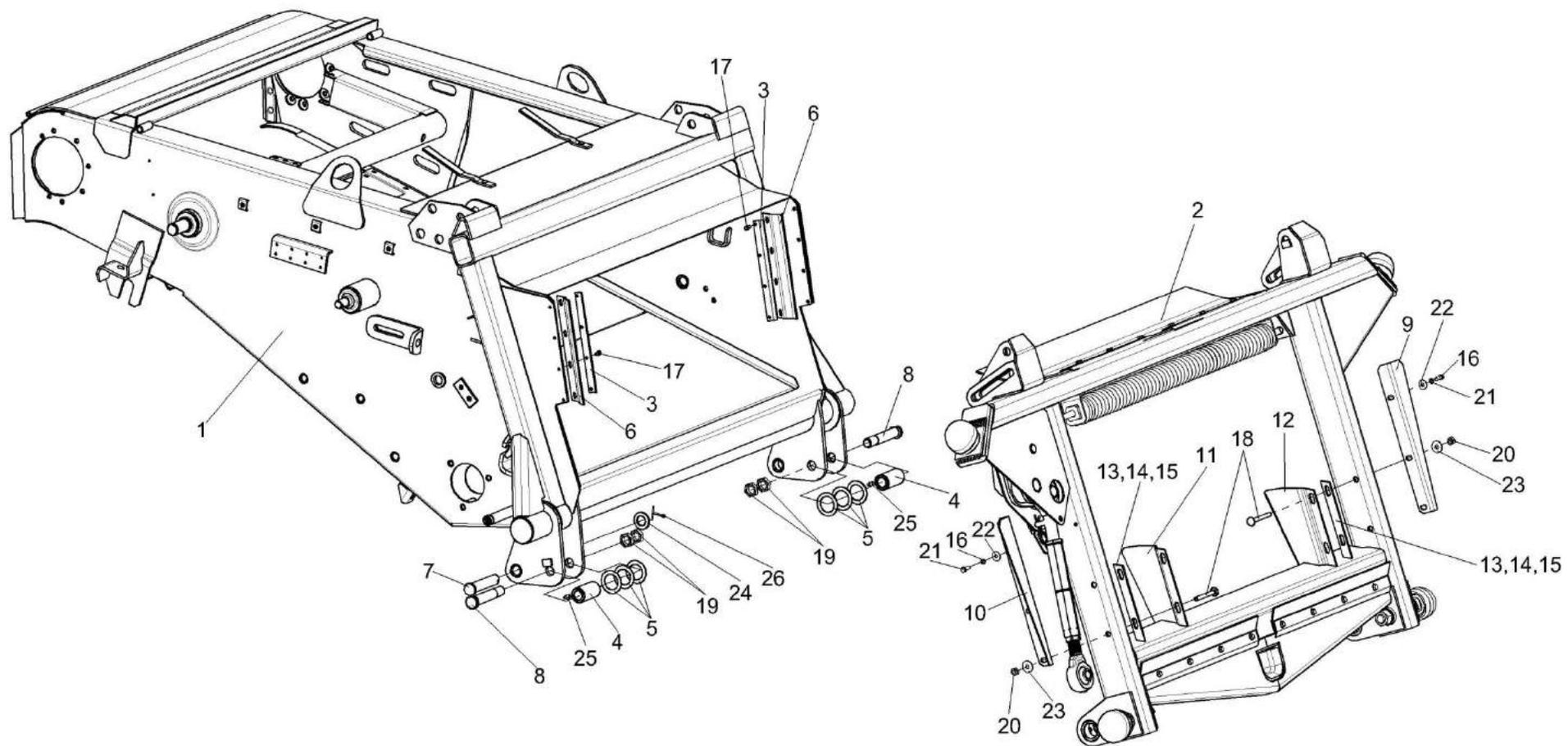
Рисунок 20 – Установка рамки переходной КЗК 1780000А
