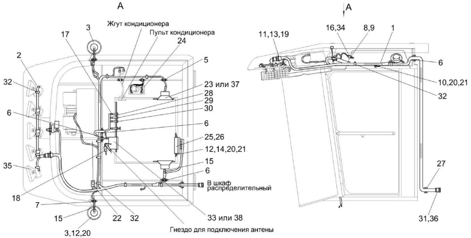
Рисунок 193 – Электрооборудование кабины
