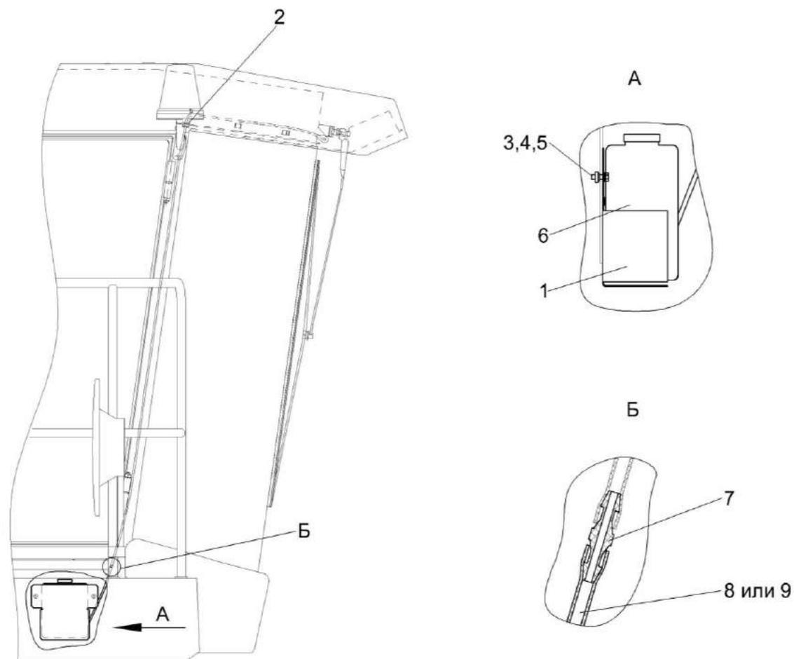
Рисунок 199 – Установка стеклоомывателя КЗК-12-0120460-01
