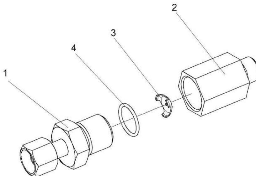
Рисунок 250 – Дроссель с обратным клапаном КЗК 0602520А-01
