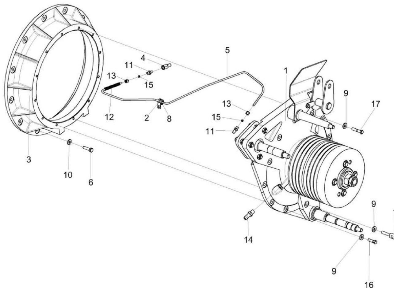
Рисунок 156 – Установка главного привода КЗК-8А-10-1-0106030
