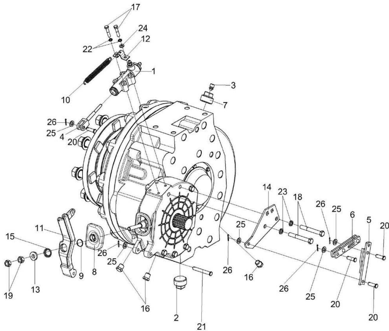
Рисунок 83 – Редуктор бортовой КЗК-10-0107200 (лист 1)
