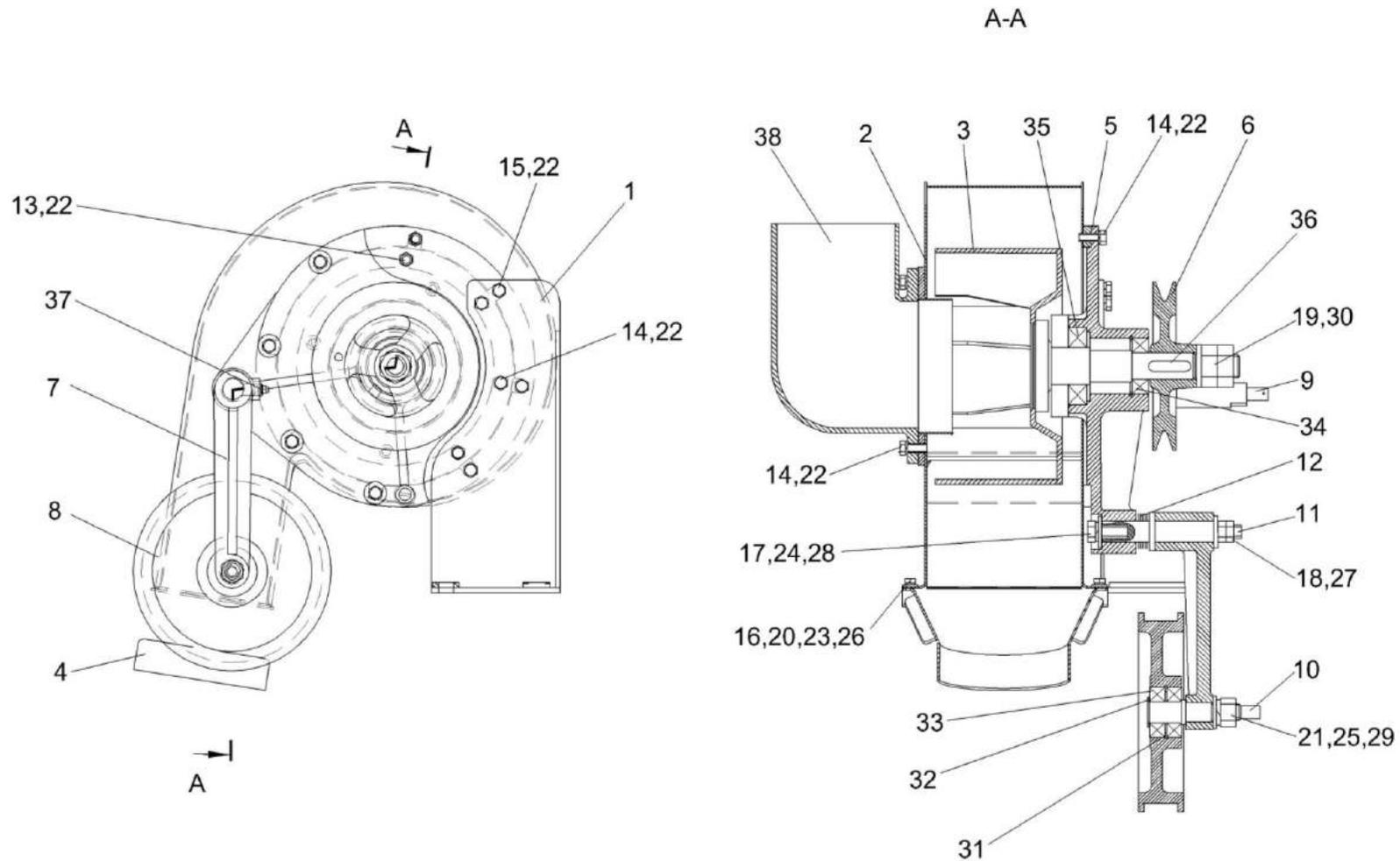
Рисунок 178 – Вентилятор КЗК-8А-0112070
