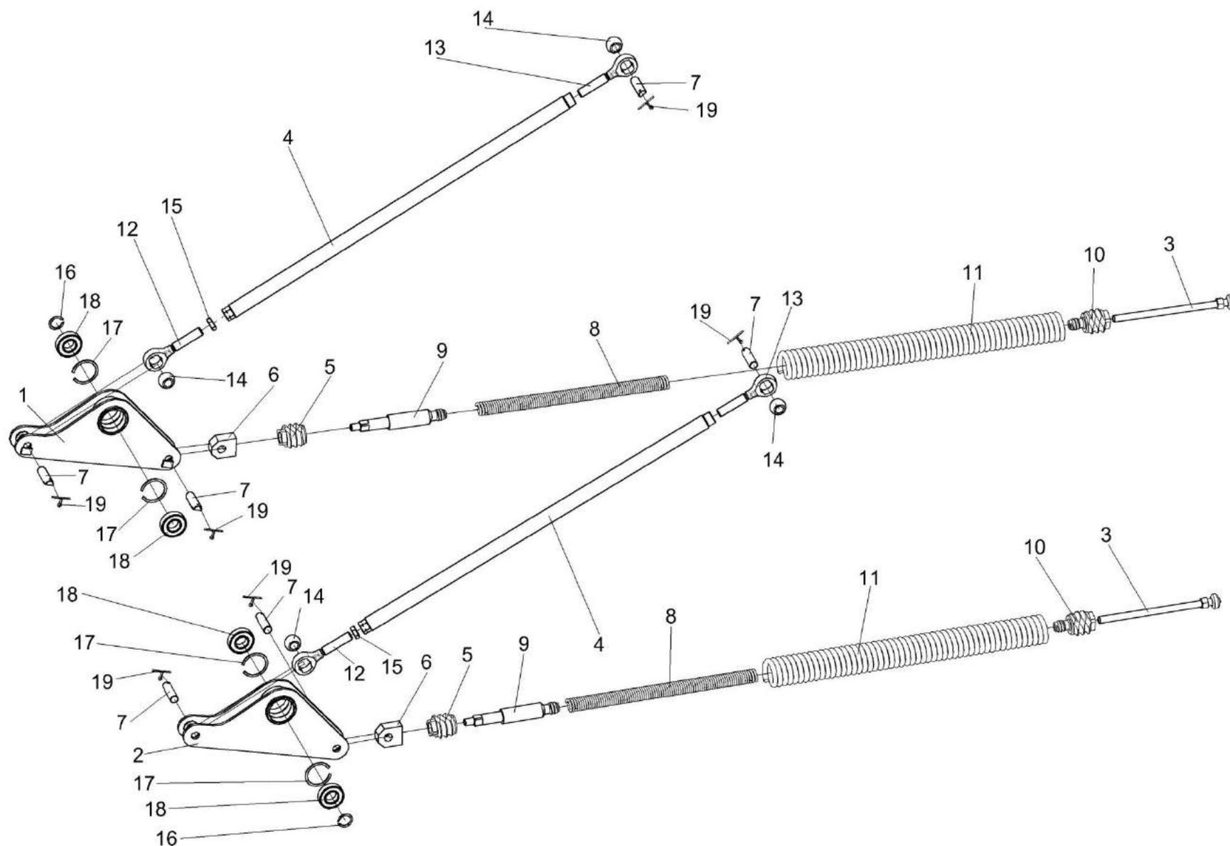
Рисунок 18 – Механизм продольного копирования КЗК 1775000А
