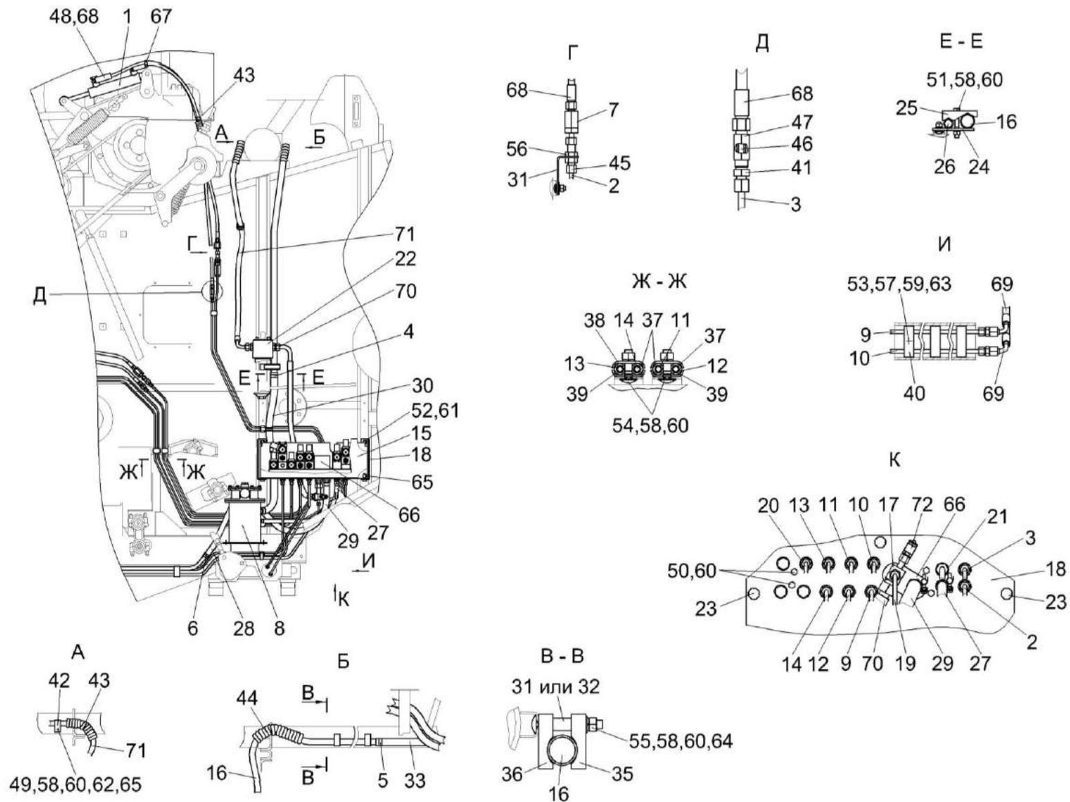
Рисунок 246 – Гидросистема рулевого управления и силовых гидроцилиндров КЗК-8А-2-0602000 (вид слева)
