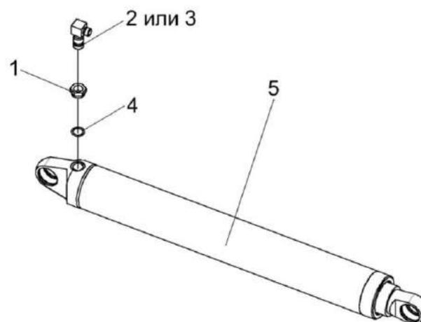
Рисунок 256 – Гидроцилиндр КЗК 0602290-01
