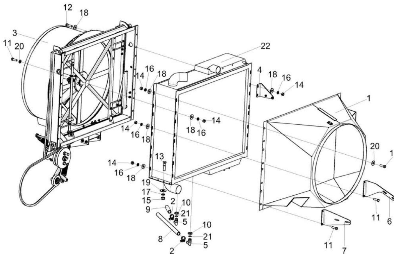
Рисунок 158 – Установка блока радиаторов КЗК-8А-10-1-0106040
