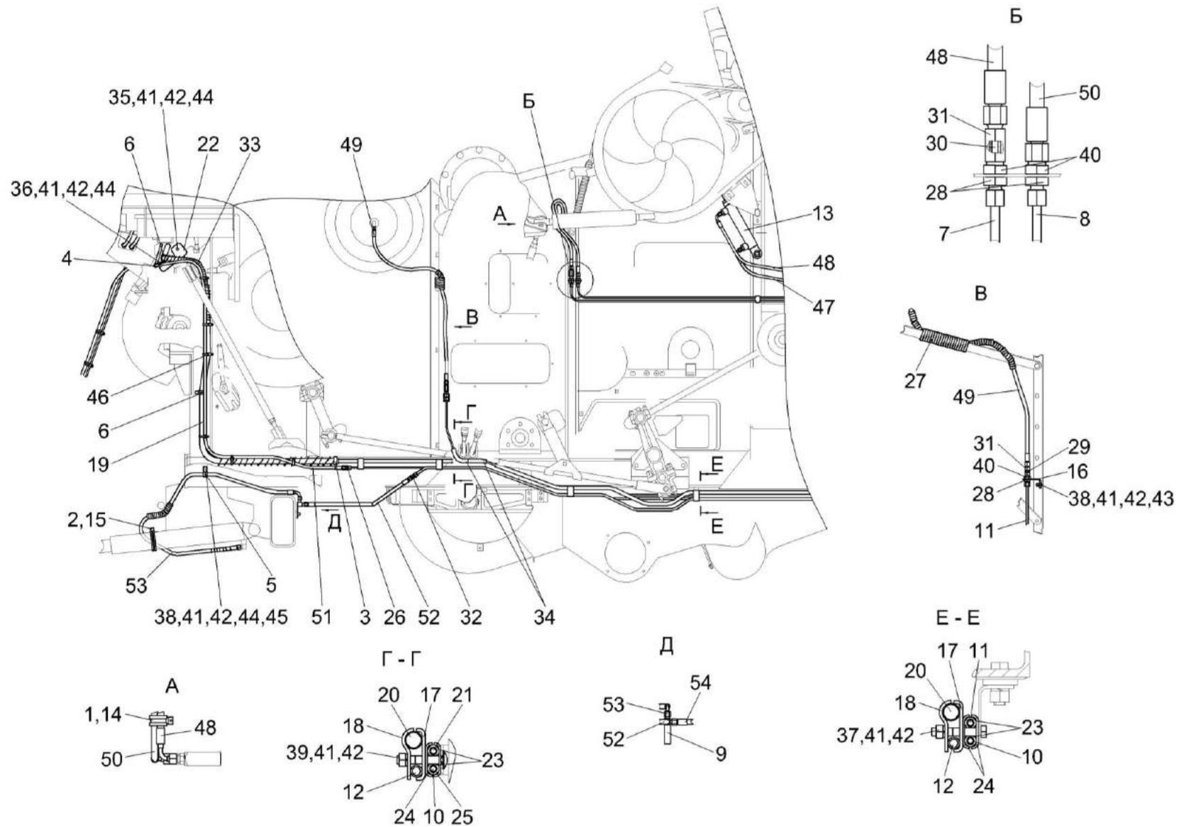
Рисунок 245 – Гидросистема рулевого управления и силовых гидроцилиндров КЗК-8А-2-0602000 (вид слева)
