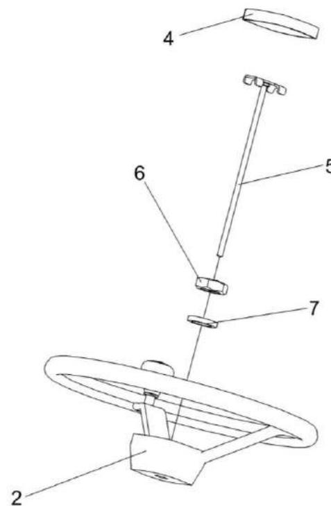
Рисунок 213 – Установка колеса рулевого КЗК-12-0122600 и КЗК-12-0122600-01
