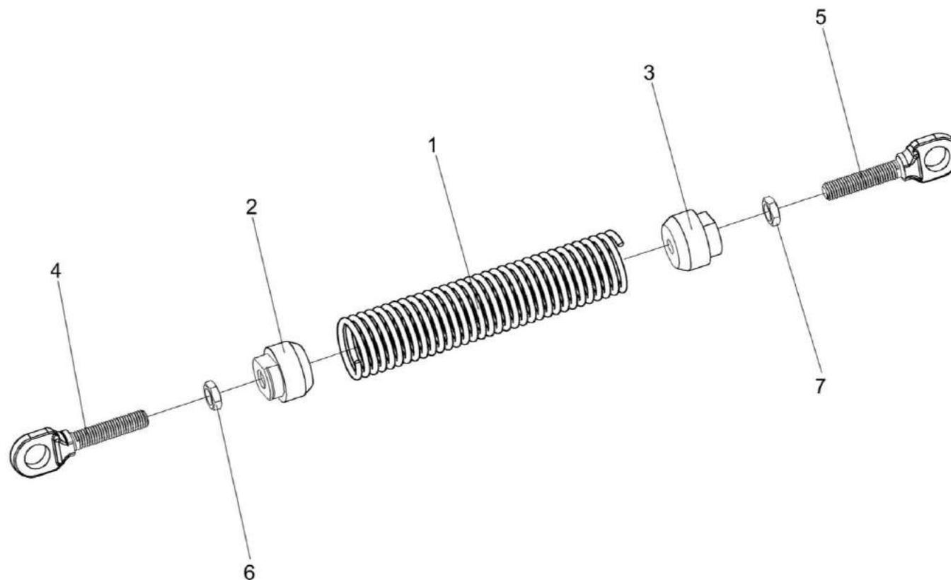
Рисунок 165 – Пружины КЗС 0131210 и КЗС 0131210-01
