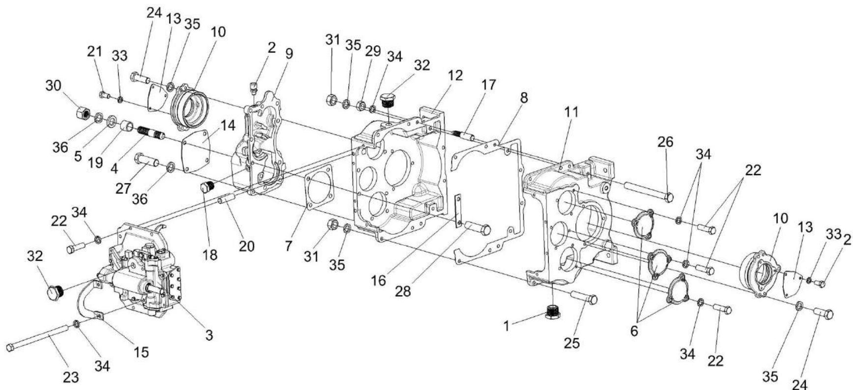
Рисунок 90 – Коробка диапазонов 3518020-46150 (корпус, крышки)
