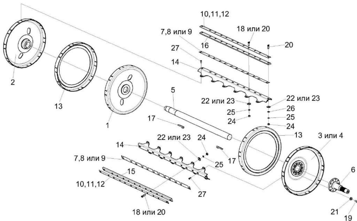
Рисунок 65 – Барабан молотильный КЗК-8А-0104000
