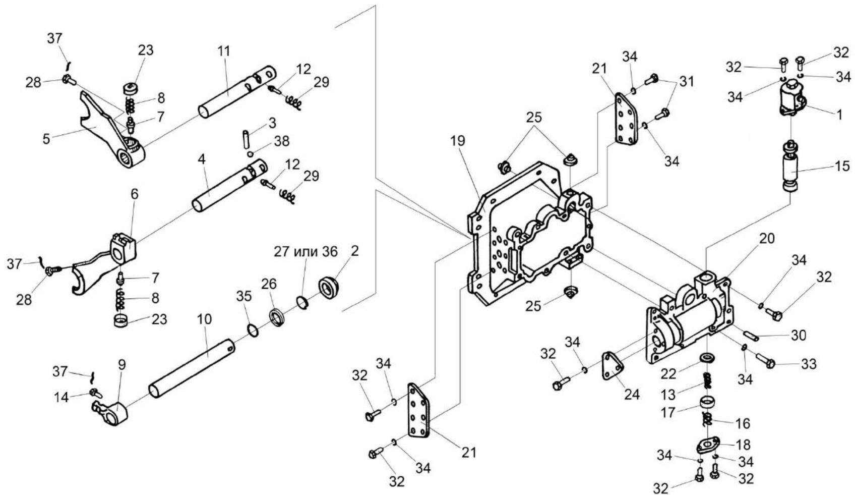
Рисунок 93 – Механизм переключения диапазонов 3518020-46160
