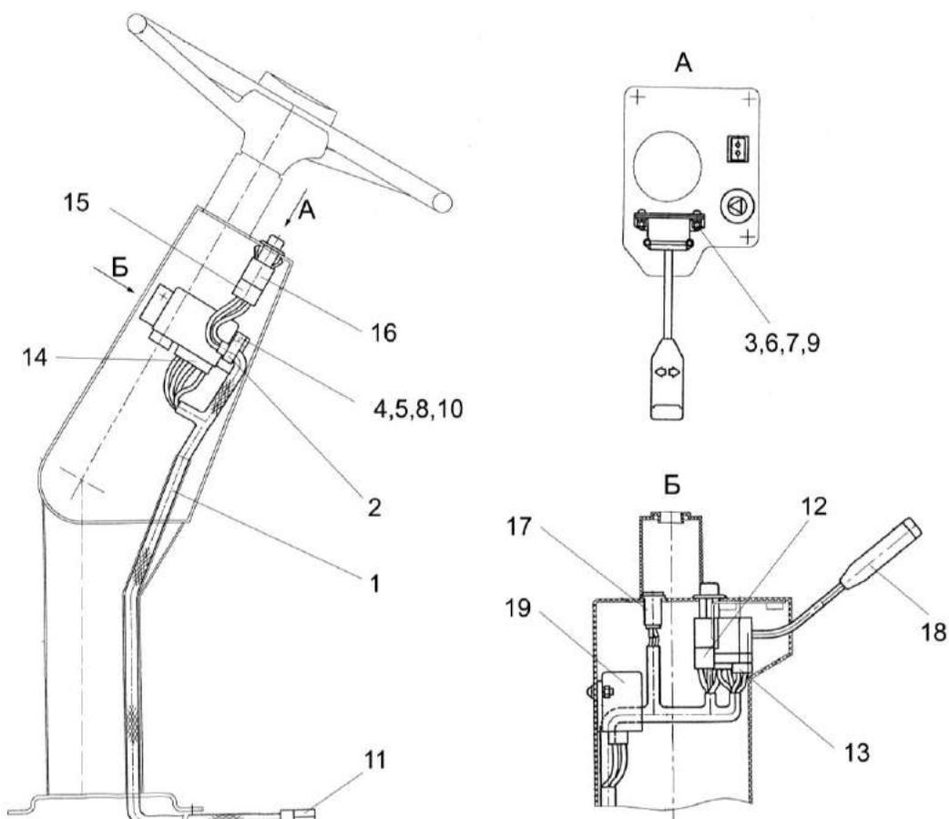
Рисунок 220 – Электрооборудование рулевой колонки КЗС 0119030-01
