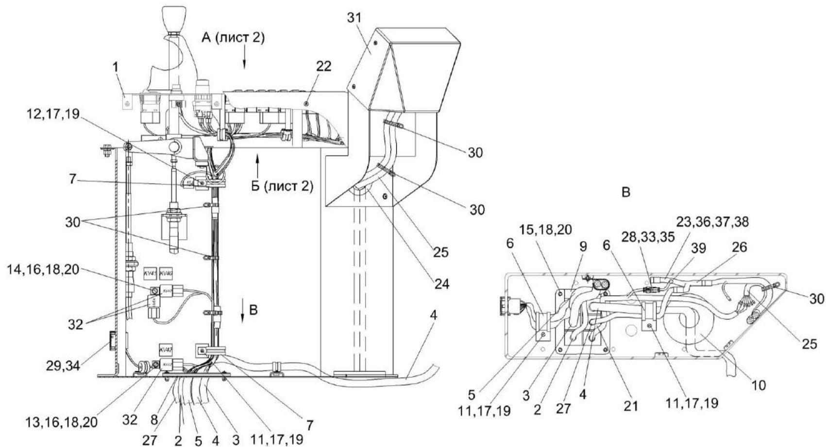
Рисунок 203 – Установка электрооборудования пульта управления КЗК-8А-10-1-0725000 (лист 1)
