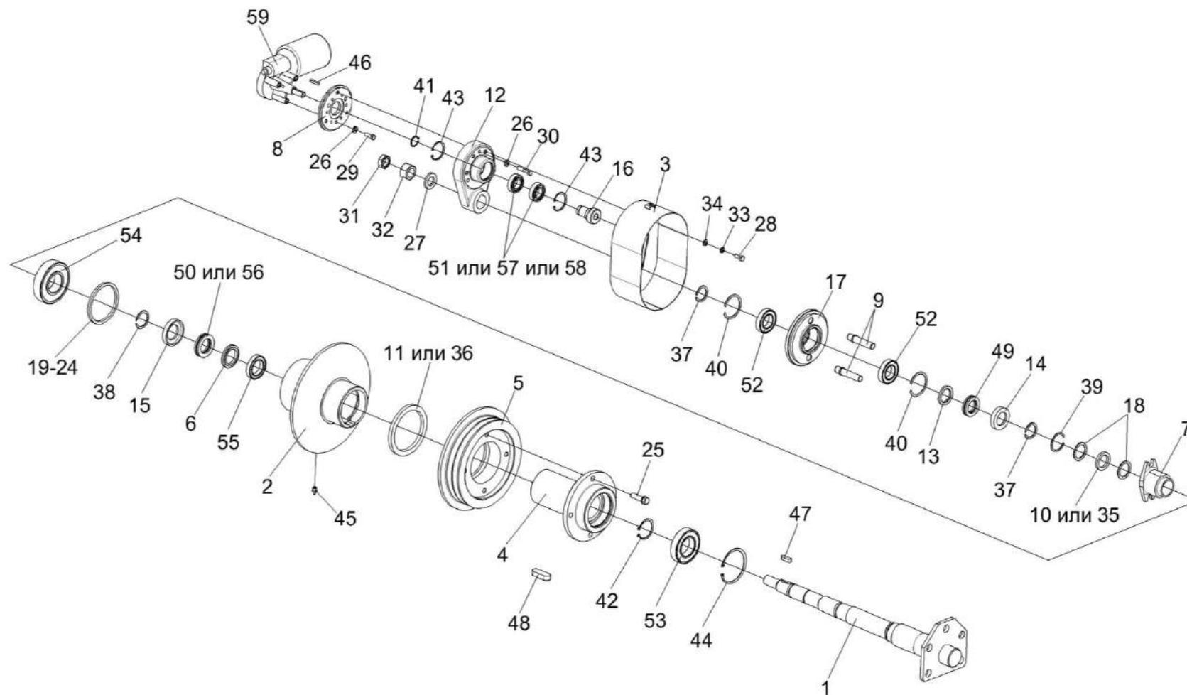
Рисунок 58 – Контрпривод вариатора КЗК-7-0202500Б
