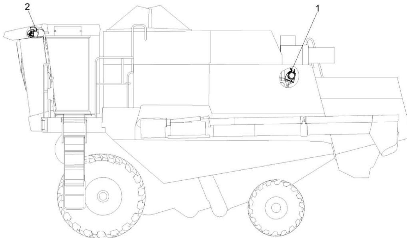
Рисунок 194 – Установка климатическая КЗК-7-0113000А-03
