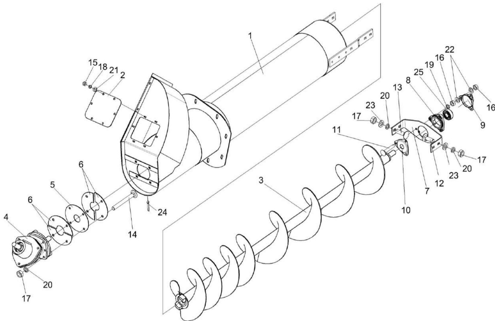
Рисунок 119 – Шнек загрузной зерновой КЗК 0216000А
