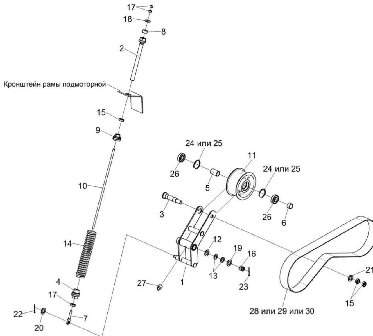
Рисунок 172 – Привод гидронасоса КЗК-8А-2-0222500
