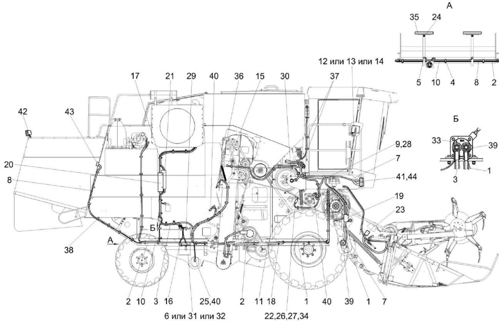
Рисунок 5 – Установка электрооборудования молотилки КЗК-8А-10-1-0721000 (вид справа)
