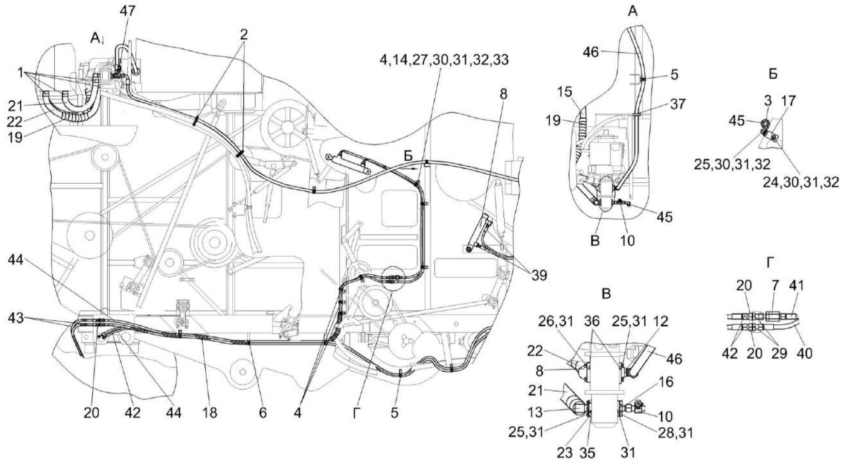
Рисунок 247 – Гидросистема рулевого управления и силовых гидроцилиндров КЗК-8А-2-0602000 (вид справа)
