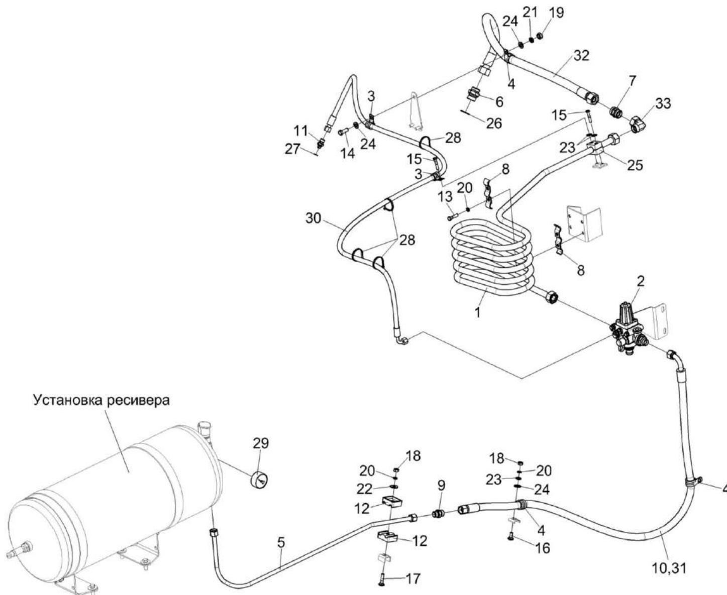
Рисунок 259 – Пневмосистема КЗК-8А-10-1-0800000
