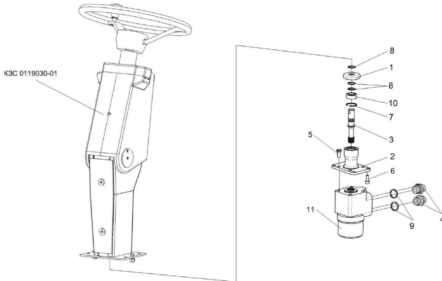
Рисунок 219 – Установка насоса-дозатора КЗК-8-0602160
