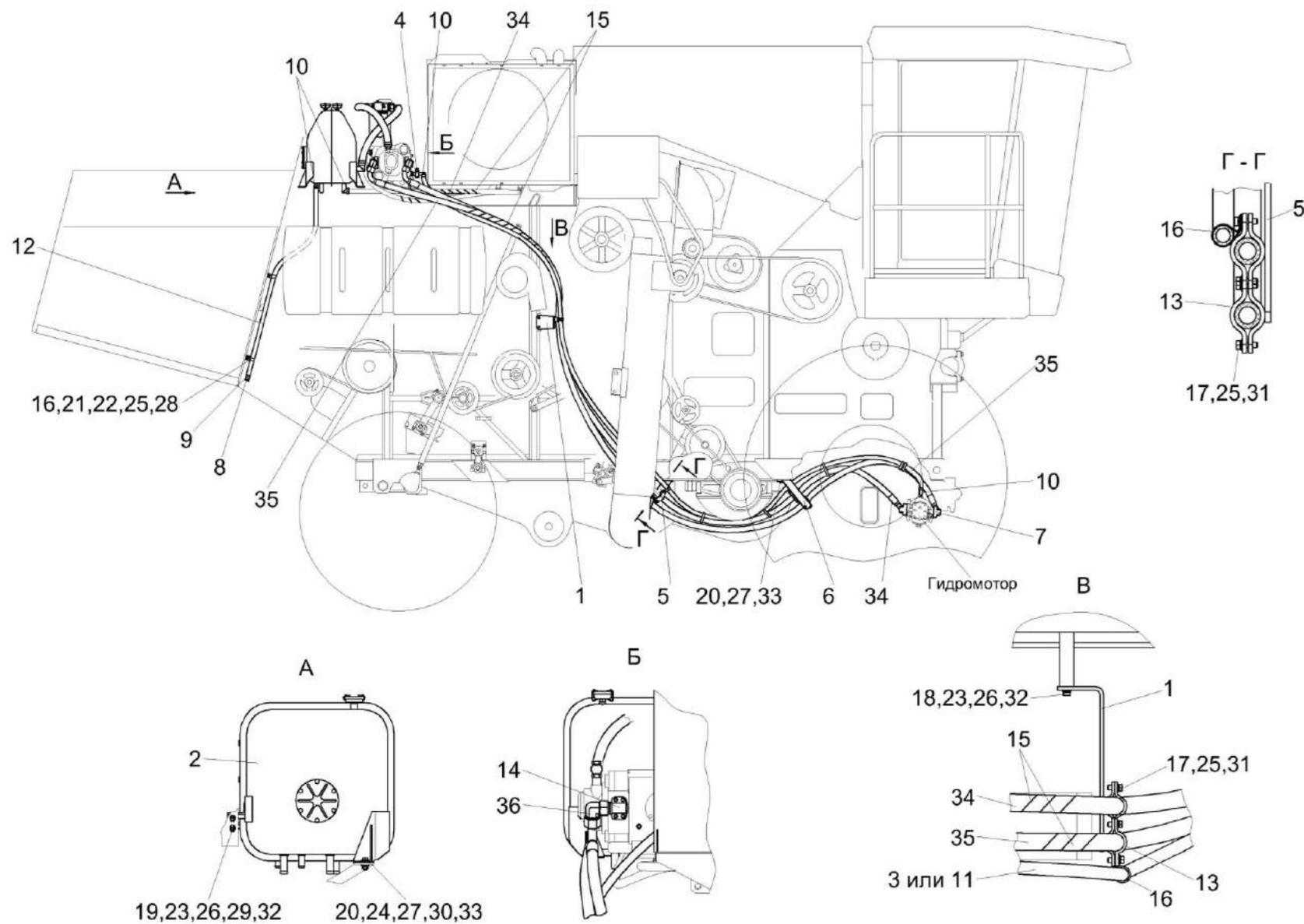
Рисунок 240 – Гидросистема привода ходовой части КЗК-8А-0601000 (лист 1)
