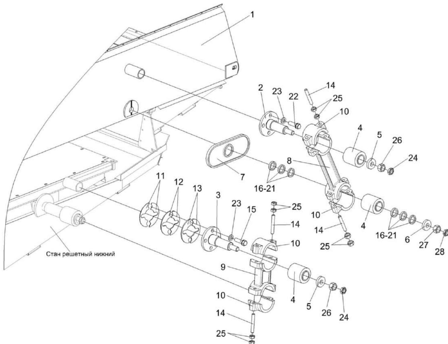
Рисунок 36 – Установка привода стана решетного верхнего КЗК 0260000Б-01
