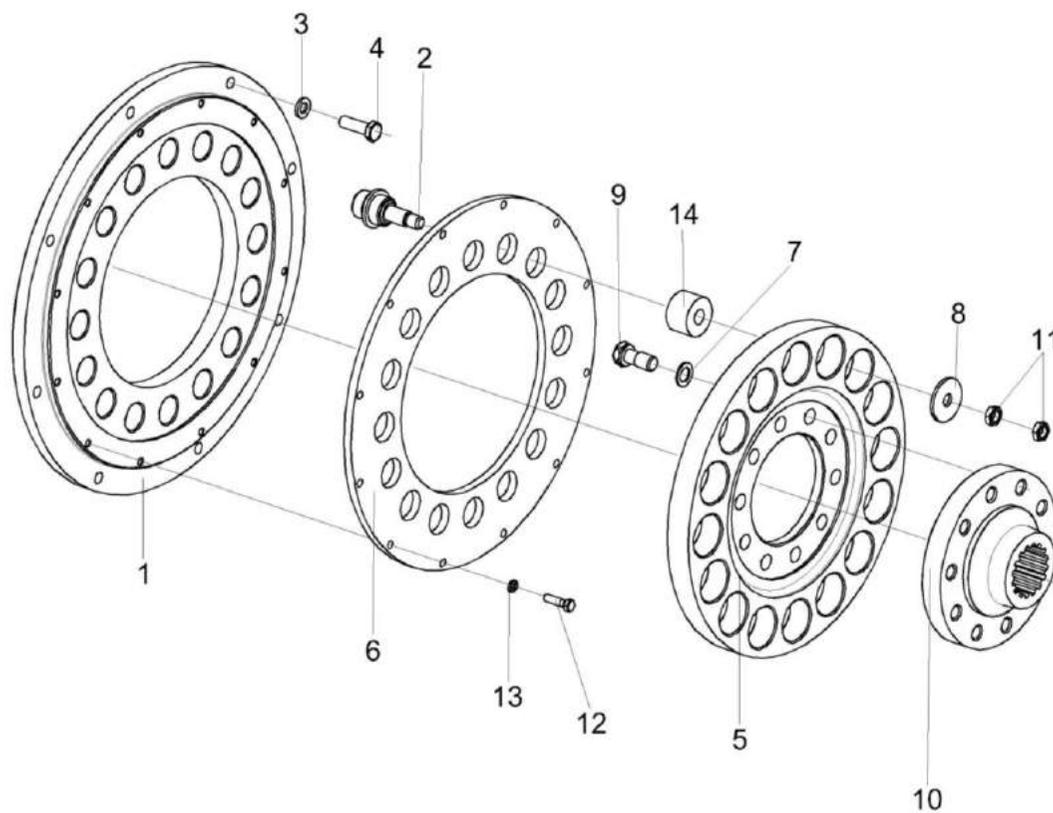
Рисунок 155 – Установка муфты КЗК-8А-10-1-0106020
