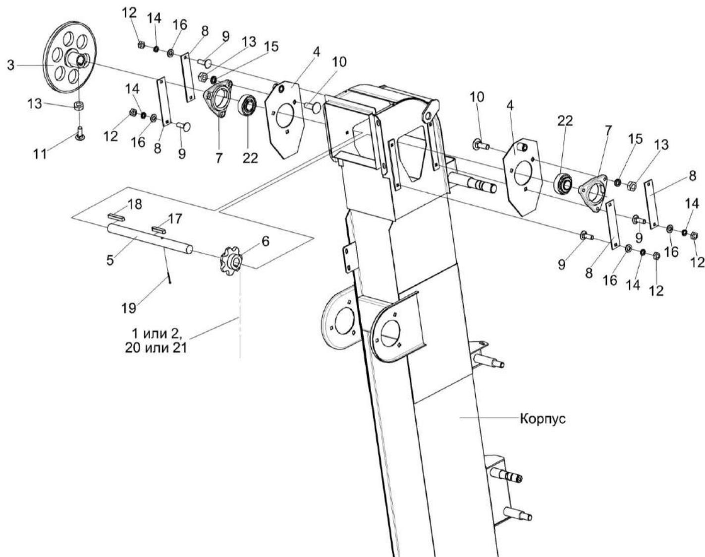
Рисунок 114 – Элеватор зерновой КЗК 0214000Б-01 (лист 3)
