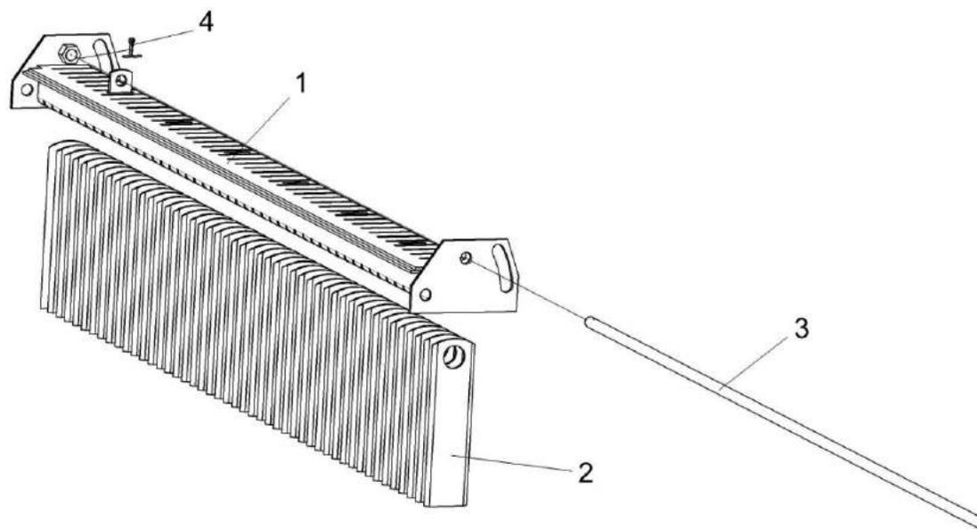
Рисунок 144 – Опора ножевая КЗК 0290030А
