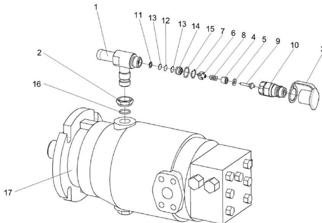
Рисунок 258 – Гидромотор КЗК-12-0601500-01
