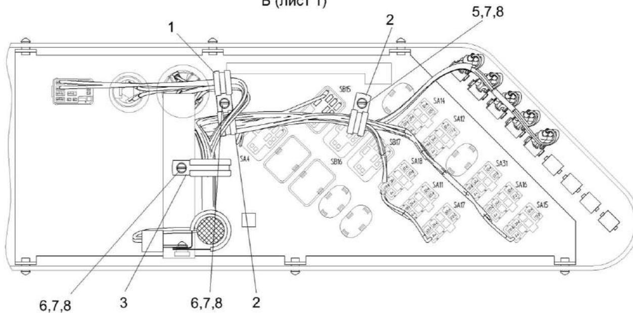
Рисунок 204 – Установка электрооборудования пульта управления КЗК-8А-10-1-0725000 (лист 2)
