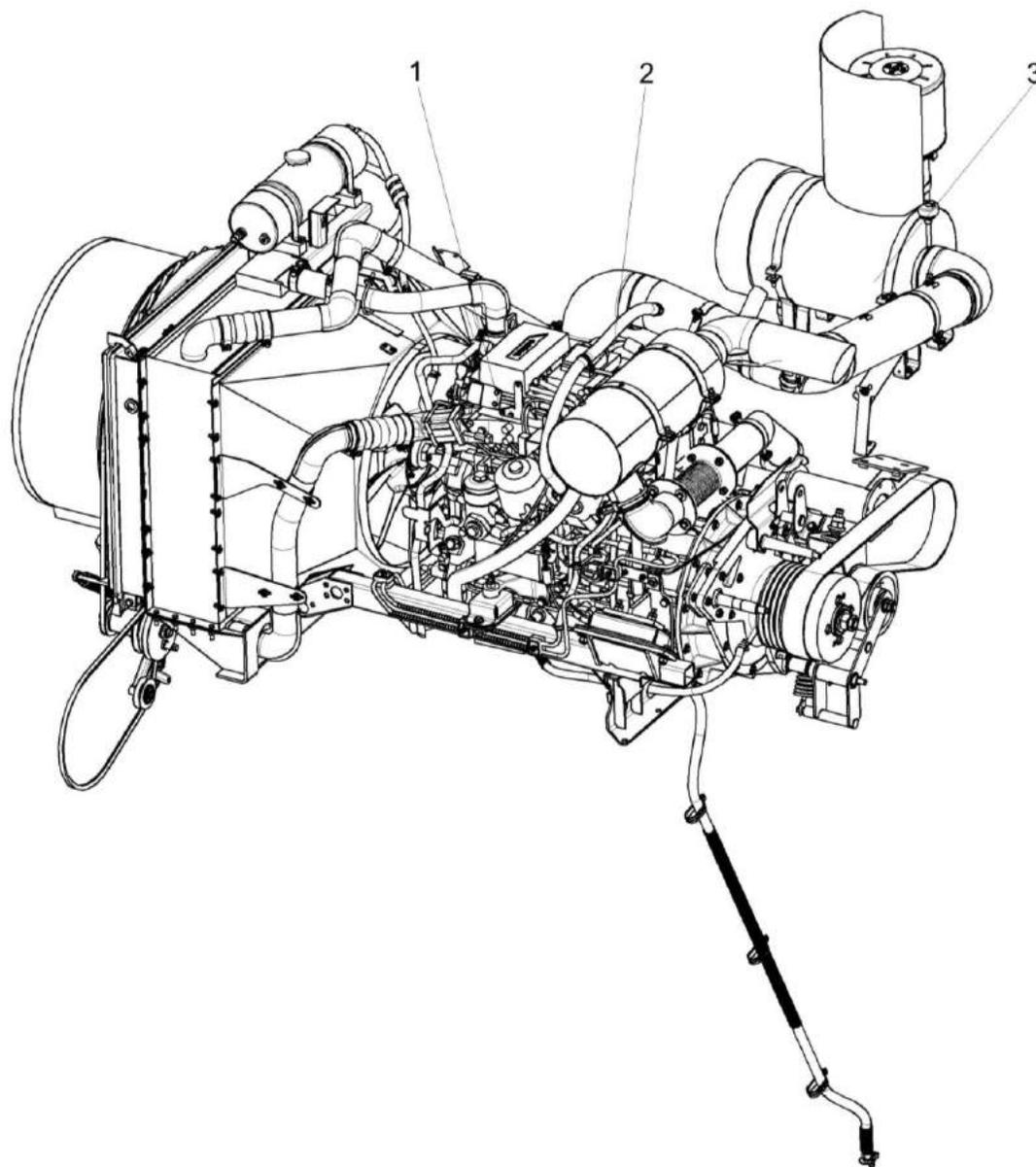
Рисунок 152 – Установка двигателя КЗК-8А-10-1-0106000
