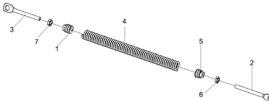
Рисунок 141 – Пружина КЗК 0202840А-03
