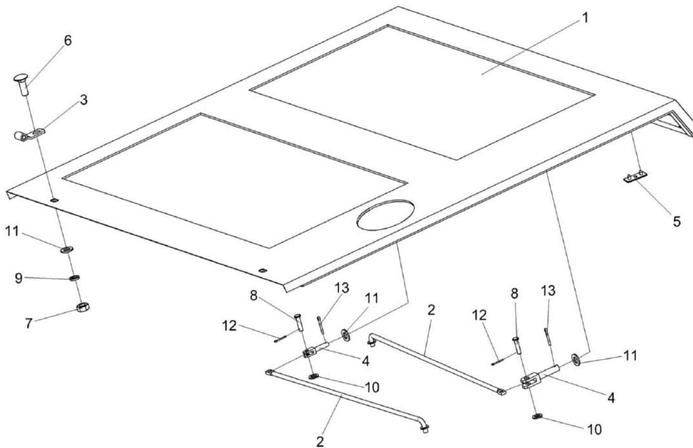
Рисунок 236 – Крыша КЗК-8А-2-0124000
