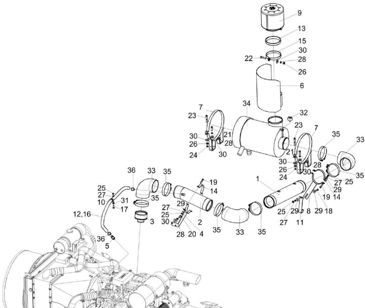
Рисунок 174 – Установка воздухоочистителя КЗК-8А-10-1-0106080
