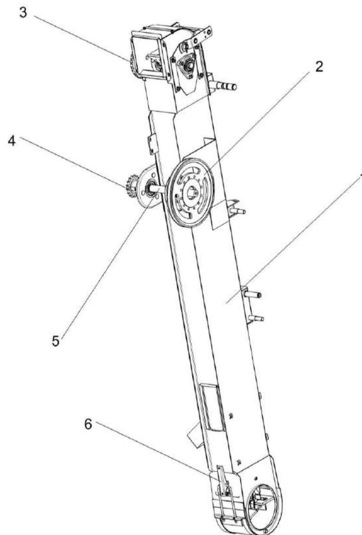
Рисунок 112 – Элеватор зерновой КЗК 0214000Б-01(лист 1)
