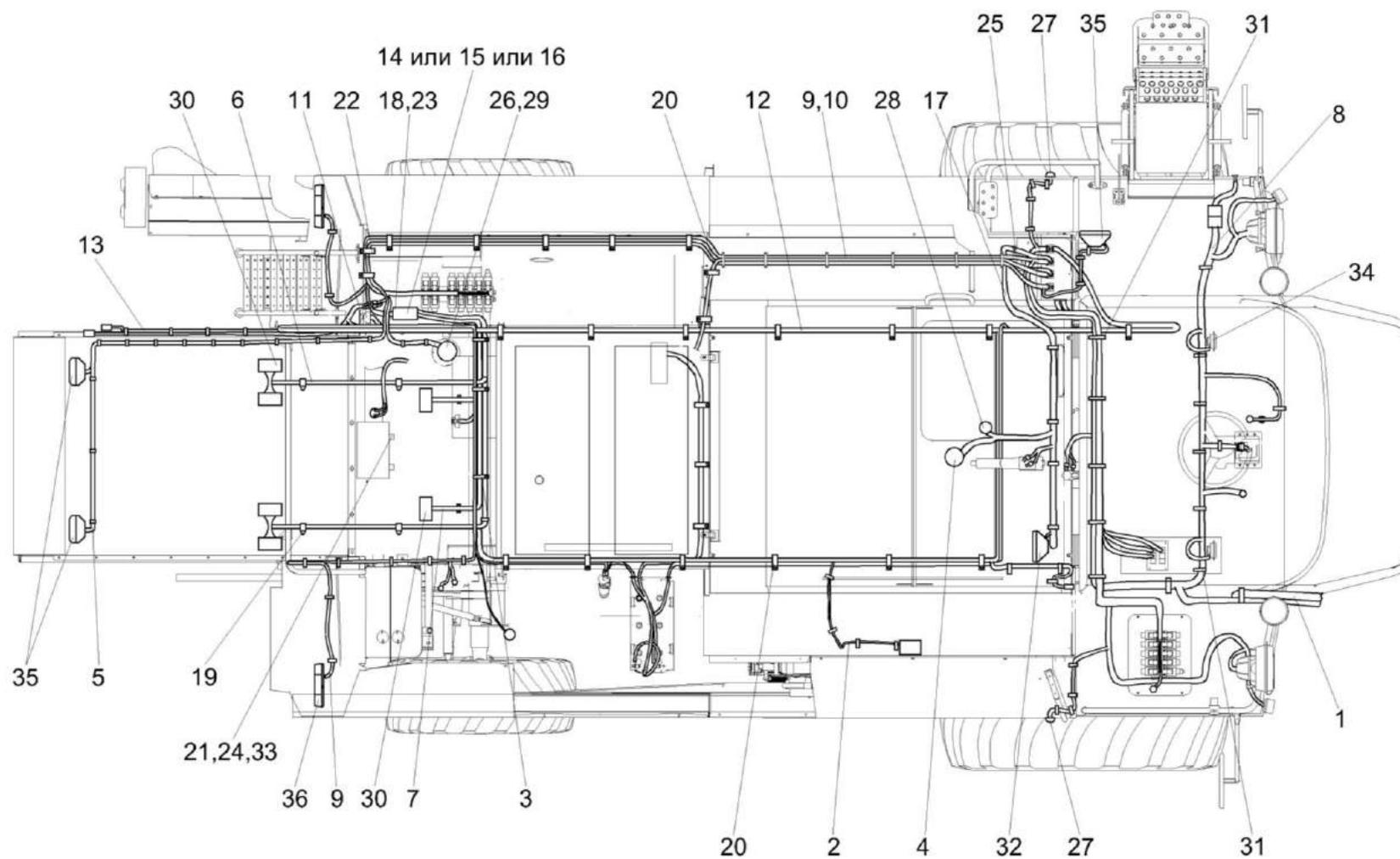
Рисунок 6 – Установка электрооборудования молотилки КЗК-8А-10-1-0721000 (вид сверху)
