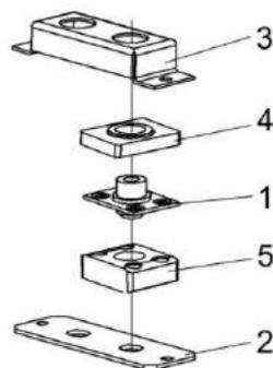
Рисунок 173 – Амортизатор КЗК-10-0106160
