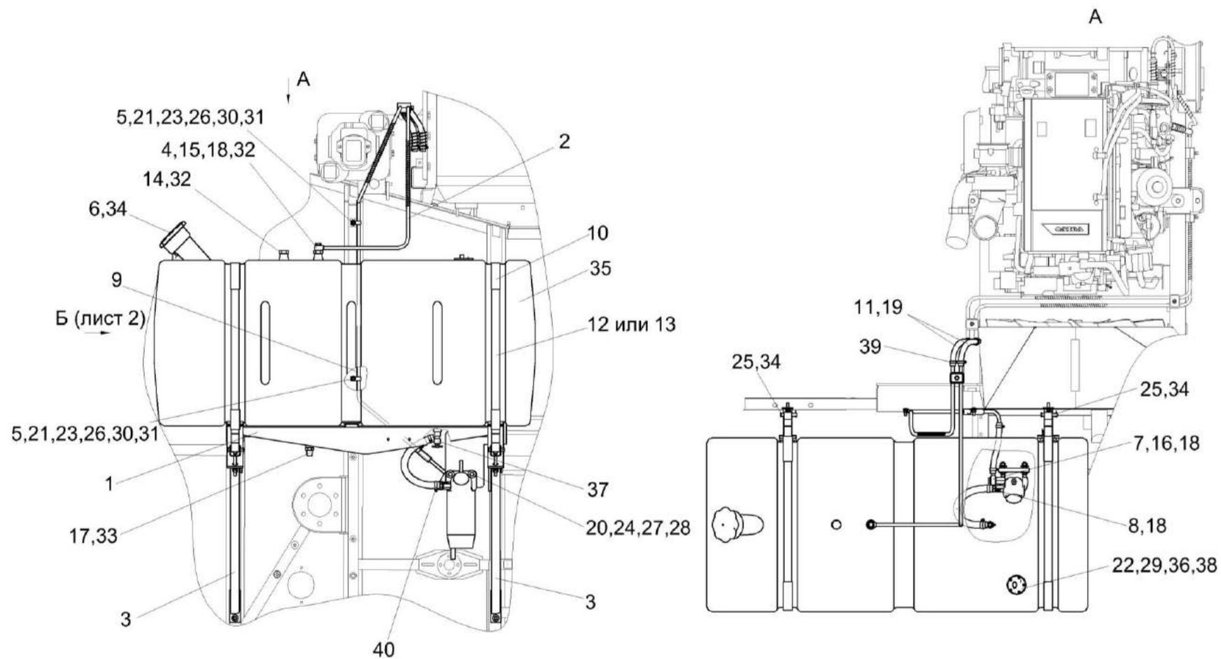
Рисунок 182 – Установка топливной системы КЗК-8А-10-1-0126000 (лист 1)
