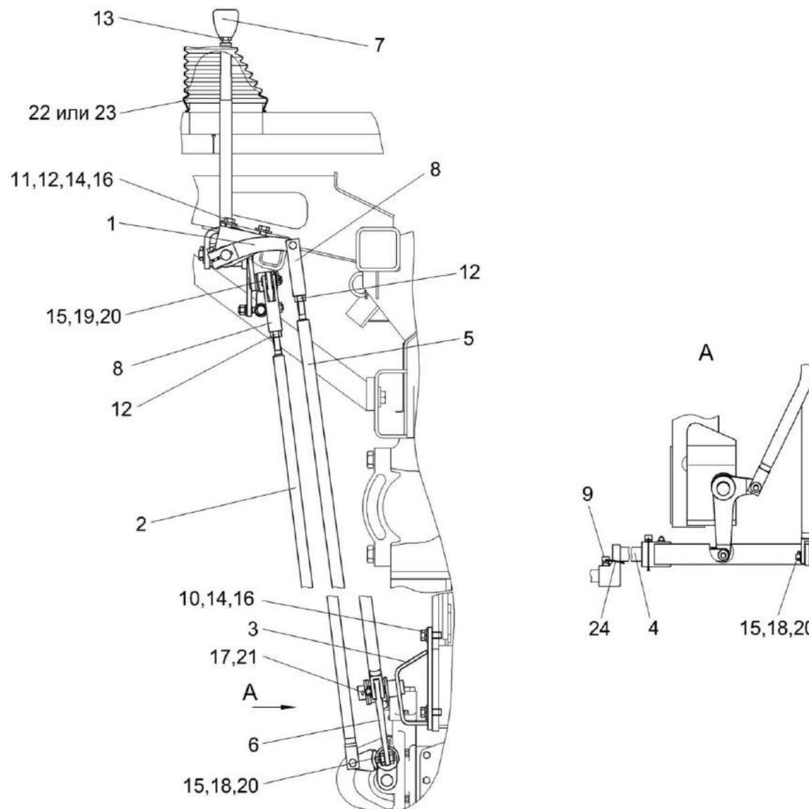
Рисунок 223 – Установка механизма управления коробкой диапазонов КЗК-8-0119040
