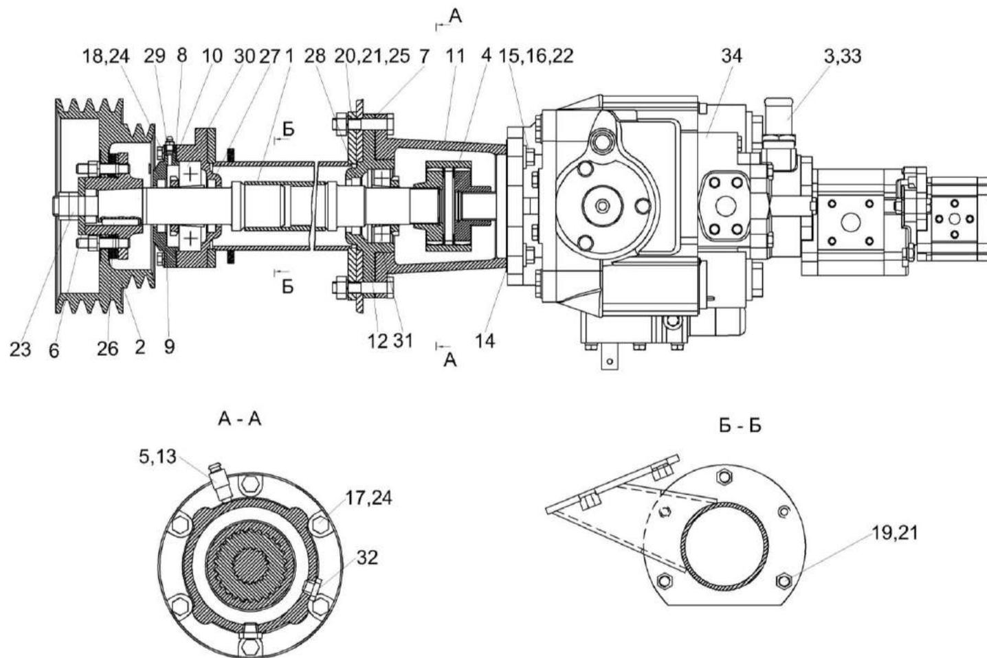
Рисунок 180 – Привод насоса ходовой части КЗК-812С-2-0222000
