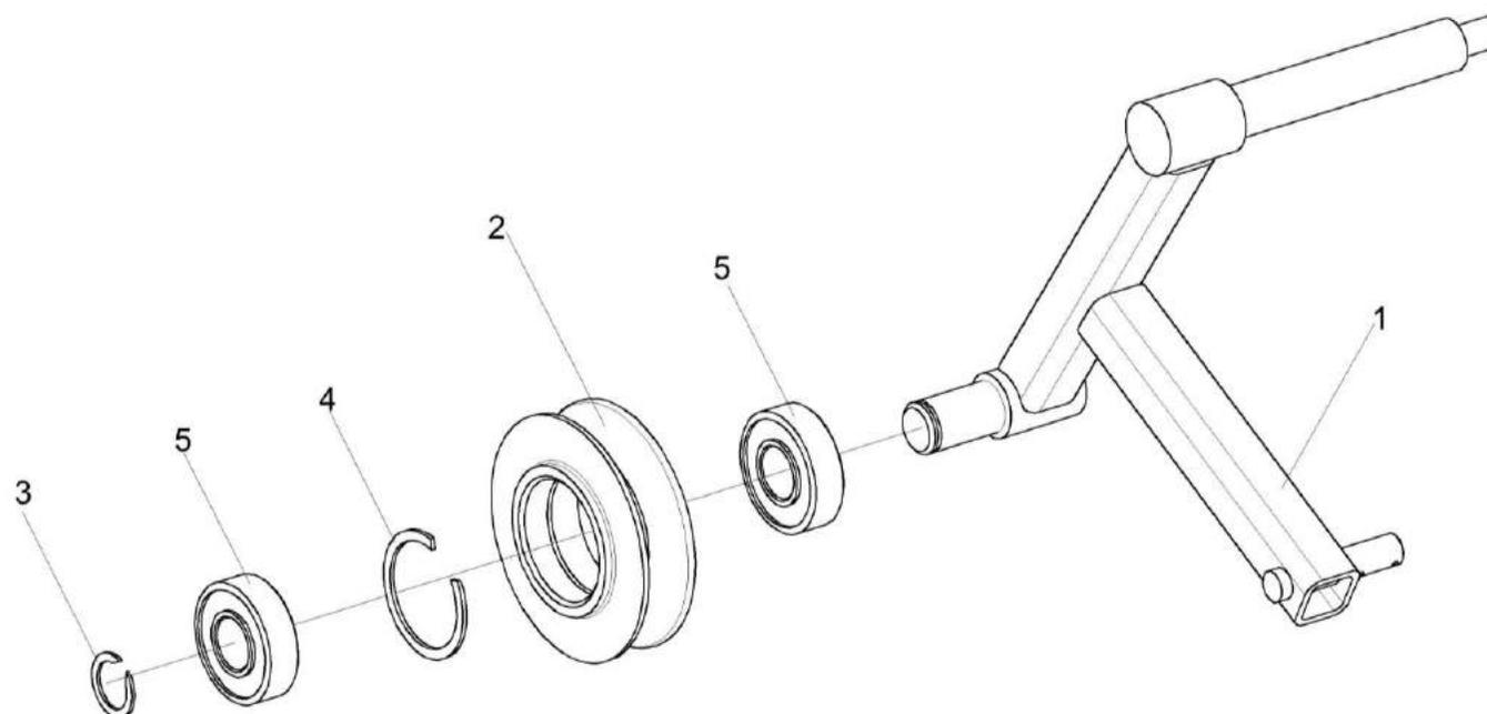
Рисунок 164 – Рычаг КЗК 0112210А
