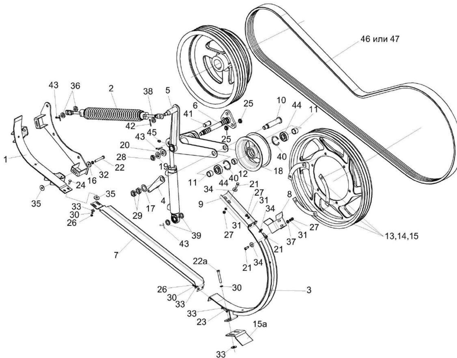
Рисунок 24 – Привод наклонной камеры КЗК 0125000
