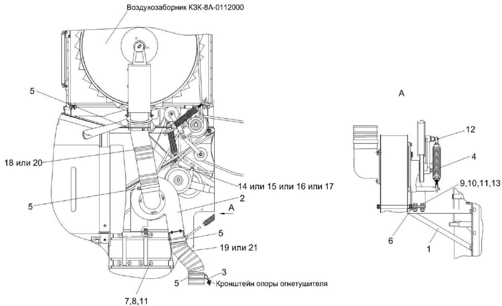
Рисунок 177 – Установка вентилятора КЗК-8А-0112100
