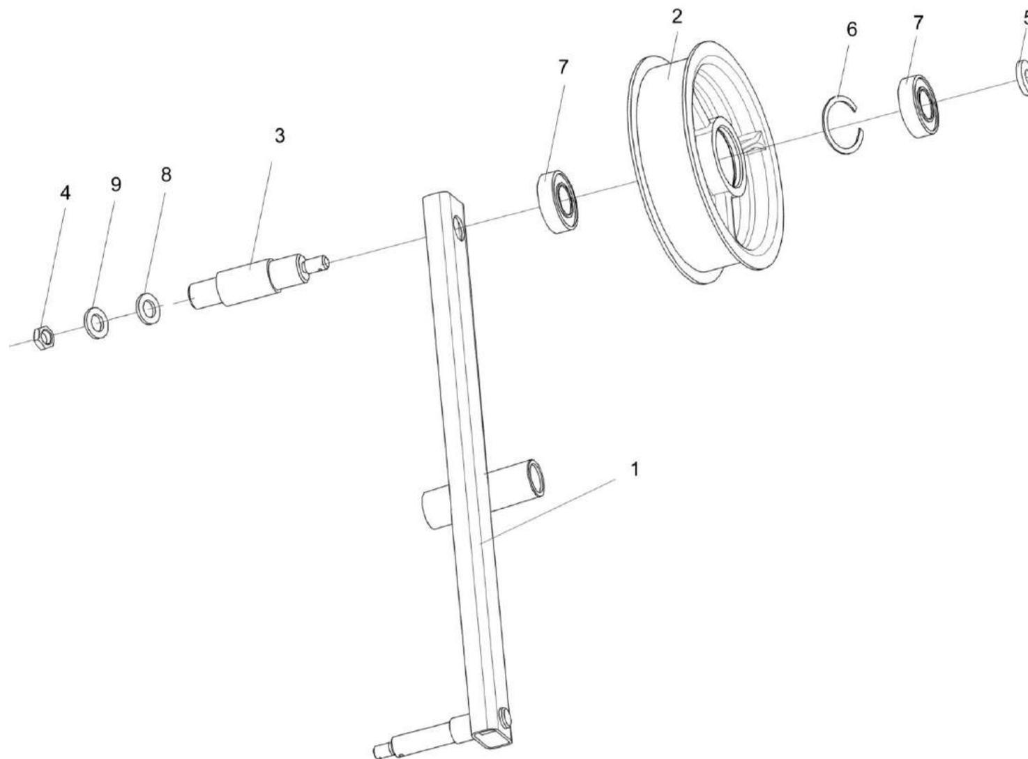
Рисунок 163 – Рычаг КЗК 0112180А
