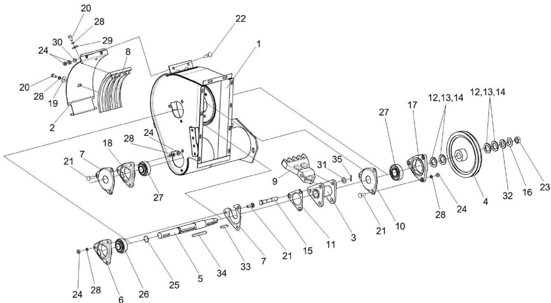
Рисунок 53 – Устройство домолачивающее КЗК 0207000В
