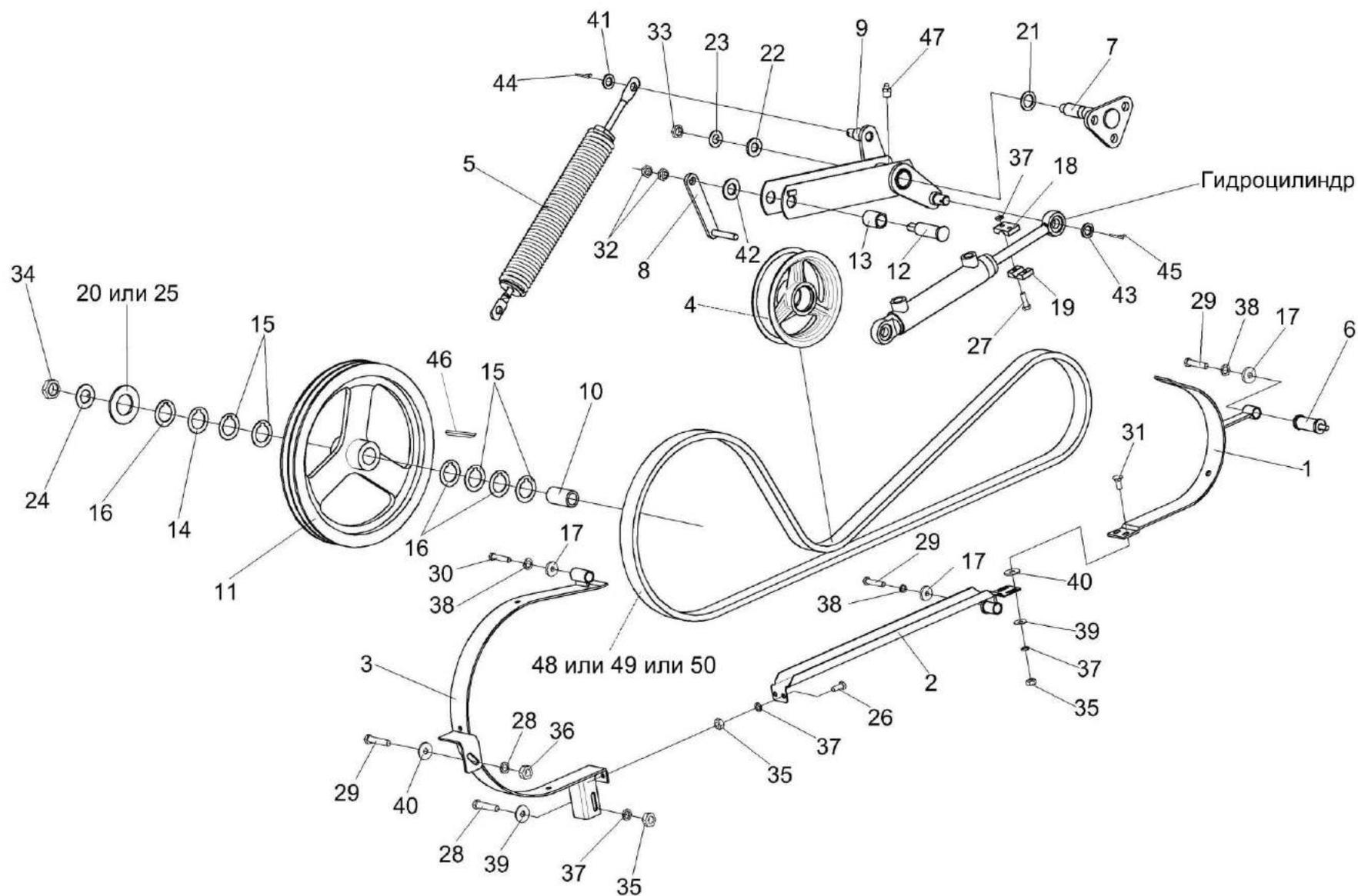
Рисунок 129 – Привод горизонтального шнека КЗК-10-0221000
