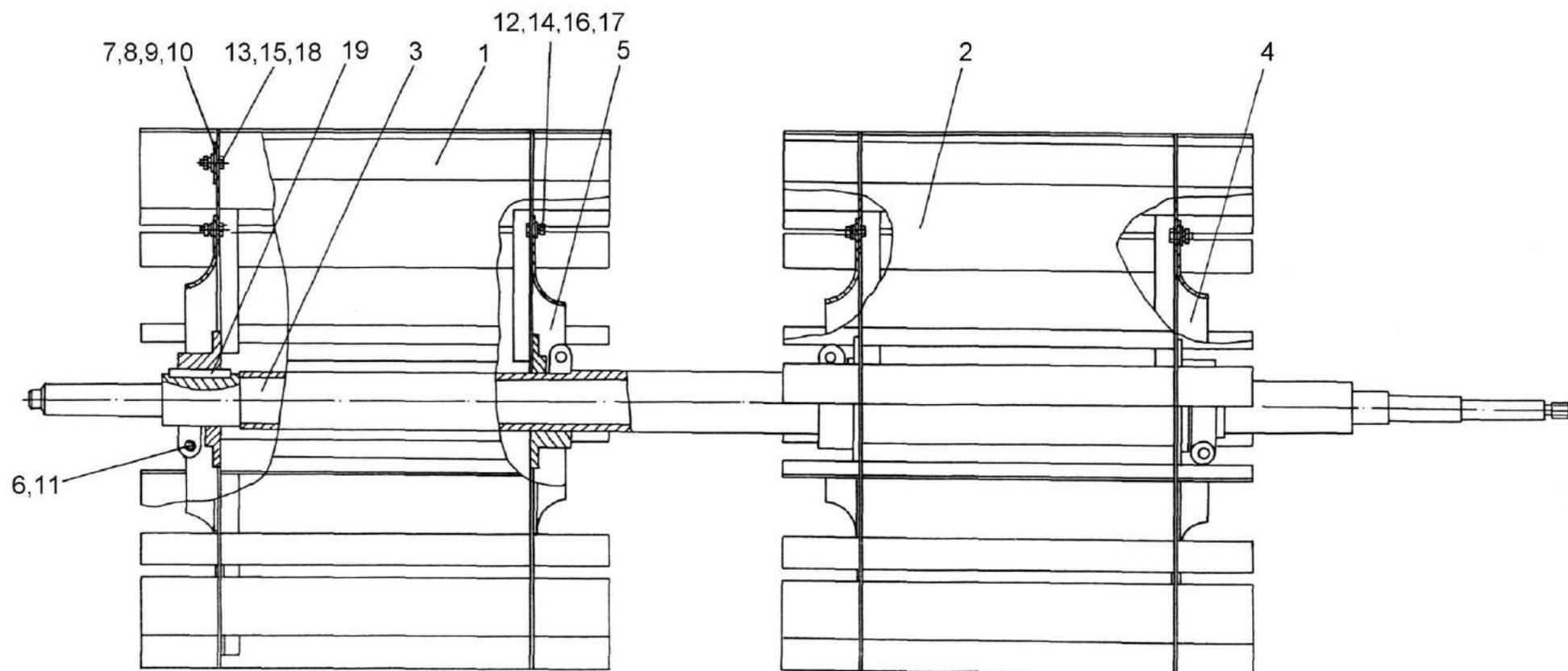
Рисунок 101 – Крылач КЗК 0217010Б
