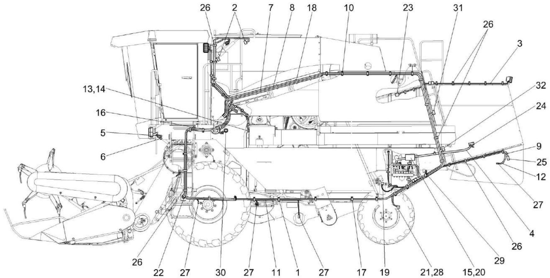
Рисунок 4 – Установка электрооборудования молотилки КЗК-8А-10-1-0721000 (вид слева)
