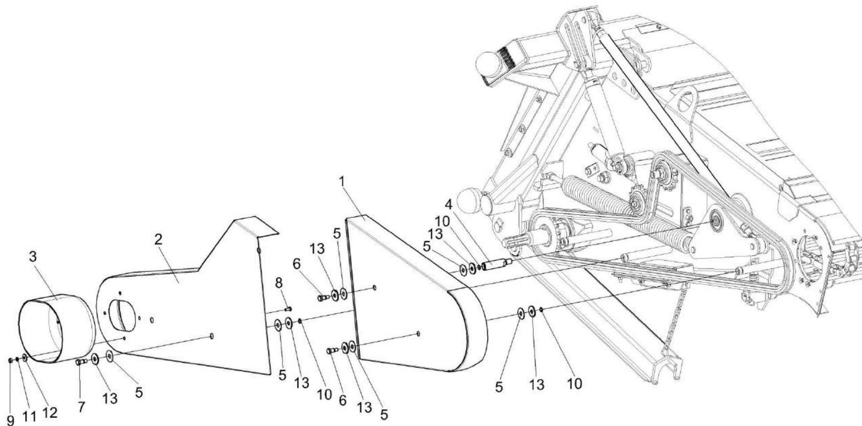
Рисунок 13 – Установка ограждений КЗК-8-1770050 и КЗК-8-1770070
