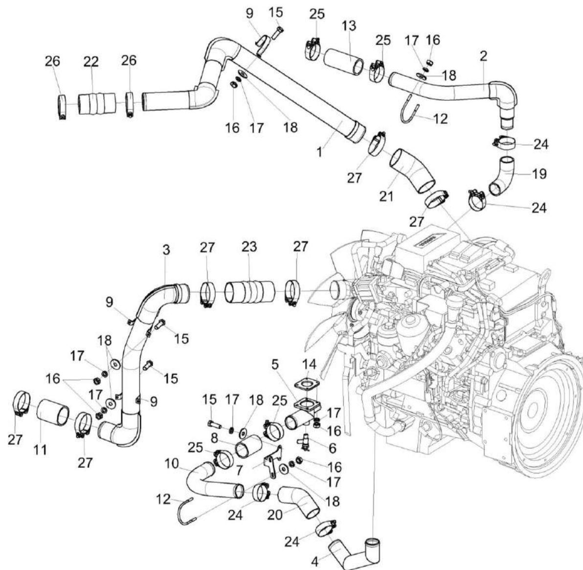
Рисунок 169 – Установка труб КЗК-8А-10-1-0106300
