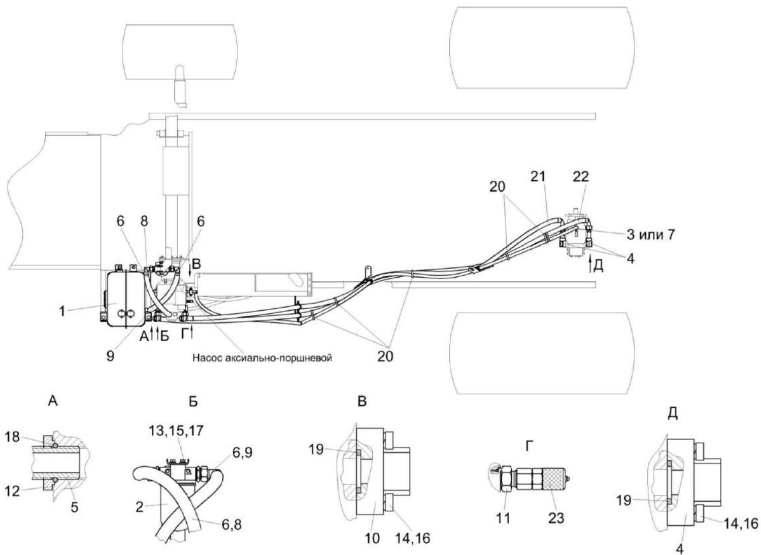
Рисунок 241 – Гидросистема привода ходовой части КЗК-8А-0601000 (лист 2)
