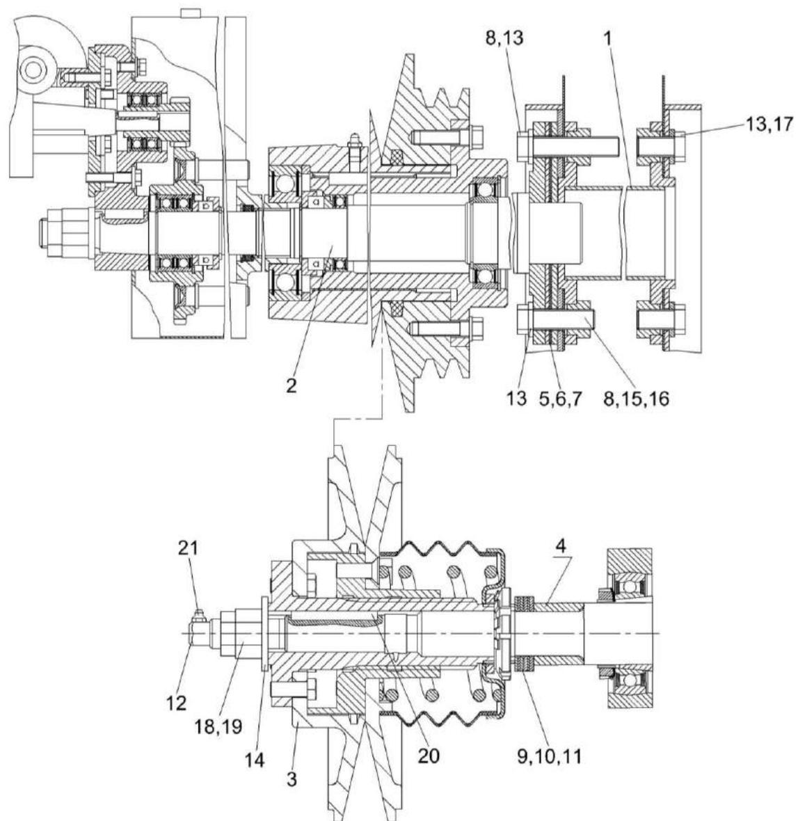
Рисунок 37 – Очистка, шкив ведомый КЗК-12-0217400 и контрпривод вариатора КЗК-7-0202500Б
