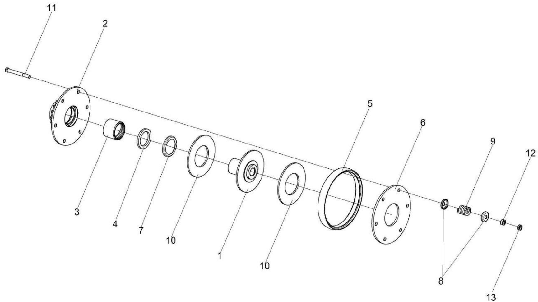
Рисунок 55 – Муфта фрикционная КЗК 0219020Б-01
