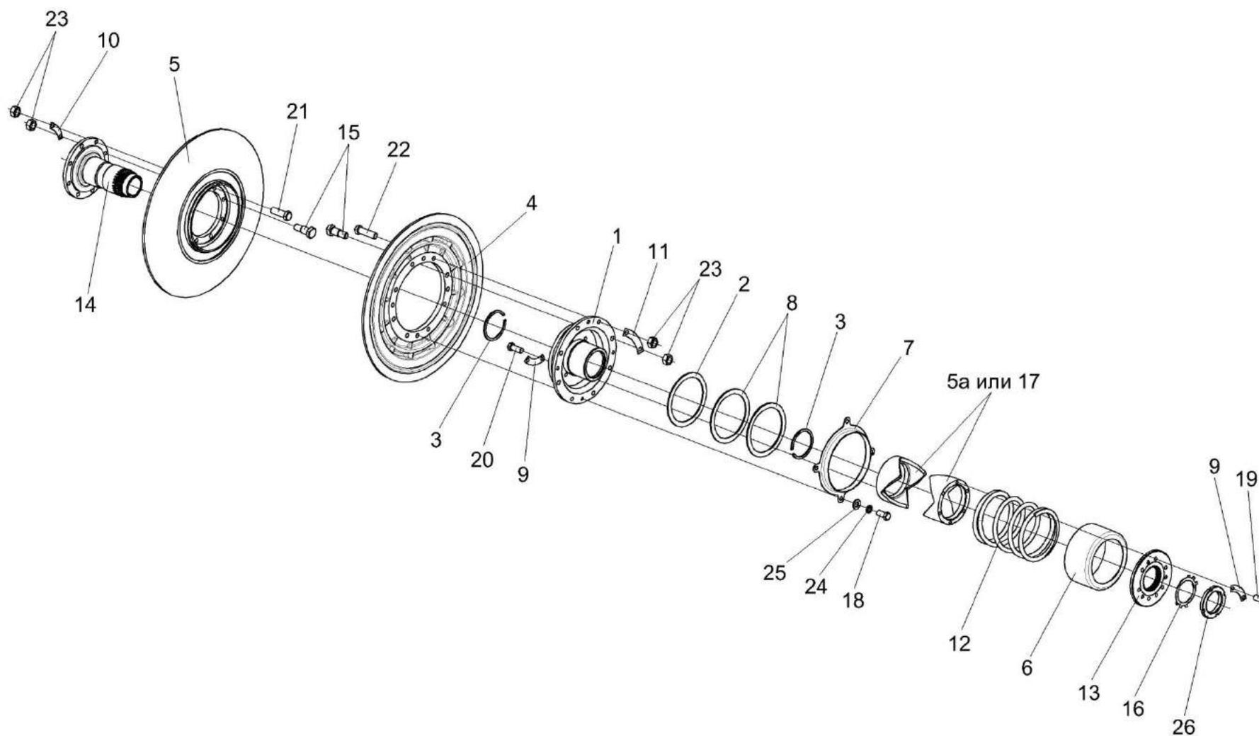
Рисунок 73 – Вариатор барабана КЗК 0123000
