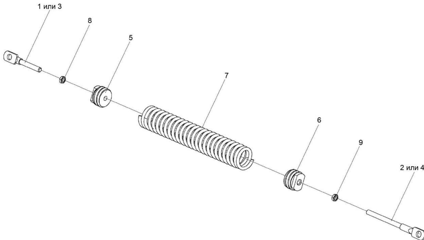
Рисунок 25 – Пружина КЗК 0125050
