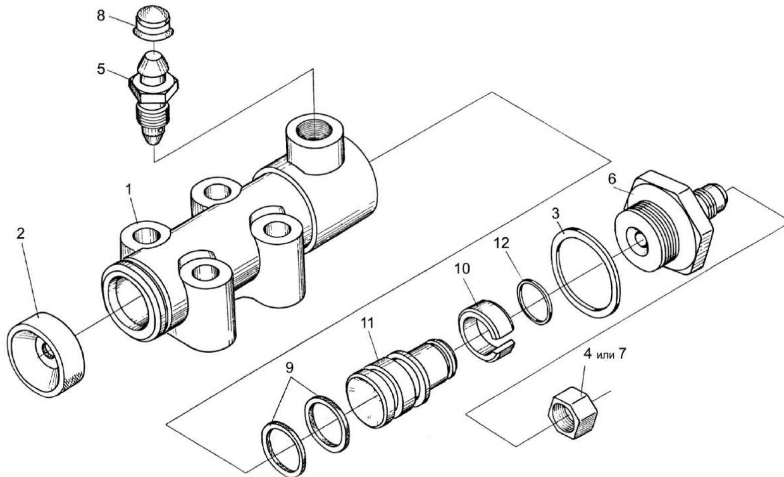
Рисунок 89 – Гидроцилиндр тормоза МК-23М.03.220А
