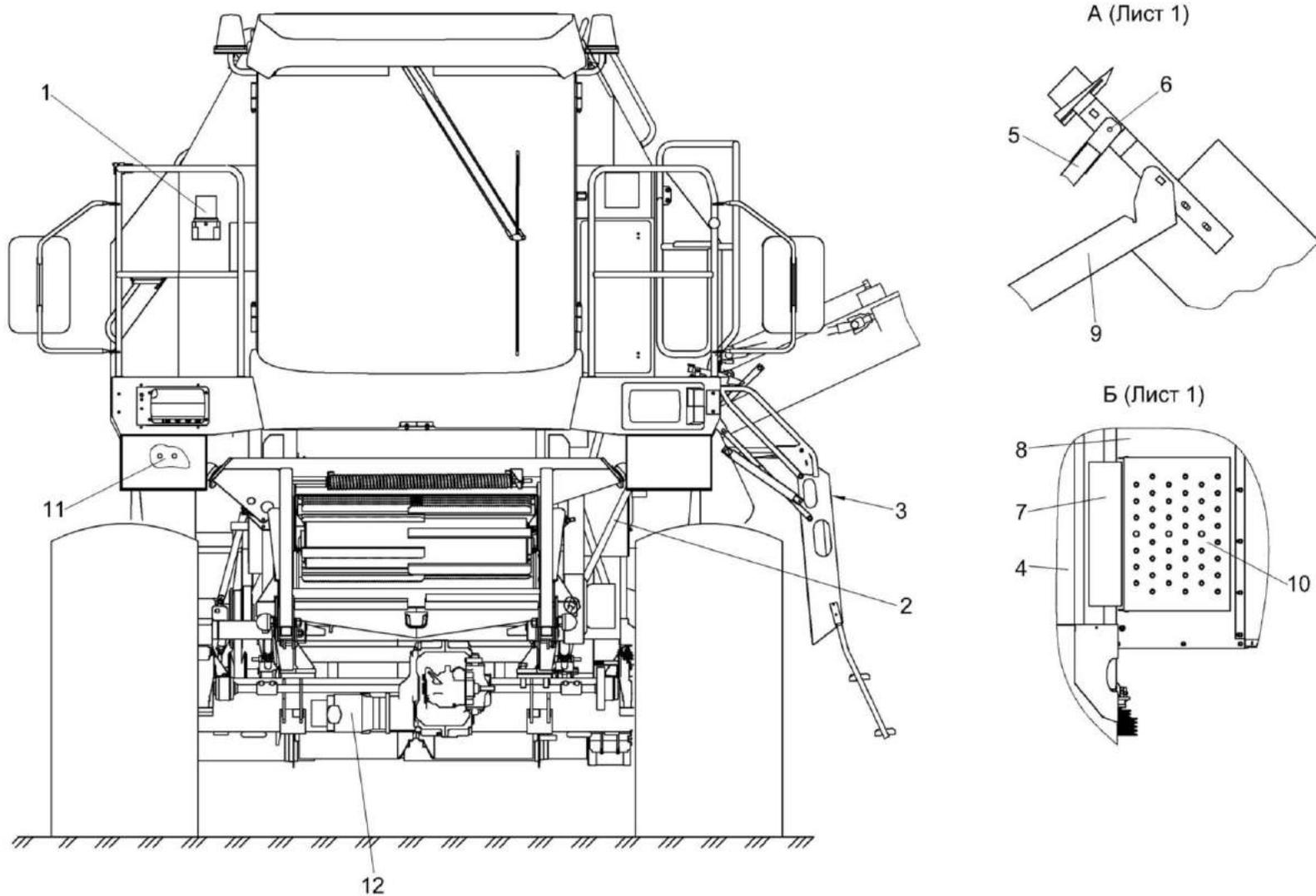
Рисунок 3 – Молотилка самоходная КЗК-8А-10-1-0100000 (вид спереди)
