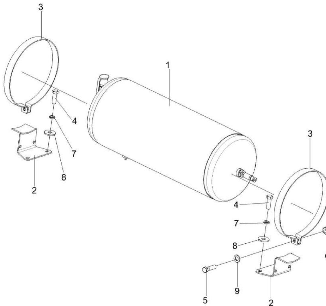
Рисунок 234 – Установка ресивера КЗК-8А-0800010
