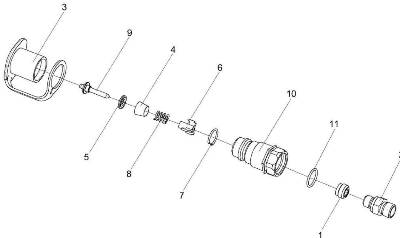
Рисунок 252 – Полумуфта внутренняя КЗК 0602620, КЗК 0602620-01, КЗК 0602620-02
