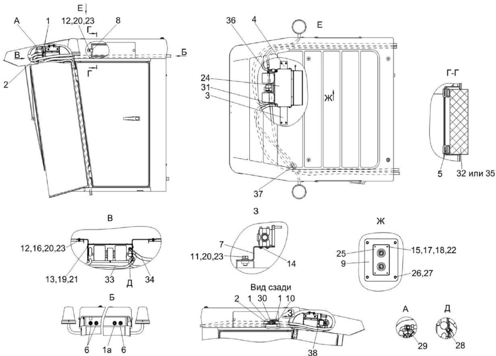
Рисунок 198 – Установка испарителя КЗК-7-0113040-01
