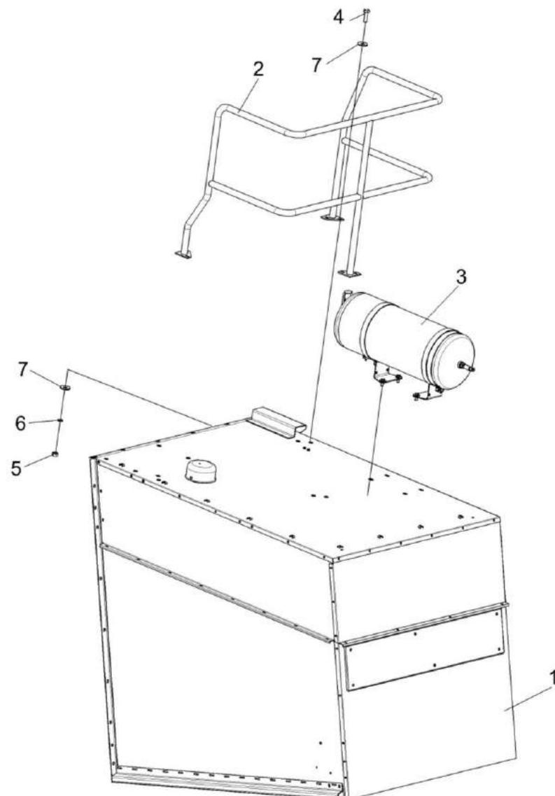
Рисунок 231 – Установка капота КЗК-8А-10-1-0228100
