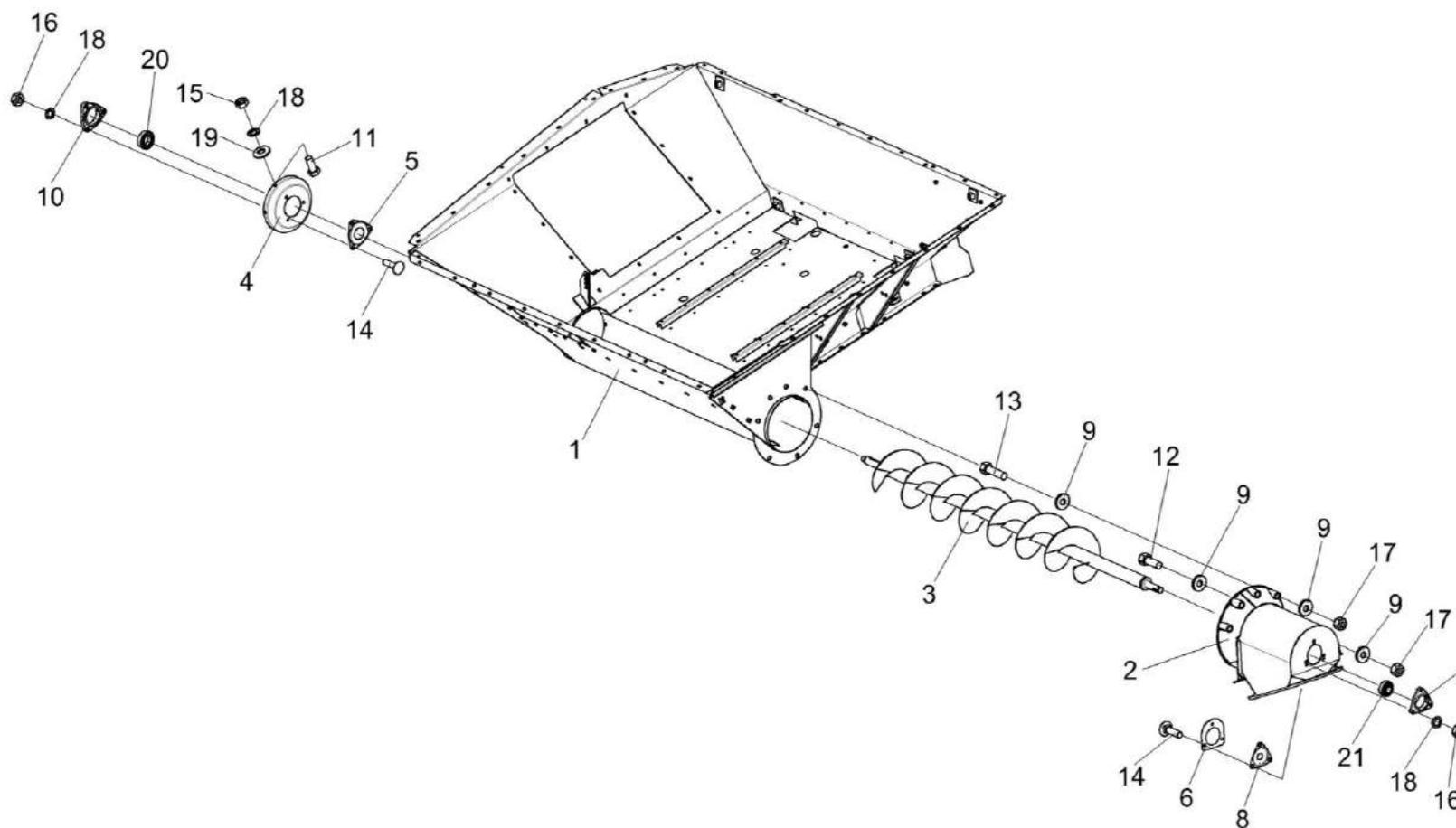
Рисунок 124 – Установка шнека КЗК 0206030Б
