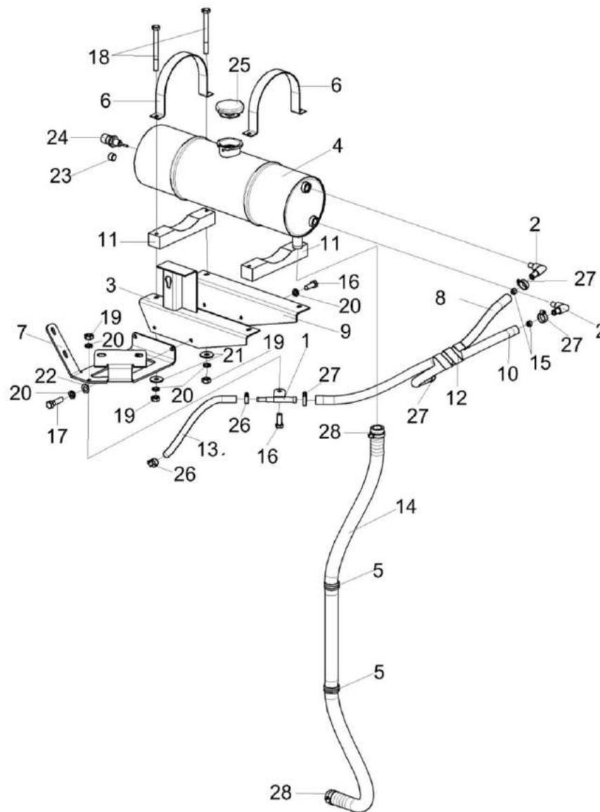
Рисунок 168 – Установка бачка расширительного КЗК-8А-10-1-0106070
