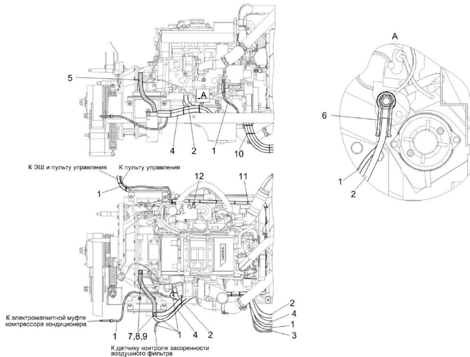
Рисунок 176 – Установка электрооборудования моторной установки КЗК-8А-10-1-0726000
