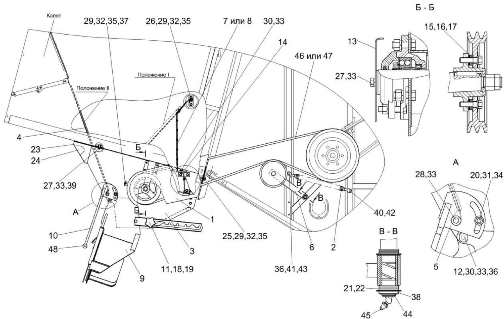
Рисунок 140 – Установка соломоизмельчителя КЗК 0290600-01
