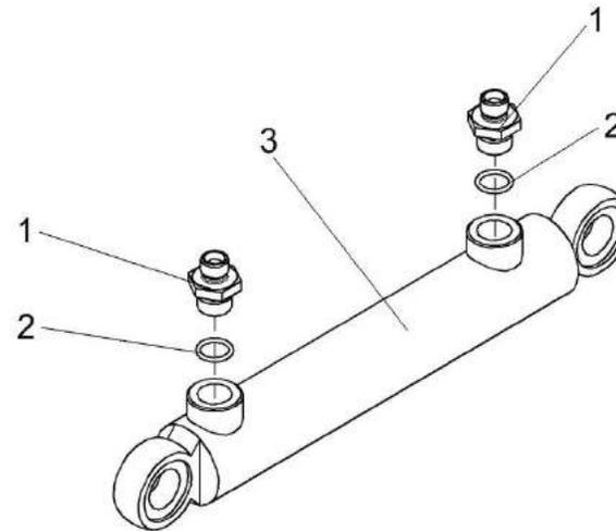
Рисунок 254 – Гидроцилиндр КЗК-12-0602310
