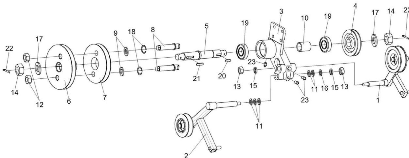
Рисунок 162 – Контрпривод КЗК 0112080А
