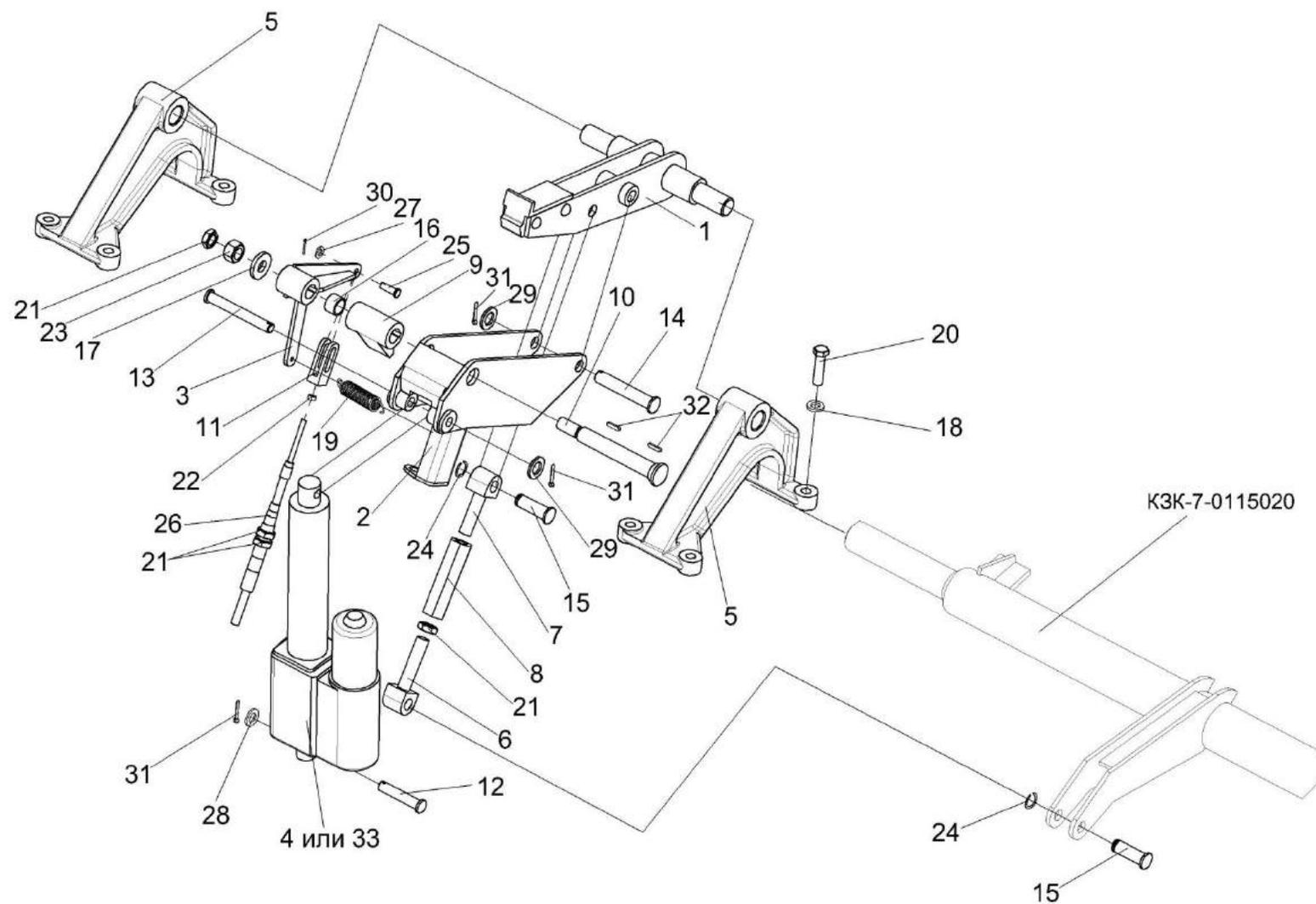
Рисунок 67 – Механизм подъема подбарабанья КЗК-8А-0115000 (установка электромеханизма)
