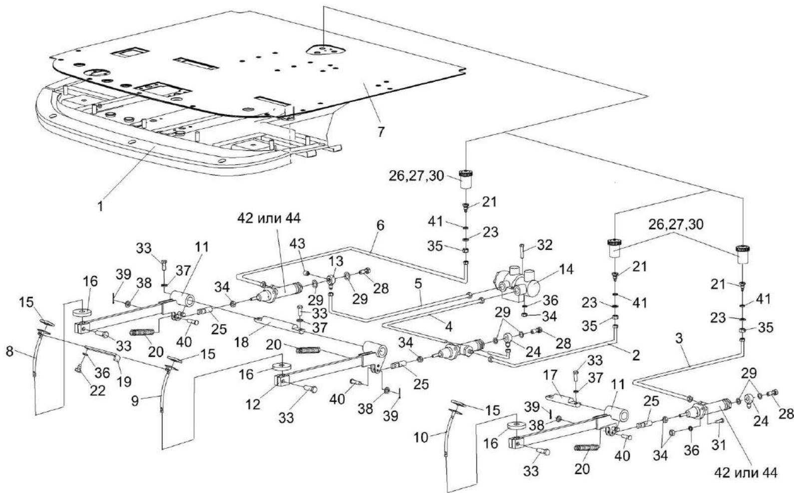
Рисунок 211 – Рычаги и трубопроводы площадки управления
