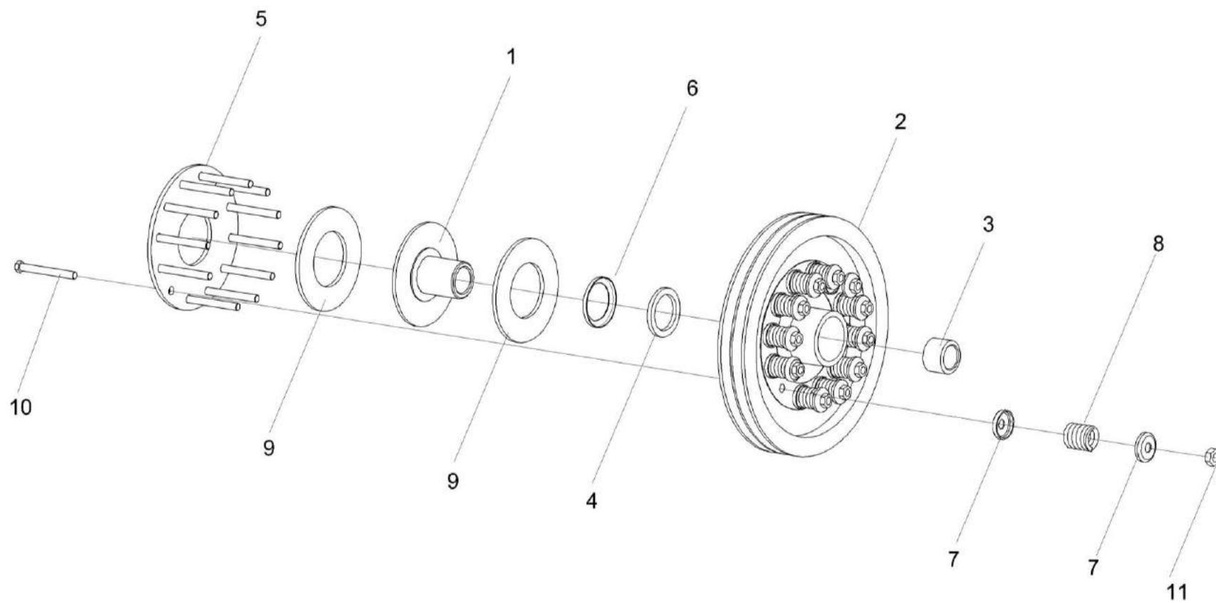
Рисунок 118 – Муфта фрикционная КЗК 0219100А
