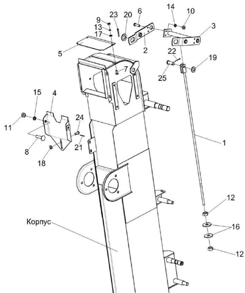
Рисунок 115 – Элеватор зерновой КЗК 0214000Б-01 (лист 4)
