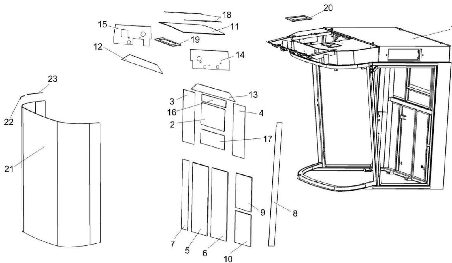
Рисунок 188 – Каркас КЗК-12-0120010
