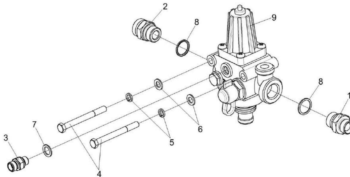
Рисунок 260 – Регулятор давления КЗК-8А-10-1-0800190
