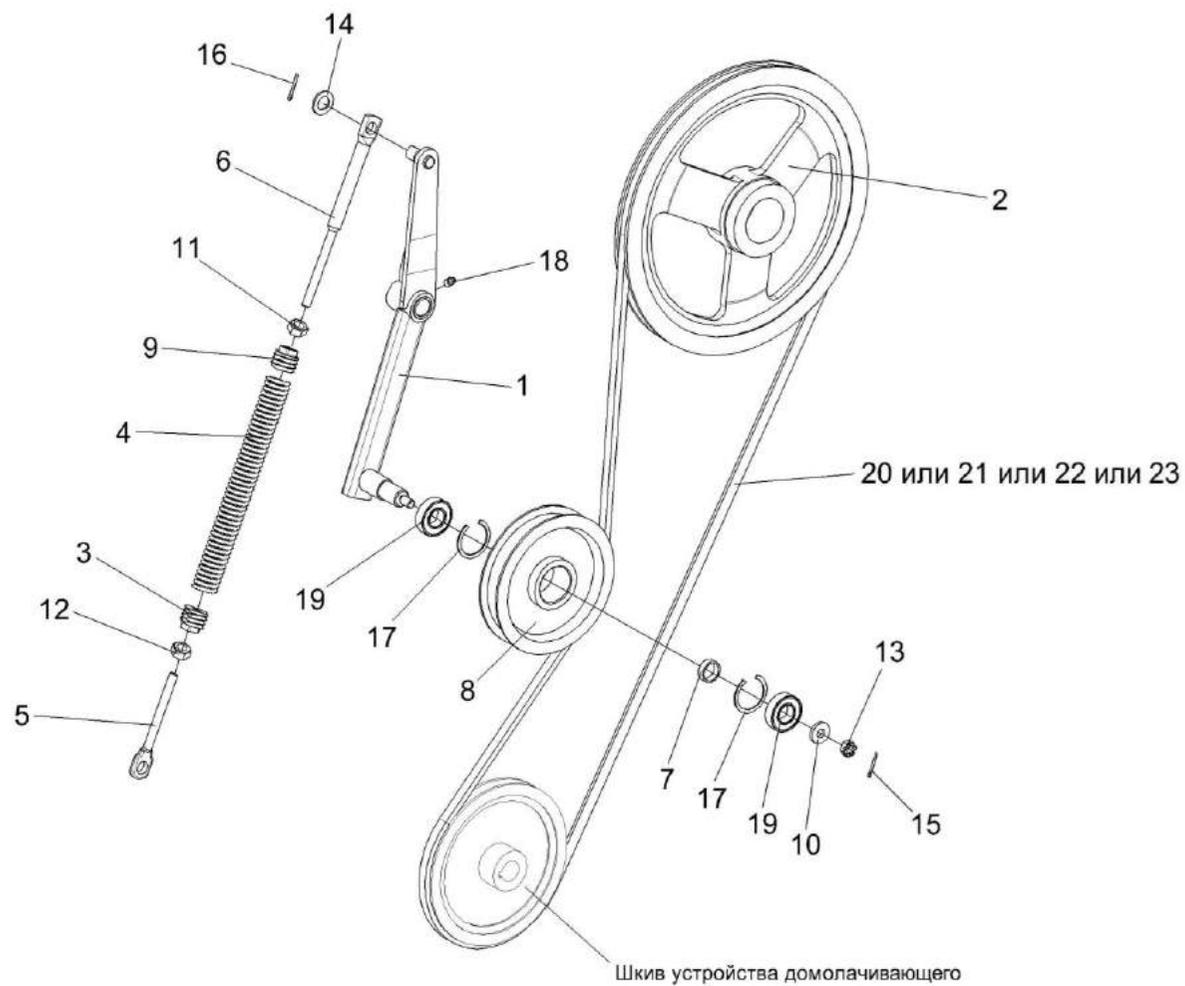
Рисунок 40 – Установка привода устройства домолачивающего
