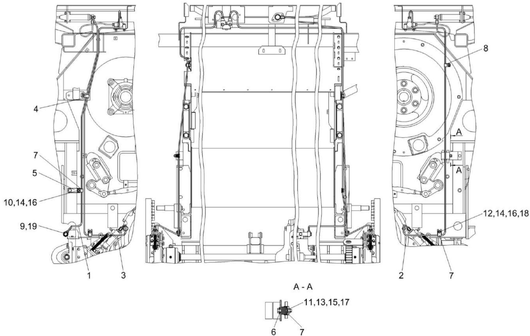
Рисунок 227 – Установка трубопроводов моста ведущих колёс K3K-8-0119250
