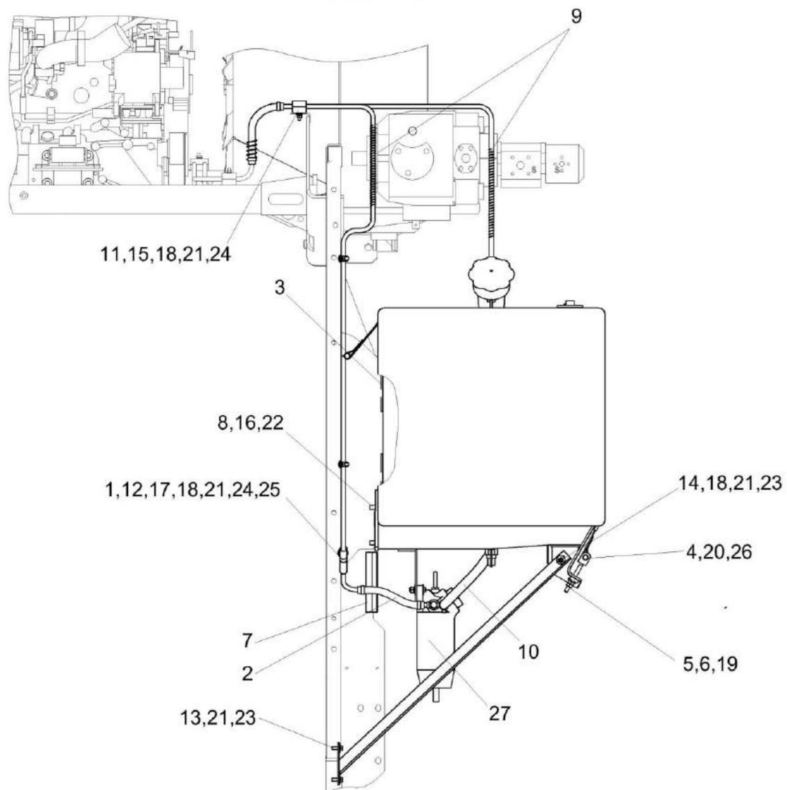
Рисунок 183 – Установка топливной системы КЗК-8А-10-1-0126000 (лист 2)
