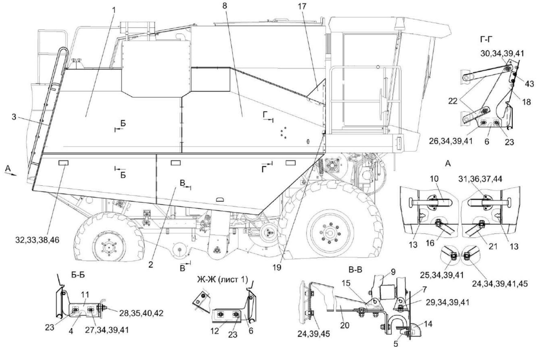
Рисунок 230 – Установка капотов и ограждений КЗК-8А-0128000-03 (вид справа)
