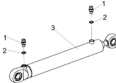
Рисунок 257 – Гидроцилиндр КЗК 0602510
