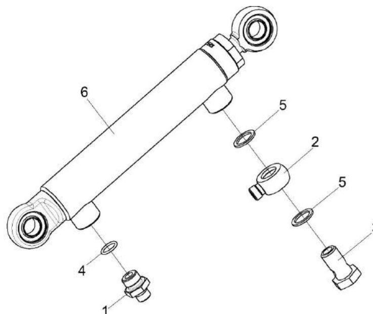
Рисунок 253 – Гидроцилиндр КЗК-8-0602500
