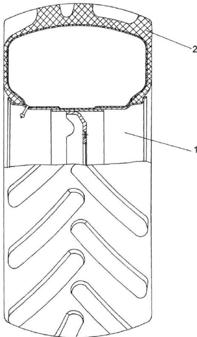
Рисунок 108 – Колесо КЗК 0118000 и КЗК 0118000-01
