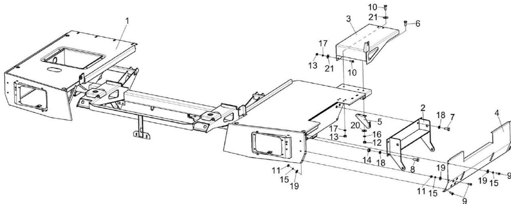
Рисунок 235 – Подрамник КЗК-8-3-0121000
