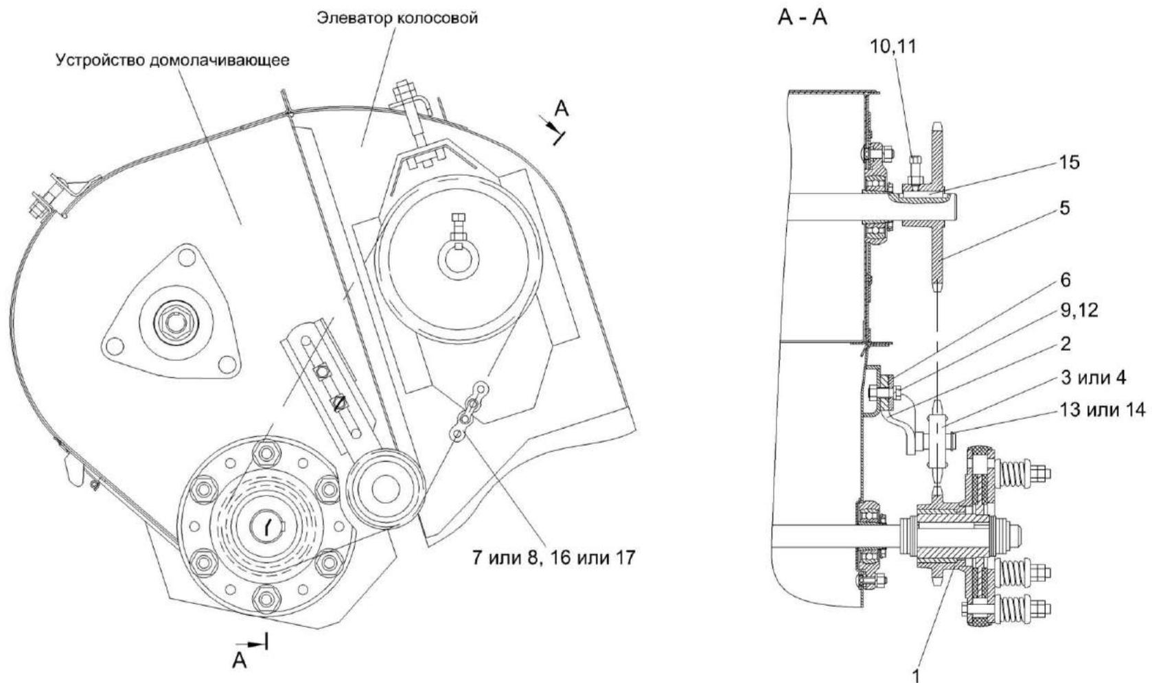
Рисунок 31 – Установка цепного привода элеватора колосового
