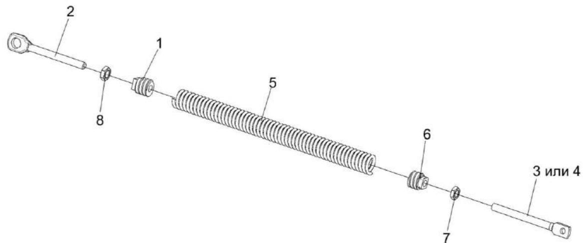
Рисунок 50 – Пружины КЗК 0202840А и КЗК 0202840А-01
