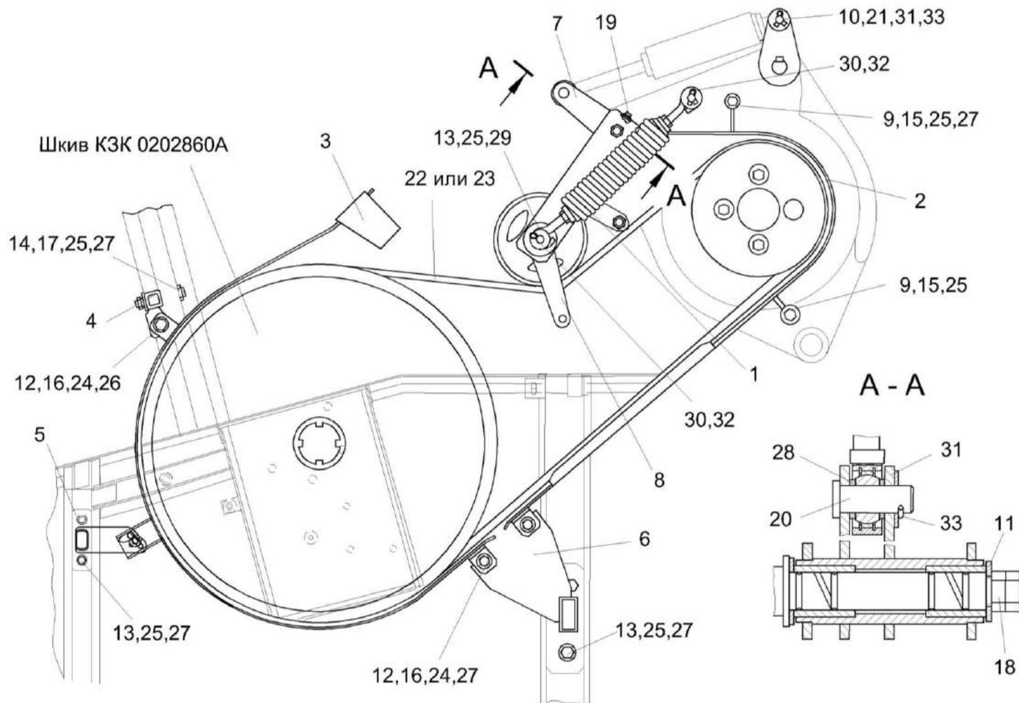
Рисунок 179 – Привод главного контрпривода КЗК 0220000А
