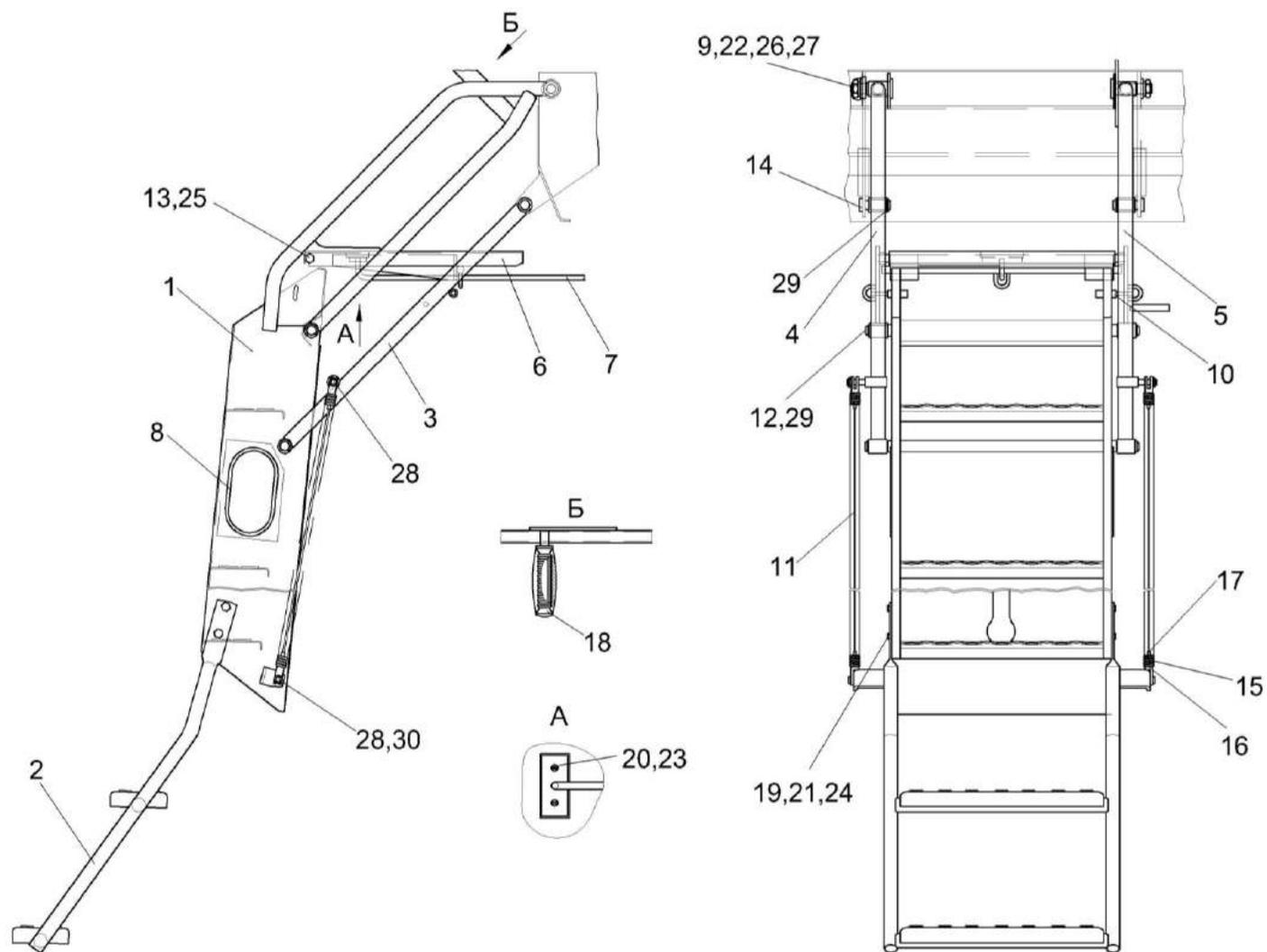
Рисунок 237 – Установка трапа КЗК-7-0117000
