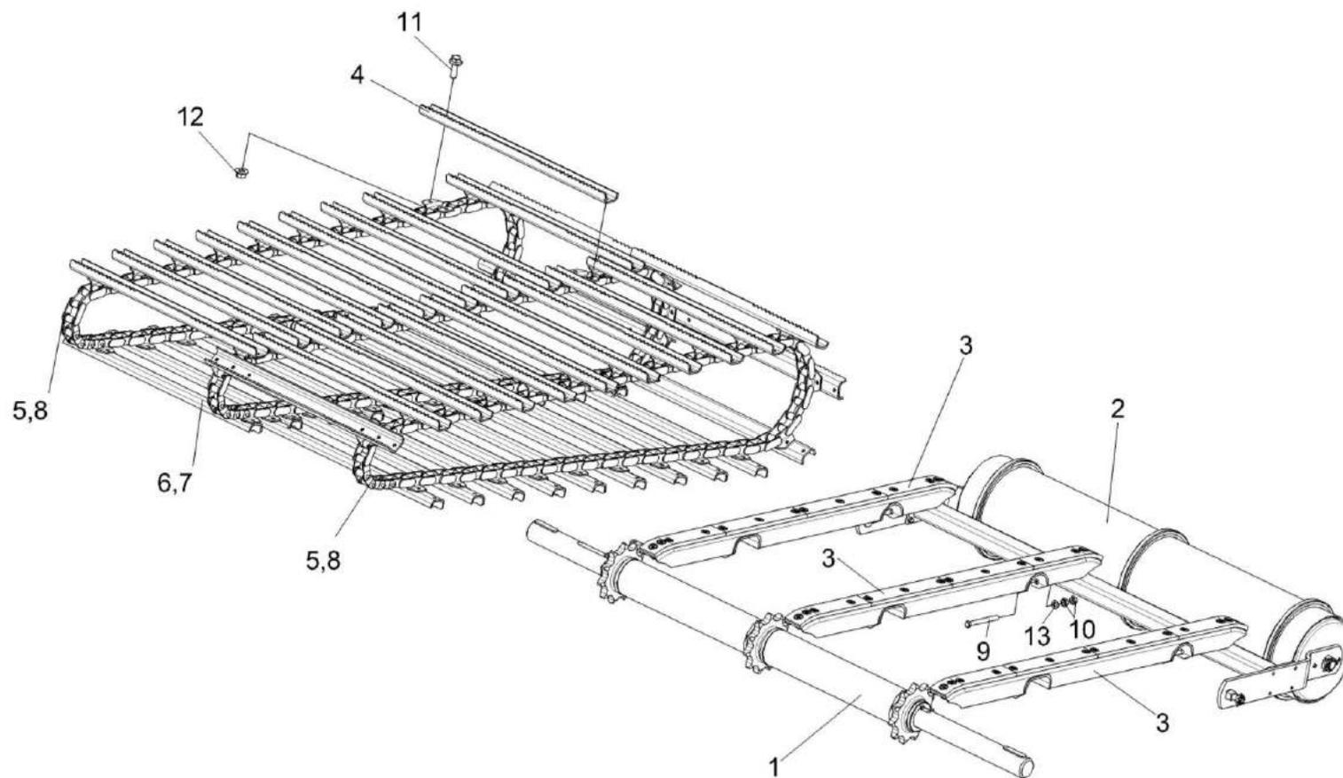
Рисунок 9 – Установка транспортера КЗК-8-1817100
