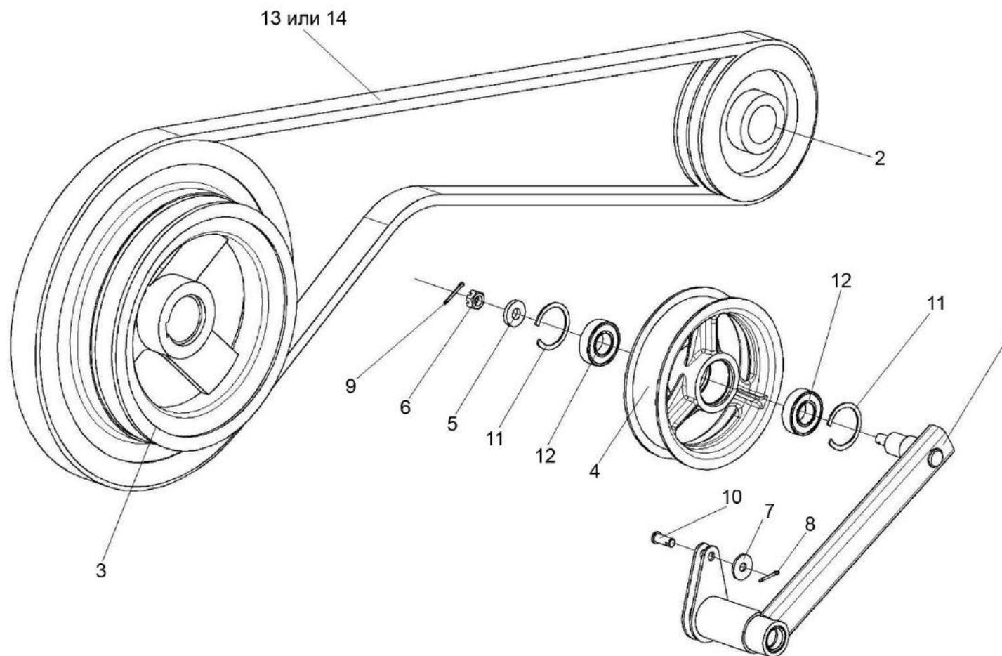
Рисунок 39 – Установка рычага КЗК 0202430В
