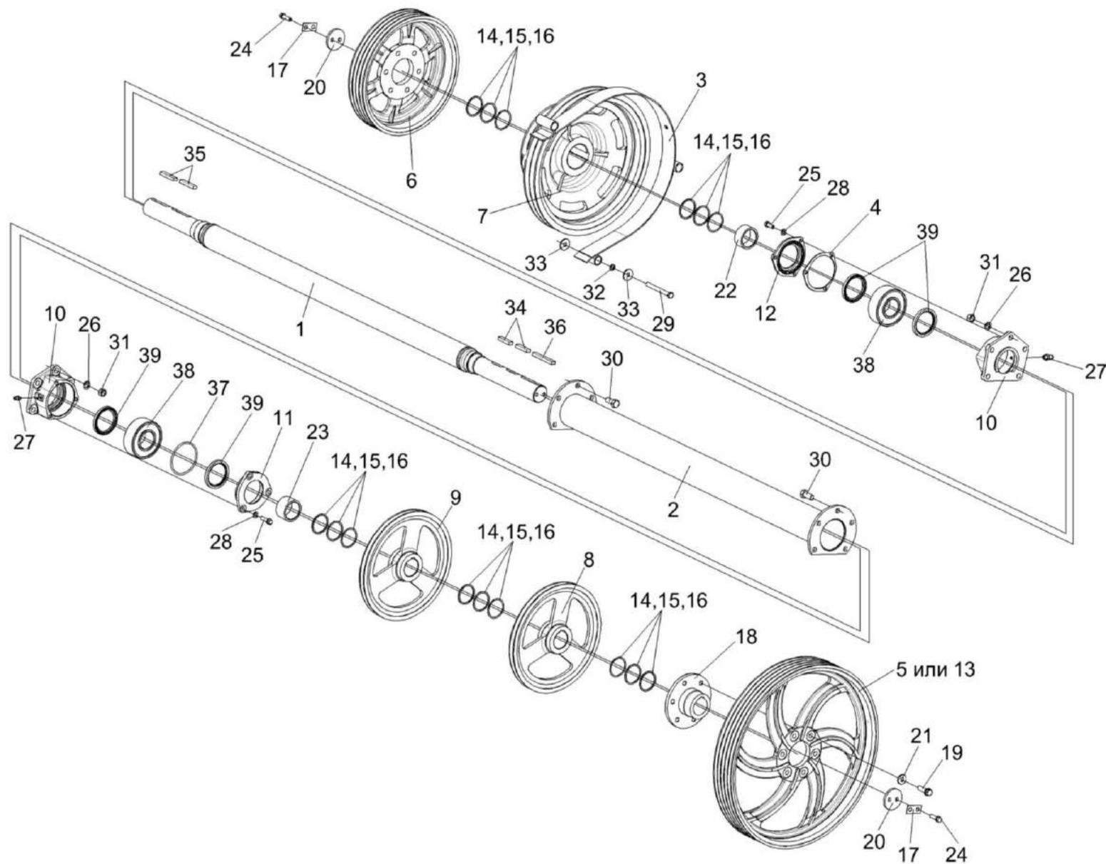
Рисунок 28 – Установка шкивов КЗК 0202860А и КЗК 0202103Б
