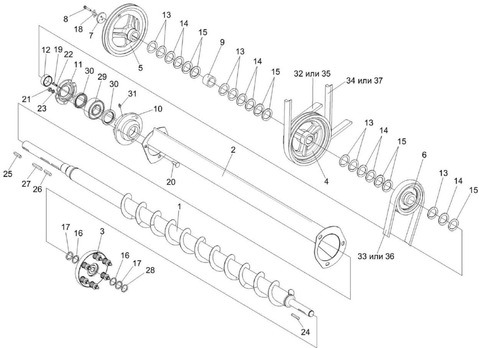
Рисунок 29 – Установка шкивов на шнек распределительный КЗК 0202770В
