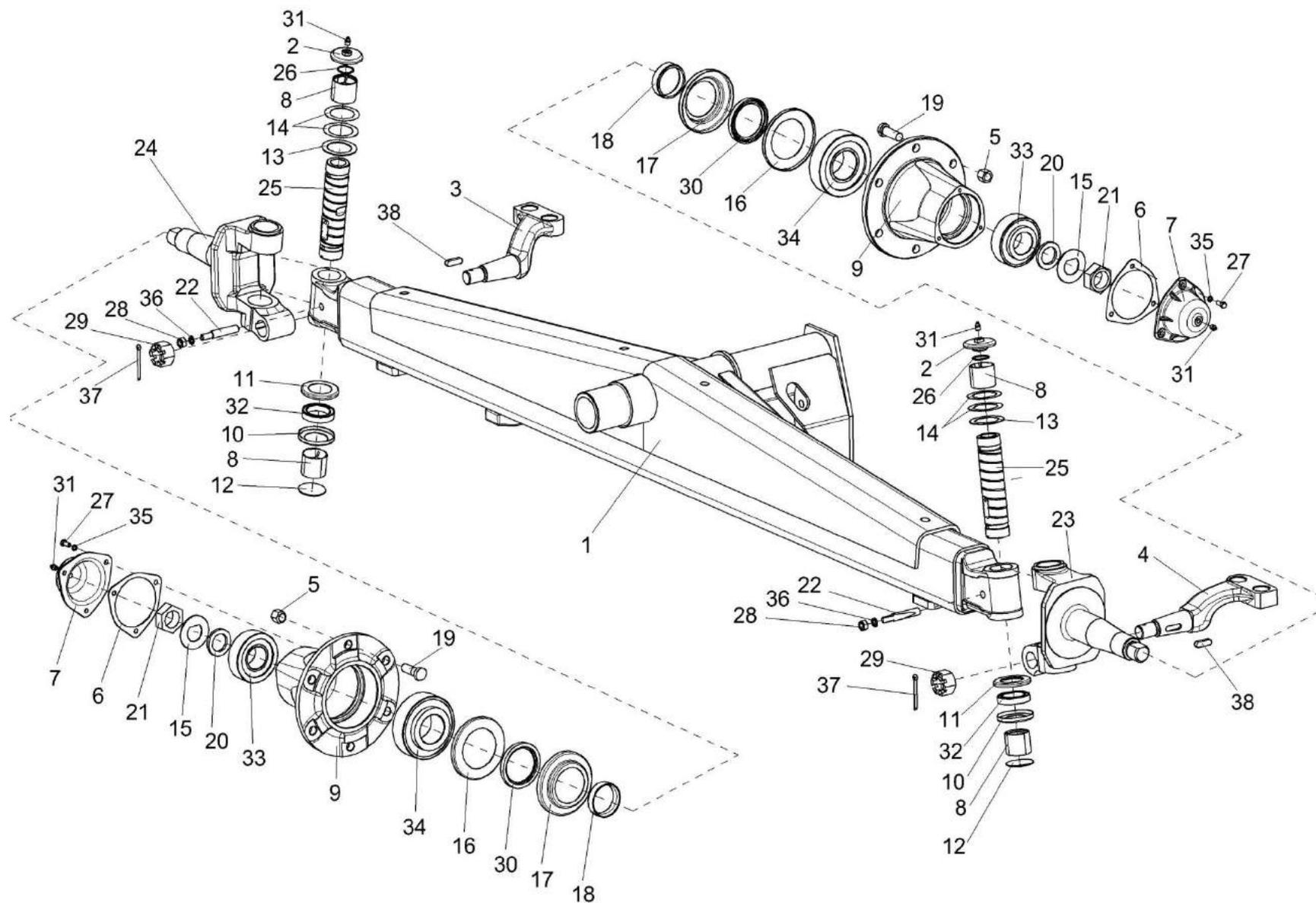
Рисунок 97 – Мост управляемых колес КЗК 0109000 (лист 1)
