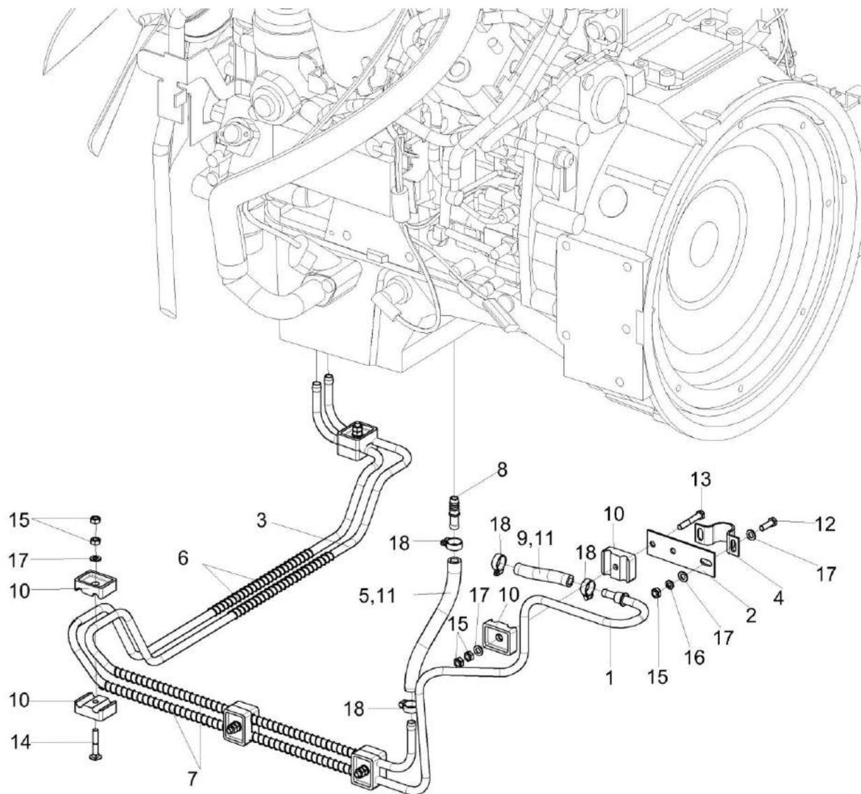
Рисунок 171 – Установка топливопроводов КЗК-8А-10-1-0126100
