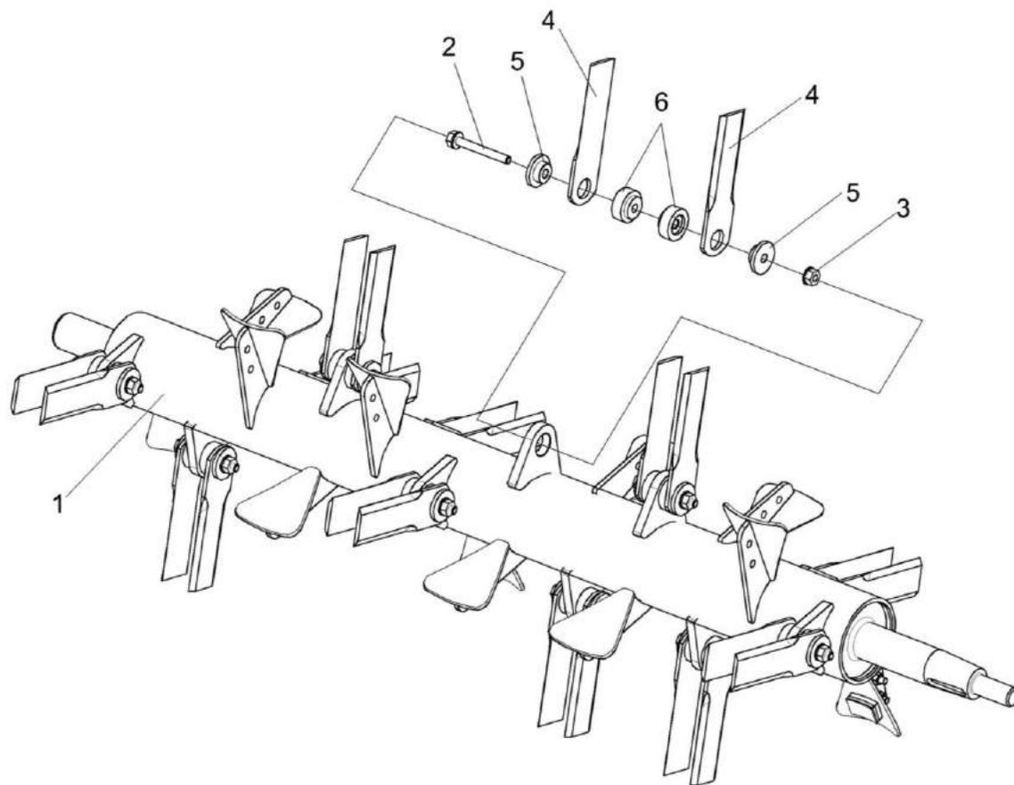
Рисунок 146 – Ротор измельчителя КЗК 0290140А
